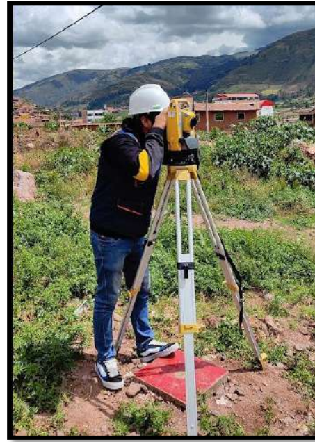
Figura 39. Lectura del punto geodésico con estación total.
