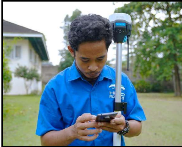
Figura 21. Toma de data con GPS diferencial.
