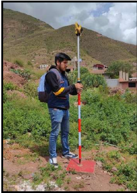
Figura 39. Lectura del punto geodésico con estación total.
