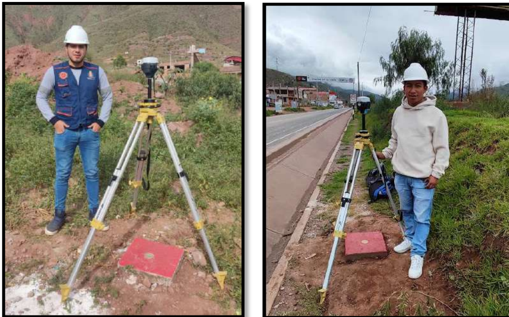
Figura 20. Georreferenciación de puntos geodésicos con GPS diferencial.
