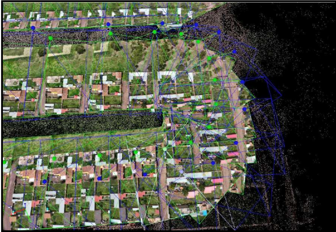
Figura 76. Generación de traslape y/o superposición de fotos tomadas por el RPAS (dron) al momento de girar y procesamiento I.
