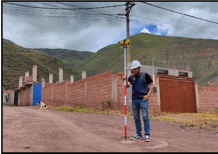
Figura 43. Lectura de buzones con estación total.
