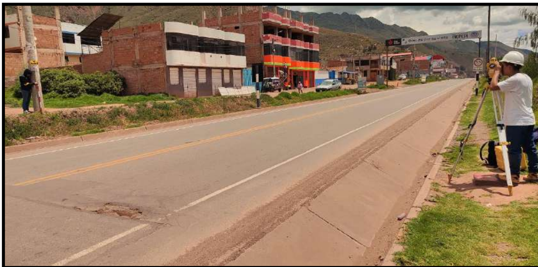
Figura 46. Lectura puntos a partir de un punto geodésico.
