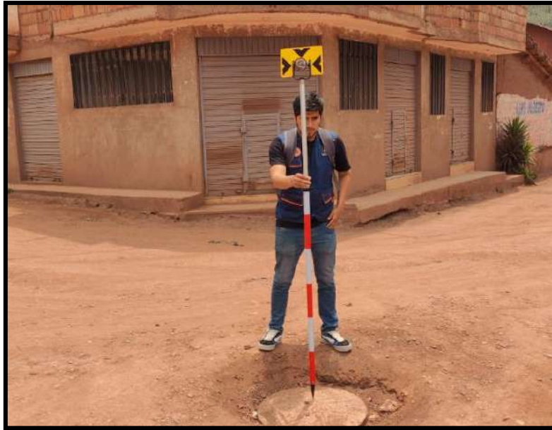
Figura 45. Lectura de buzones con estación total II.
