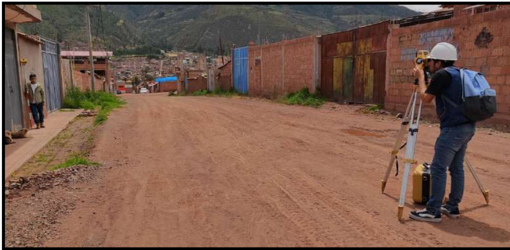
Figura 42. Lectura predios con estación total.
