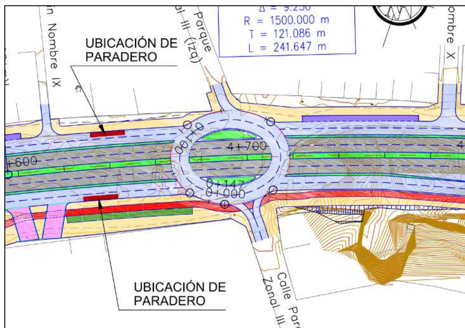
Figura N°53: Ubicación de paraderos en los óvalos del proyecto de la vía expresa.
