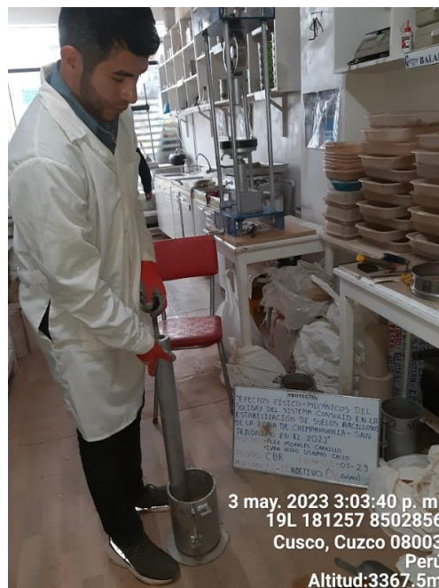
Figura 46: Determinación de la capacidad de soporte de california CBR 1% de aditivo
