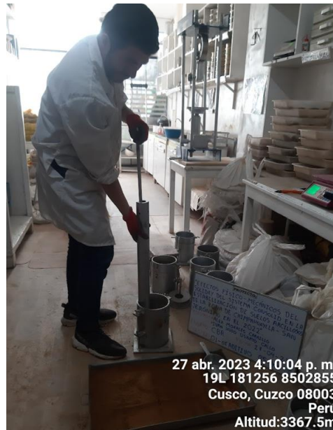
Figura 39: Determinación de la capacidad de soporte de california CBR 0% de aditivo
