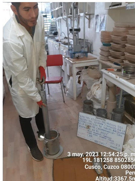
Figura 44: Determinación de la capacidad de soporte de california CBR 1% de aditivo
