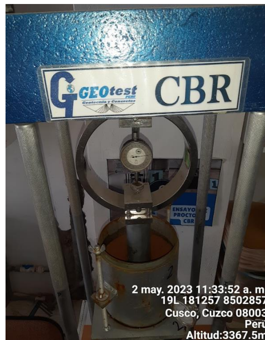
Figura 42: Determinación de la capacidad de soporte de california CBR 0% de aditivo
