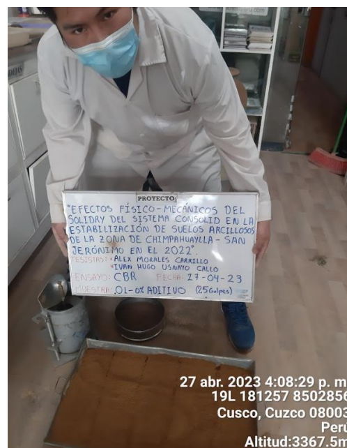
Figura 38: Determinación de la capacidad de soporte de california CBR 0% de aditivo
