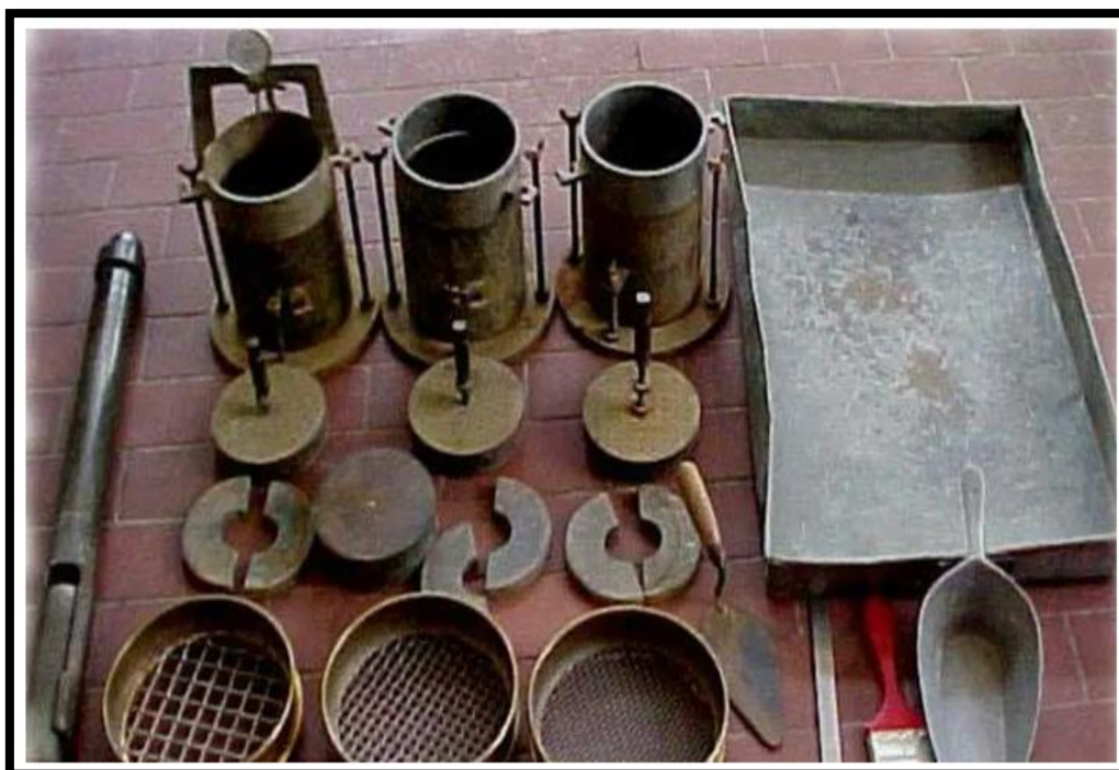
Figura 6: Materiales para el ensayo de CBR bajo la norma ASTM 1883 .
