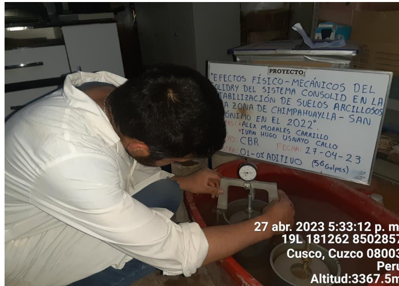
Figura 41: Determinación de la capacidad de soporte de california CBR con 0% de aditivo
