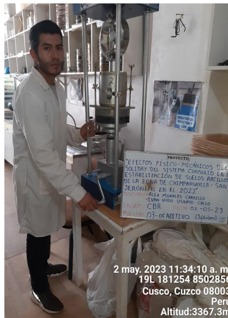
Figura 43: Determinación de la capacidad de soporte de california CBR 0% de aditivo
