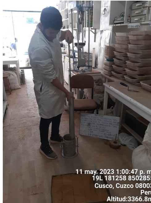
Figura 49: Determinación de la capacidad de soporte de california CBR 2% de aditivo
