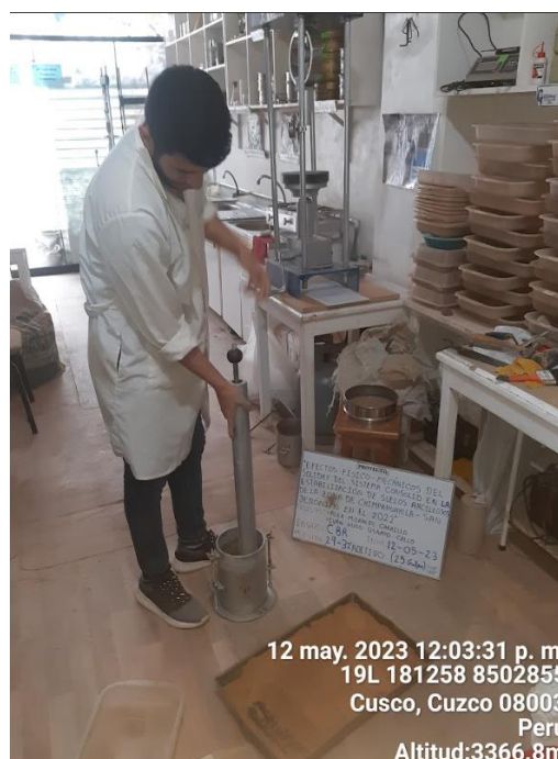
Figura 50: determinación de la capacidad de soporte de california CBR 3% de aditivo
