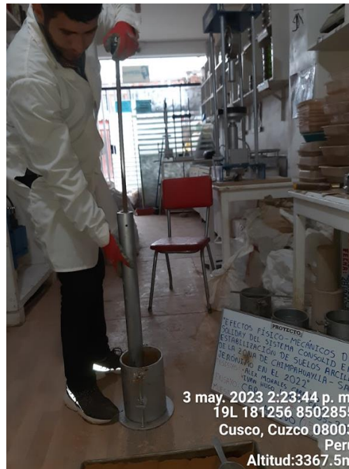
Figura 45: Determinación de la capacidad de soporte de california CBR 1% de aditivo
