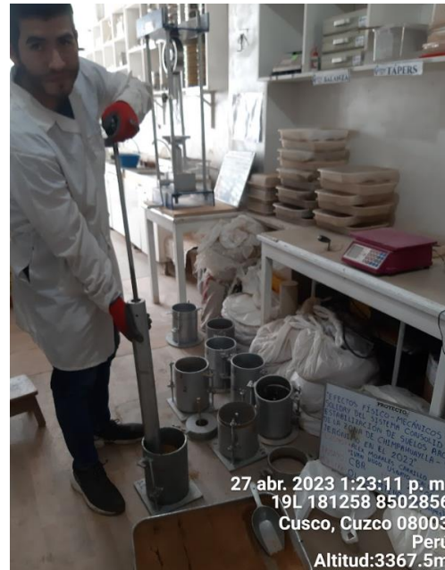
Figura 37: Determinación de la capacidad de soporte de california CBR 0% de aditivo
