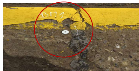
Figura N° 90. Monumentación de BM1 en la intersección de Av. Huáscar y Av. Arcopunku
