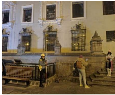
Figura N° 94. Manejo del prisma en la Av. Sol.
