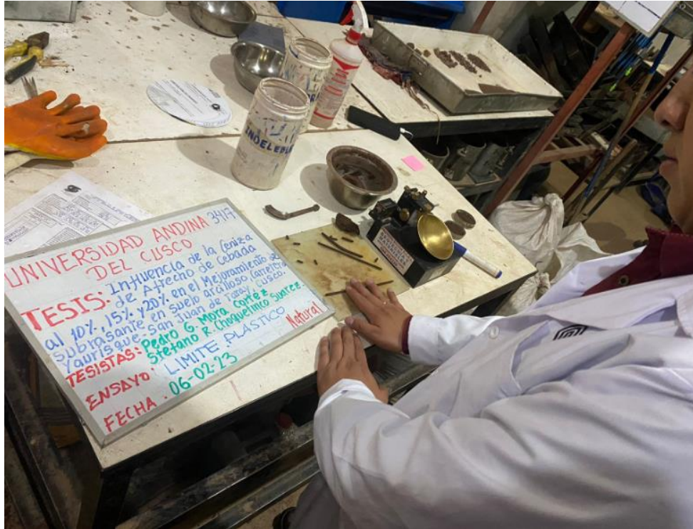
Gráfico 15 Ensayo del límite plástico al suelo natural
