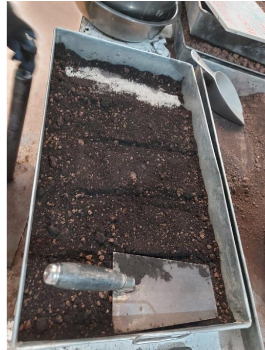
Fotografía 14: Preparación de muestra para ensayo de Proctor Modificado
