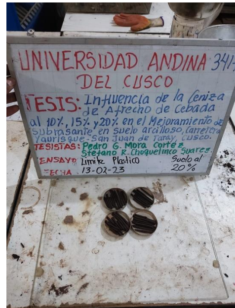
Fotografía 10: Ensayo Límite Plástico
