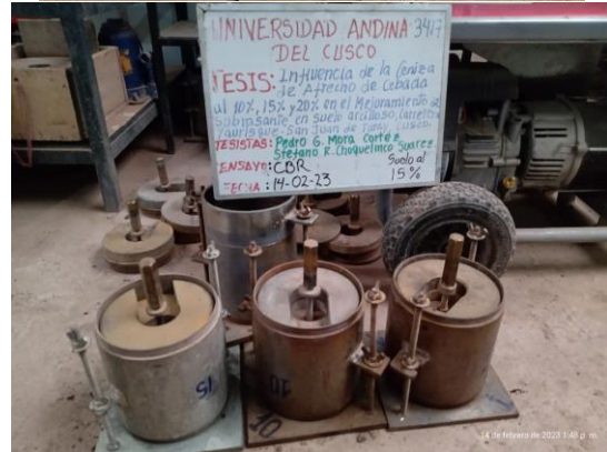
Fotografía 18: Preparación de muestras del CBR listas para ser sumergidas
