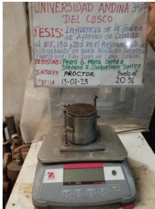
Gráfico 26 Toma del peso de las muestras para el ensayo de Proctor Modificado Suelo natural + 20% de CAC
