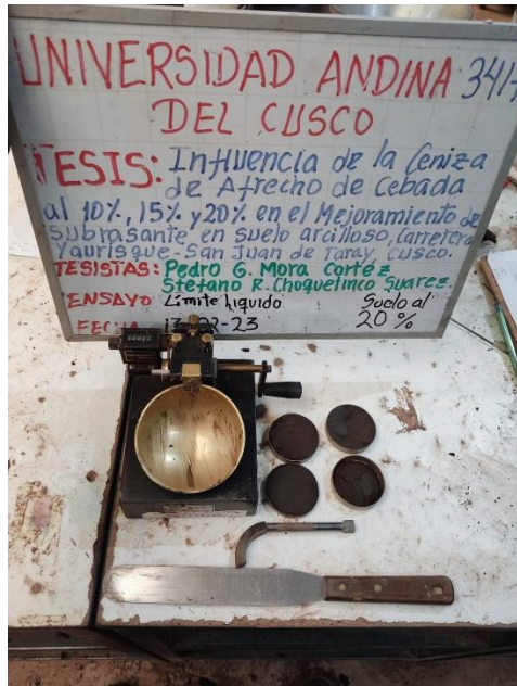
Fotografía 09: Ensayo Límite Líquido
