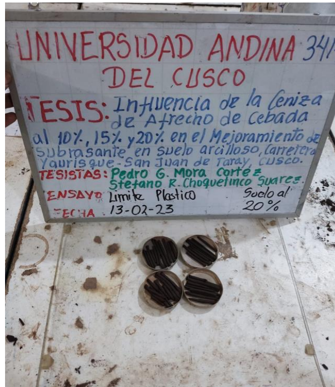
Gráfico 18 Ensayo del límite plástico con ceniza al 20%
