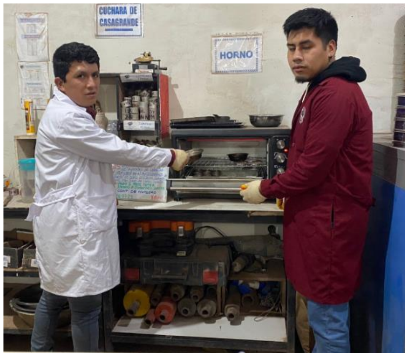
Gráfico 19 Puesta en el horno de las muestras del límite plástico
