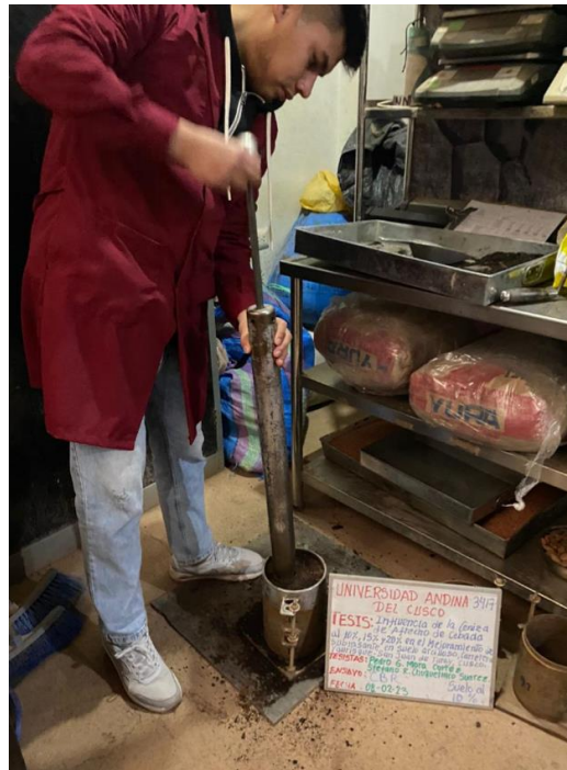
Gráfico 30 Compactación de la muestra para el ensayo de CBR con suelo natural + CAC al 10% + agua
