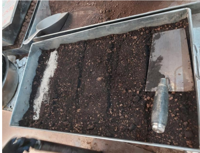
Gráfico 20 Mezclado de muestras y aditivos y separación en 5 capas para Proctor Modificado
