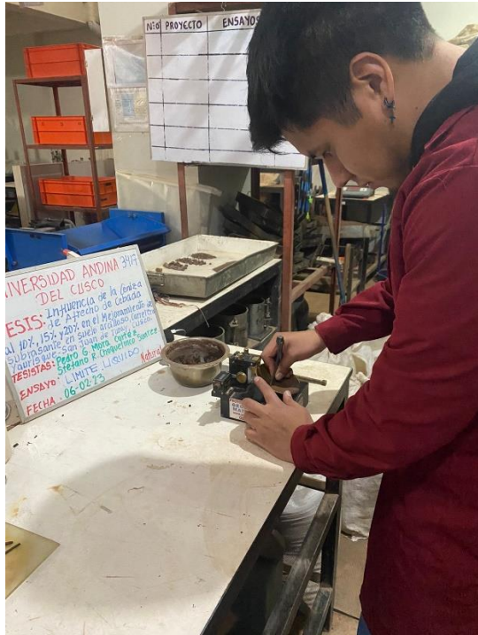
Fotografía 09: Ensayo Límite Líquido
