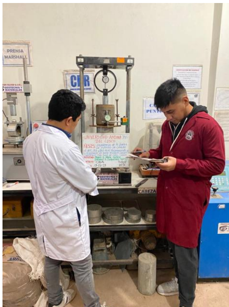
Fotografía 19: Ensayo de CBR
