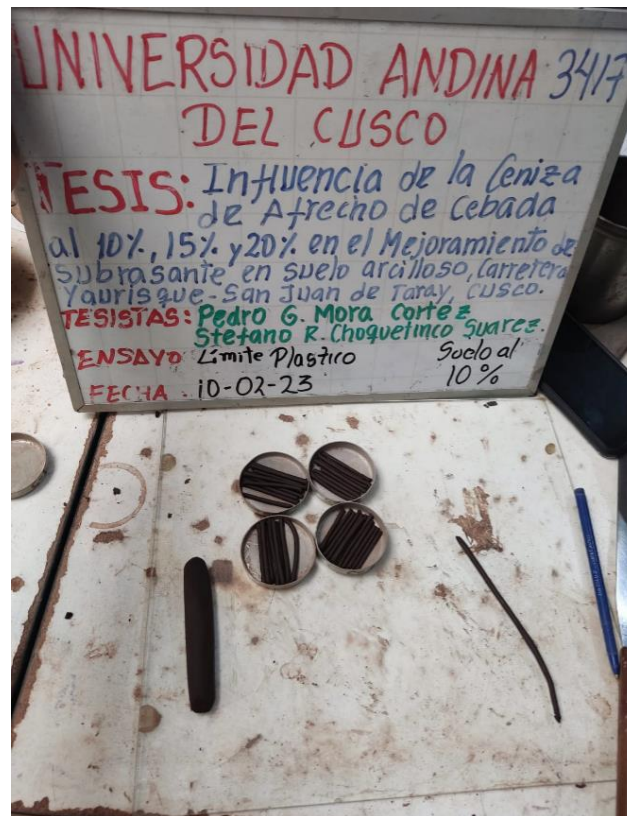
Gráfico 16 Ensayo del límite plástico con ceniza al 10%
