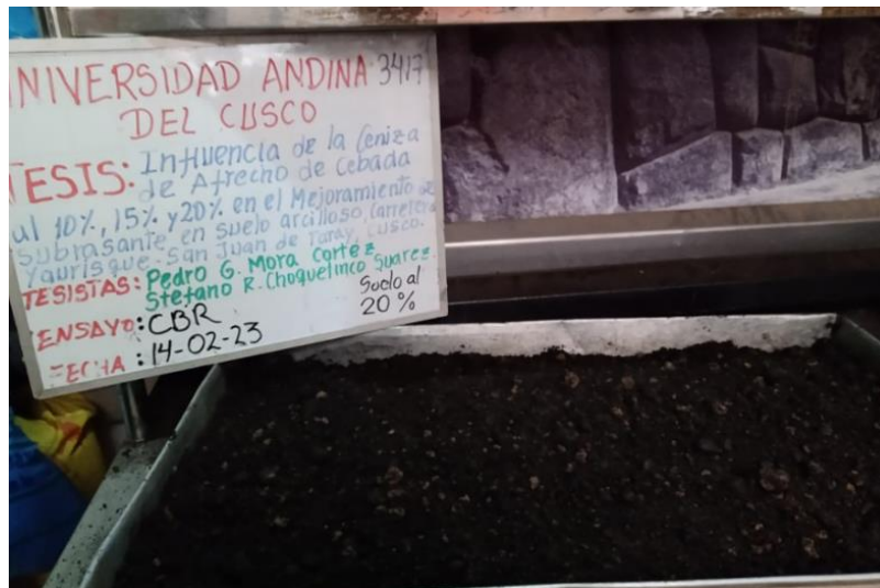
Gráfico 29 Preparación del Suelo Natural + CAC al 20% para el ensayo de CBR
