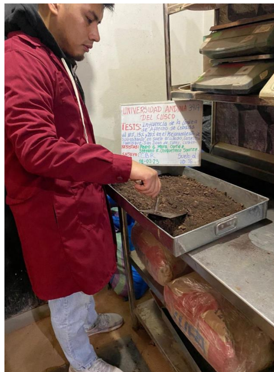
Gráfico 27 Preparación de la muestra para el ensayo de CBR
