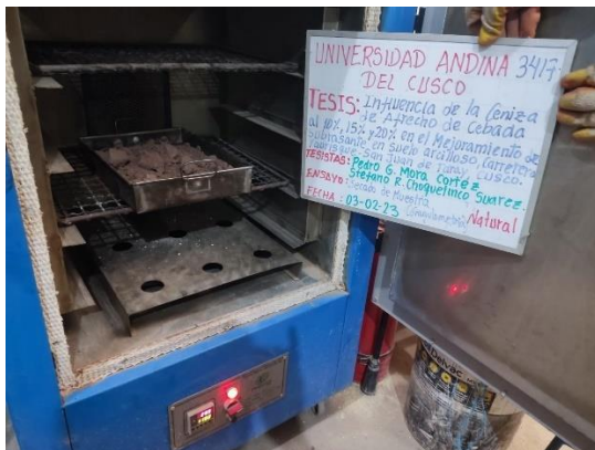
Fotografía 07: Secado de la muestra (granulometría)
