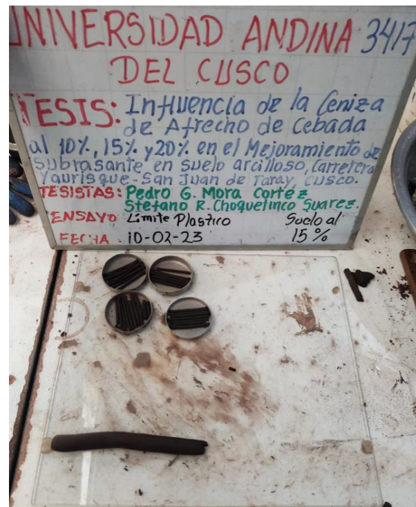
Gráfico 17 Ensayo del límite plástico con ceniza al 15%
