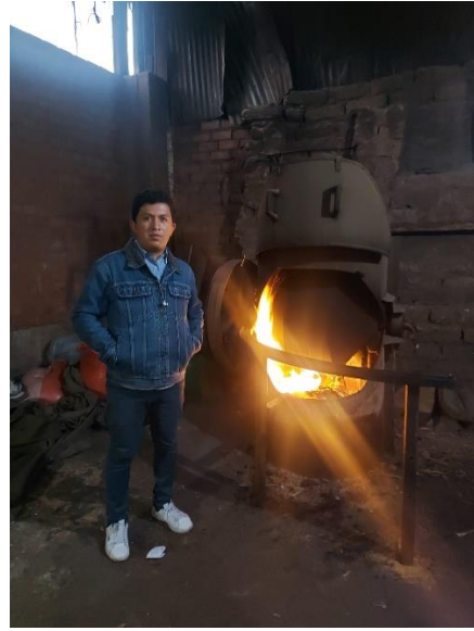
Fotografía 02: Proceso de quemado del Afrecho de Cebada
