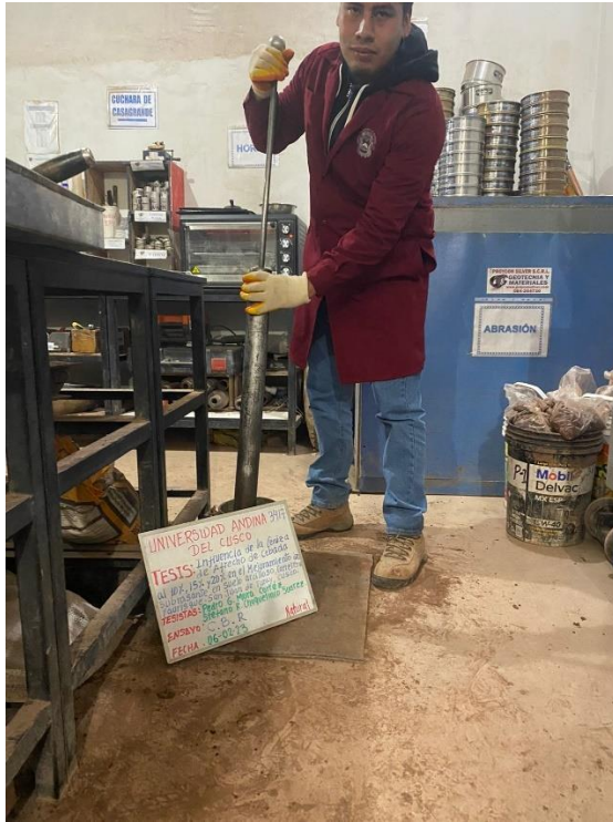
Fotografía 17: Apisonado para el ensayo de CBR
