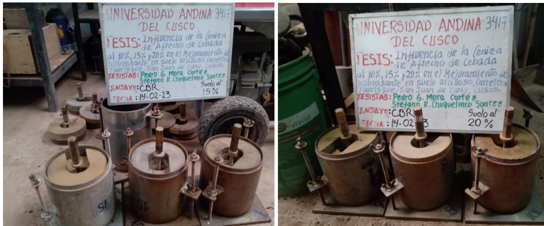
Gráfico 32-33 Muestras de CBR compactadas y con pesas
