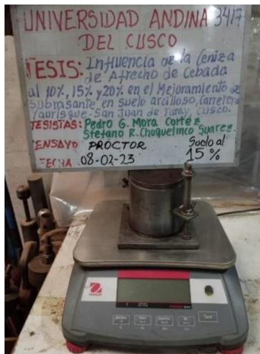
Gráfico 25 Toma del peso de las muestras para el ensayo de Proctor Modificado Suelo natural + 15% de CAC
