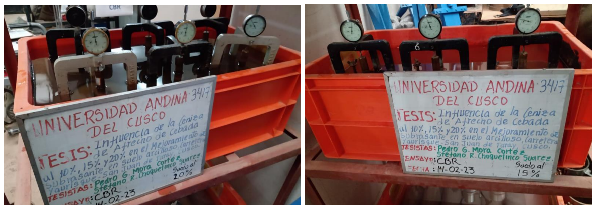
Gráfico 34-35 Muestras de CBR sumergidas en agua con trípode y dial
