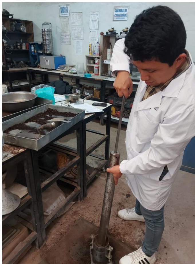
Gráfico 21 Compactación de suelo usando el pisón para Proctor Modificado
