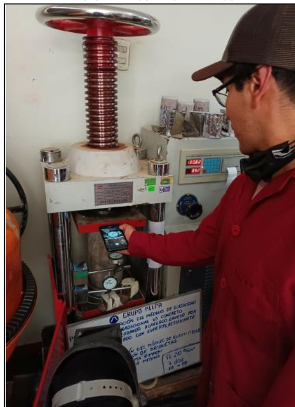
FIGURA 67 LECTURA DE LOS DEFORMÍMETROS
