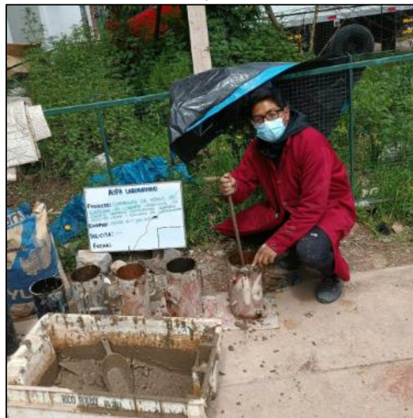
FIGURA 57 ELABORADO DE BRIQUETAS DE CONCRETO
