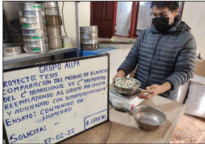
FIGURA 37 TOMA DE PESO FINAL - ENSAYO DE CONTENIDO DE HUMEDAD
