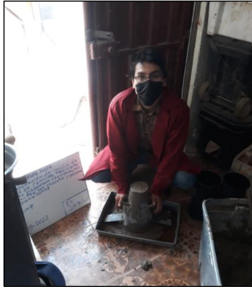
FIGURA 55 PRUEBA DE SLUMP
