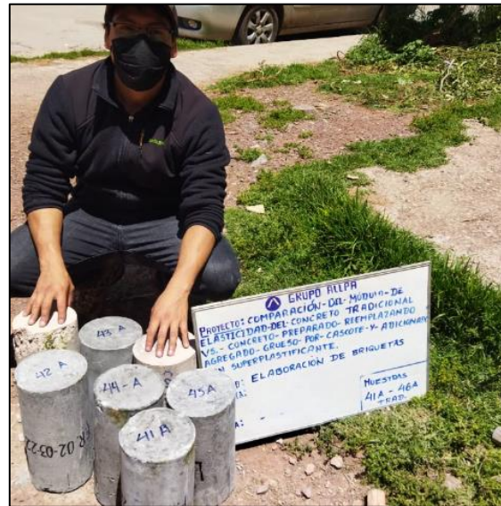
FIGURA 60 TESTIGOS DE CONCRETO
