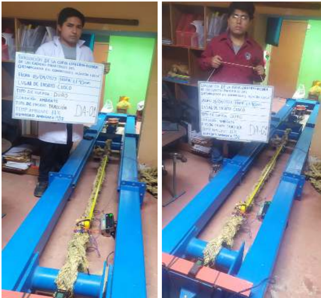
Montaje de Duro y preparación de máquina
