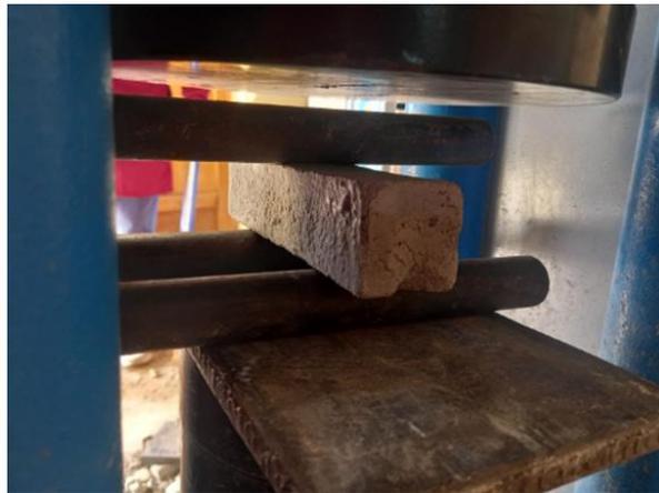
*Figura 41. Rotura y visualización de la falla en la muestra de mortero*
