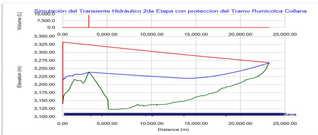
Figura N° 35 Perfil de envolventes de Sobrepresión y Subpresión Tramo_E.B. Rumicolca – E.B. Collana (con protección)
