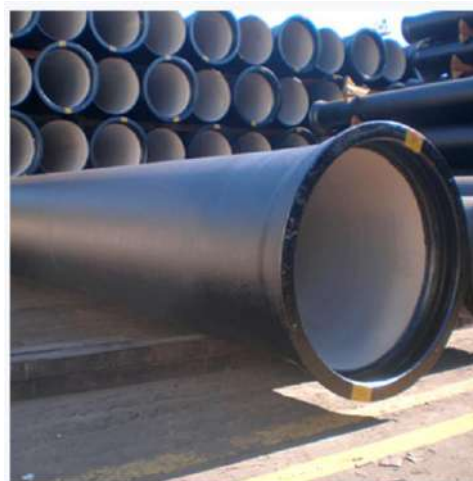
Figura N° 8 Tubería de hierro dúctil
