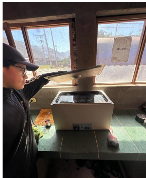
Figura N°112: Especímenes en baño maría a 25°C
