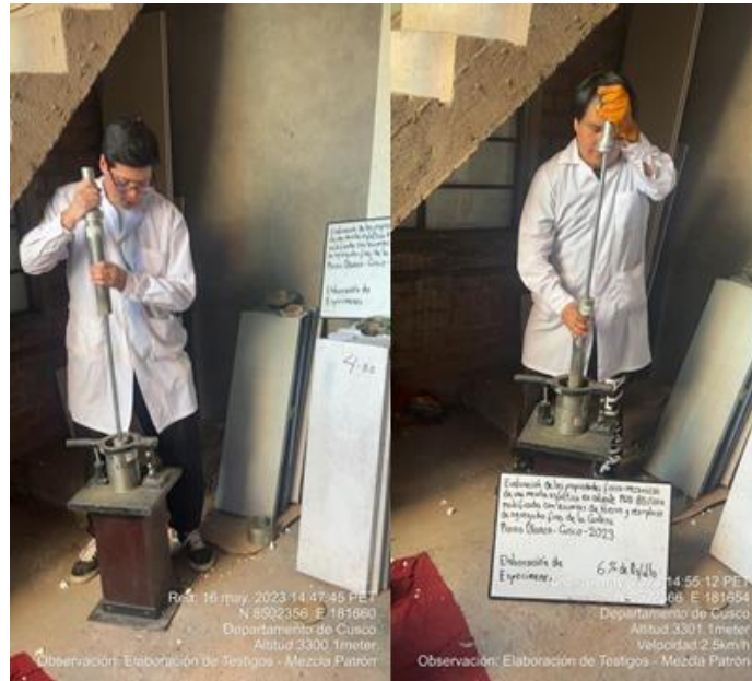
Figura N°41: Compactado de la mezcla patrón con 6.0 % de asfalto.
