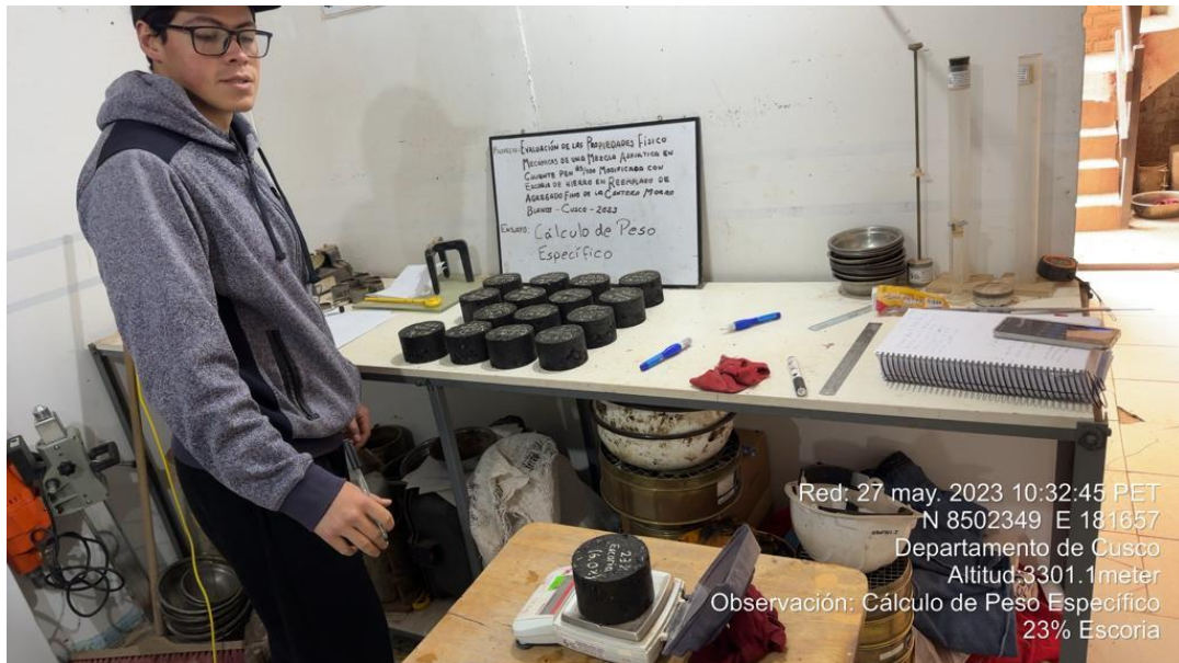
Figura N°91: Peso al aire de especímenes de MAC modificada con 23% de escoria de hierro.
