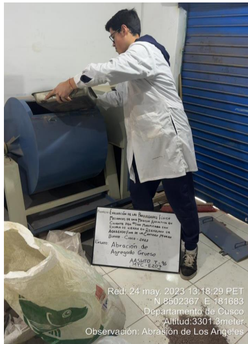
Figura N°20: Preparación de la Máquina de Abrasión (Máquina de los Ángeles)
