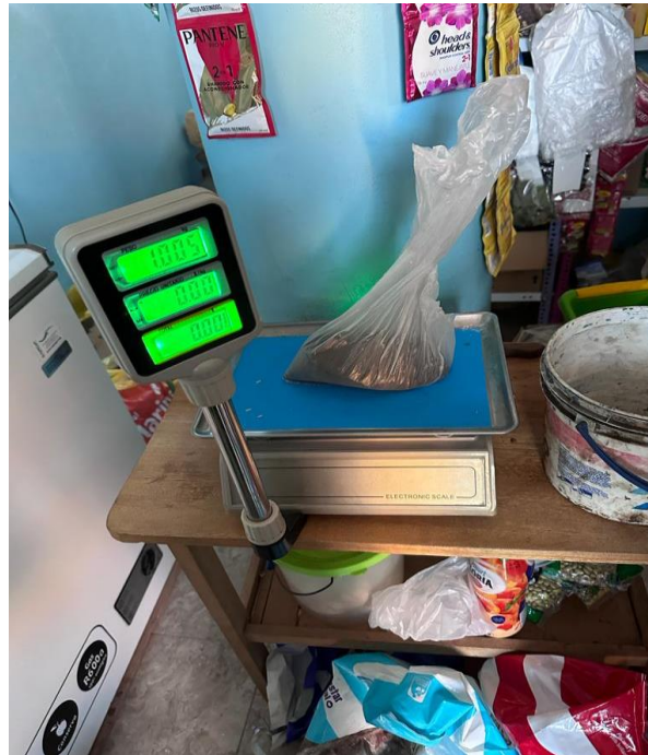
Figura N°34: Pesado de Escoria de Hierro Segregada con Malla de 200 mm de abertura.
