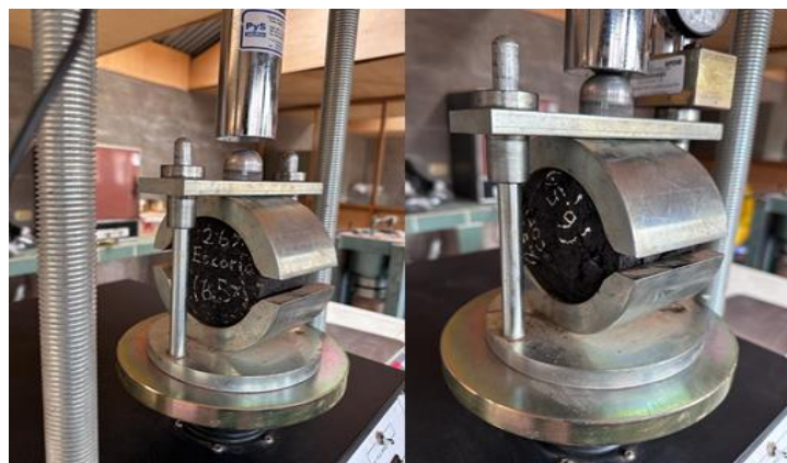
Figura N°99: Colocado del cabezal de ruptura con el espécimen en la máquina de carga a compresión
