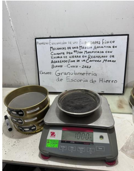
Figura N°35: Ensayo Granulométrico de Escoria de Hierro Reciclado.
