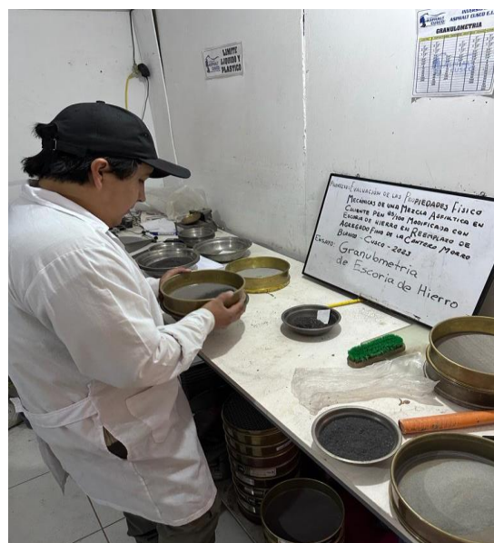
Figura N°36: Ensayo Granulométrico de Escoria de Hierro Reciclado.
