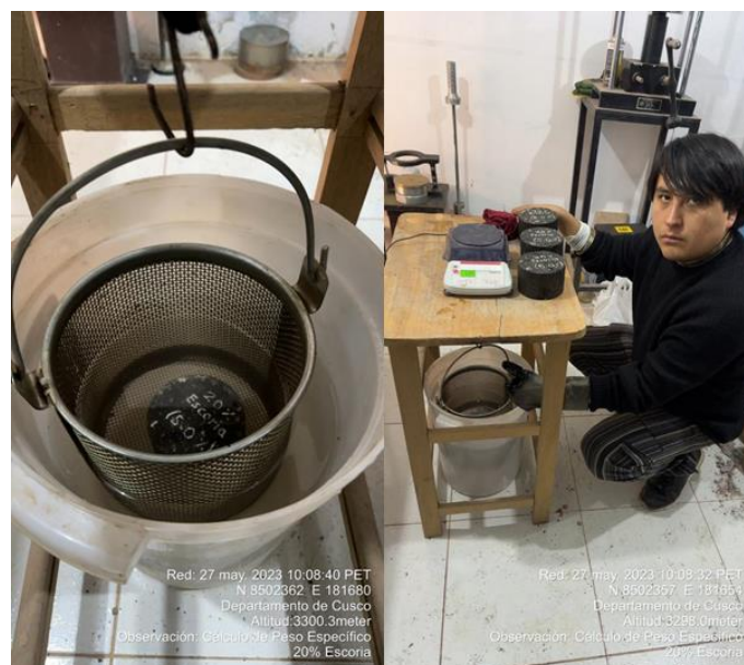
Figura N°90: Peso sumergido de especímenes de MAC modificada con 20% de escoria de hierro.
