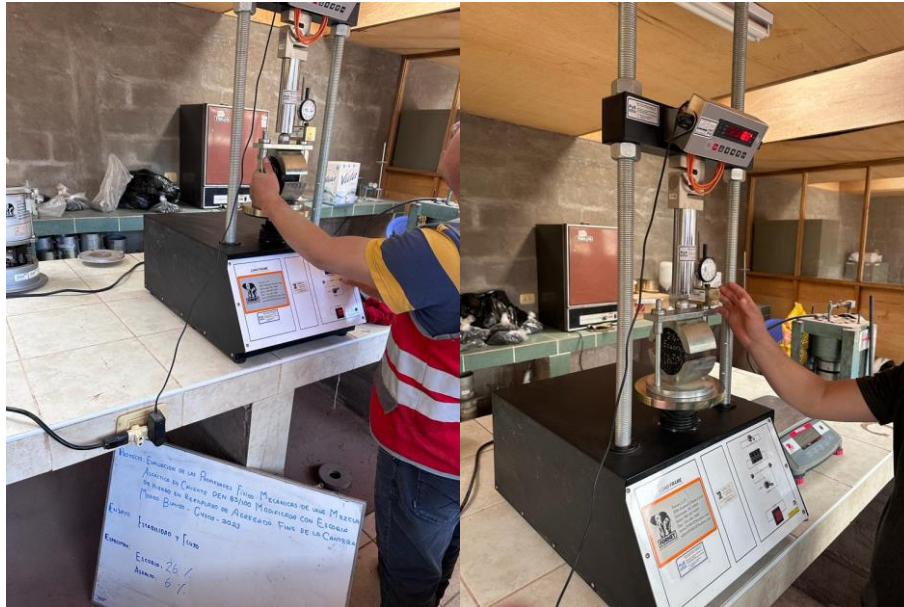
Figura N°110: Evaluación de estabilidad y flujo de la MAC con 26% de escoria de hierro, para 6.0% y 6.5% de asfalto.
