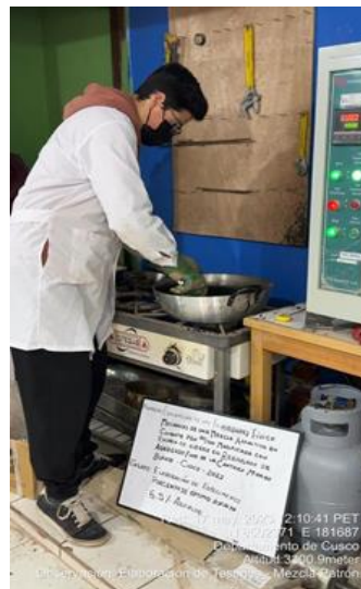
Figura N°42: Mezclado de agregados para elaboración de especímenes con 6.5% de asfalto.
