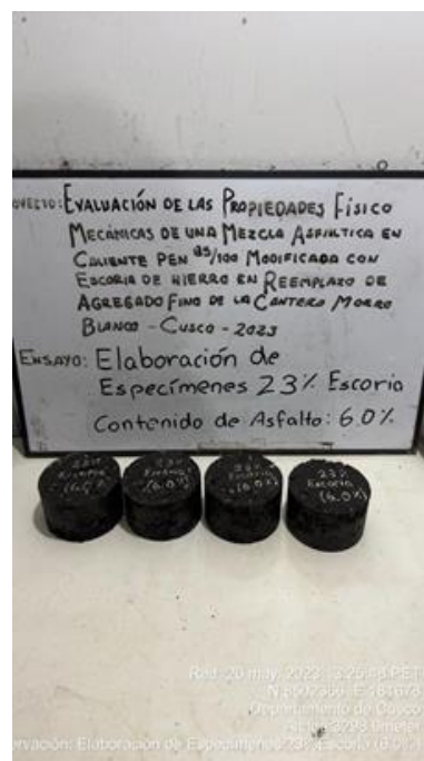
Figura N°71: Especímenes extraídos elaborados con 23% de escoria de hierro y con 6.0% de asfalto.
