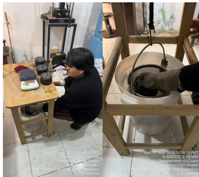
Figura N°92: Peso sumergido de especímenes de MAC modificada con 23% de escoria de hierro.
