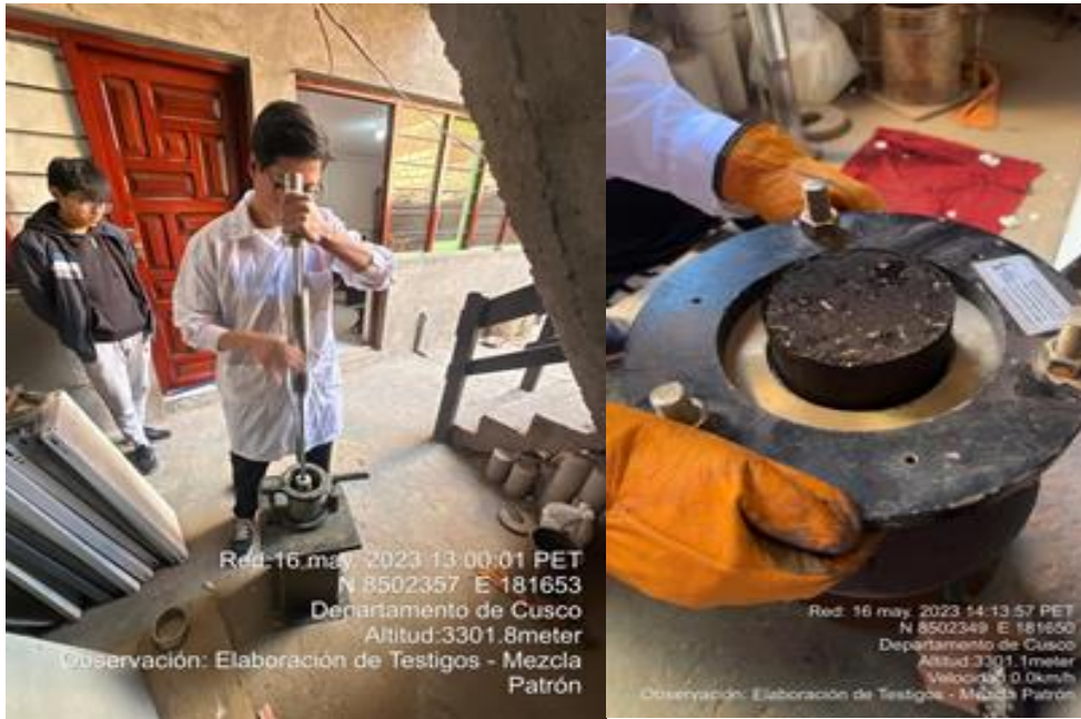
Figura N°39: Compactado y extracción de la mezcla patrón con 5.5 % de asfalto.
