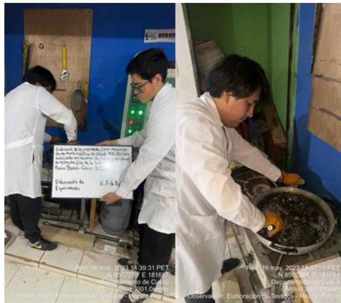
Figura N°40: Mezclado de agregados para elaboración de especímenes con 6.0% de asfalto.
