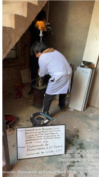
Figura N°70: Compactado de la mezcla asfáltica elaborada con 23% de escoria de hierro y con 6.0% de asfalto.
