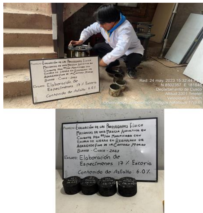
Figura N°53: Extracción de especímenes elaborados con 17% de escoria de hierro y con 6.0% de asfalto.
