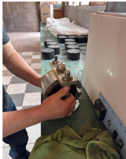
Figura N°98: Colocado del espécimen en el cabezal de ruptura.
