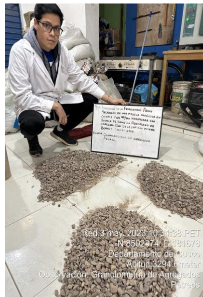
Figura N°10: Cuarteo de muestra de agregado Grueso.
