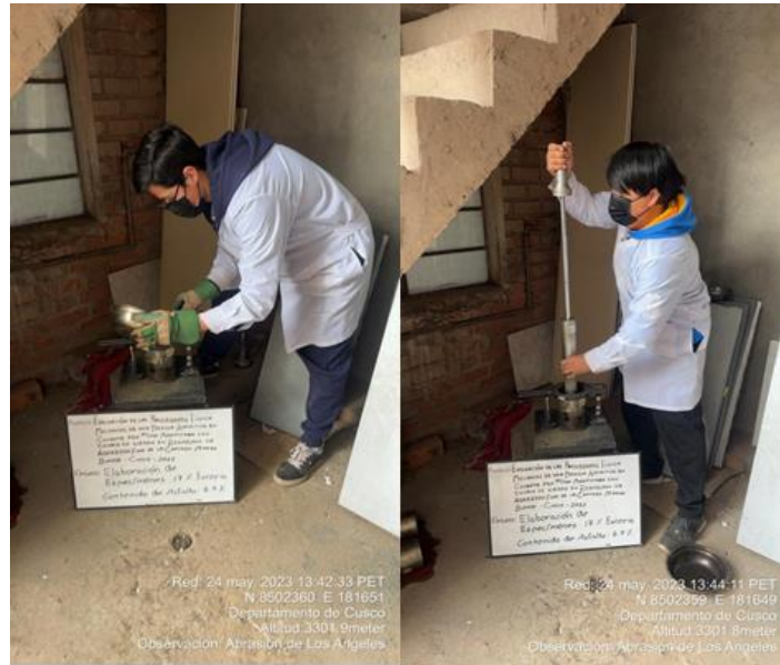
Figura N°52: Compactado de la mezcla asfáltica elaborada con 17% de escoria de hierro y con 6.0 % de asfalto.
