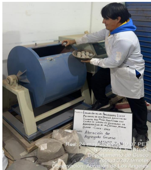
Figura N°21: Inserción de Esferas Metálicas para el Ensayo de Abrasión
