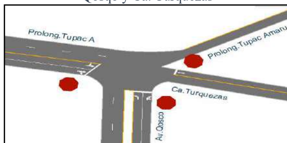
Figura 122: Identificación de desplazamientos en la Intersección de Prolong.Av. Tupac Amaru, Av. Qosqo y Ca. Turquezas
