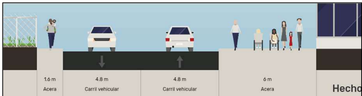
Figura 382: Sección transversal actual en la Intersección Av. Cusco y Av. Marcos Sapaca, vista Este.
