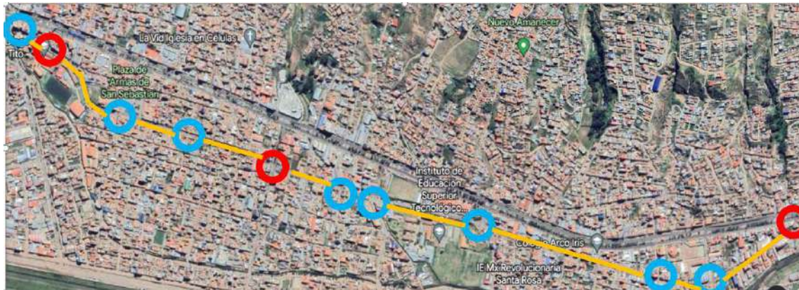
Figura 11. Tramo II, Av. Cusco y Av. Alemania Federal, intersecciones no semaforizadas (azul) e intersecciones semaforizadas (rojo)
