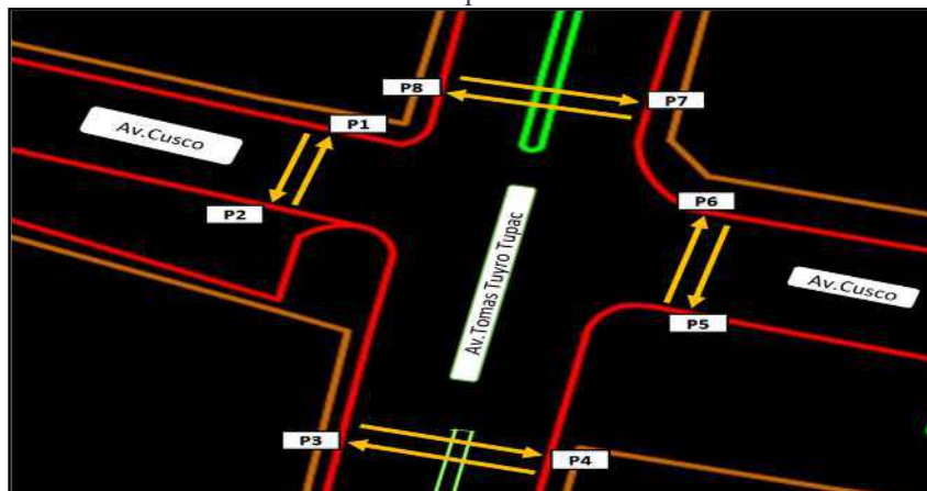
Figura 110: Codificación direccional de peatones y ciclistas en la Intersección Av. Cusco y Av. Tuyo Tupac.
