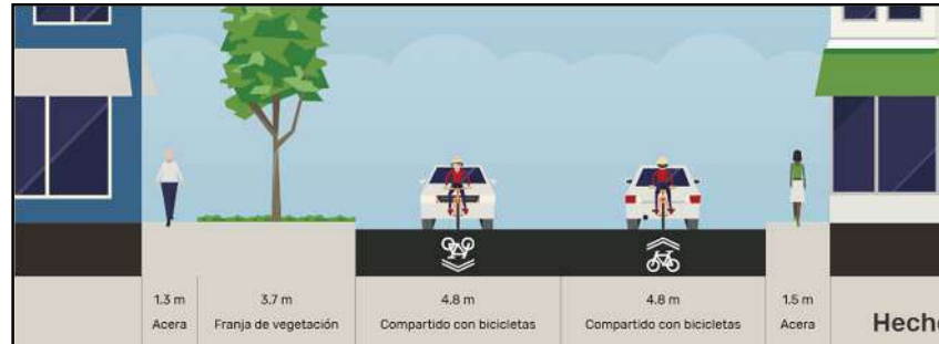
Figura 364:Sección transversal diseñada en la Intersección Av. Cusco y colegio Diego Quispe Tito, vista Este.
