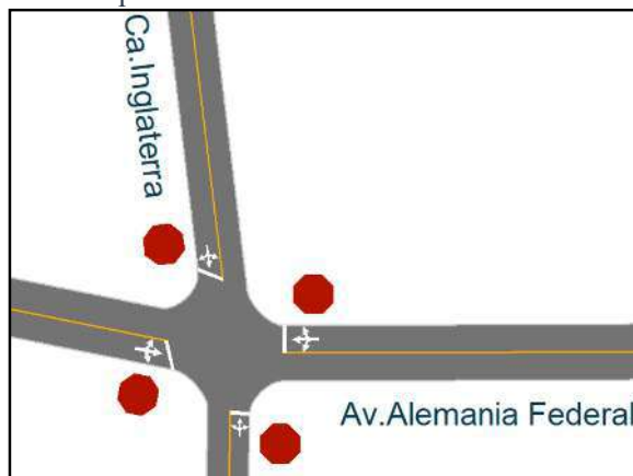
Figura 222: Identificación de desplazamientos en la Intersección Av. Alemania Federal y Inglaterra.
