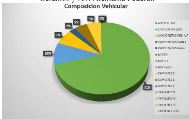
Figura 212: Composición Vehicular en la Intersección Av. Cusco, Prolong. Av. Cusco, Ca. Los Geranios y Av. Alemania Federal.
