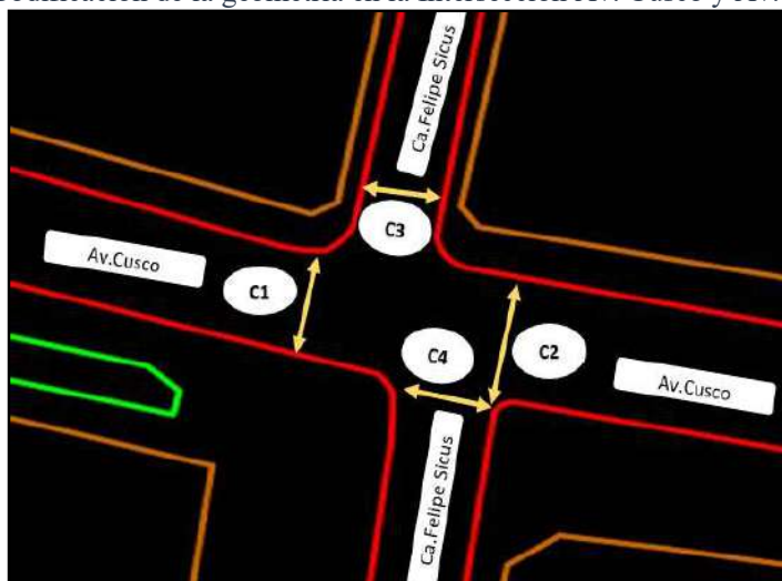
Figura 91: Codificación de la geometría en la Intersección Av. Cusco y Av. Felipe Sicus.
