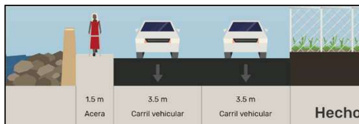
Figura 398:Seccion transversal actual en la Intersección Av. Alemania Federal y Av. De la Cultura, vista Sur.
