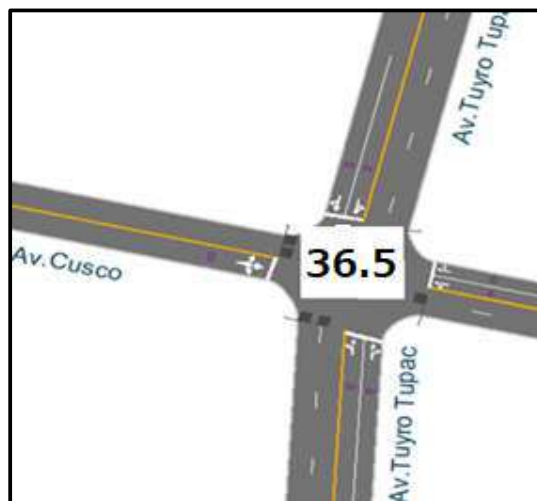
Figura 296: Obtención de demora en la Intersección Av. Cusco y Av. Tuyro Tupac.
