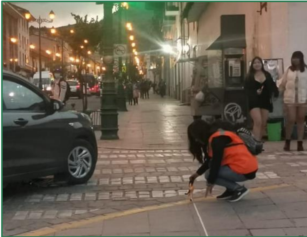
Figura N° 37. Toma de características geométricas de la vía
