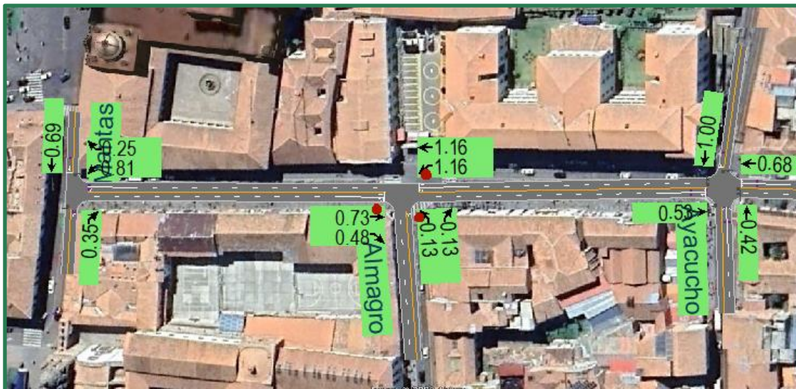
Figura N° 80. Relación de v/c de las tres primeras intersecciones por movimientos permitidos en la situación actual
