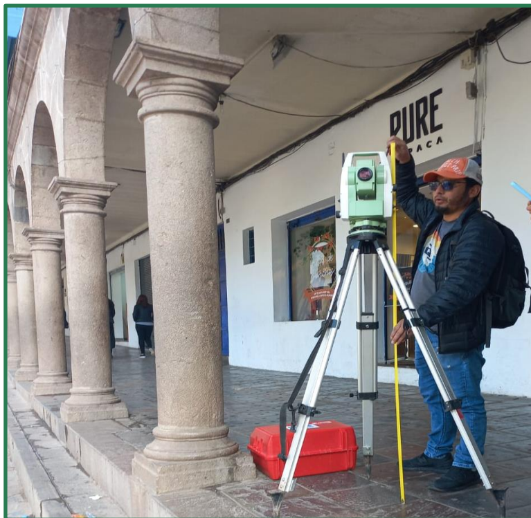
Figura N° 34. Instalación de la Estación Total
