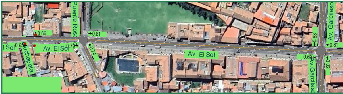
Figura N° 95. Relación de v/c de la cuarta a la sexta intersección por movimientos permitidos con efecto de la ola verde
