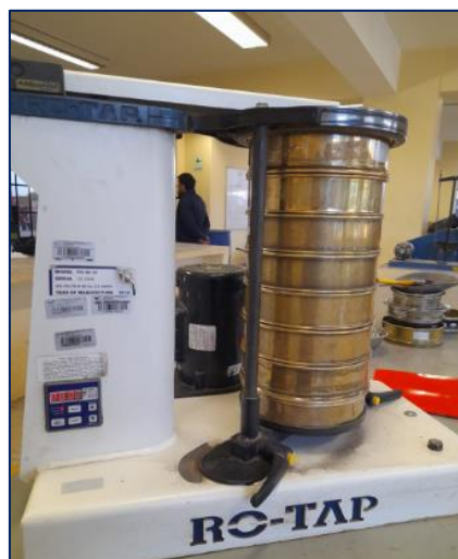
Figura 13: Agregados en la maquina tamizadora
