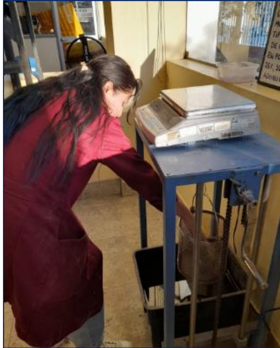
Figura 63: Tesista colocando el adoquín en la canastilla
