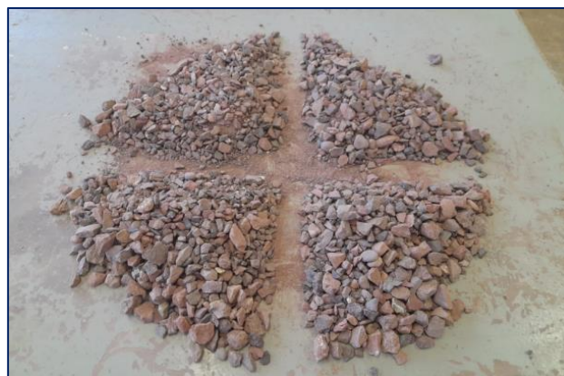
Figura 30: Cuarteo de agregado grueso
