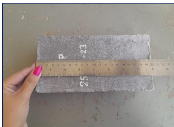
Figura 55: Toma de medidas del adoquín
