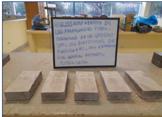
Figura 67: Adoquines Patrón para ensayo de compresión
