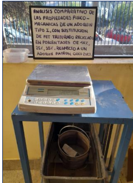
Figura 58: Adoquín en la canastilla metálica
