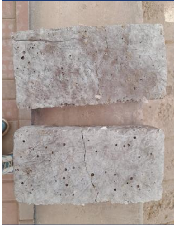
Figura 74: Adoquines luego de ser sometidos al ensayo de flexión
