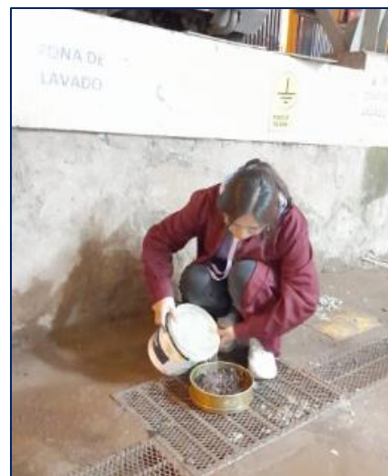
Figura 11: Lavado de agregados en malla N° 200 y N° 16
