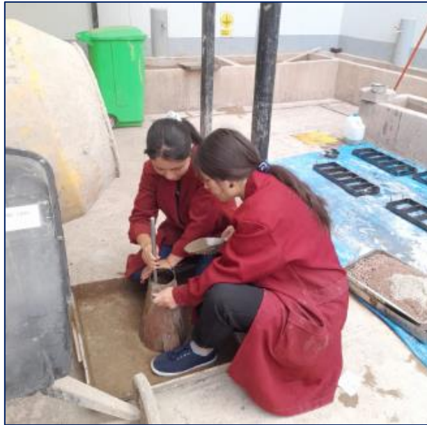
Figura 44: Tesistas realizando el ensayo de Cono de Abrams
