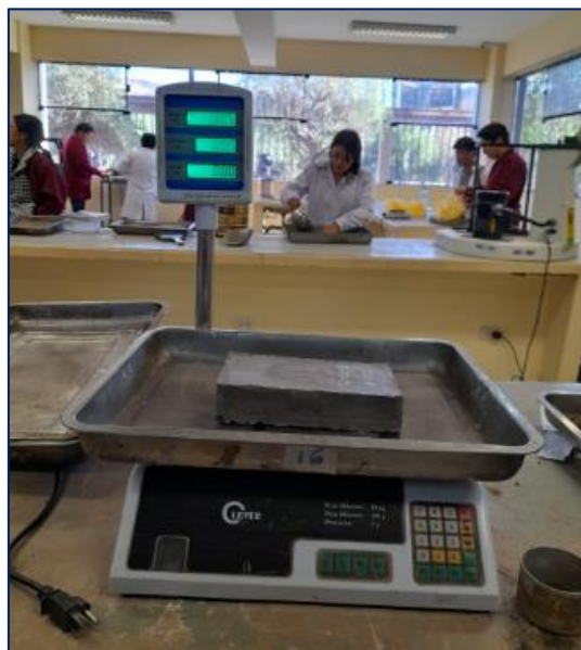
Figura 57: Registro del peso saturado de una unidad de adoquín
