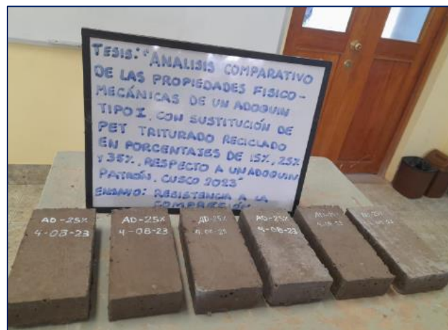
Figura 68: Adoquines con PET para ensayo de compresión
