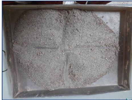
Figura 9: Cuarteo del agregado fino
