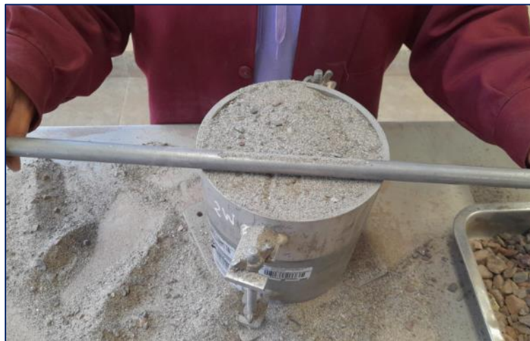
Figura 34: Enrazado de los agregados al nivel del cilindro metálico
