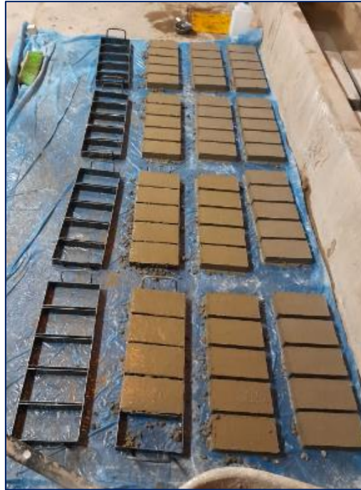
Figura 50: Vaciado de adoquines con sustitución de PET en 15%, 25% y 35%
