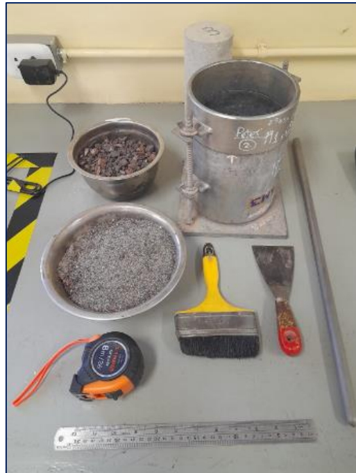
Figura 31: Equipo que se usó en el ensayo
