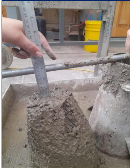
Figura 46: Prueba de SLUMP
