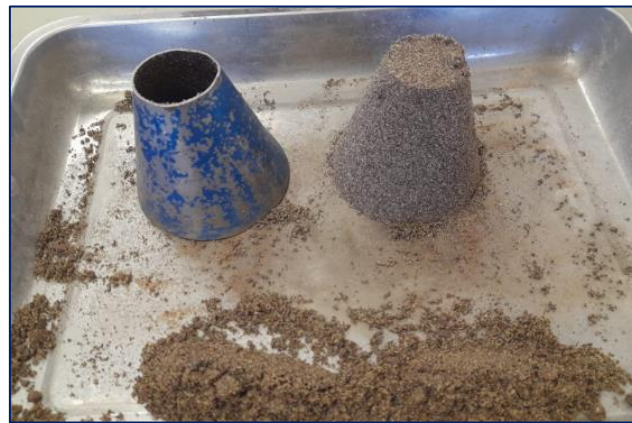
Figura 21: Agregado fino superficialmente seco
