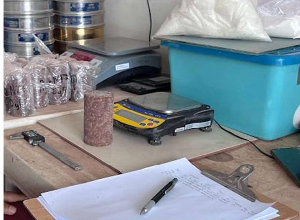
**Fig 54. Extracción de muestra para la humedad**
