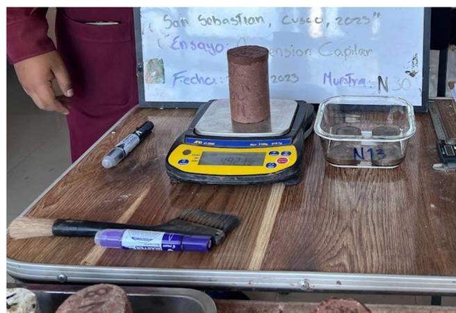
**Fig 59. Ensayo de Ascension Capilar**
