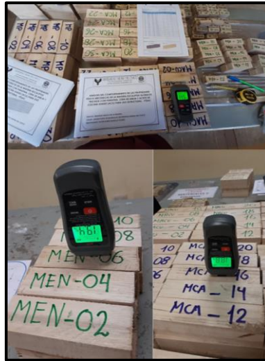
Figura N°52. Verificación del contenido de humedad de las muestras de madera.
