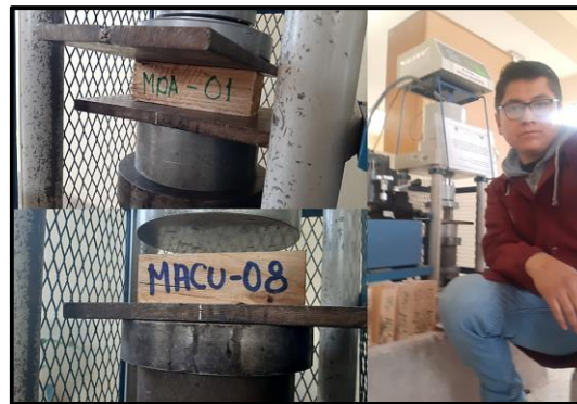
Figura N°58. Proceso de ensayo de resistencia a la compresión perpendicular en las muestras de madera.
