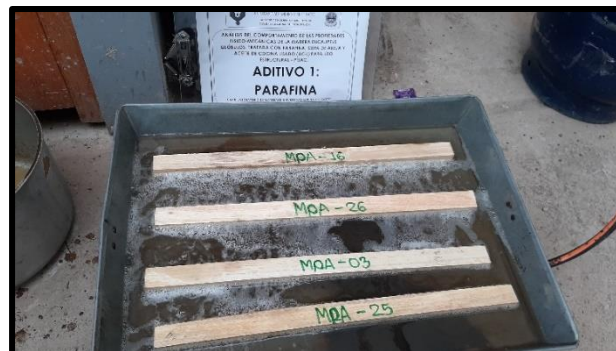
-Proceso de tratamiento de muestras de madera eucaliptus glóbulos con parafina, muestras de 2.5cm x 2.5cm x 41cm para el ensayo de resistencia a la flexión.
