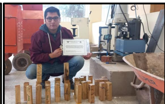
-Ensayo de resistencia a la compresión paralela al grano de las muestras tratadas con parafina.
