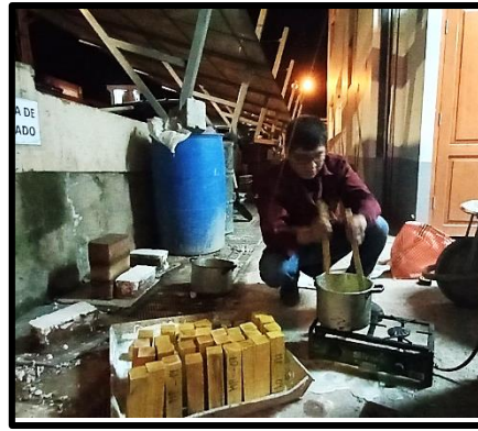
-Proceso de tratamiento de muestras de madera eucaliptus glóbulos con cera de abeja, en el patio del laboratorio.
