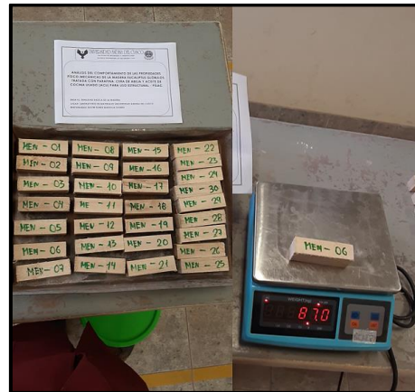
Figura N°54. Retiro de las muestras para su pesaje correspondiente.
