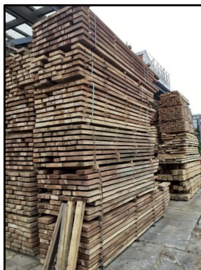
Figura N°05. Secado de la madera al aire.
