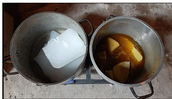
Figura N°47. Cambio de estado sólido a liquido de la parafina y la cera de abeja.
