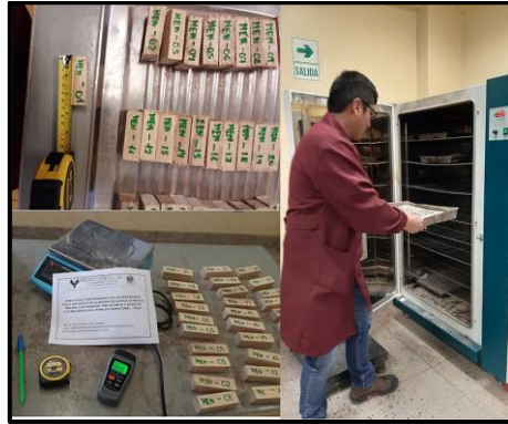
Figura N°53. Medición de las muestras y su ingreso al horno.
