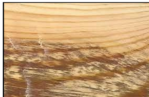
Figura N°26. Colapso de Madera.
