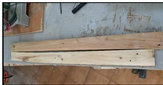
Figura N°25. Alabeo de una Madera.
