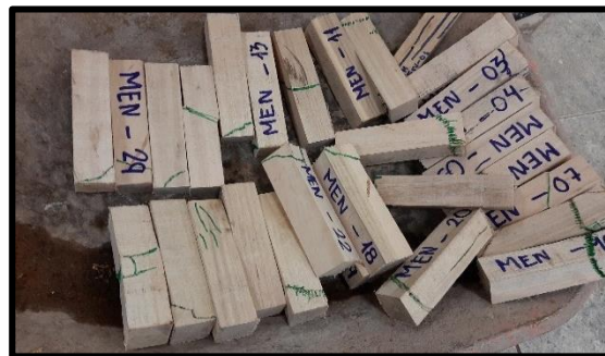
-Muestras de madera en estado natural con fisuras después del ensayo de resistencia a la compresión paralelo al grano
