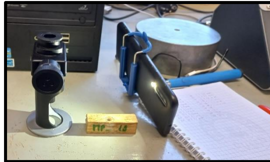
-Lectura de la huella de la billa del ensayo de dureza por el método de Brinell en las muestras tratadas con
