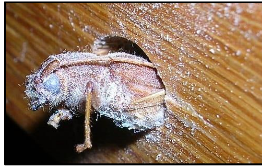
Figura N°24. Perforacion por Agentes excavadores.
