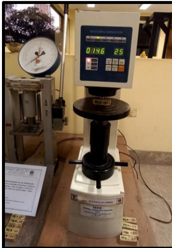
-Ensayo de dureza por el método de Brinell, para las muestras en estado natural.
