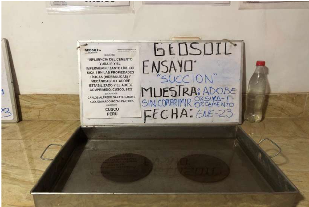
Figura 31: Ensayo de Succión de los adobes.
