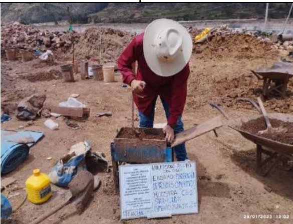
Apisonado con varilla de acero para sacar espacios vacíos.
