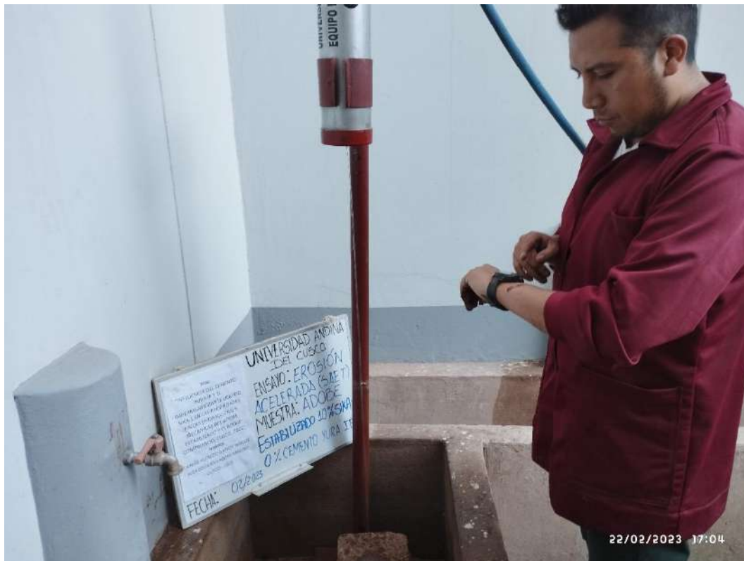
Figura 41: Toma de tiempo en ensayo de erosión.
