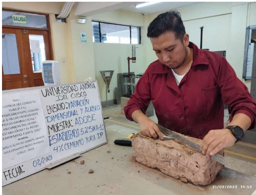
Figura 54: Ensayo de Alabeo de los adobes compactados y sin compactar
