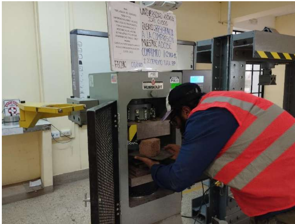
Figura 46: Ensayo de compresión del adobe.
