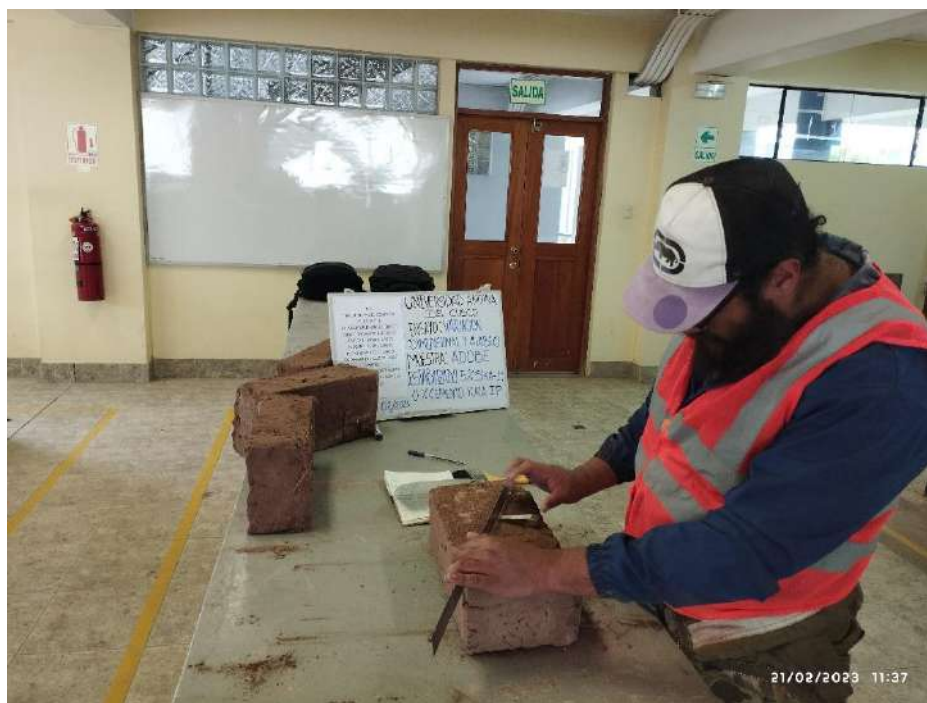
Figura 53: Toma de datos de el ensayo de alabeo.
