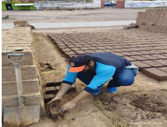
Elaboracion de cubos de adobe de 10cm de arista para el ensayo de resistencia a la compresion.
