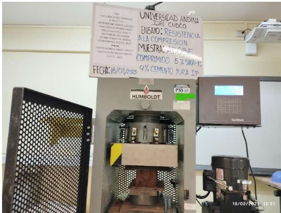
Figura 50: Proceso de compresión del adobe comprimido.
