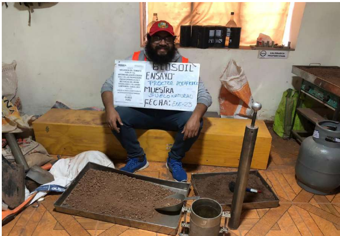
Figura 29: Equipos y materiales para el ensayo de Proctor Modificado.
