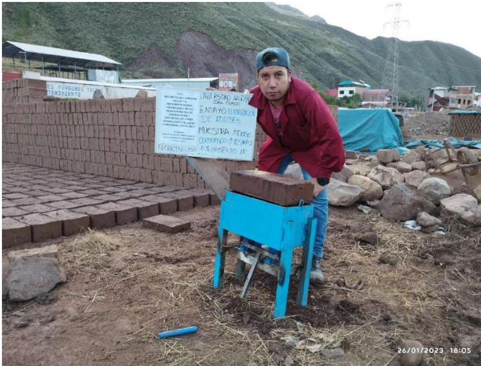
Figura 72: Adobe comprimido elaborado en maquina compresora.
