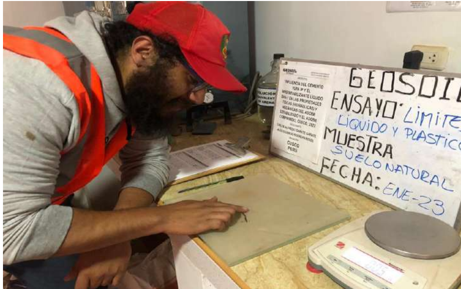
Figura 26: Forma de lograr los cilindros en Limite Plástico.
