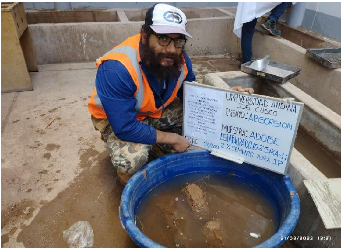
Figura 36: Ensayo de Absorción del adobe saturación de 24 horas.
