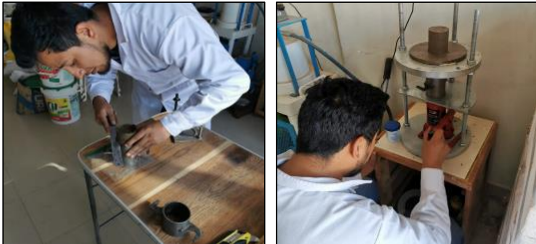
Figura 33 Enrasado y eyección de la muestra
