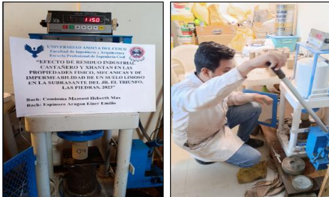
Figura 37 Muestra M-04 sometida a compresión simple.
