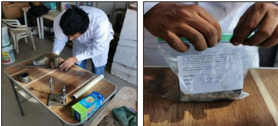
Figura 34 Impermeabilización de la muestra y etiquetado
