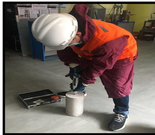
Figura 29: Disparo con esclerómetro en cara inferior con un ángulo de -90^\circ
