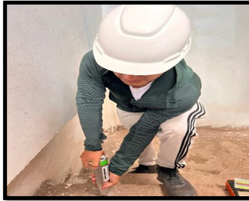
Figura 41: Toma de lectura para ensayos de esclerometría en losa
