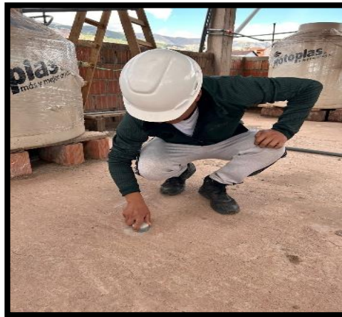
Figura 41: Toma de lectura para ensayos de esclerometría en losa
