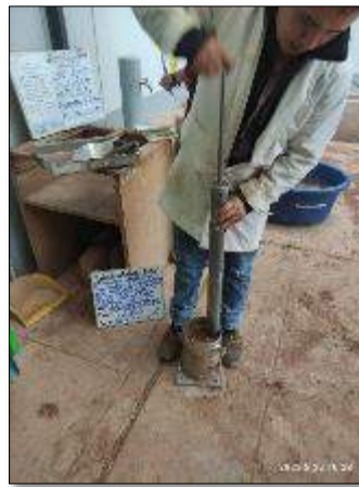
Ilustración 44: Compactación dentro del molde de 6''
