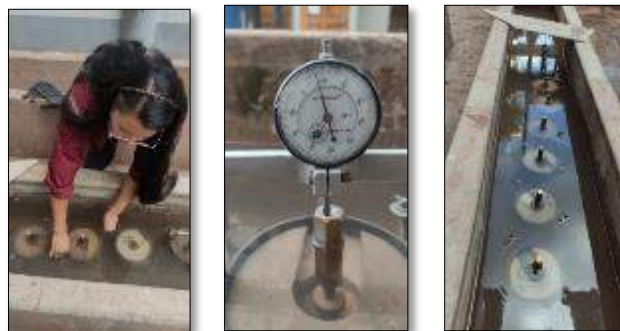
Ilustración 47: Sumergido del molde con material, pesas y placa con vástago
