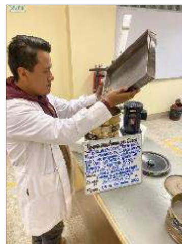
Ilustración 25: Colocado del material a los tamices y posteriormente tamizado por la maquina
