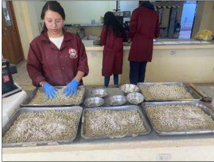
Ilustración 36: Material adicionando Yeso Hidráulico
