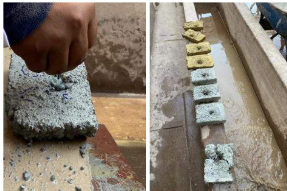
Ilustración 53: Medición de oquedad de los bloques
