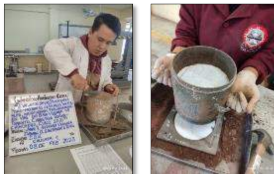
Ilustración 45: Enrasado de material y colocación de nuevo papel filtro
