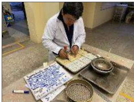
Ilustración 51: Elaboración de bloques de tierra comprimida
