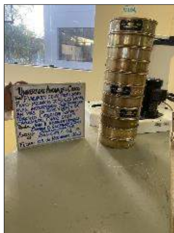
Ilustración 25: Colocado del material a los tamices y posteriormente tamizado por la maquina
