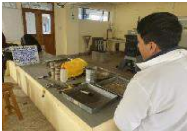
Ilustración 33: Materiales necesarios para realizar el ensayo Proctor Modificado
