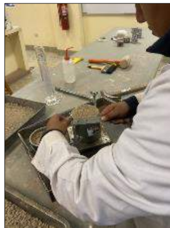
Ilustración 40: Enrasado de muestra en molde y pesaje.
