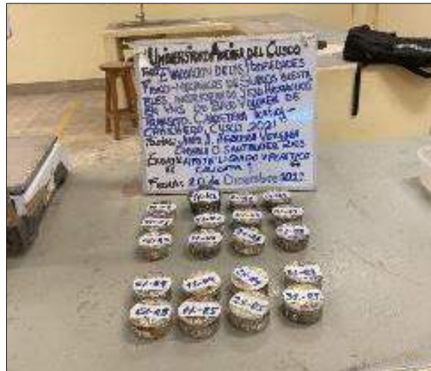
Ilustración 32: Taras con muestra de LP y LL listas para colocarse dentro del horno de secado
