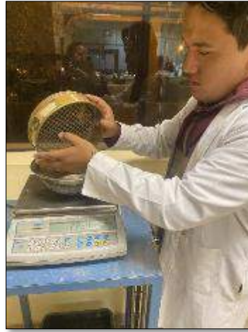
Ilustración 26: Pesado de los pesos retenidos en cada tamiz.
