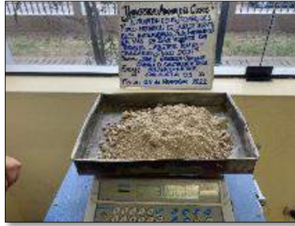
Ilustración 23: Muestra seca (3000 gr) antes del lavado
