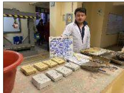
Ilustración 51: Elaboración de bloques de tierra comprimida
