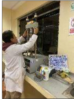
Ilustración 48: Colocación del molde con material al CBR Tester
