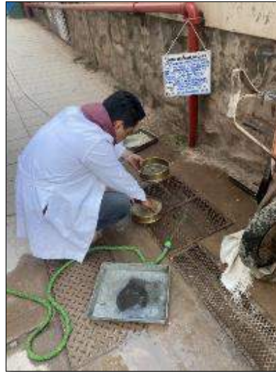
Ilustración 24: Lavado de material por la malla N°200
