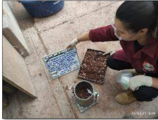
Ilustración 43: Colocación de material al molde de 6''
