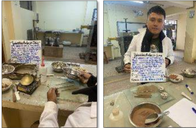
Ilustración 31: Ejecución del ensayo de límite plástico
