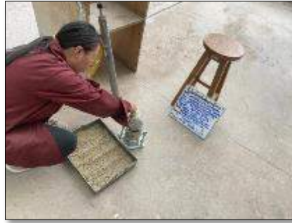
Ilustración 38: Distribución de 5 capas iguales, y colocación al molde.
