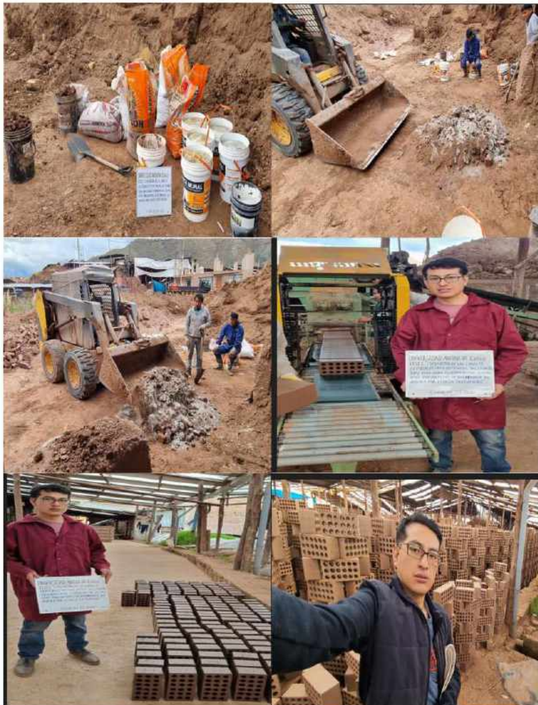
Figura 73. Proceso de elaboración de ladrillos, Mezclado, Moldeado, Secado.
