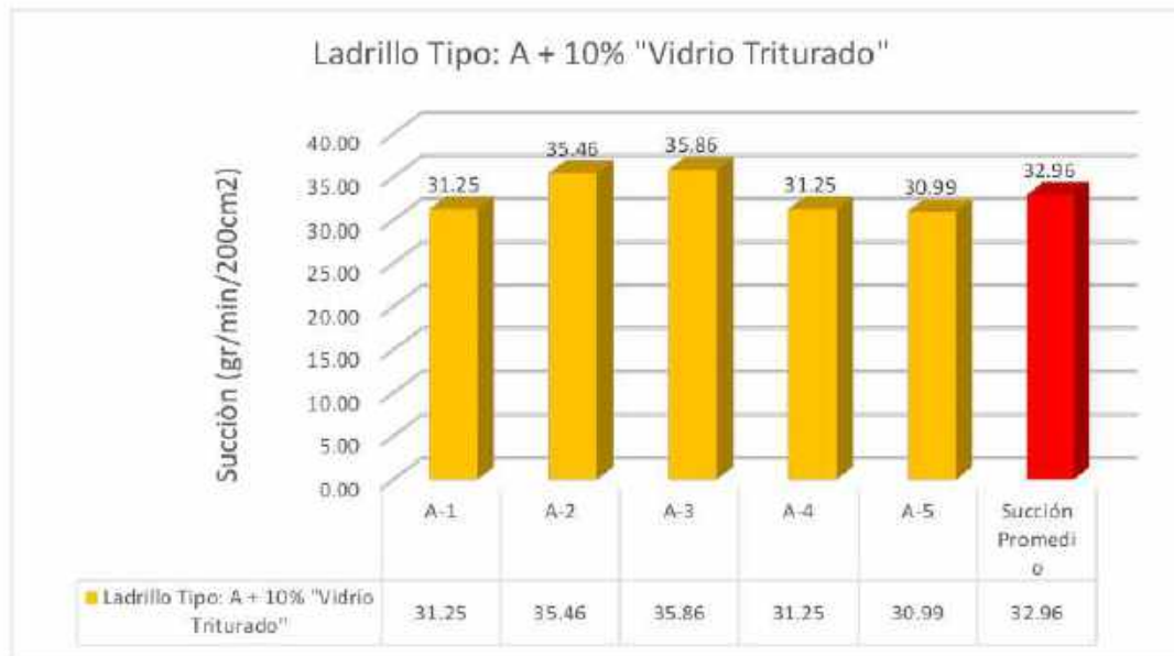
Figura 49. Gráfico de barras de Succión y promedio del ladrillo tipo: A + 10 % Vidrio Triturado.
