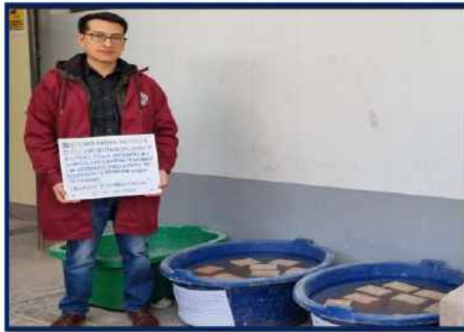
Figura 33. Ensayo de efluorescencia.
