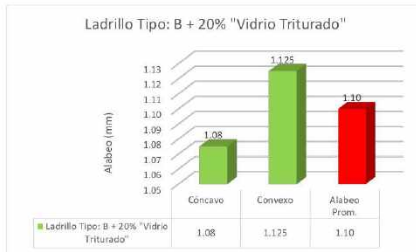
Figura 46. Gráfico de barras de Variación Dimensional de ladrillo tipo: B + 20 % Vidrio Triturado.
