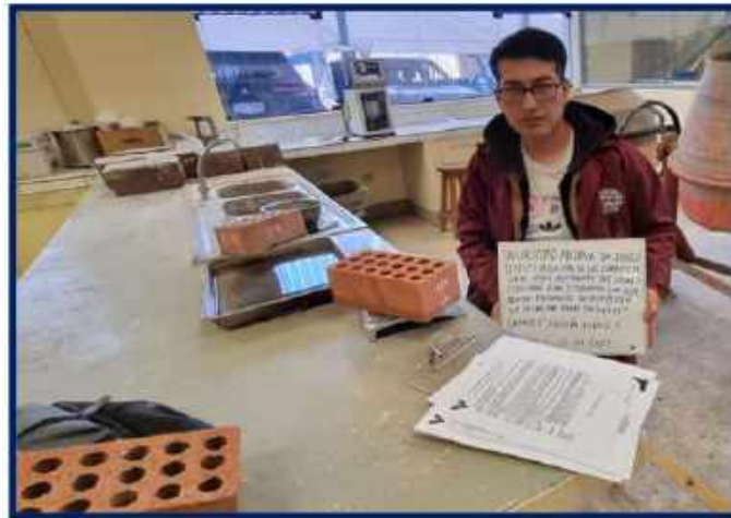
Figura 30. Toma de datos de succión.
