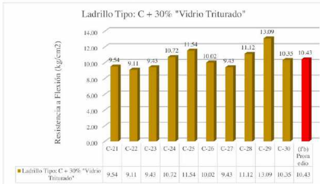
Figura 63. Gráfico de barras de Resistencia a Flexión y promedio de la resistencia ladrillo tipo: C + 30 % de Vidrio Triturado.
