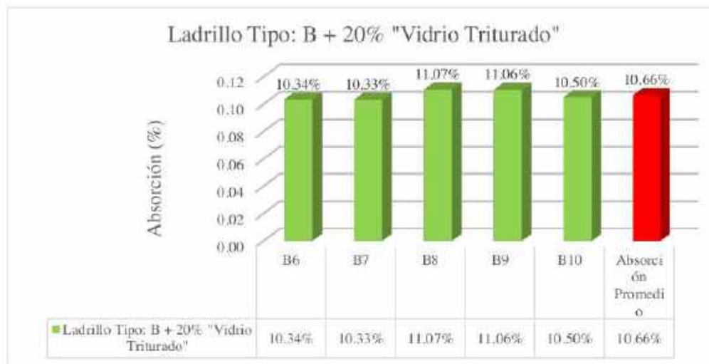
Figura 54. Gráfico de barras de valores de Absorción y promedio del ladrillo tipo: B + 20 % Vidrio Triturado.
