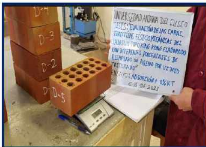
Figura 32. Toma de datos absorción.
