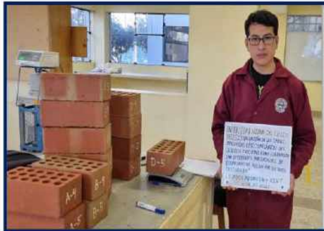
Figura 31. Toma de datos de absorción.
