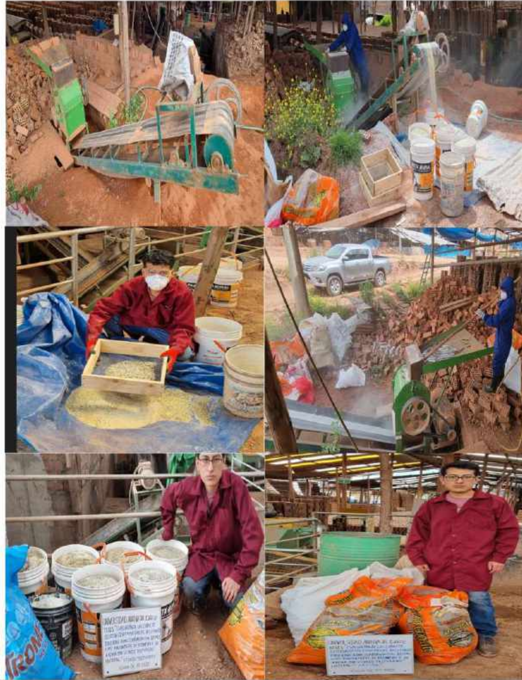
Figura 72. Proceso de Trituración de botellas de vidrio, selección de material para la investigación.
