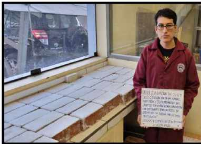
Figura 35. Unidades con refrentado de yeso para el ensayo de resistencia a la compresión.
