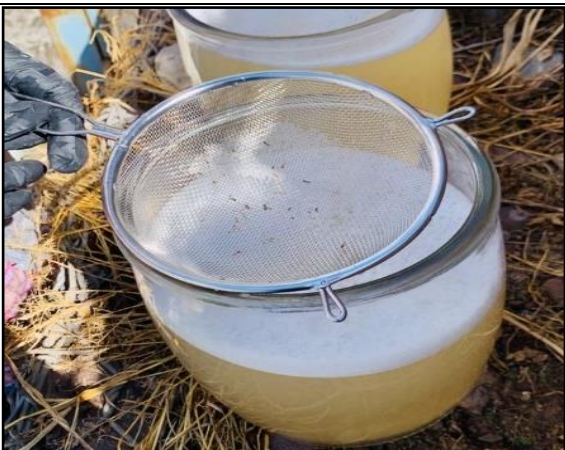
Tamizado del agua residual antes de llenar el recipiente de vidrio, para minimizar microorganismos presentes en el agua.
