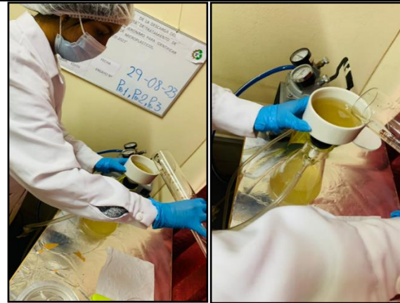
Inicio del proceso de filtrado a través de la bomba de vacío
