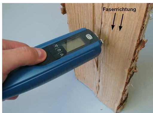
Figura 7 Contenido De Humedad De La Madera
