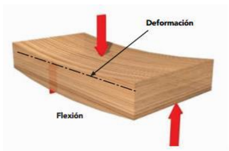
Figura 12 Esquema Del Ensayo De Flexión Estática
