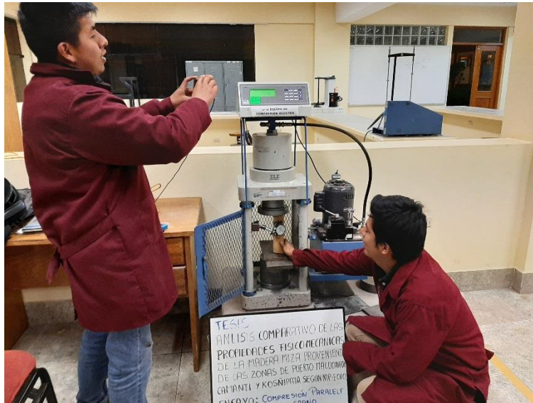
Figura 38 Registro De Ensayo De Compresión Paralela
