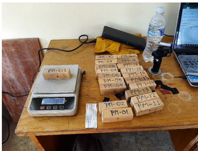
Figura 29 Probeta Pesada Después Del Horno
