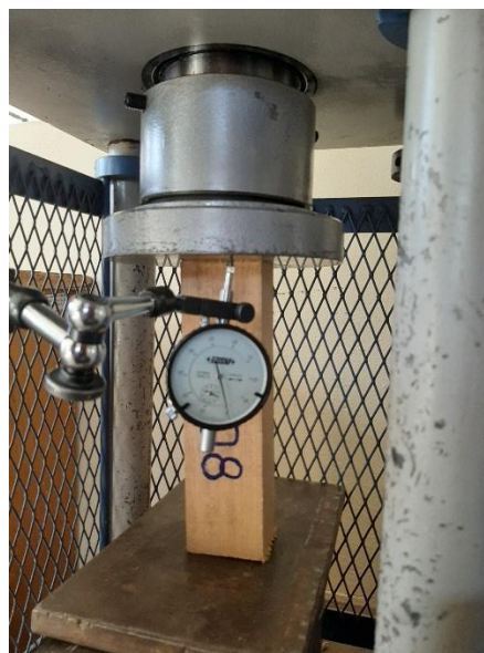
Figura 37 Colocación De La Probeta En La Máquina De Compresión
