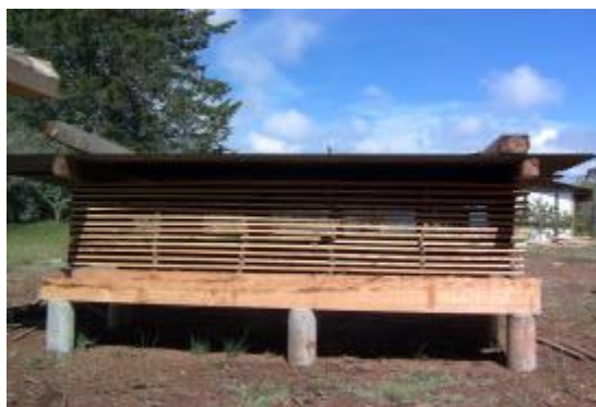
Figura 3 Secado De Tablones De Madera Al Aire
