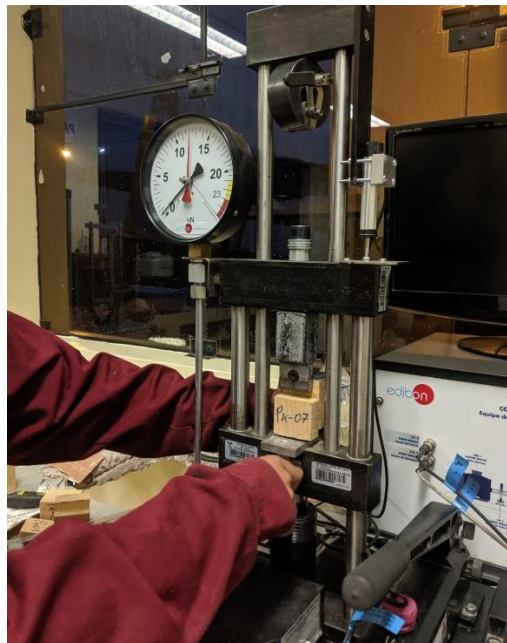
Figura 34 Ensayo De Cizallamiento Paralelo Al Grano
