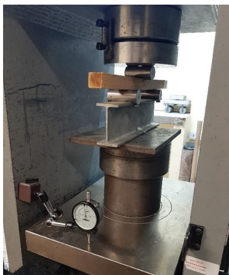
Figura 43 colocación de las probetas en la máquina de compresión
