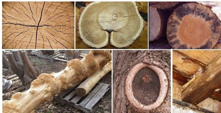
Figura 5 Defectos De La Madera
