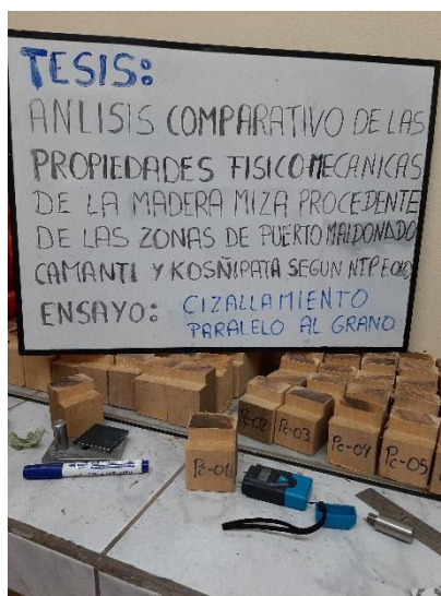
Figura 30 Probeta De Ensayo De Cizallamiento Paralelo Al Grano
