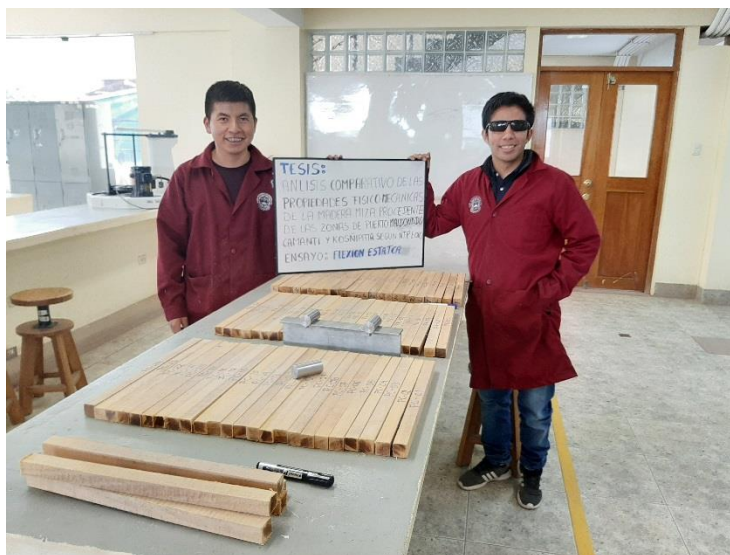
Figura 42 Acondicionamiento De Las Probetas Para El Ensayo
