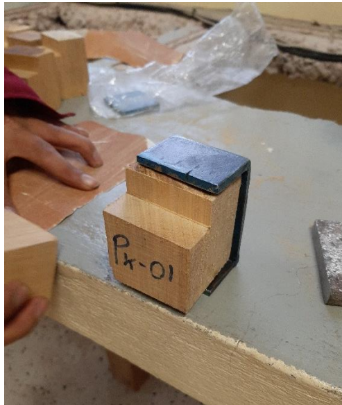
Figura 33 Probeta Acondicionada Con La Pieza De Metal Para El Ensayo
