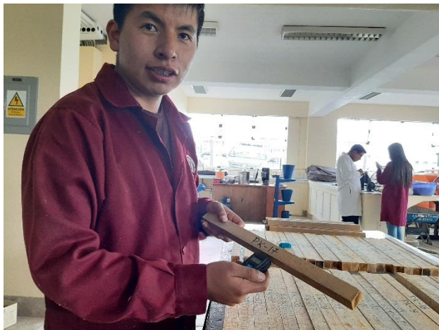
Figura 41 Medición Del Contenido De Humedad
