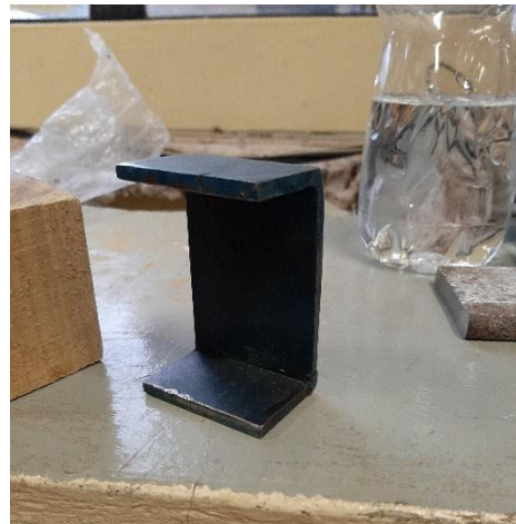
Figura 32 pieza de metal para sujetar las probetas
