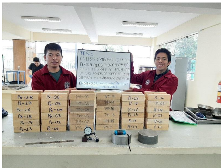
Figura 39 medición de dimensiones y contenido de humedad de las probetas
