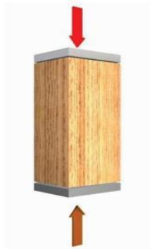
Figura 10 Esquema Del Ensayo De Compresión Paralela Al Grano
