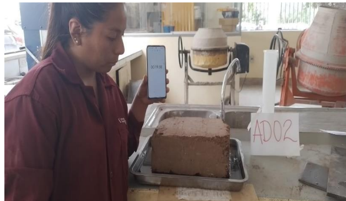
Figura 19: Muestras representativas para en ensayo de succión del adobe con cemento
