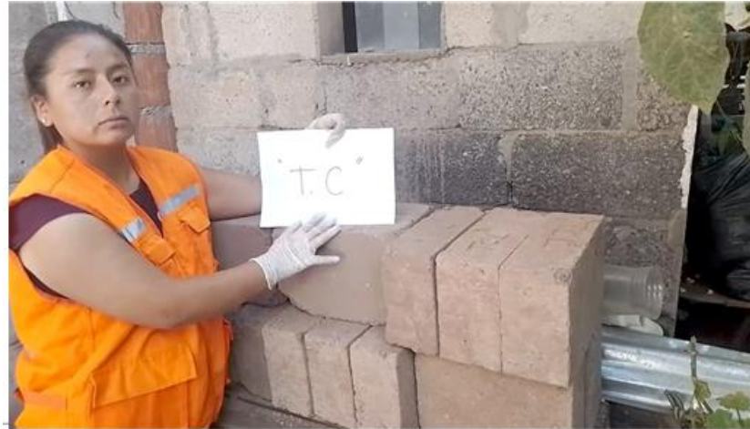
Figura 19: Muestras representativas para en ensayo de succión del adobe con cemento
