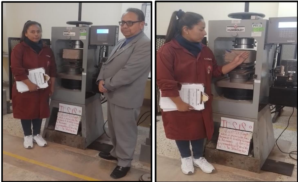
Figura 21: Unidades de albañilería, para el ensayo de resistencia a la compresión con Sika 1
