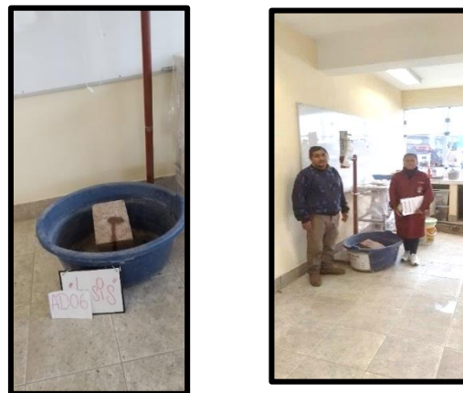
Figura 16: Unidades de albañilería, para el ensayo de alteración por erosión del adobe con Sika 1.
