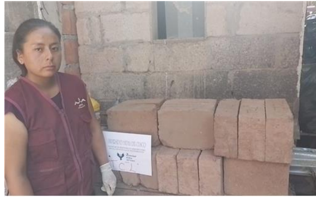
Figura 13: Unidades de albañilería, para el ensayo de absorción con cemento.
