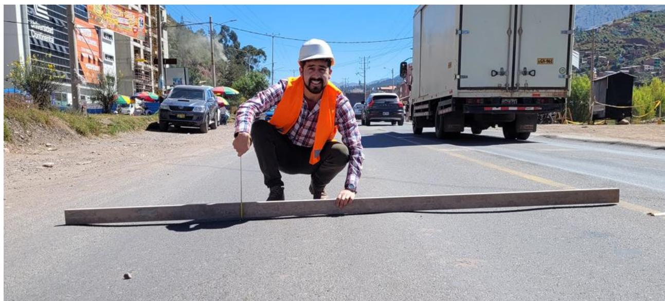
*Figura 77: Ahuellamiento de 1.5cm de profundidad en la estación Universidad Continental Carril Bajada*
