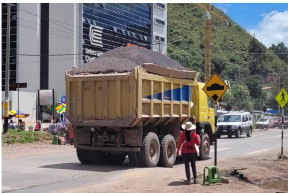
*Figura 67: Camión volquete C3 con sobrecarga en estación de conteo Universidad Continental carril subida*
