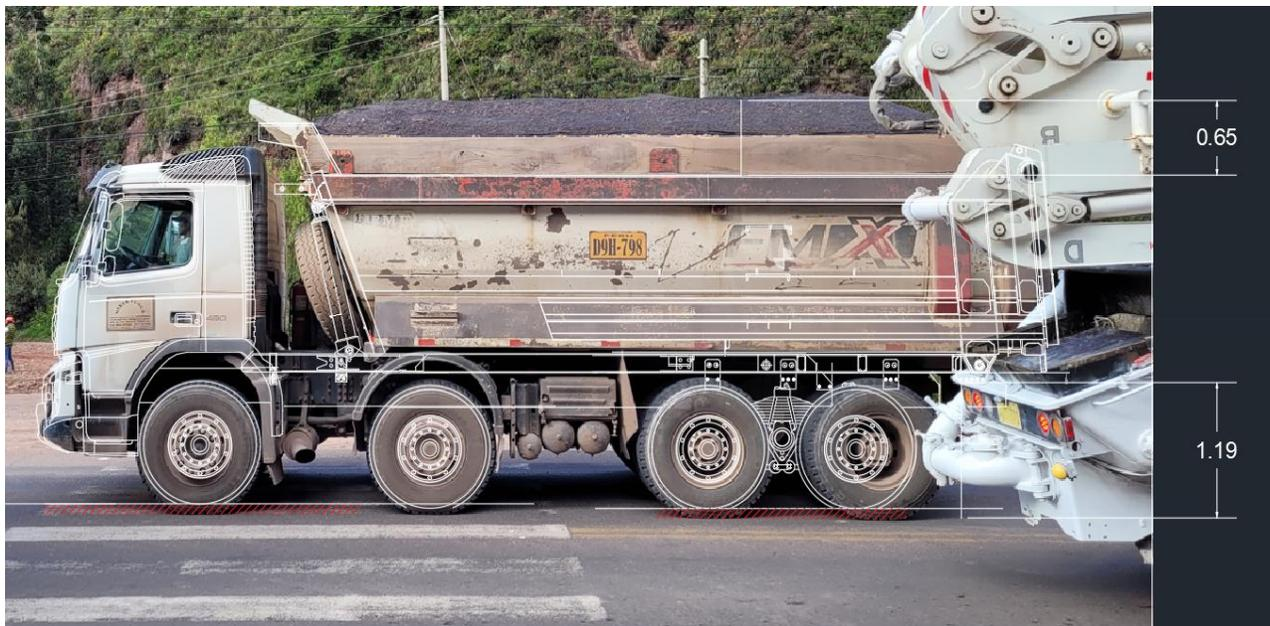
Figura 46: Camión volquete 8x4 sobrecargado escalado en Autocad
