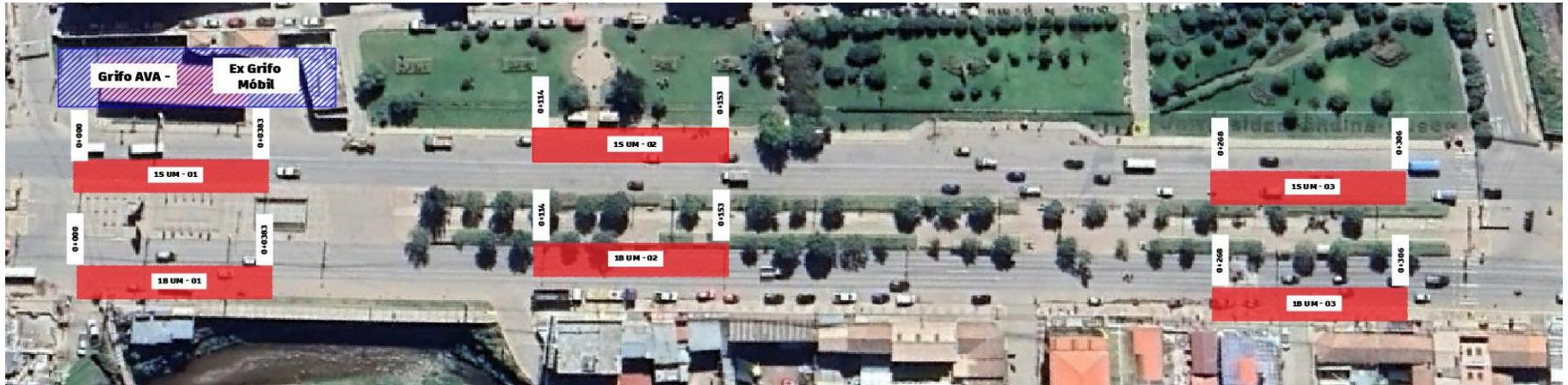
Figura 78: Unidades de muestra progresivas 0+000 a la 0+306 carriles subida y bajada
