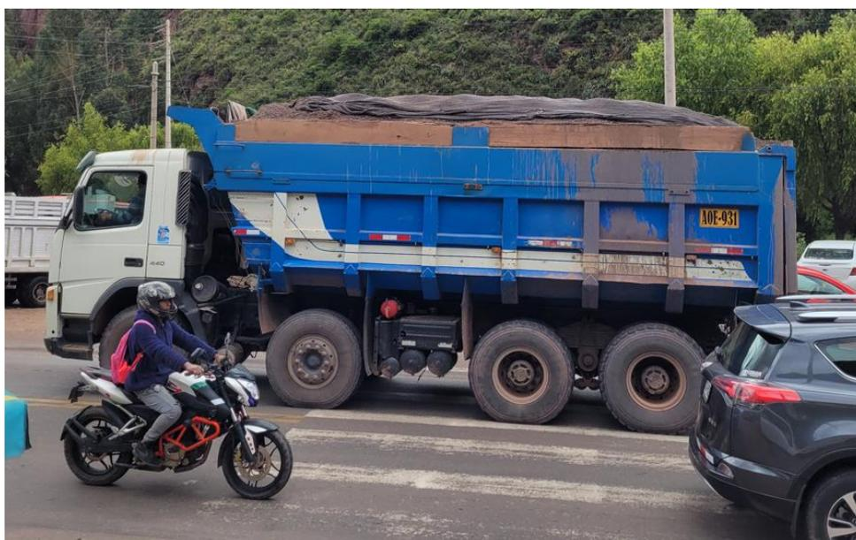
*Figura 69: Camión volquete 8x4 con sobrecarga en estación de conteo Universidad Continental carril subida*
