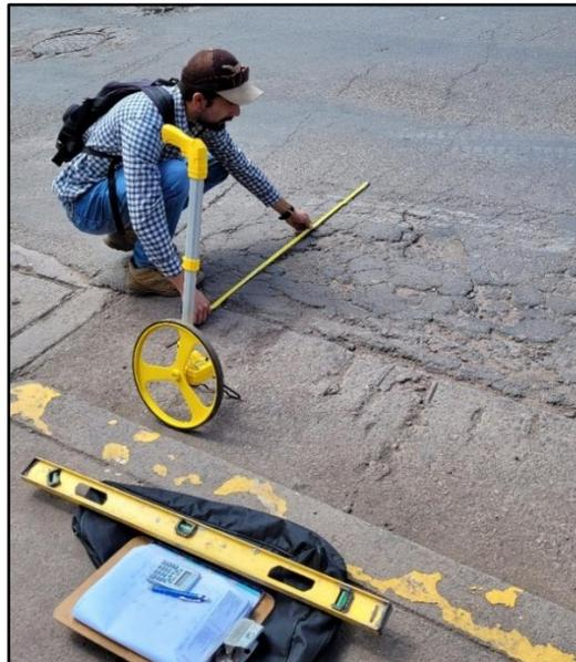
*Figura 17: Medición de la falla piel de cocodrilo*
