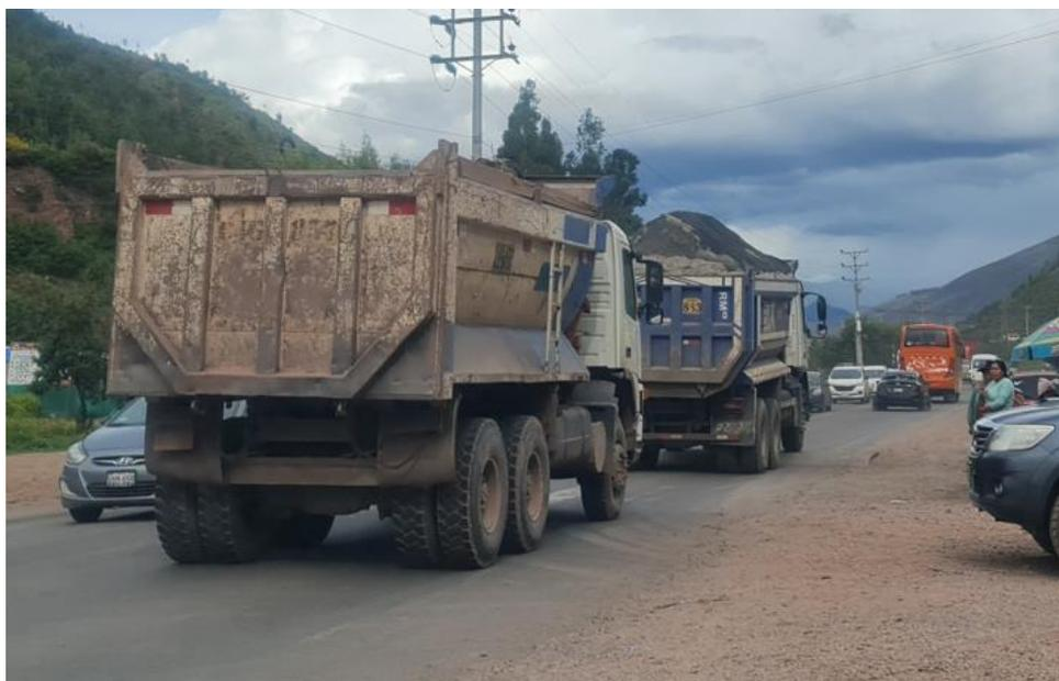
*Figura 72: Camión volquete C3 con sobrecarga y con carga moderada en estación de conteo Universidad Continental carril bajada*
