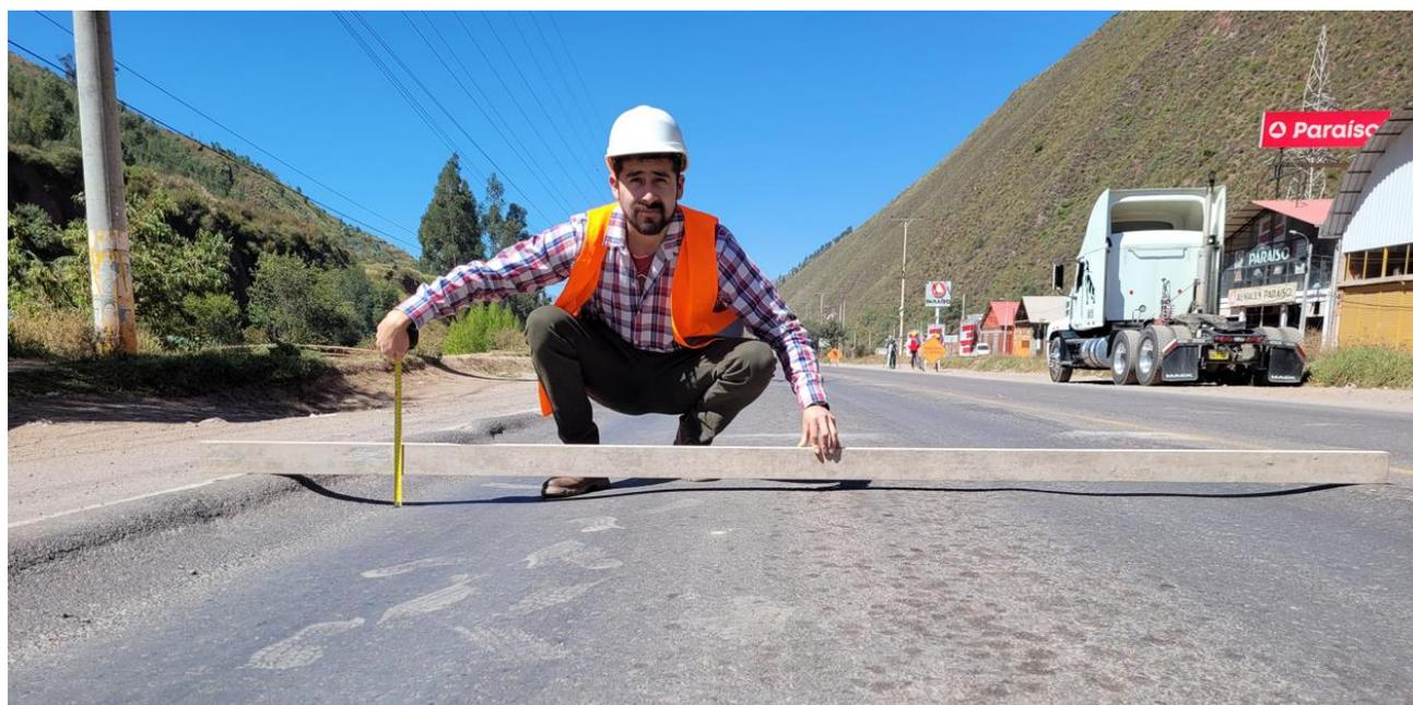
*Figura 76: Ahuellamiento de 10cm de profundidad en la estación Universidad Continental Carril Subida*
