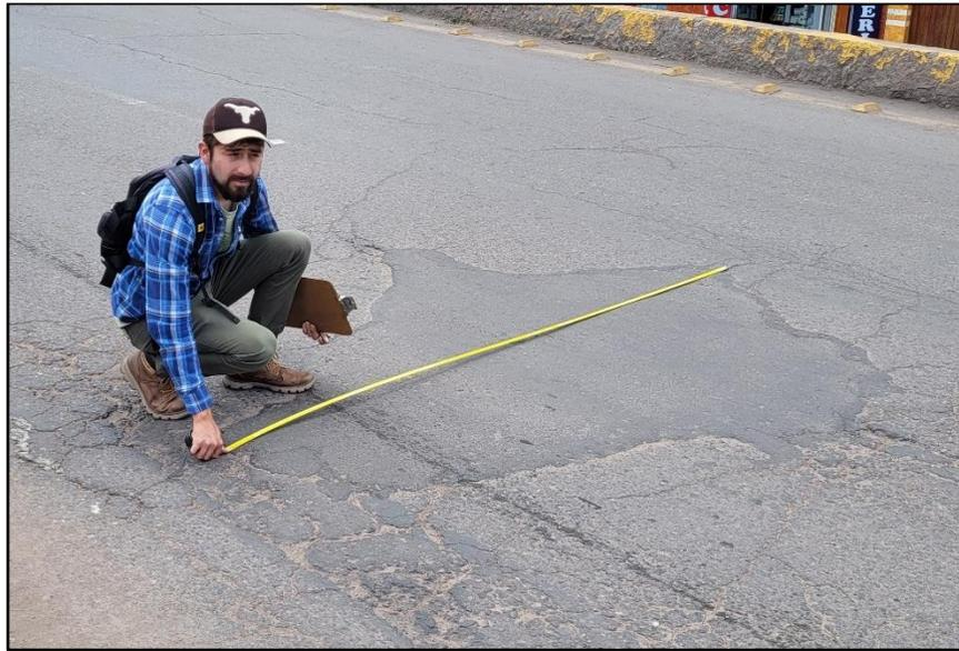
*Figura 18: Medición de la falla tipo parcheo*
