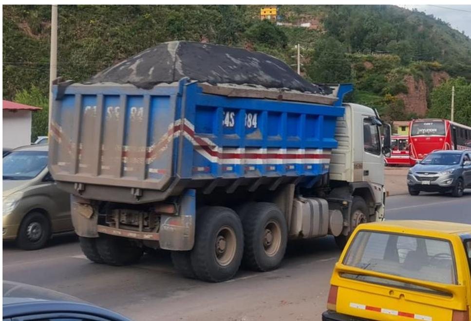
*Figura 75: Camión volquete C3 con sobrecarga en estación de conteo Universidad Continental carril bajada*
