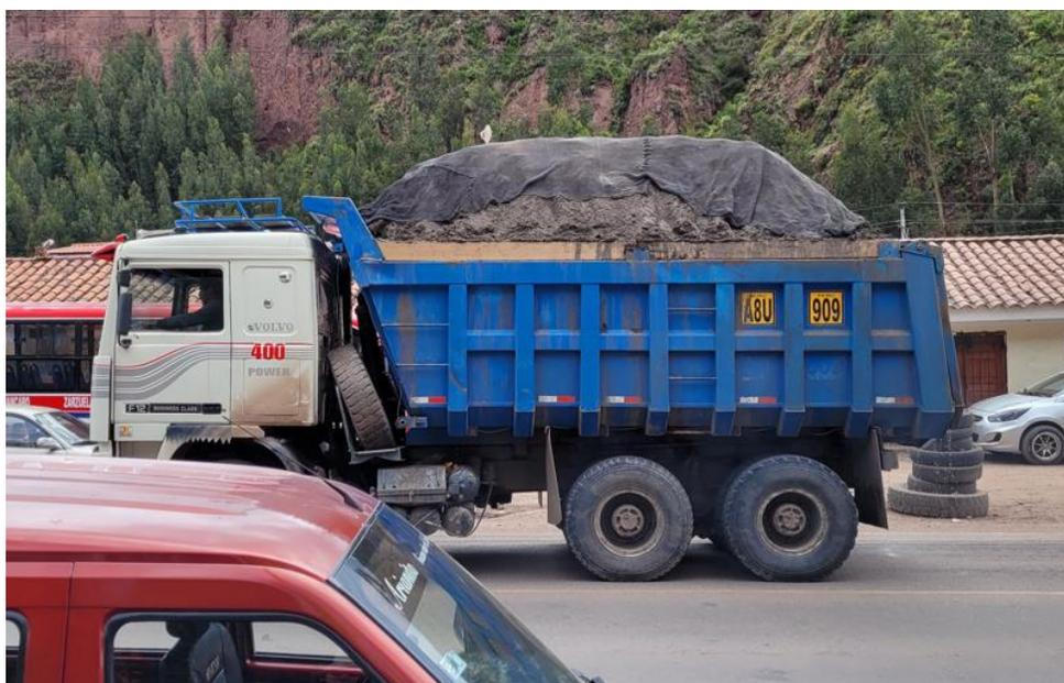
*Figura 65: Camión volquete C3 con sobrecarga en estación de conteo Universidad Continental carril subida*
