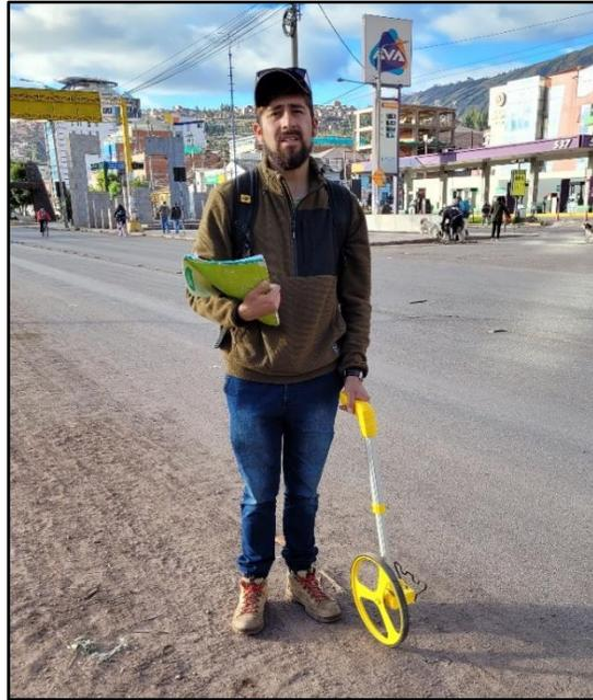
*Figura 16: Replanteo de progresivas de unidades de muestra a evaluar*
