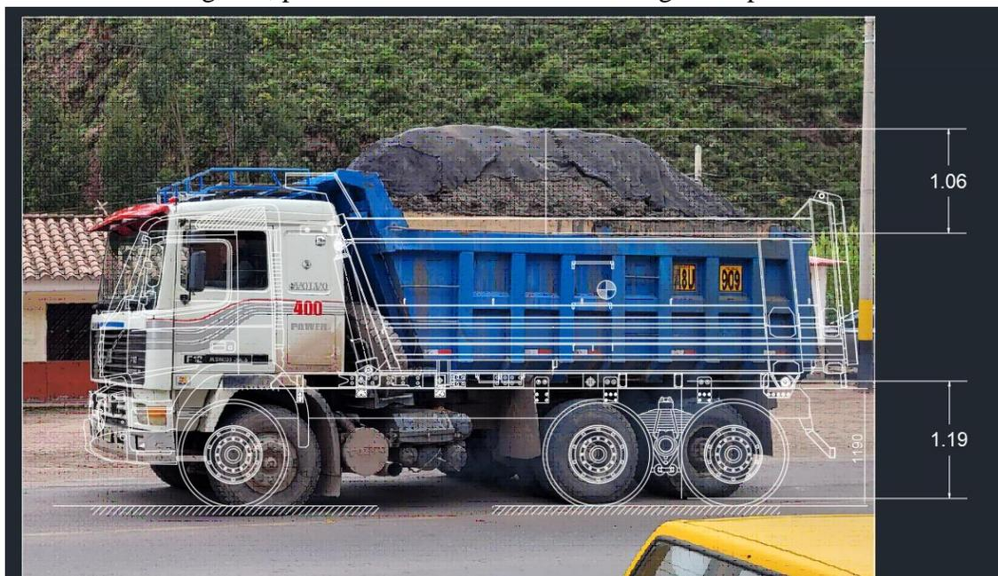
Figura 44: Camión volquete C3 sobrecargado escalado en Autocad
