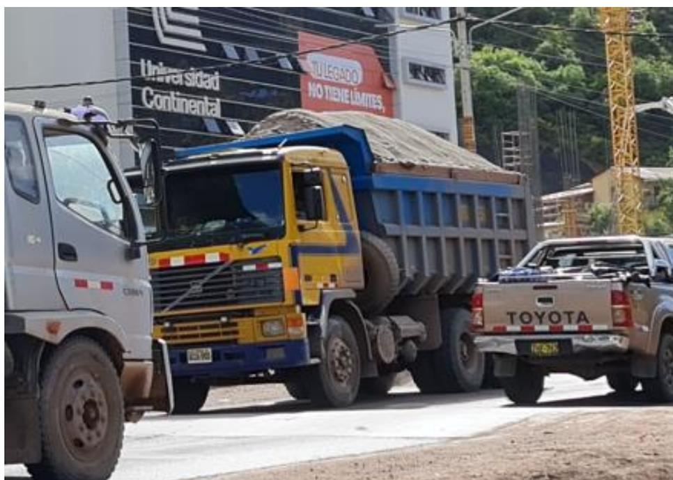
*Figura 71: Camión volquete C3 con sobrecarga en estación de conteo Universidad Continental carril bajada*
