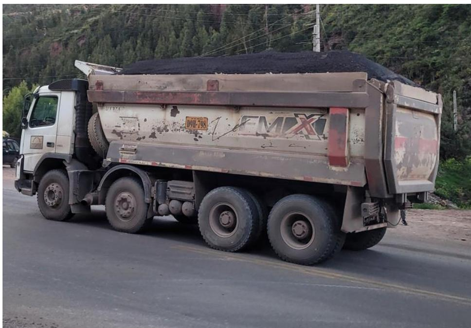
*Figura 66: Camión volquete 8x4 con sobrecarga en estación de conteo Universidad Continental carril subida*
