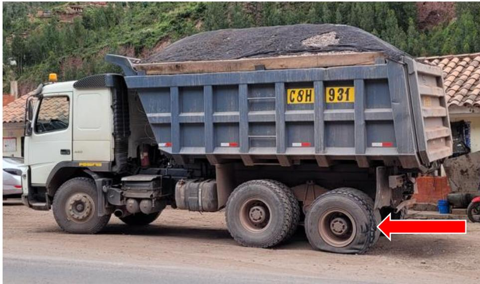
Figura 52: Llanta reventada debido a un exceso de carga
