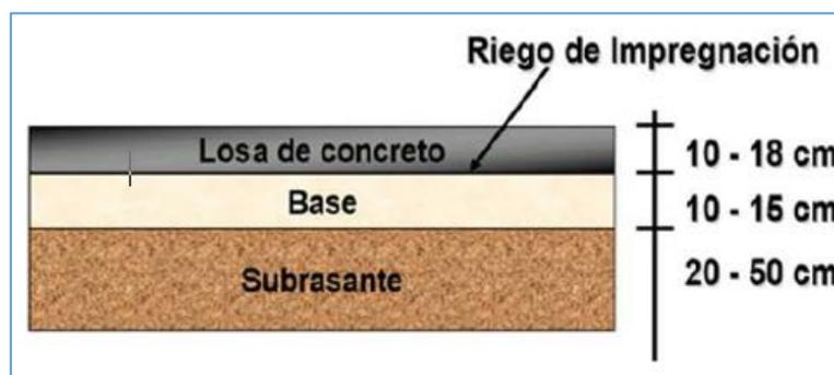
Figura 4: Corte transversal de un pavimento rígido
