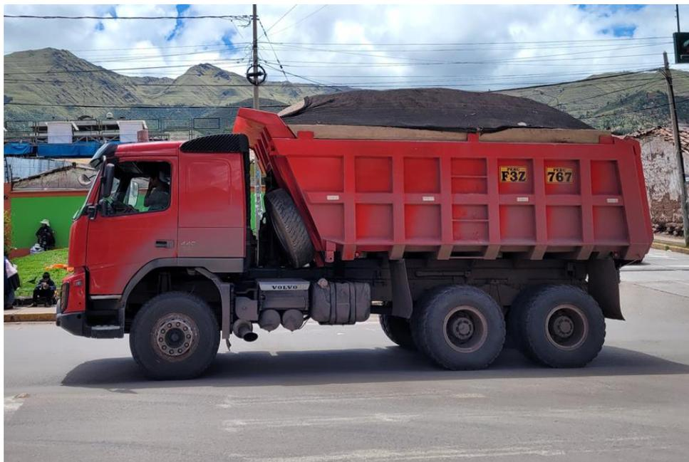
*Figura 64: Camión volquete C3 con sobrecarga en estación de conteo control de San Jerónimo*
