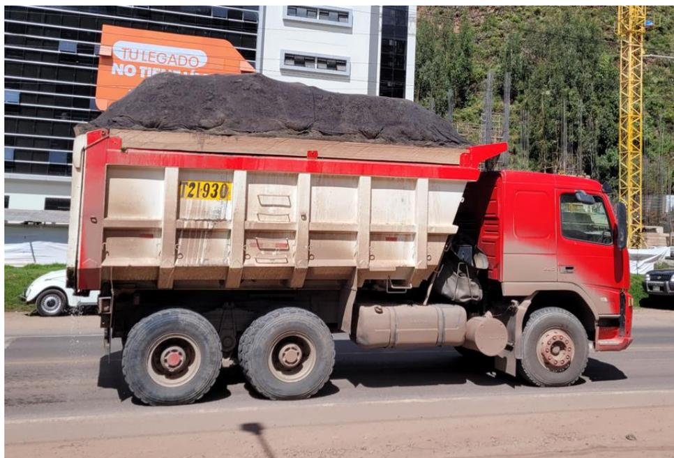
*Figura 70: Camión volquete C3 con sobrecarga en estación de conteo Universidad Continental carril subida*
