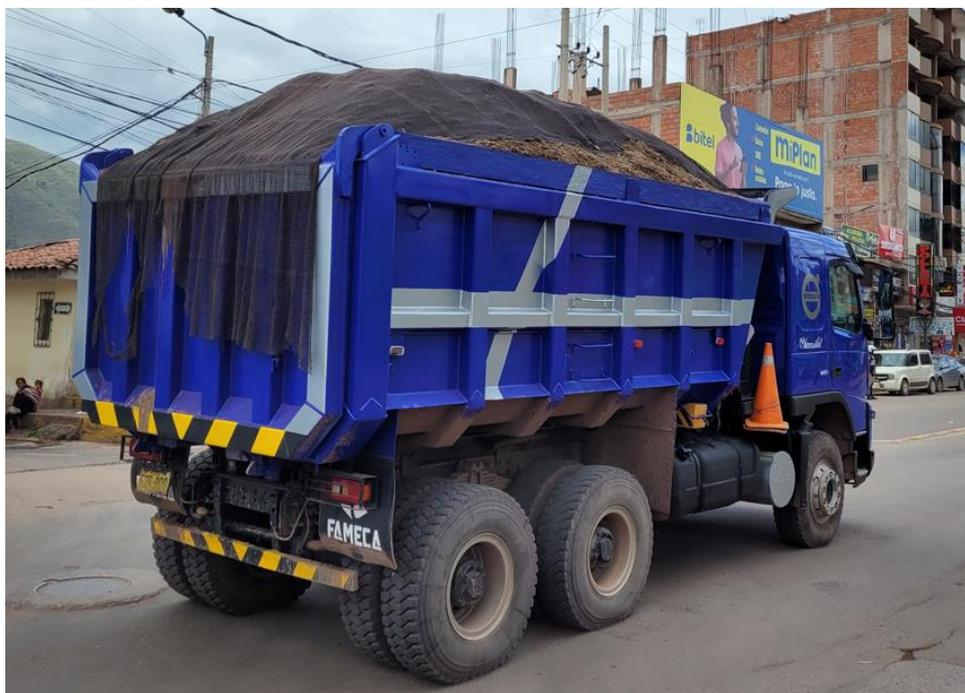
*Figura 63: Camión volquete C3 con sobrecarga en estación de conteo control de San Jerónimo*
