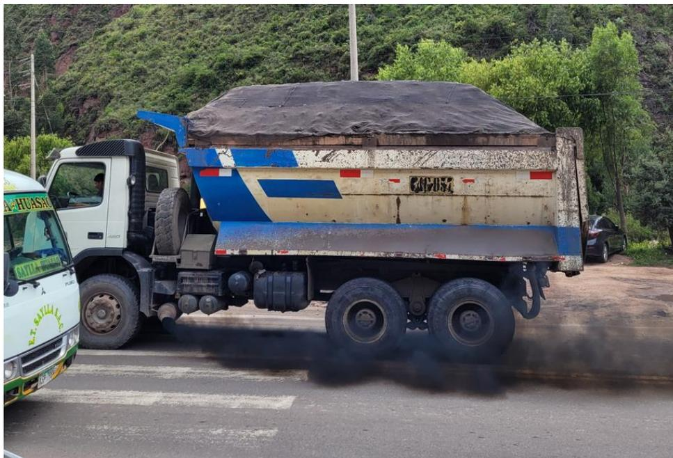
*Figura 68: Camión volquete C3 con sobrecarga en estación de conteo Universidad Continental carril subida*
