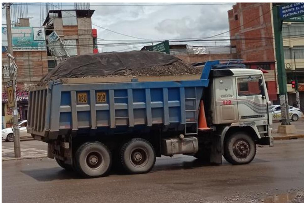
*Figura 54: Camión volquete C3 con sobrecarga en estación de conteo grifo Móbil carril subida*
