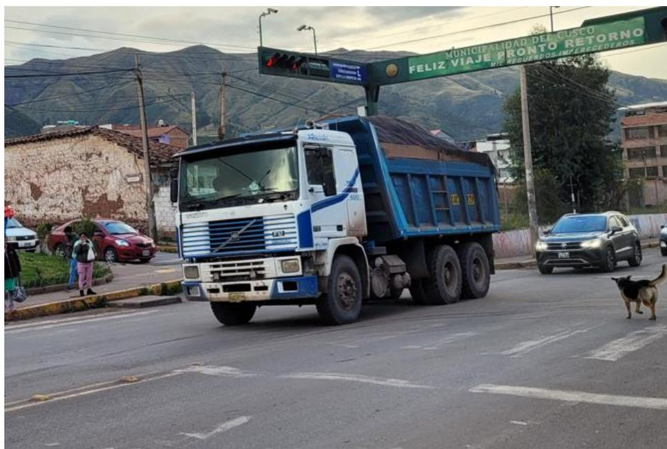
*Figura 61: Camión volquete C3 con sobrecarga en estación de conteo control de San Jerónimo*
