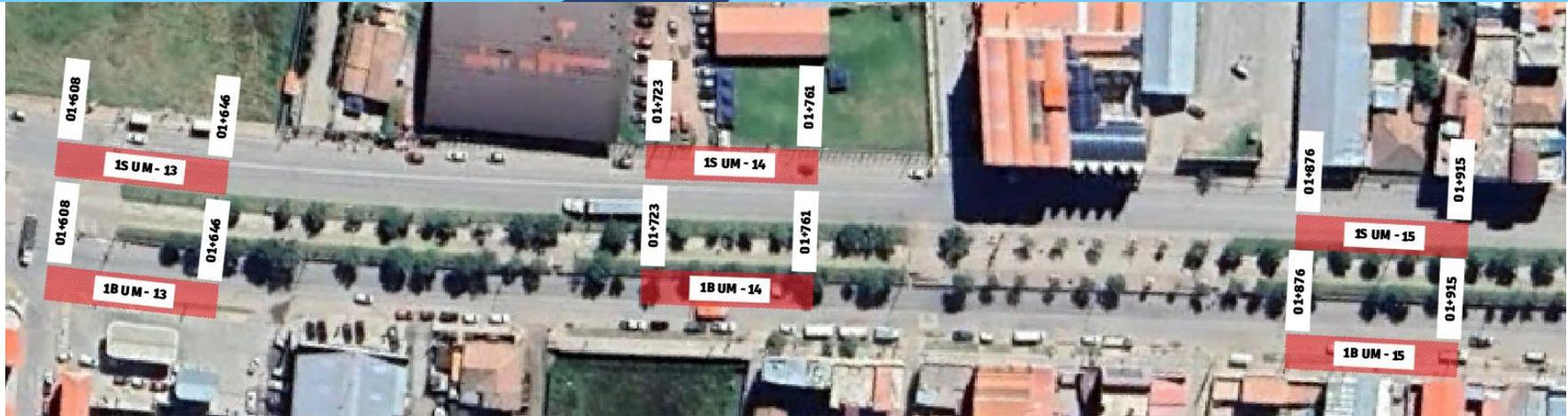
Figura 82: Unidades de muestra progresivas 01+608 a la 01+915 carriles subida y bajada
