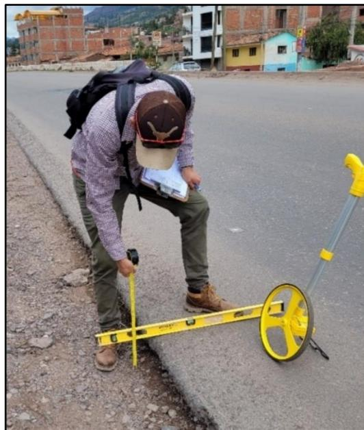
*Figura 19: Medición de la falla tipo desnivel carril / berma*
