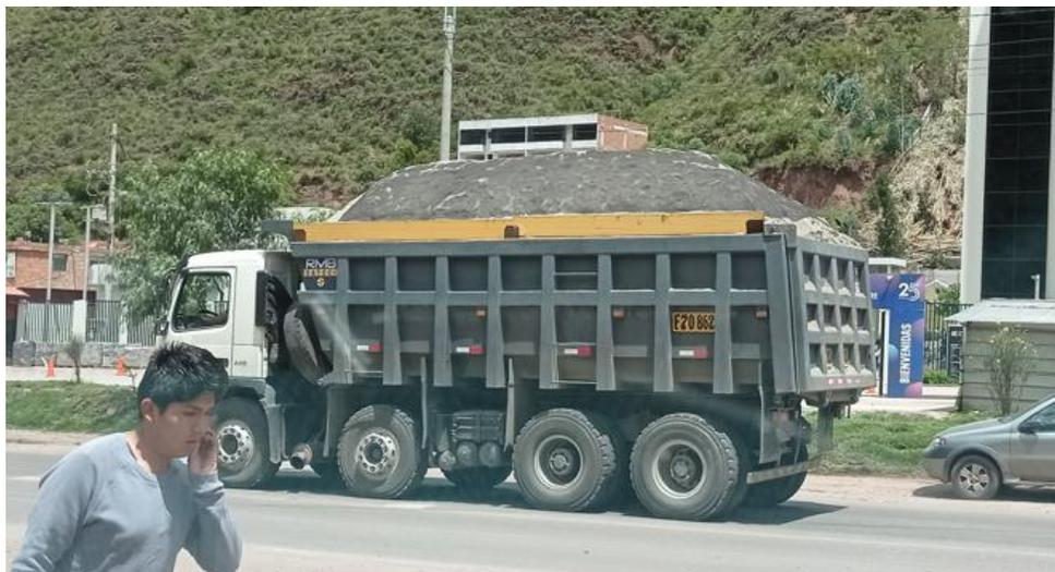
*Figura 74: Camión volquete 8x4 con sobrecarga en estación de conteo Universidad Continental carril bajada*
