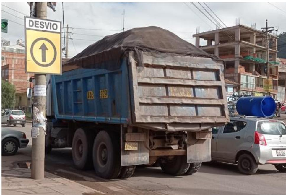
*Figura 56: Camión volquete C3 con sobrecarga en estación de conteo grifo Móvil carril subida*
