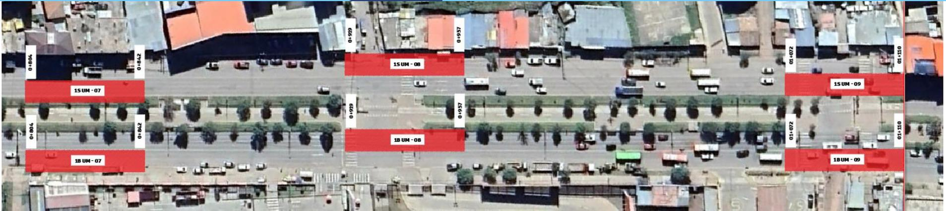
Figura 80: Unidades de muestra progresivas 0+804 a la 01+110 carriles subida y bajada
