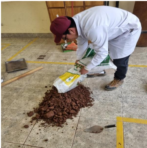
Figura 21. Preparación de muestra de aproximadamente 2000.00 gr. para ensayo granulométrico a través del método del cuarteo manual.
