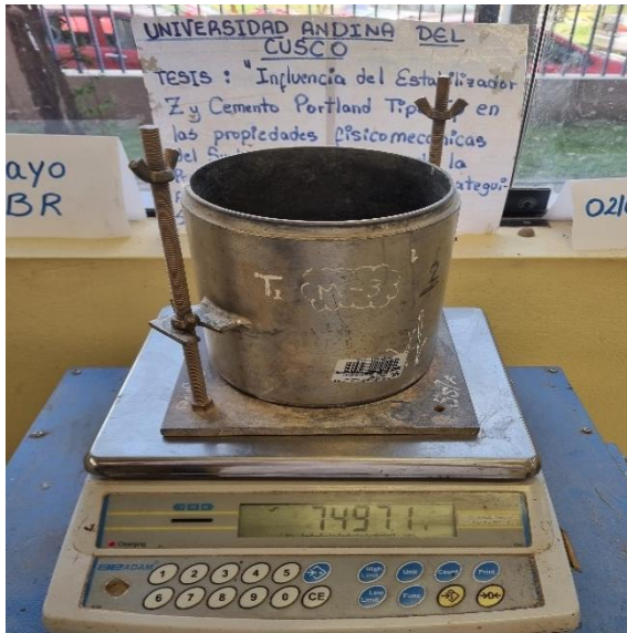
Figura 39. Ensamblaje y peso del molde CBR, colocación del papel filtro y compactación de 05 capas en el molde.
