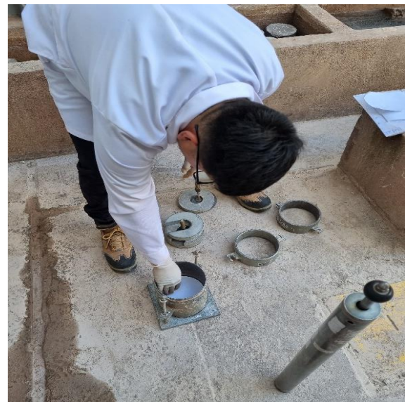
Figura 39. Ensamblaje y peso del molde CBR, colocación del papel filtro y compactación de 05 capas en el molde.
