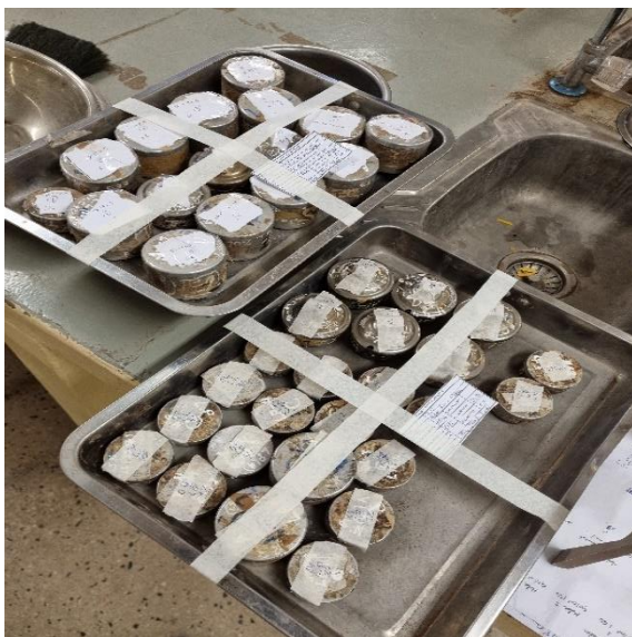
Figura 29. Respectivo etiquetado y colocado al horno de secado para determinar su contenido de humedad.
