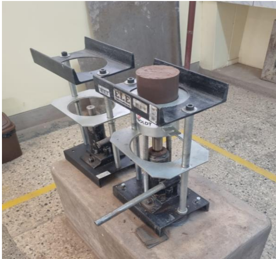
Figura 36. Extracción de espécimen, registro de peso de la muestra representativa del suelo para determinar contenido de humedad.
