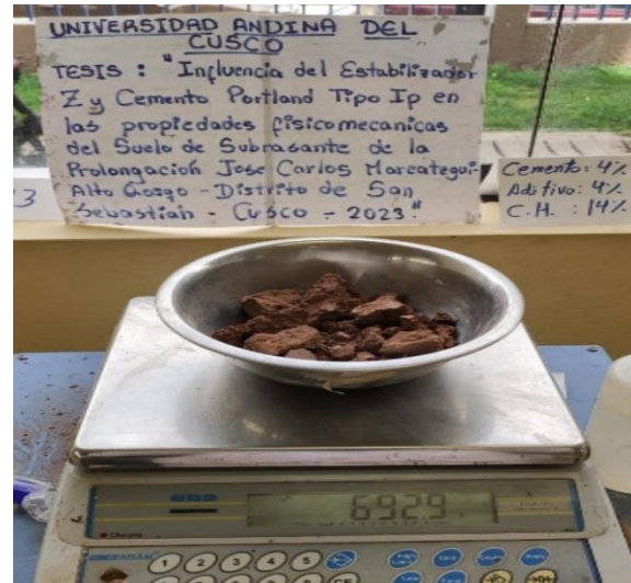
Figura 36. Extracción de espécimen, registro de peso de la muestra representativa del suelo para determinar contenido de humedad.
