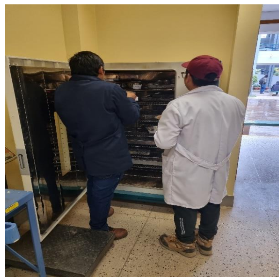
Figura 22. Lavado del material cuarteado usando la malla N° 200 y llevado al horno para un secado de 24 horas.
