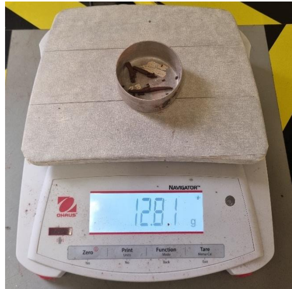
Figura 31. Peso de tara y muestra de suelo para determinar contenido de humedad.
