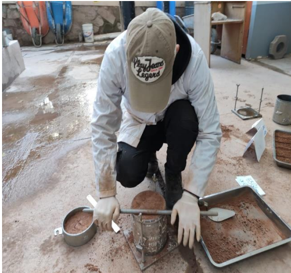
Figura 40. Enrasado y retiro del molde CBR, colocación del papel filtro, colocación inversa del molde CBR.
