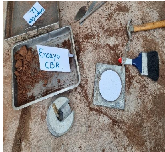
Figura 40. Enrasado y retiro del molde CBR, colocación del papel filtro, colocación inversa del molde CBR.
