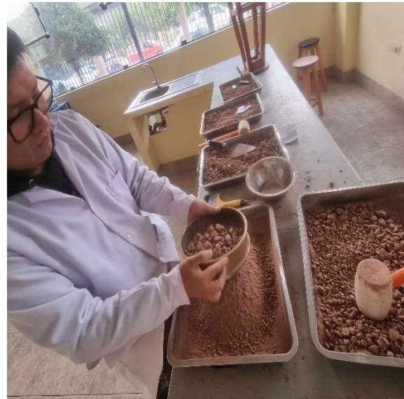
Figura 32. Secado, desmenuzado y tamizado de la muestra para el estudio.
