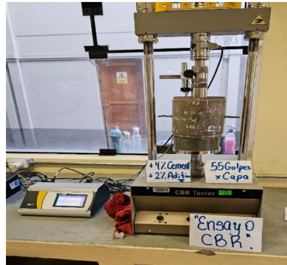
Figura 43. Ensayo del material en la máquina de compresión y extracción de muestra para llevar al horno.
