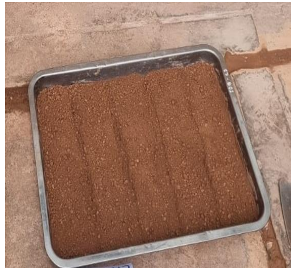
Figura 34. División de la muestra en 5 partes iguales, y compactación en 5 capas.
