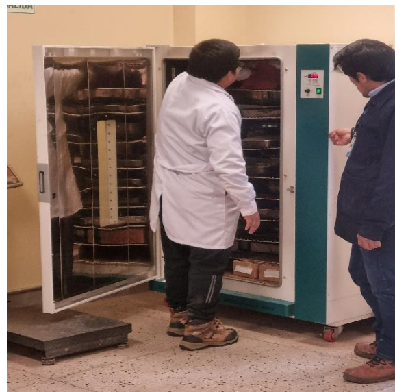
Figura 29. Respectivo etiquetado y colocado al horno de secado para determinar su contenido de humedad.
