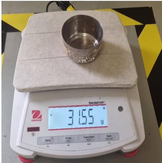
Figura 31. Peso de tara y muestra de suelo para determinar contenido de humedad.
