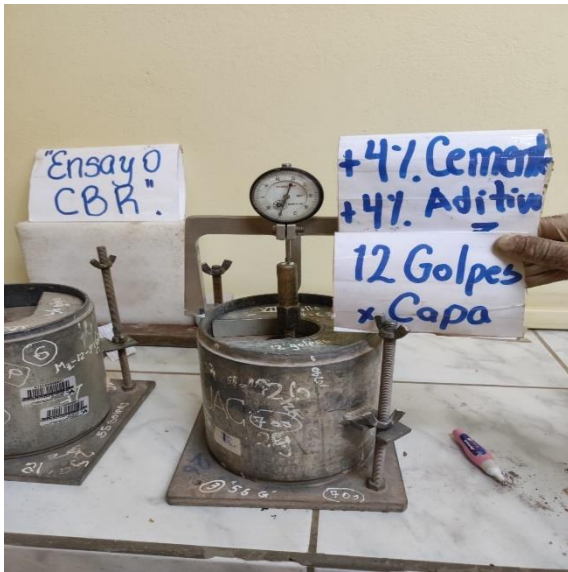
Figura 42. Medición de expansión de las muestras sumergidas en agua, retiro de las muestras, pesado de las muestras.
