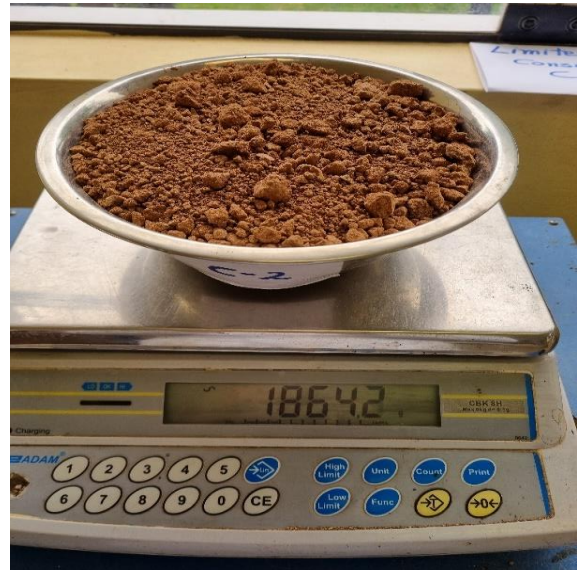
Figura 23. Muestra seca retirada del horno y pesada en la balanza de precisión de 0.01 gr
