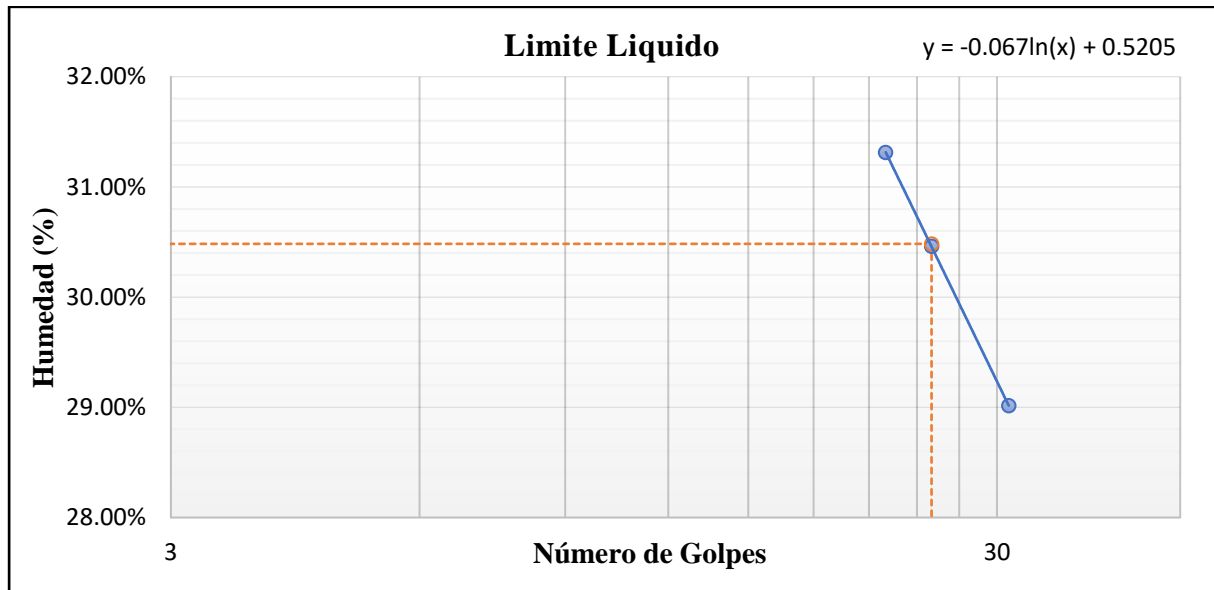
Figura 47. Límite Líquido de Suelo Natural, Calicata C-1.
