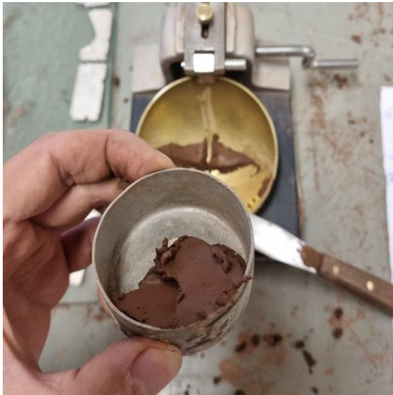
Figura 28. Obtención de muestra para limite líquido y pesaje respectivo.
