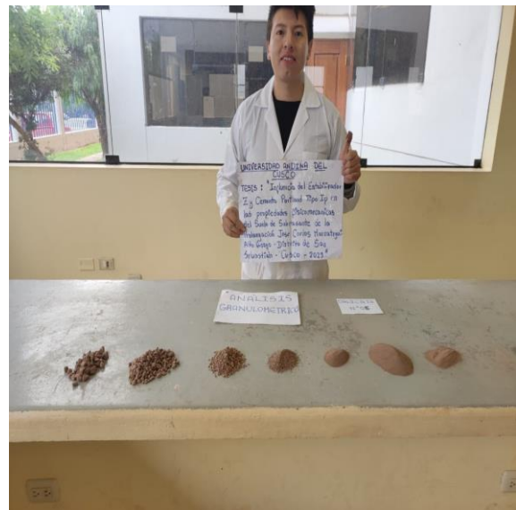
Figura 24. Muestra de suelo distribuida y retenida por cada tamiz.
