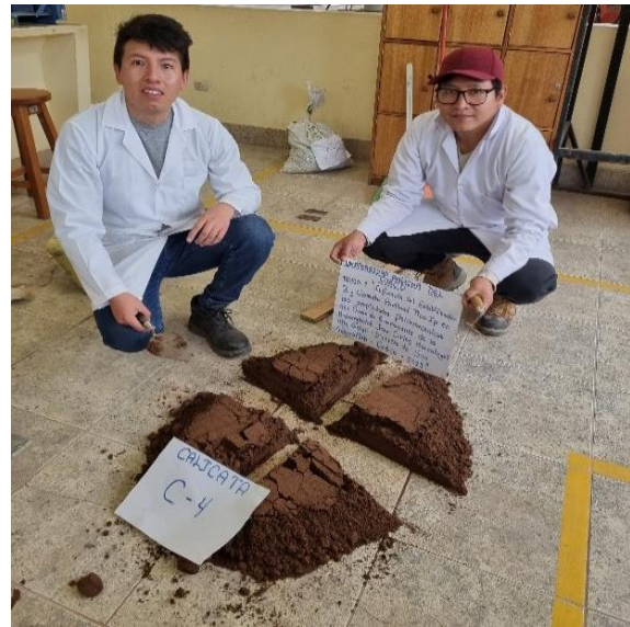
Figura 21. Preparación de muestra de aproximadamente 2000.00 gr. para ensayo granulométrico a través del método del cuarteo manual.
