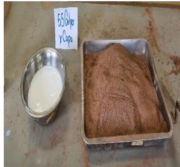
Figura 38. Mezclado de suelo con cemento, agua, aditivo correspondiente y división de la muestra en 05 partes iguales.
