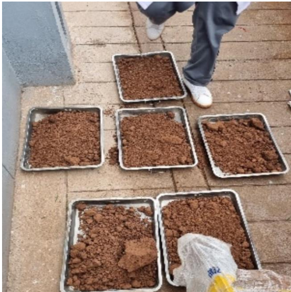
Figura 32. Secado, desmenuzado y tamizado de la muestra para el estudio.
