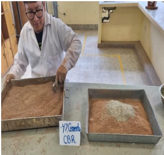
Figura 38. Mezclado de suelo con cemento, agua, aditivo correspondiente y división de la muestra en 05 partes iguales.
