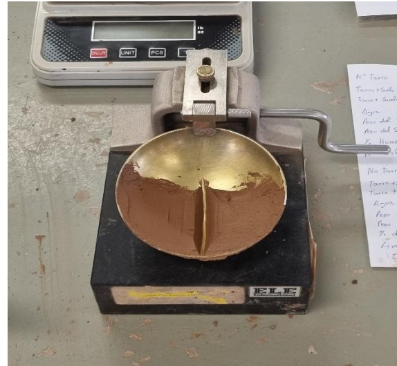
Figura 27. Calibración de copa, colocación de suelo y acanalado.
