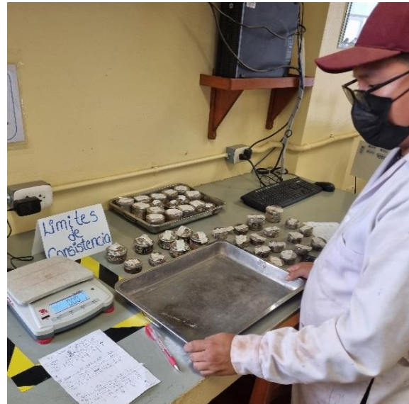
Figura 28. Obtención de muestra para limite líquido y pesaje respectivo.
