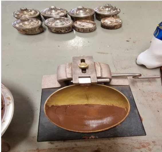
Figura 27. Calibración de copa, colocación de suelo y acanalado.
