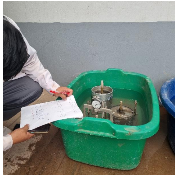
Figura 42. Medición de expansión de las muestras sumergidas en agua, retiro de las muestras, pesado de las muestras.
