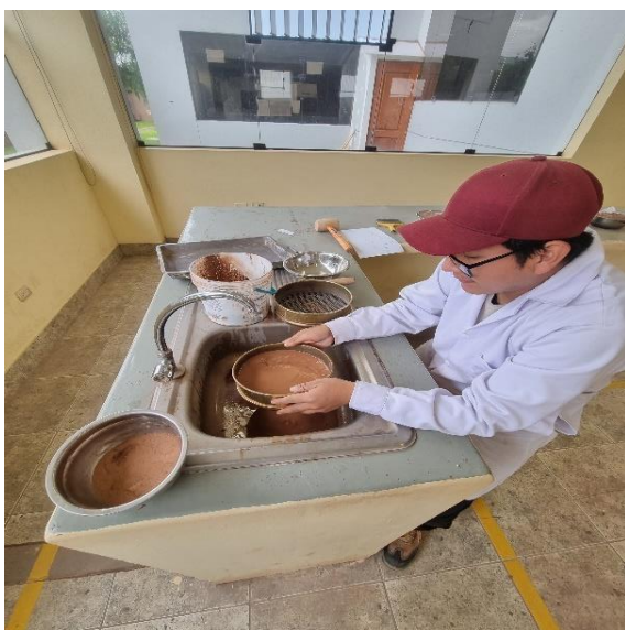
Figura 22. Lavado del material cuarteado usando la malla N° 200 y llevado al horno para un secado de 24 horas.
