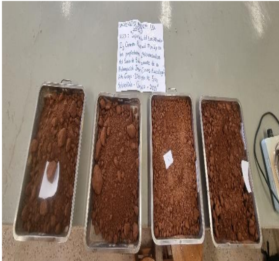
Figura 37. Secado y tamizado de la muestra para el estudio.
