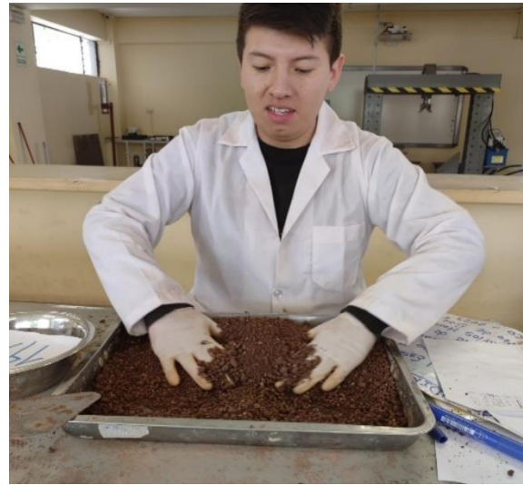
Figura 33. Adición de agua en los porcentajes establecidos y mezclado de la muestra.
