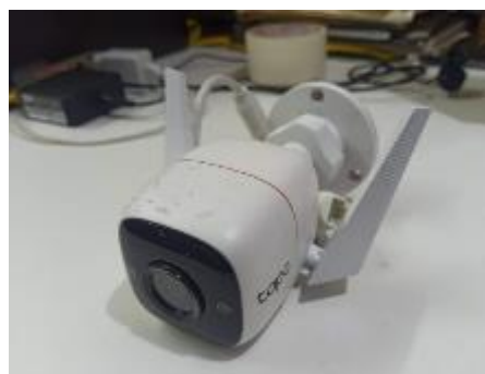
Figura 3: Cámara de seguridad para exteriores
