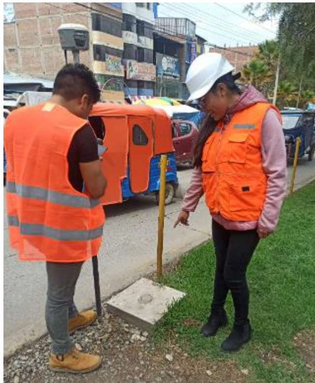
Figura 12: Toma de referencia del punto geodésico principal.
