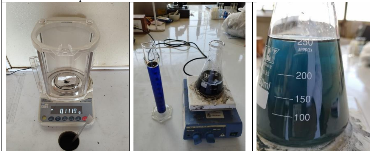
Determinación del pH del carbón activado
