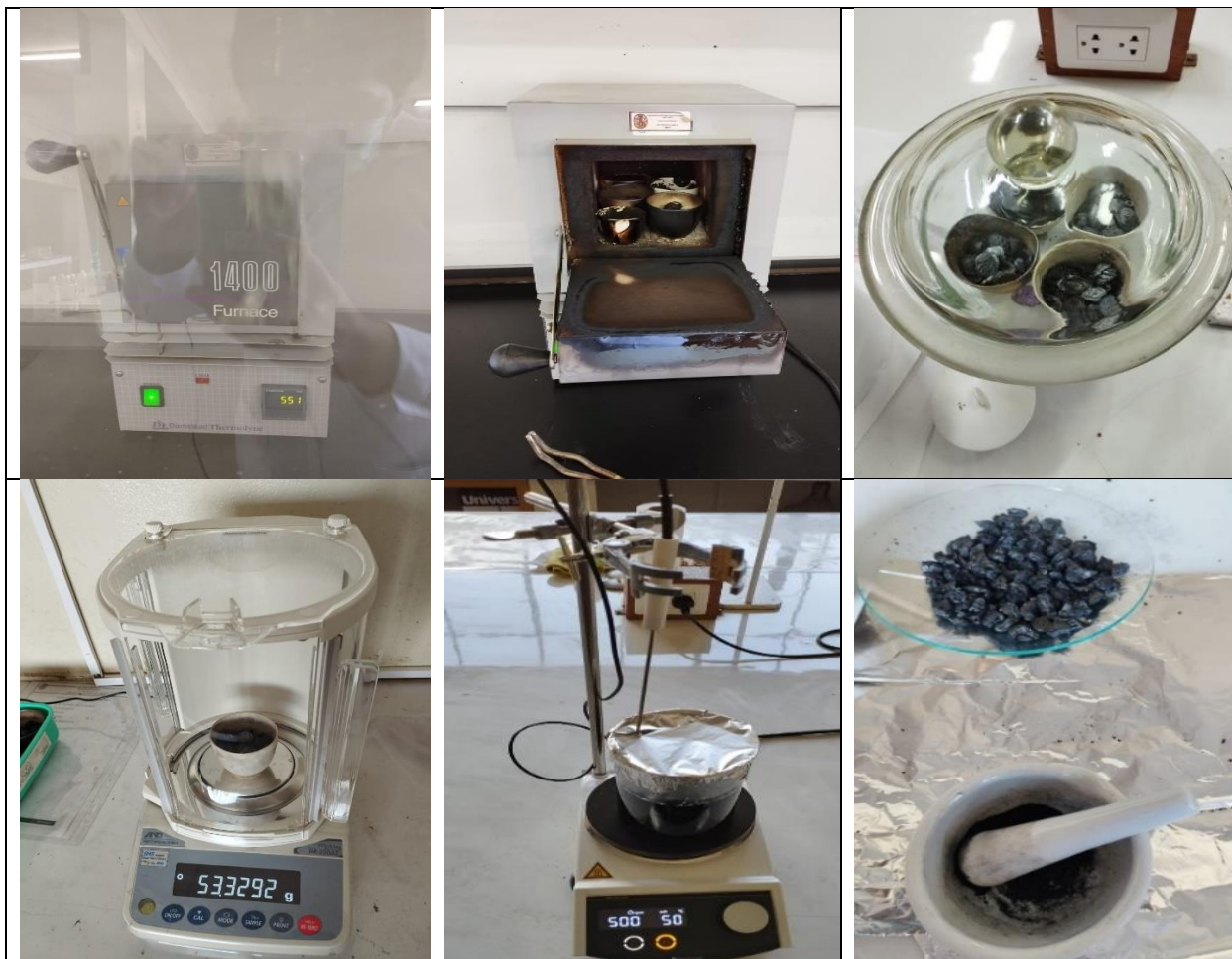
Carbonización a 550 °C durante 30 minutos y su posterior activación con ácido fosfórico al 85 %
