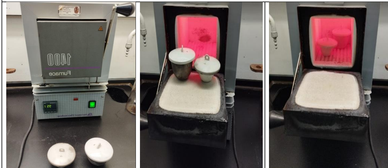
Determinación del contenido de cenizas del carbón activado
