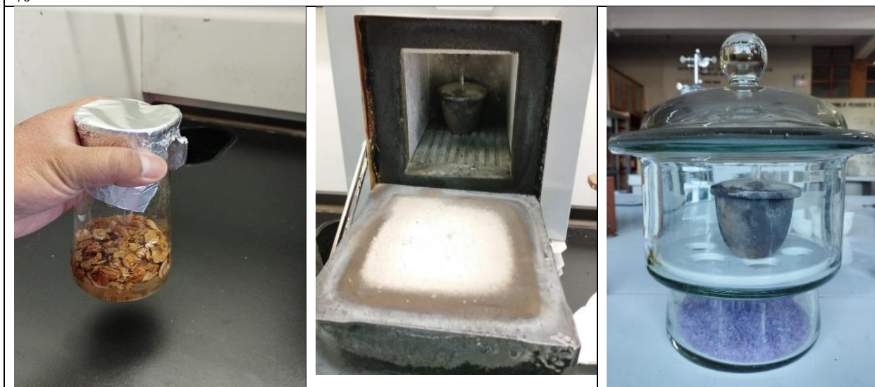
Carbonización a 550 °C durante 30 minutos y su posterior activación con ácido fosfórico al 85 %
