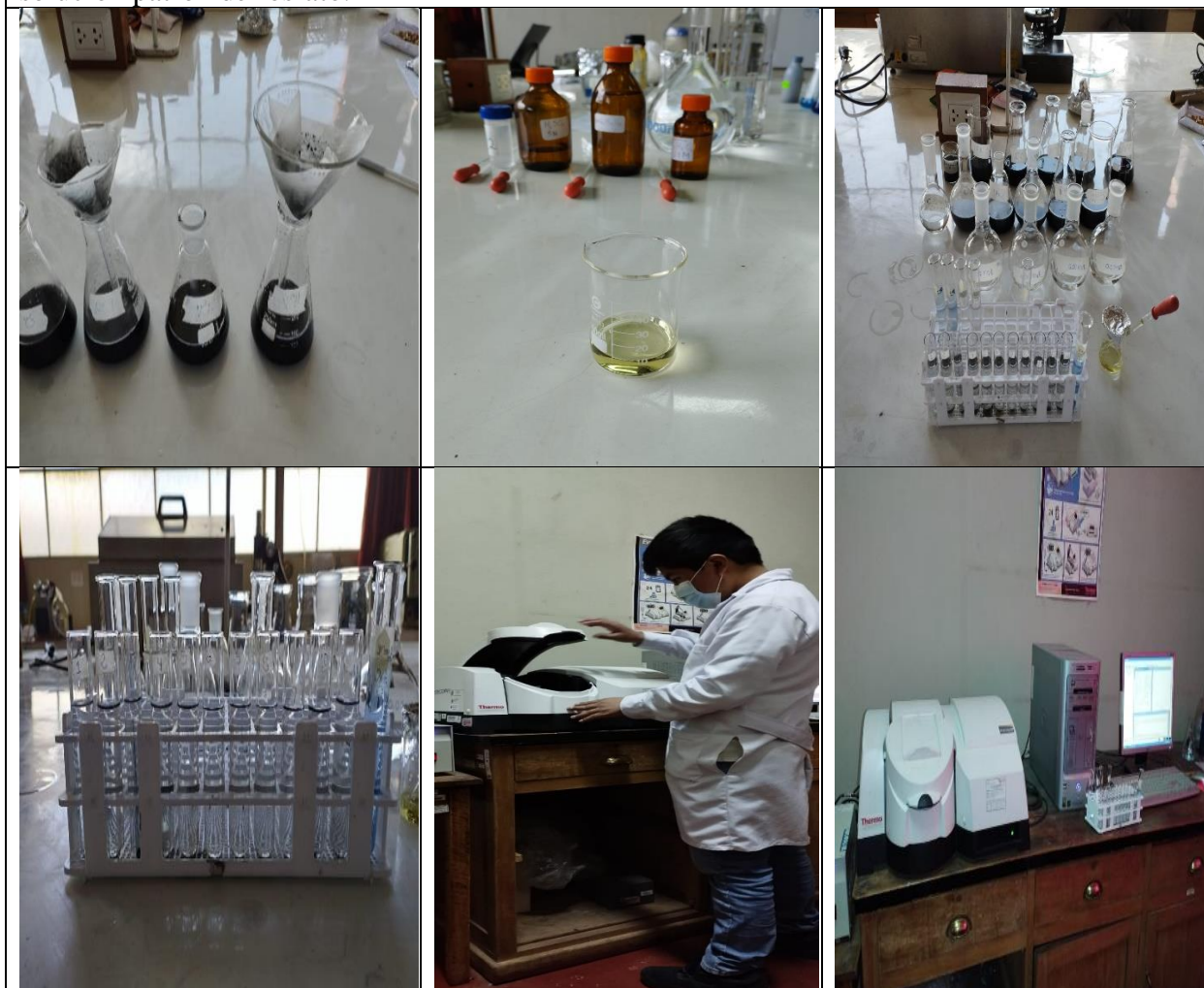
Calibración de espectrofotómetro con concentraciones patrones de 0.03, 0.1, 0.5 y 1 mg/L de solución patrón de fosfato.
