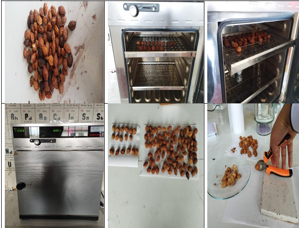
Secado a temperatura ambiente durante 48 horas del endocarpio luego de ser despulpada el durazno y posteriormente se llevó a secado en horno a 60 °C durante 24 horas, finalmente se realizó la separación de la semilla con el endocarpio.
