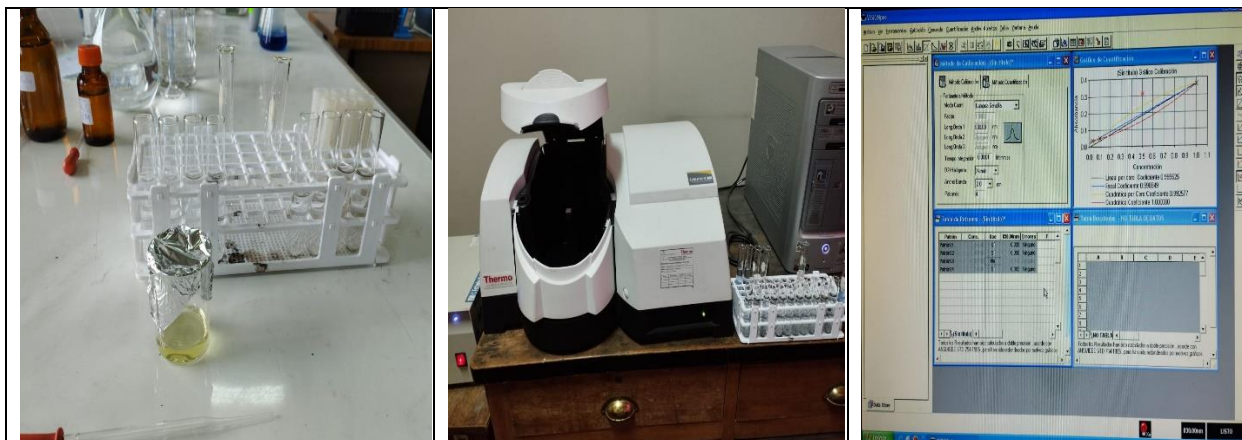
Calibración de espectrofotómetro con concentraciones patrones de 0.03, 0.1, 0.5 y 1 mg/L de solución patrón de fosfato.
