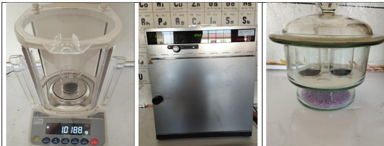
Determinación del contenido de humedad del carbón activado
