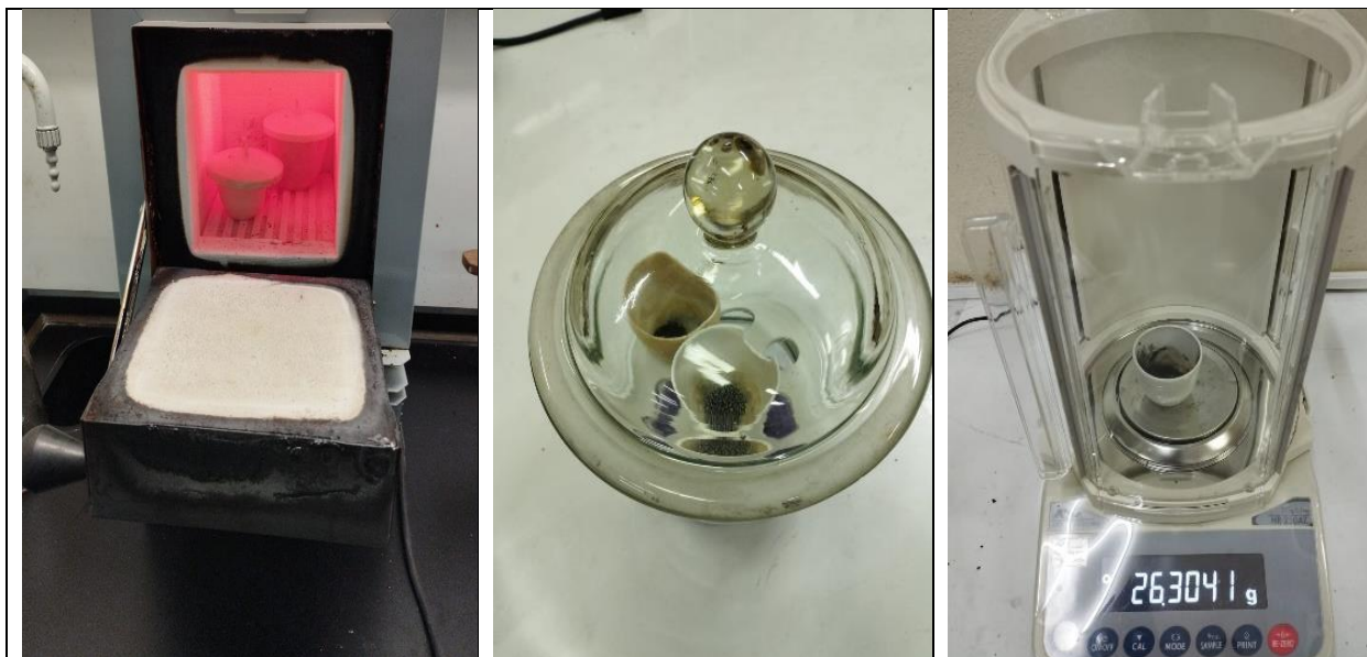
Determinación del material volátil del carbón activado
