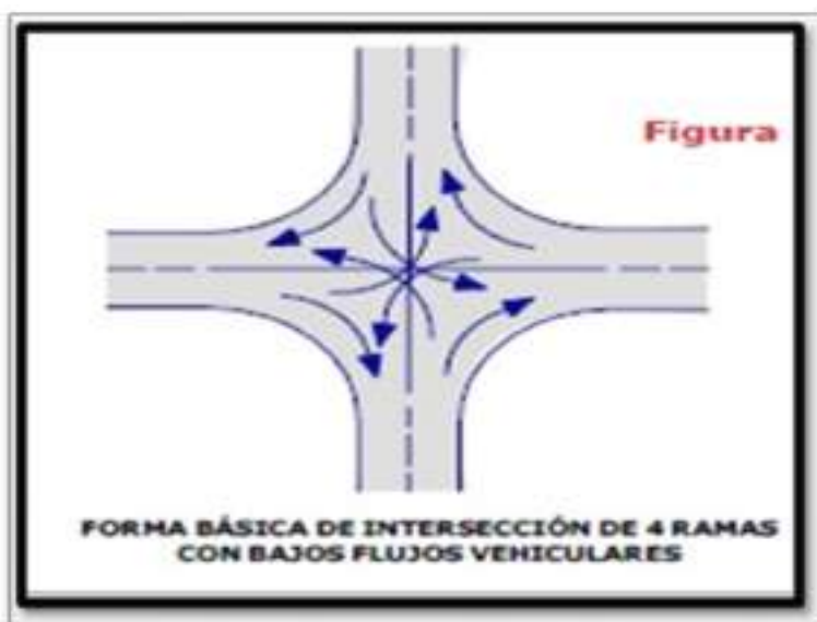
figura 33: Intersección de 4 ramales con bajos flujos vehiculare
