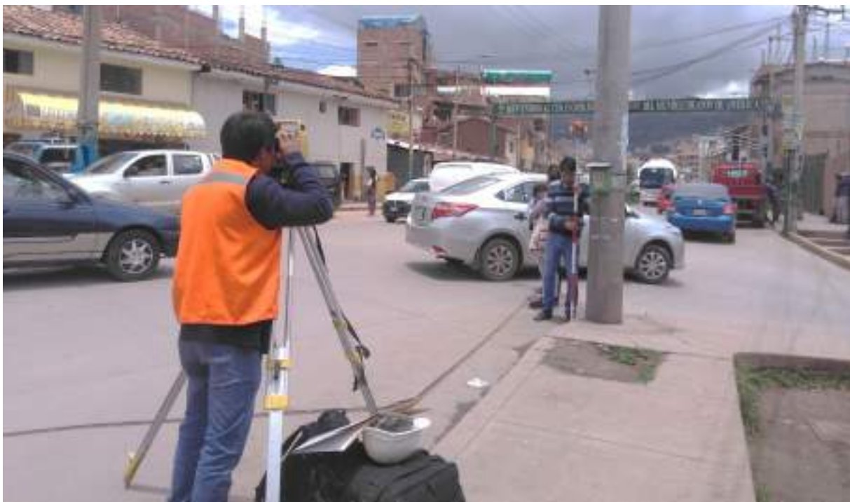
figura 70 Levantamiento topográfico en la intersección semaforizada: Avenida Agustín Gamarra – Calle Hipólito Unanue
