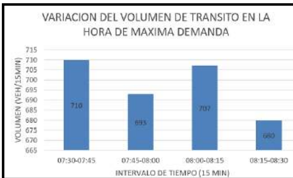
figura 111 Variación de volumen de tránsito en la hora de máxima demanda de la intersección semaforizada: Avenida Agustín Gamarra – Avenida Ejercito
