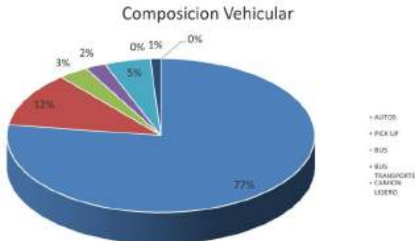
figura 200 Composición vehicular en la intersección no semaforizada: Prolongación Avenida Grau – Avenida Antonio Lorena
