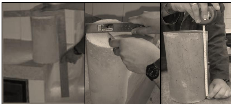
Figura 22 Medición del diámetro, chequeo de la perpendicularidad, verificación de la horizontalidad y altura de briquetas.
