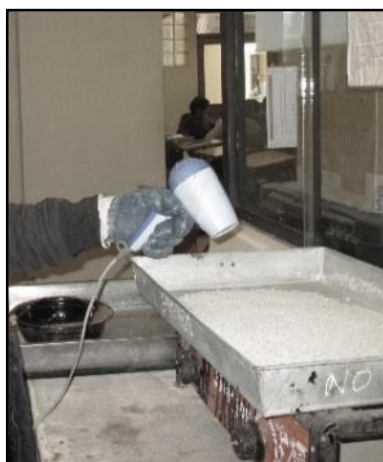
Figura 39 Secado de muestras de agregado fino y ensayo superficie seca saturada en el cono de absorción.
