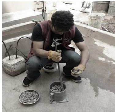
Figura 42 Determinación del peso unitario, pesado del molde más agregado.
