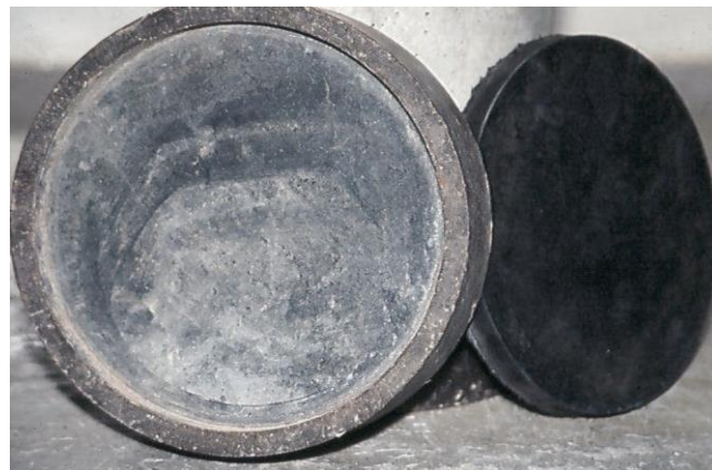
Figura 25 Preparación y acondicionamiento de probeta-testigos con almohadillas de neopreno.
