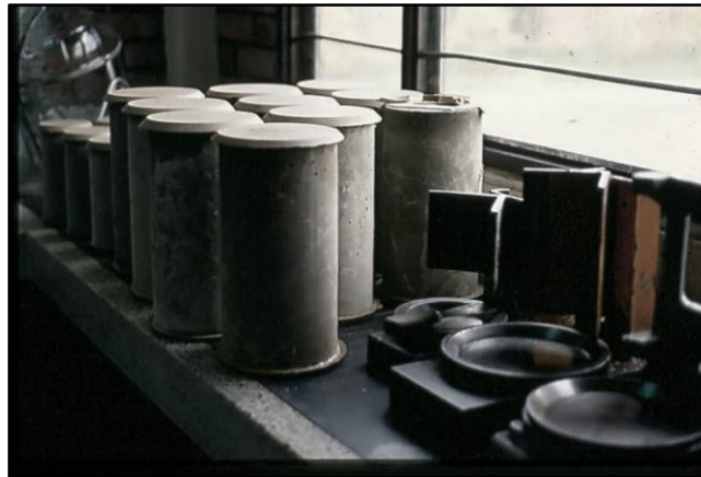
Figura 24 Preparación y acondicionamiento de probeta-testigos con capping.
