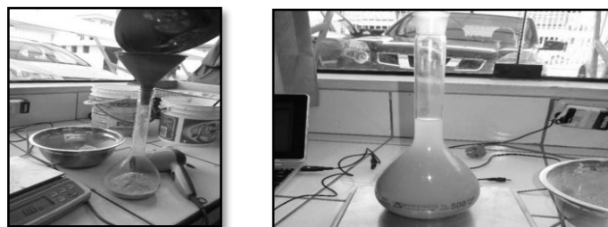
Figura 40 Ensayo del peso específico del agregado fino en la fiola y bomba de vacíos.
