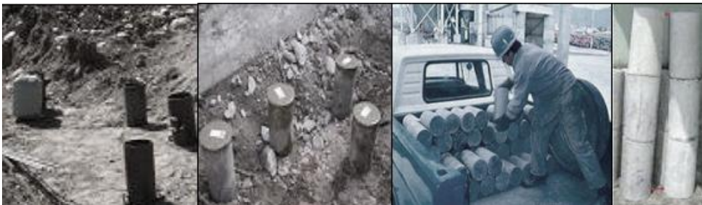
Figura 19 Actos indebidos en la manipulación y transporte de probetas-testigos.
