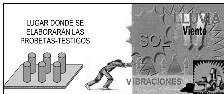
Figura 15 Factores que no debe existir en el lugar de elaboración de las probetas-testigos.
