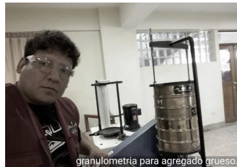
Figura 37 Ensayo de granulometría para las muestras de agregado grueso.
