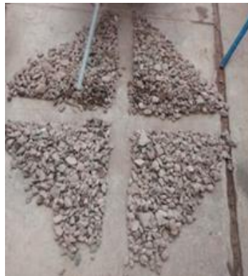
Figura 35 Muestreo del agregado grueso y agregado fino.
