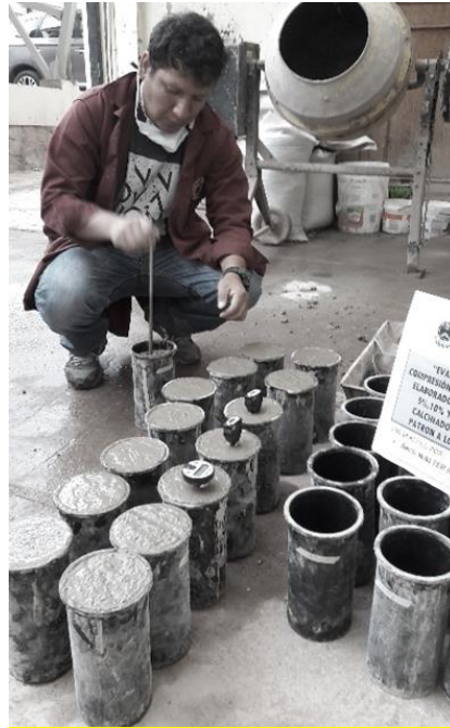
Figura 45 Toma de la temperatura del concreto fresco.
