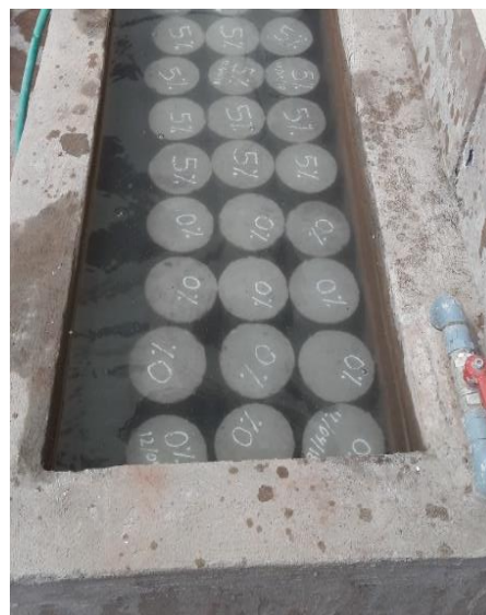
Figura 18 Curado de probetas-testigos.
