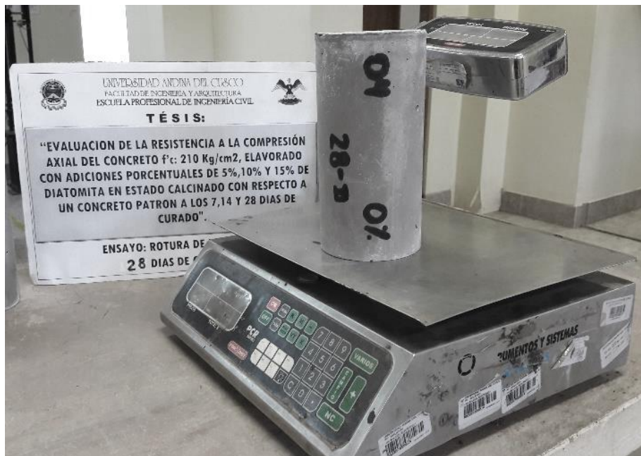
Figura 52 Pesado de probetas-testigos de concreto.
