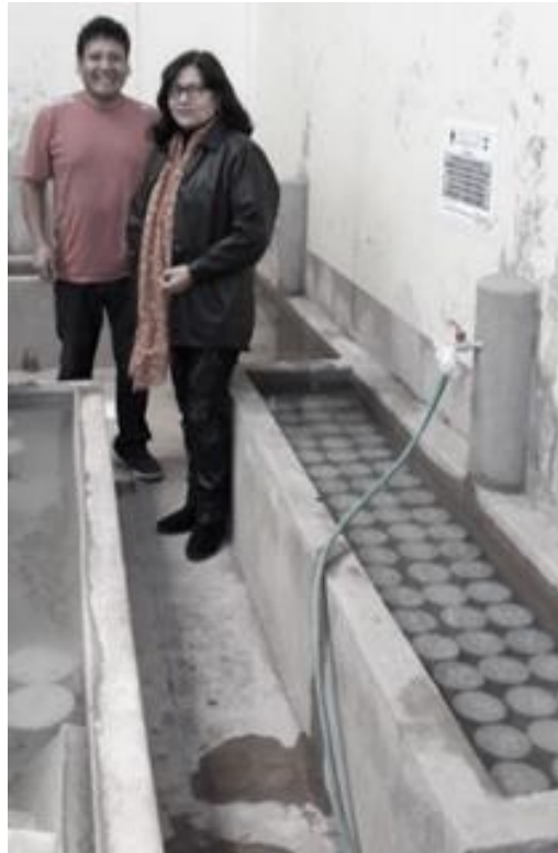
Figura 49 Curado de probetas-testigos de concreto.
