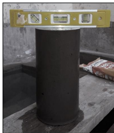
Figura 51 Medición de probetas-testigos de concreto.
