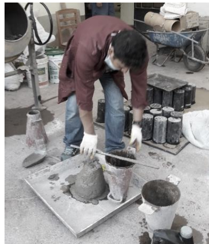
Figura 46 Realizando el ensayo de cono de Abrams para la verificación del revenimiento.
