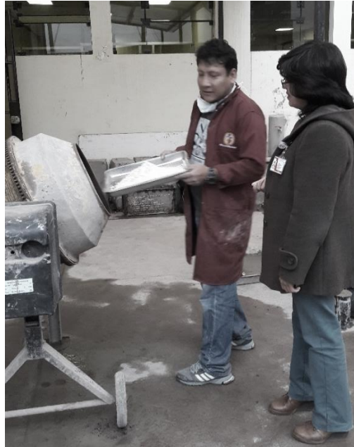
Figura 44 Adición de diatomita en estado calcinado en diferentes porcentajes al concreto.
