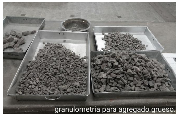
Figura 38 Ensayo de granulometría para las muestras de agregado grueso.
