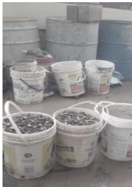
Figura 33 Lavado y almacenamiento de los agregados.
