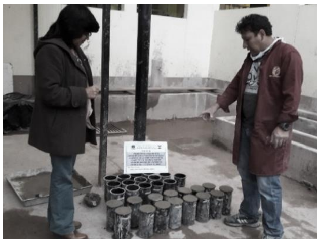
Figura 47 Moldeado de probetas-testigos de concreto fresco.
