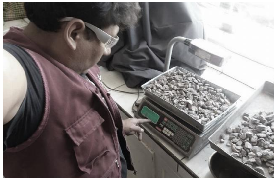
Figura 41 Ensayo del peso específico y absorción del agregado grueso.
