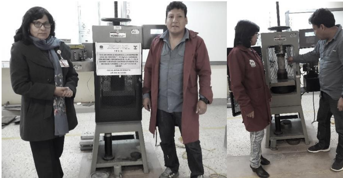
Figura 53 Ensayo de resistencia a la compresión axial de probetas-testigos de concreto.
