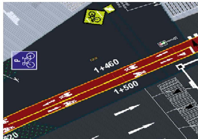
Figura N° 121: Líneas continuas Fuente: Elaboración propia
