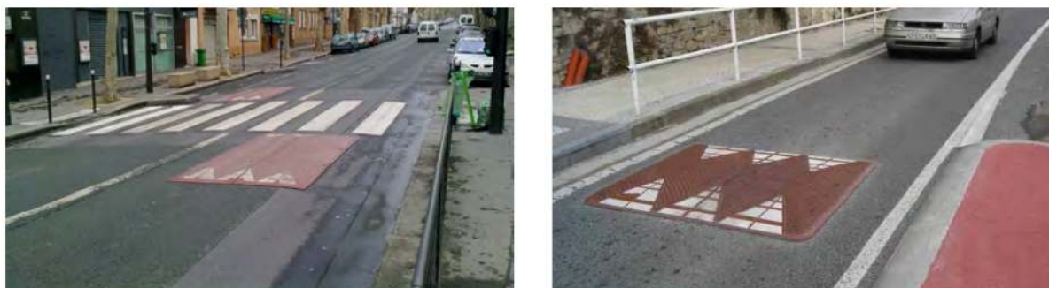
Figura N° 54: Ejemplo de “cojines” en calles de doble sentido y sentido único (Paris / Francia y San Sebastián / España)
