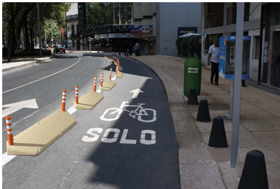
Figura N° 30: Medidas calmantes de tráfico de ciclovía. Fuente: (CONASET, 2010)
