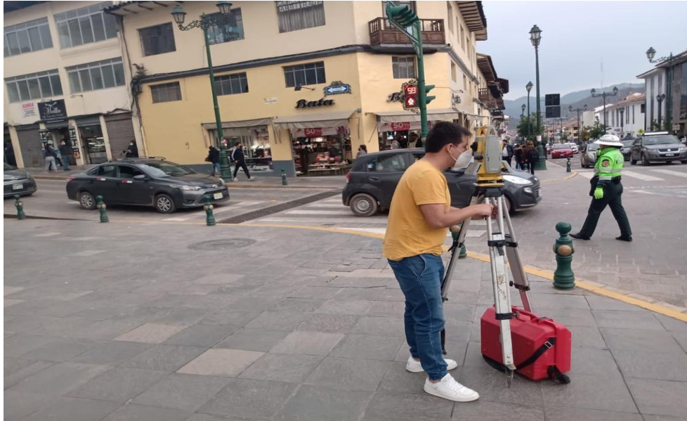
Figura 107: Recolección de datos con estación total Av. sol con Ayacucho
