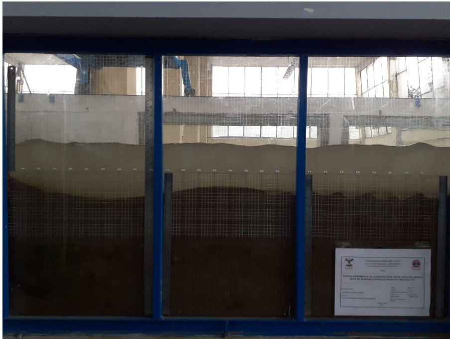
Fotografía 45: Erosión hora 09 – Caudal 63.39 l/s
