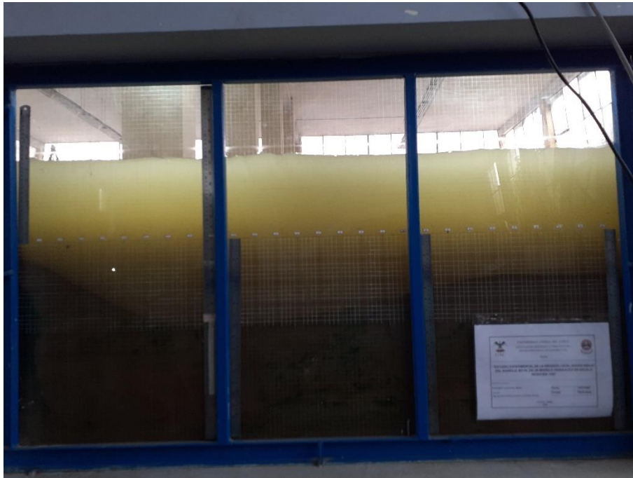
Fotografía 72: Erosión hora 06 – Caudal 189.56 l/s
