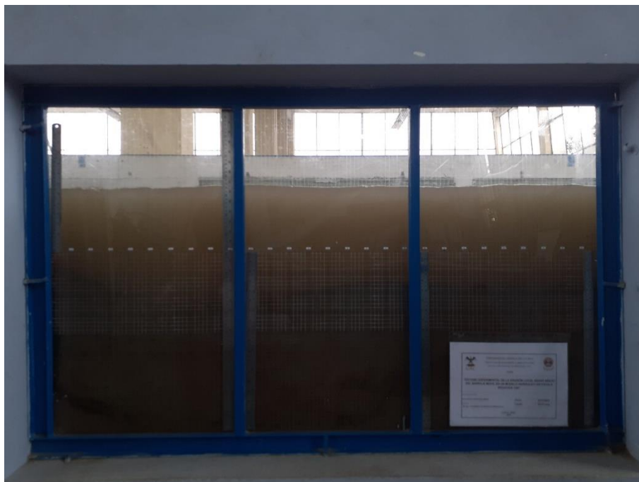
Fotografía 62: Erosión hora 05 – Caudal 148.23 l/s
