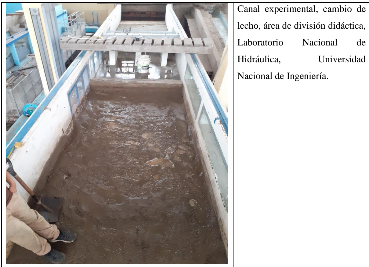
Figura 34: Limpieza de canal de ensayo
