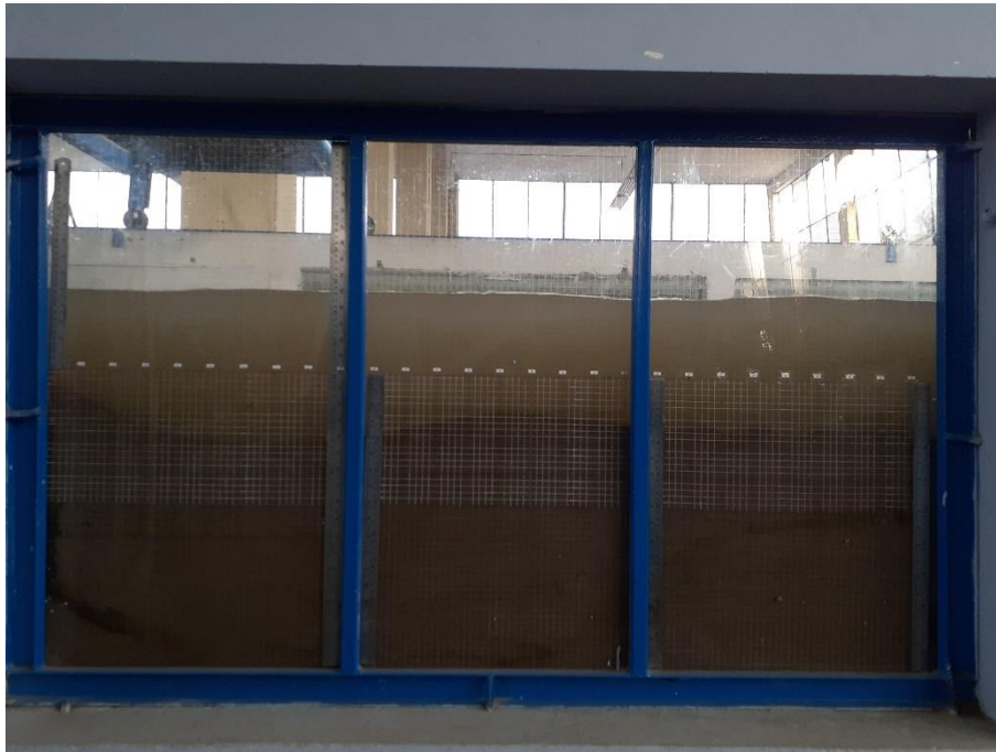
Fotografía 57: Erosión hora 10 – Caudal 105.34 l/s
