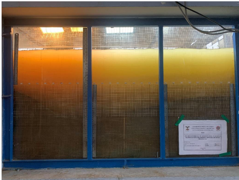
Fotografía 80: Erosión hora 03 – Caudal 232.65 l/s
