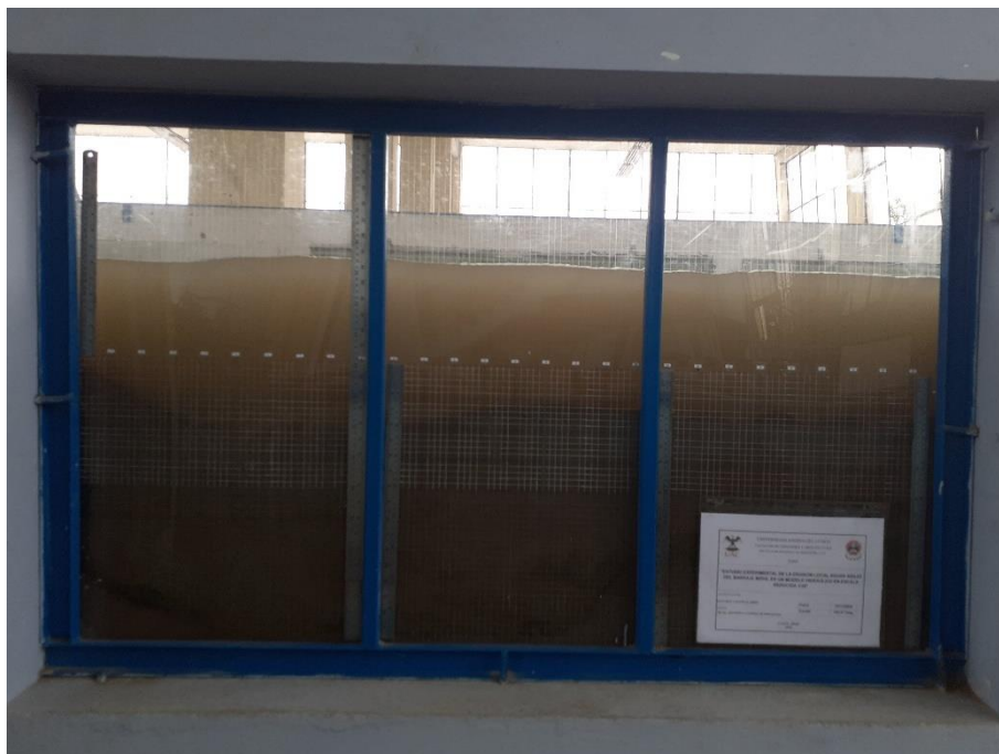
Fotografía 60: Erosión hora 03 – Caudal 148.23 l/s
