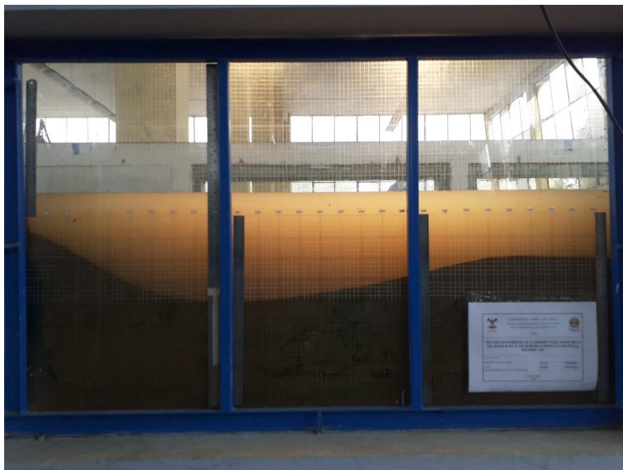
Fotografía 75: Erosión hora 09 – Caudal 189.56 l/s
