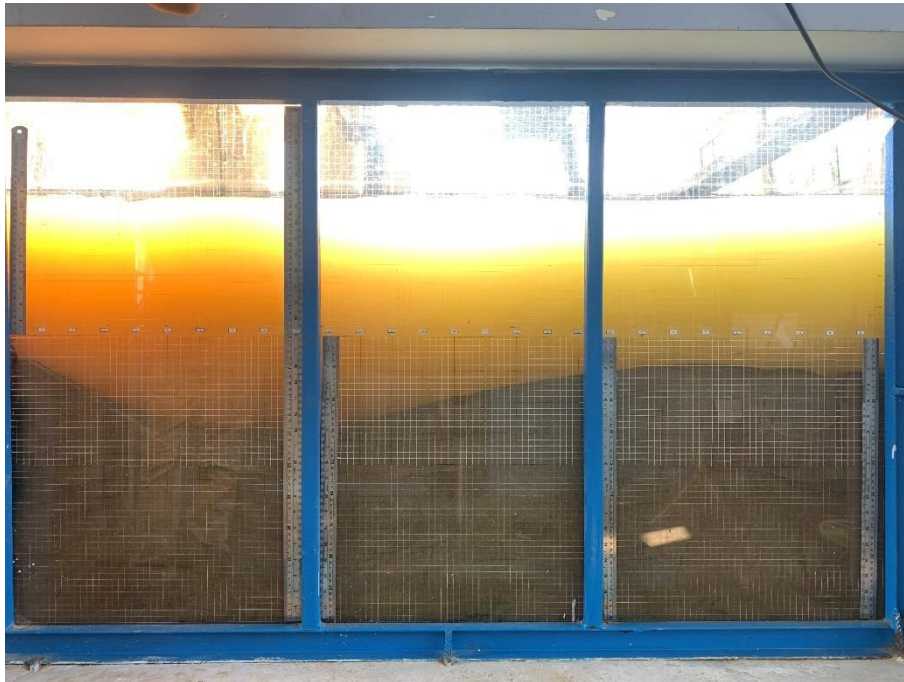
Fotografía 78: Erosión hora 01 – Caudal 232.65 l/s
