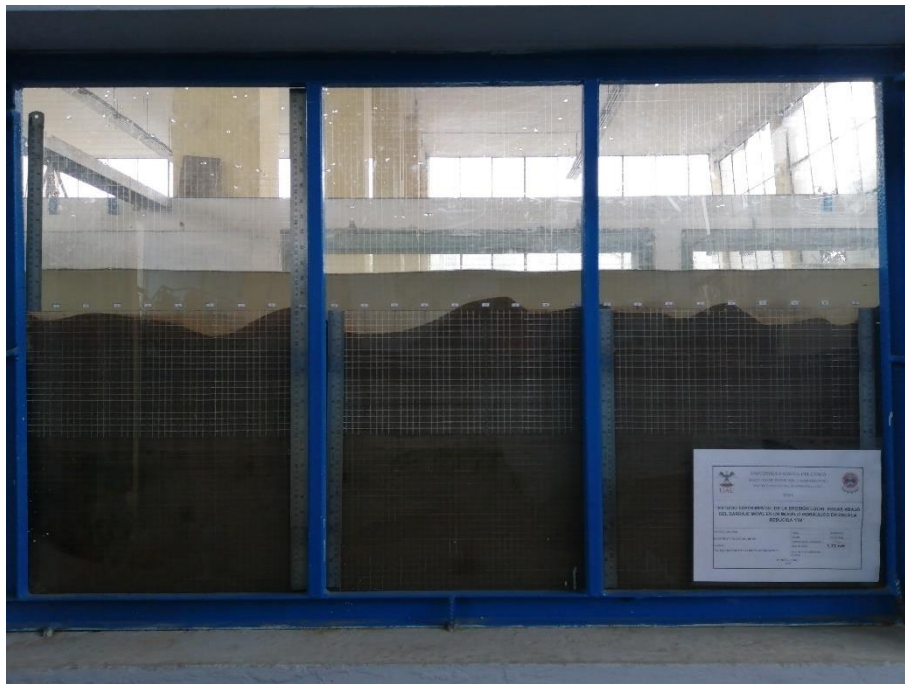
Fotografía 31: Erosión hora 02 – Caudal 29.55 l/s
