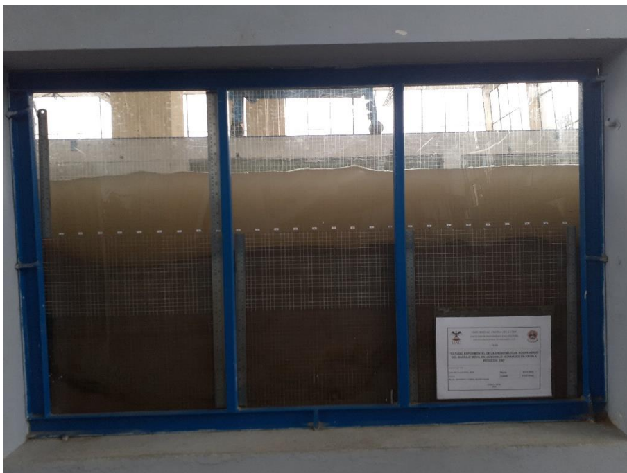
Fotografía 58: Erosión hora 01 – Caudal 148.23 l/s
