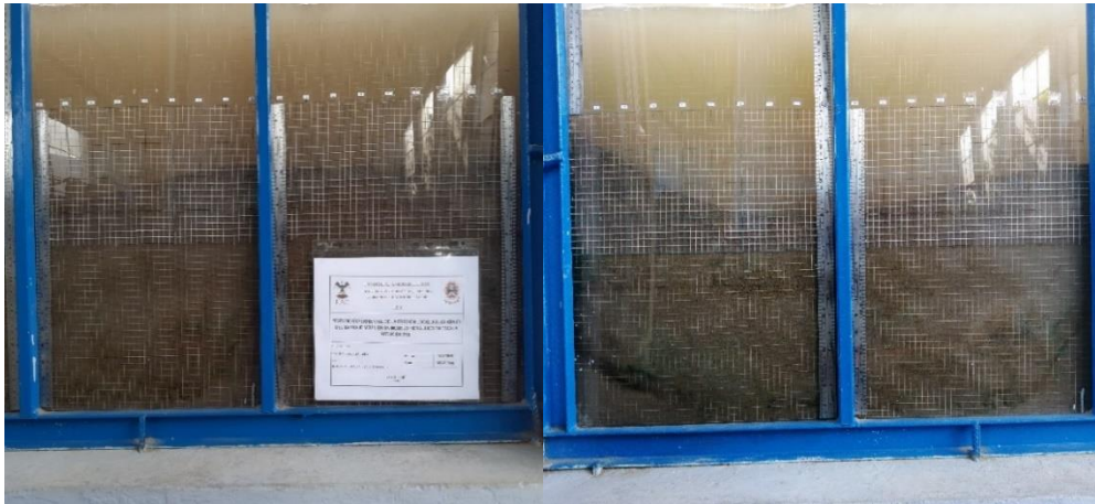
Fotografía 64: Erosión hora 07 – Caudal 148.23 l/s
