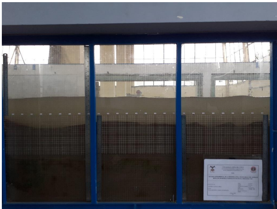
Fotografía 42: Erosión hora 06 – Caudal 63.39 l/s
