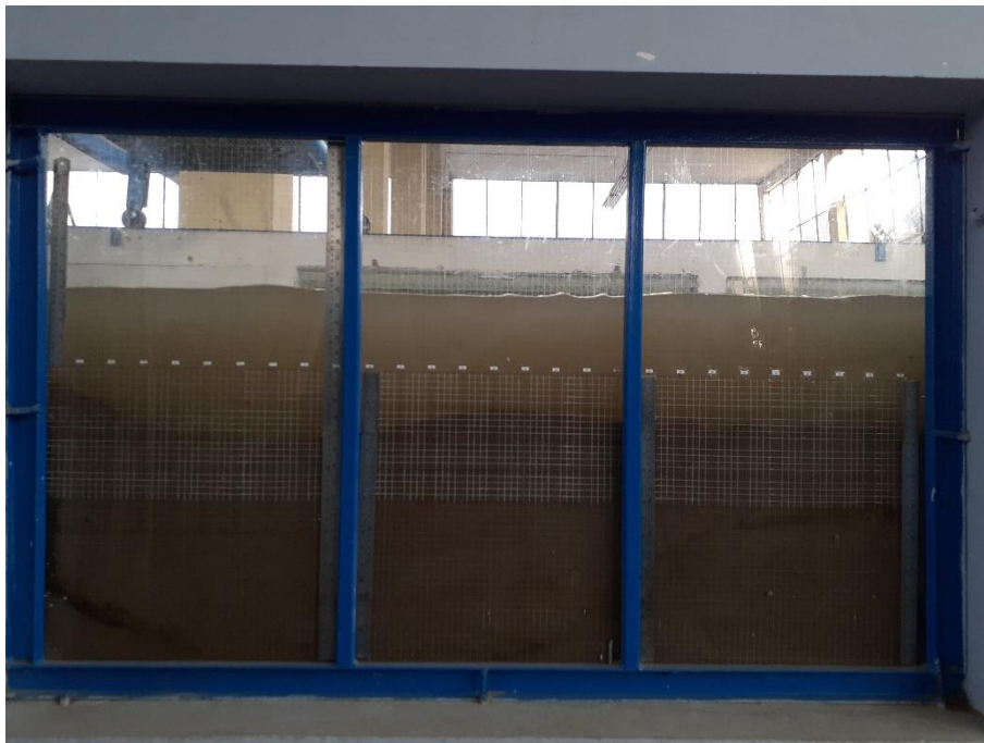
Fotografía 56: Erosión hora 09 – Caudal 105.34 l/s
