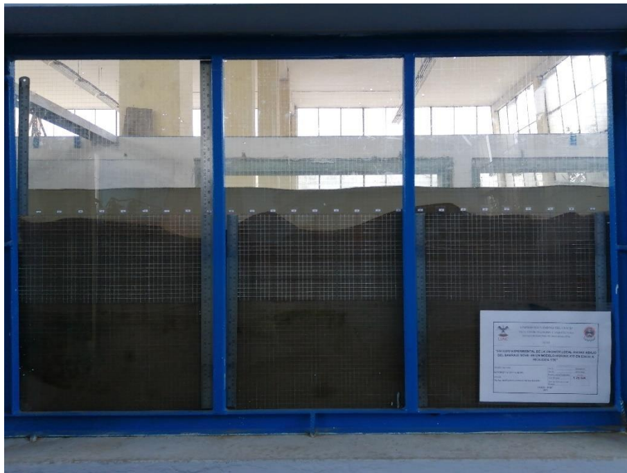
Fotografía 33: Erosión hora 04 – Caudal 29.55 l/s
