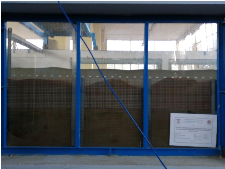
Fotografía 36: Erosión hora 07 – Caudal 29.55 l/s
