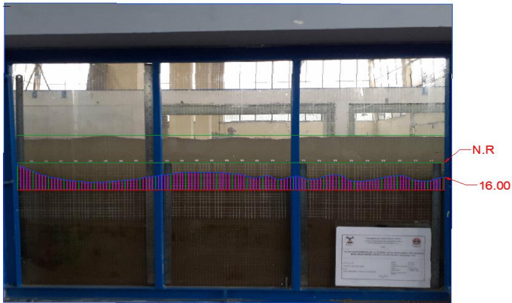
Fotografía 89: Ventana de Plexiglás y perfil de erosión.
