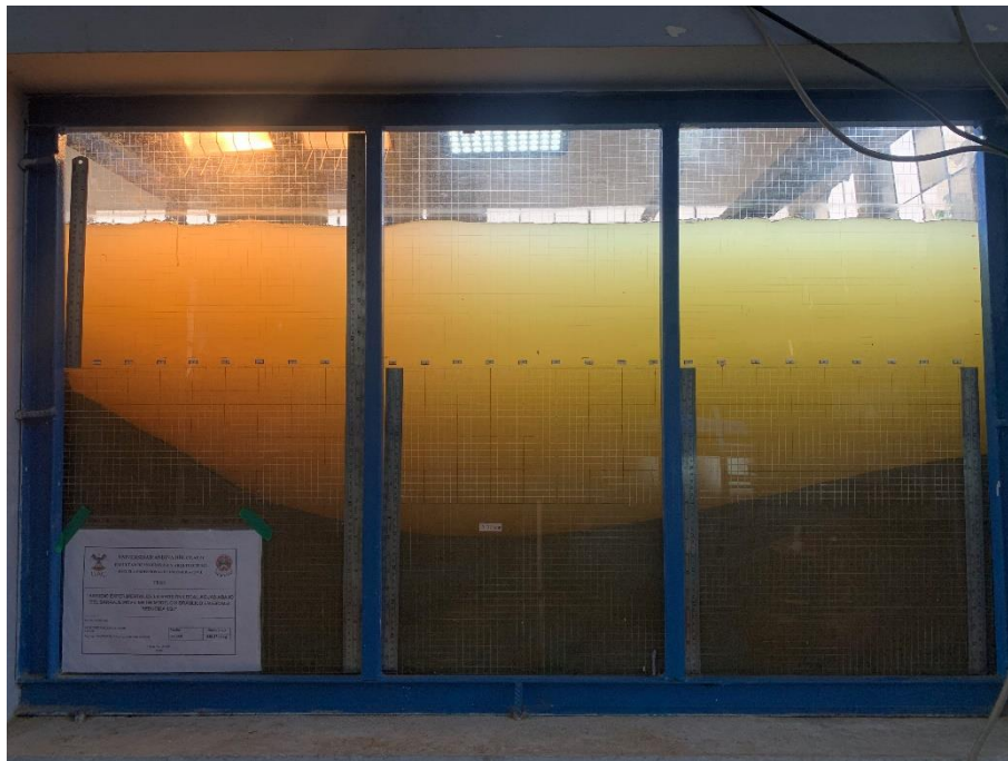
Fotografía 86: Erosión hora 9 – Caudal 232.65 l/s
