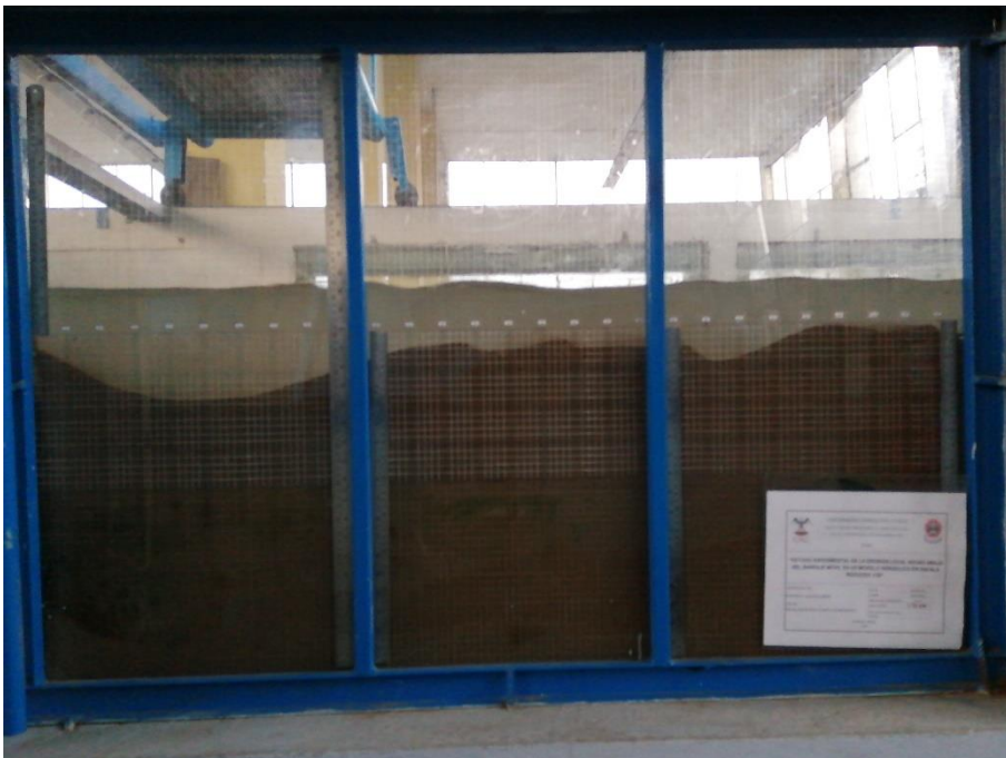
Fotografía 38: Erosión hora 09 – Caudal 29.55 l/s
