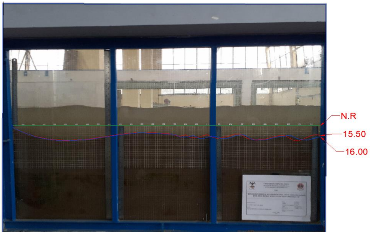
Fotografía 88: Ventana con niveles de erosión.
