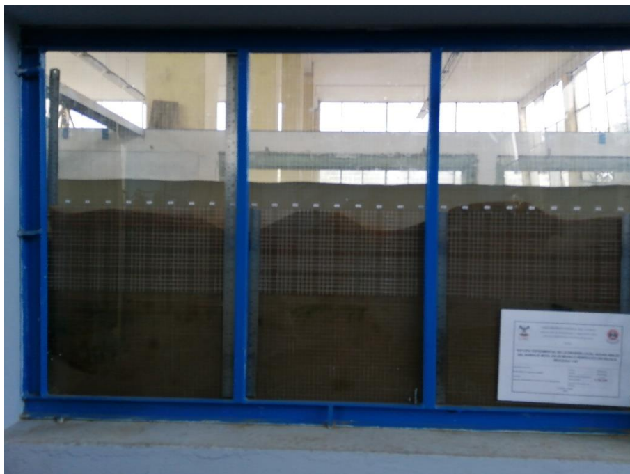
Fotografía 34: Erosión hora 05 – Caudal 29.55 l/s
