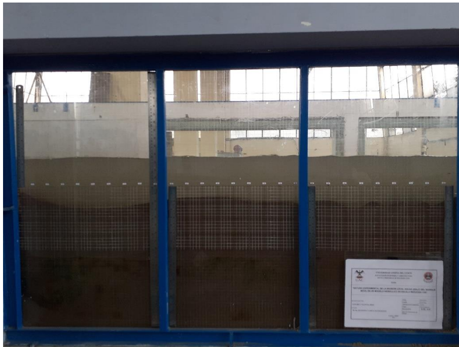
Fotografía 43: Erosión hora 07 – Caudal 63.39 l/s
