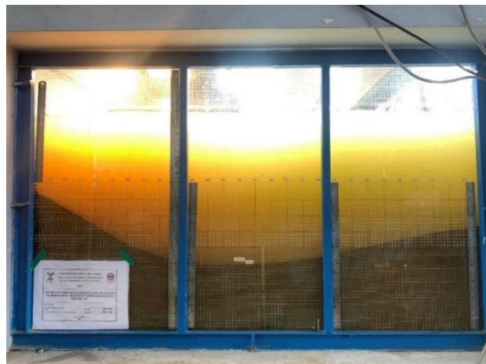
Fotografía 7: Ventana de observación de erosión
