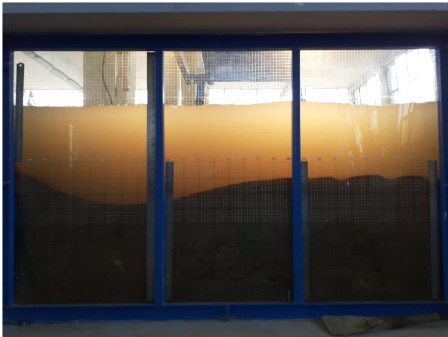
Fotografía 67: Erosión hora 01 – Caudal 189.56 l/s
