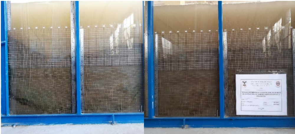
Fotografía 63: Erosión hora 06 – Caudal 148.23 l/s
