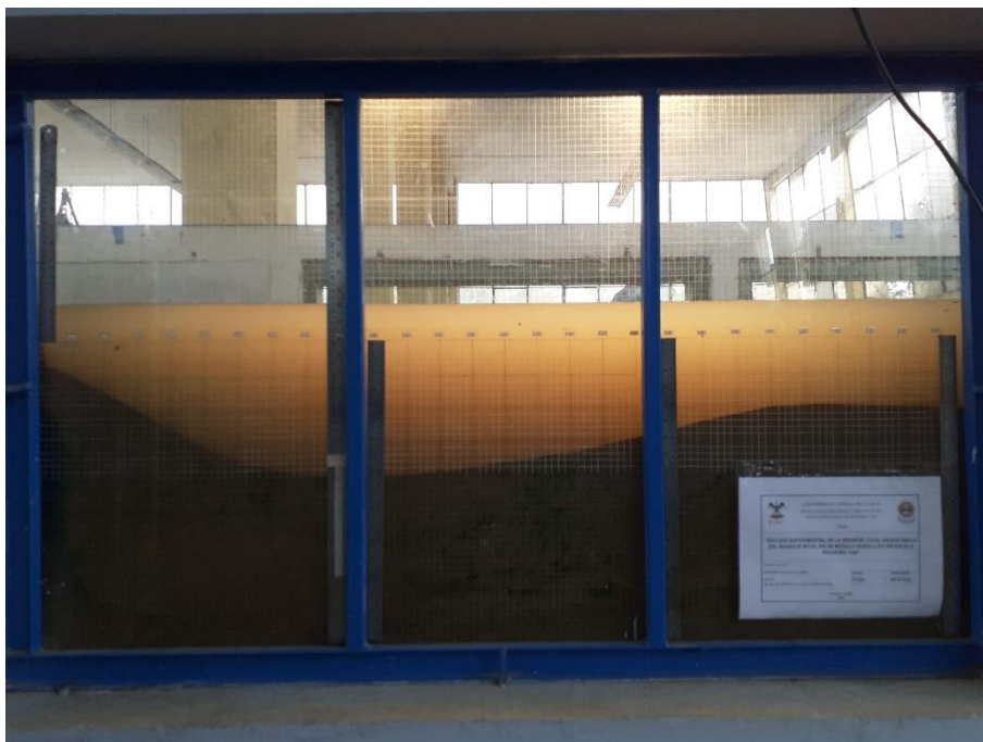
Fotografía 73: Erosión hora 07 – Caudal 189.56 l/s
