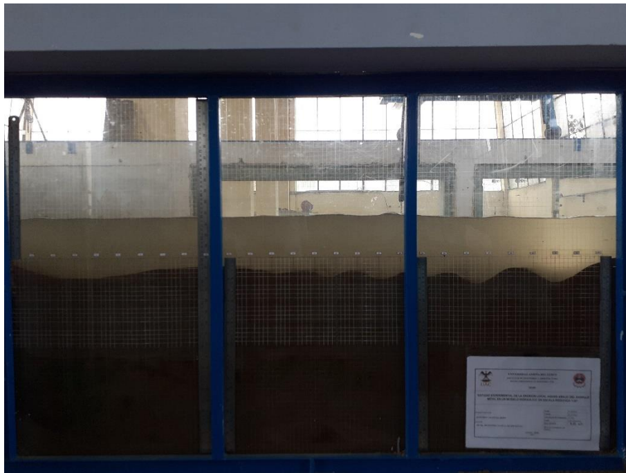
Fotografía 39: Erosión hora 03 – Caudal 63.39 l/s
