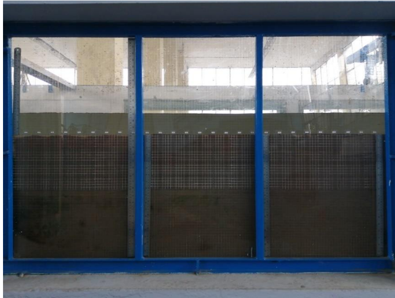
Fotografía 29: Erosión inicial hora 00 – Caudal 29.55 l/s
