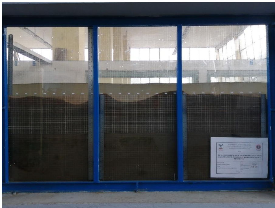
Fotografía 32: Erosión hora 03 – Caudal 29.55 l/s
