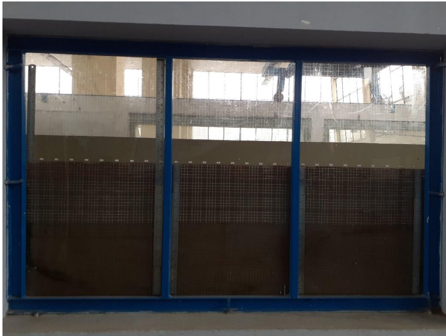
Fotografía 47: Erosión hora 00 – Caudal 105.34 l/s
