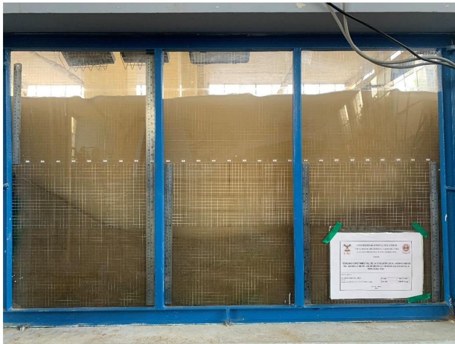
Fotografía 84: Erosión hora 7 – Caudal 232.65 l/s
