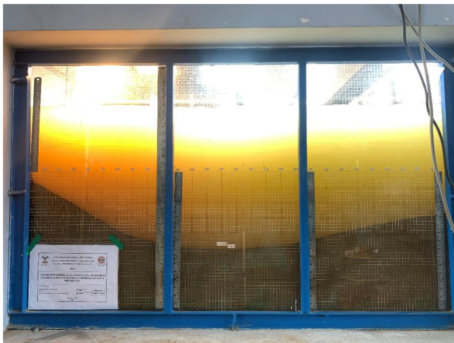
Fotografía 87: Erosión hora 10 – Caudal 232.65 l/s
