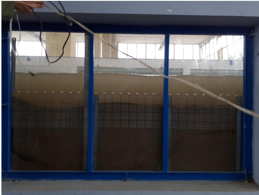
Fotografía 51: Erosión hora 04 – Caudal 105.34 l/s
