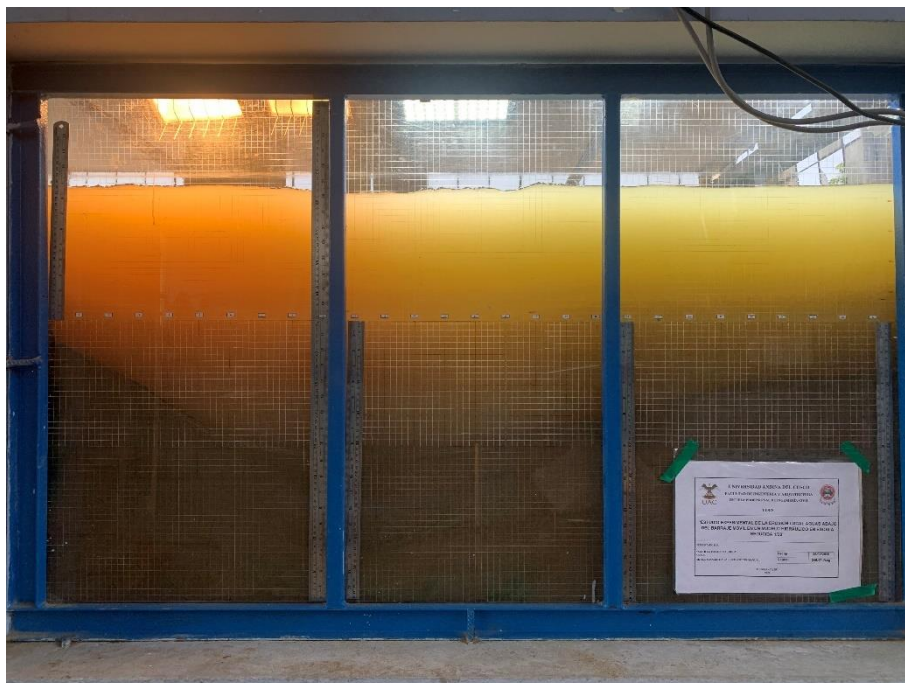
Fotografía 81: Erosión hora 4 – Caudal 232.65 l/s
