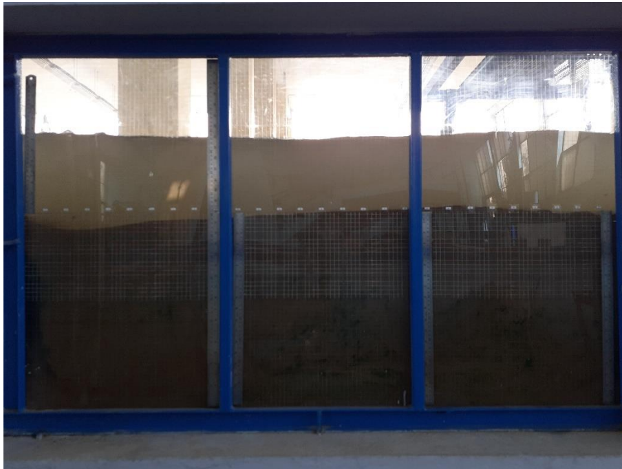
Fotografía 66: Erosión hora 00 – Caudal 189.56 l/s
