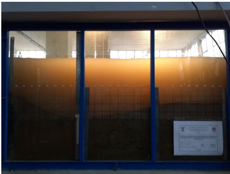
Fotografía 71: Erosión hora 05 – Caudal 189.56 l/s
