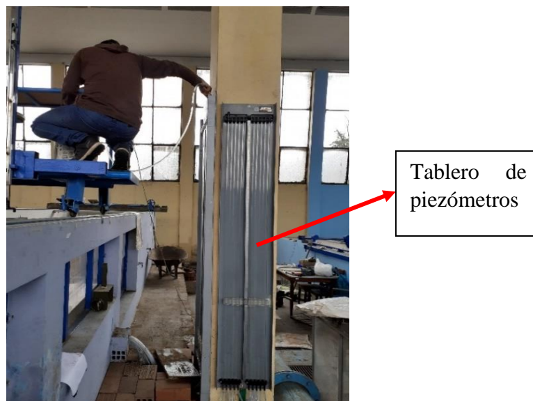
Fotografía 27: Tablero de piezómetros
