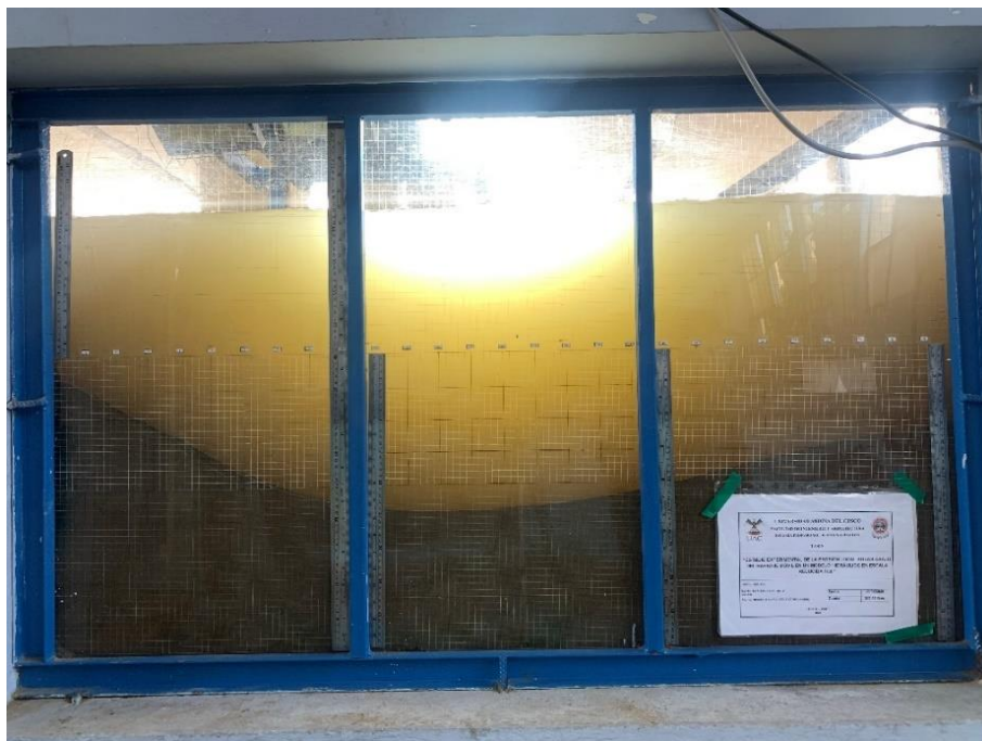
Fotografía 85: Erosión hora 8 – Caudal 232.65 l/s
