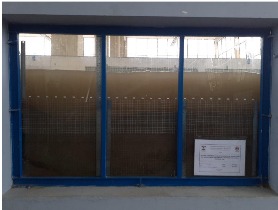
Fotografía 61: Erosión hora 04 – Caudal 148.23 l/s
