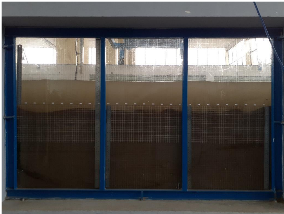
Fotografía 48: Erosión hora 01 – Caudal 105.34 l/s
