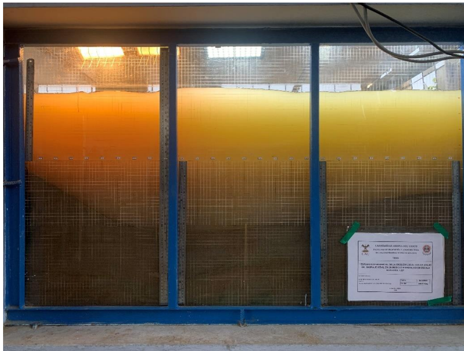
Fotografía 82: Erosión hora 5 – Caudal 232.65 l/s
