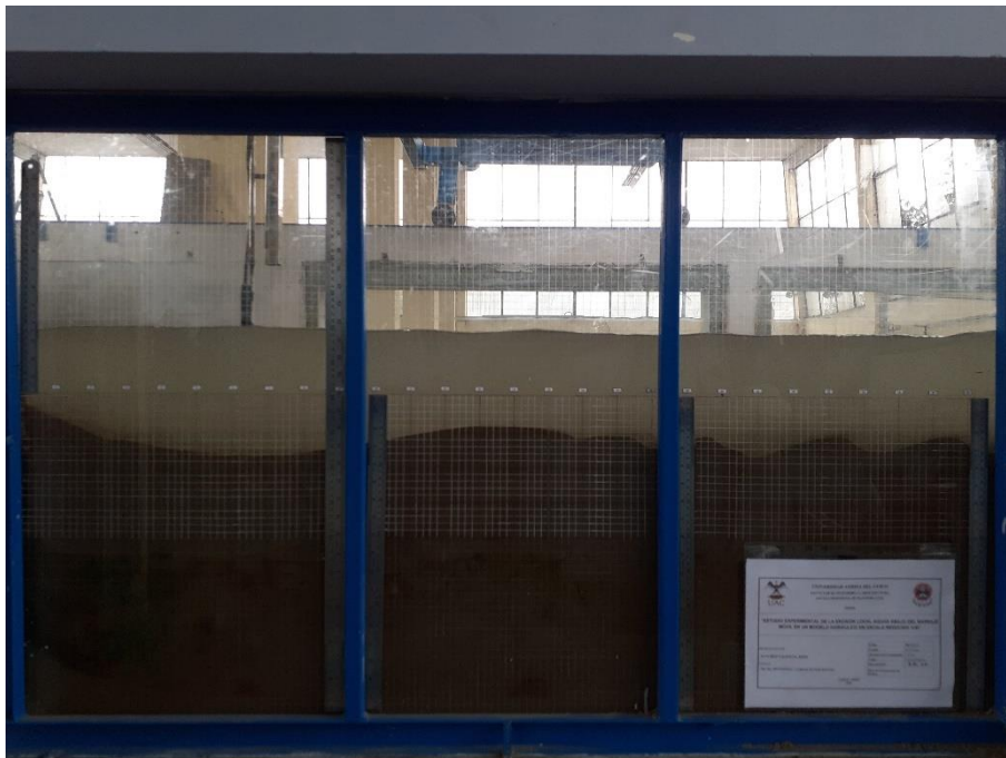
Fotografía 46: Erosión hora 10 – Caudal 63.39 l/s
