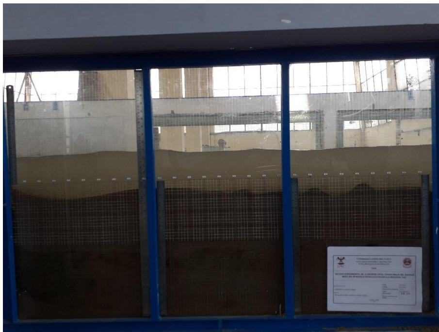
Fotografía 40: Erosión hora 04 – Caudal 63.39 l/s
