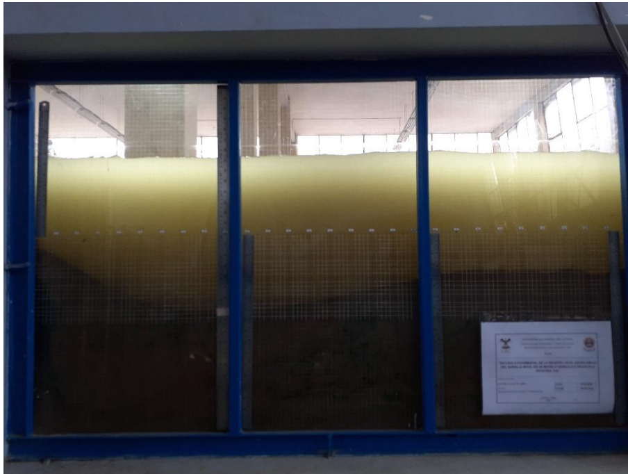
Fotografía 70: Erosión hora 04 – Caudal 189.56 l/s
