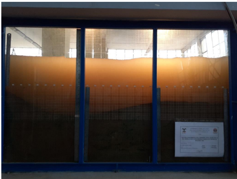
Fotografía 69: Erosión hora 03 – Caudal 189.56 l/s
