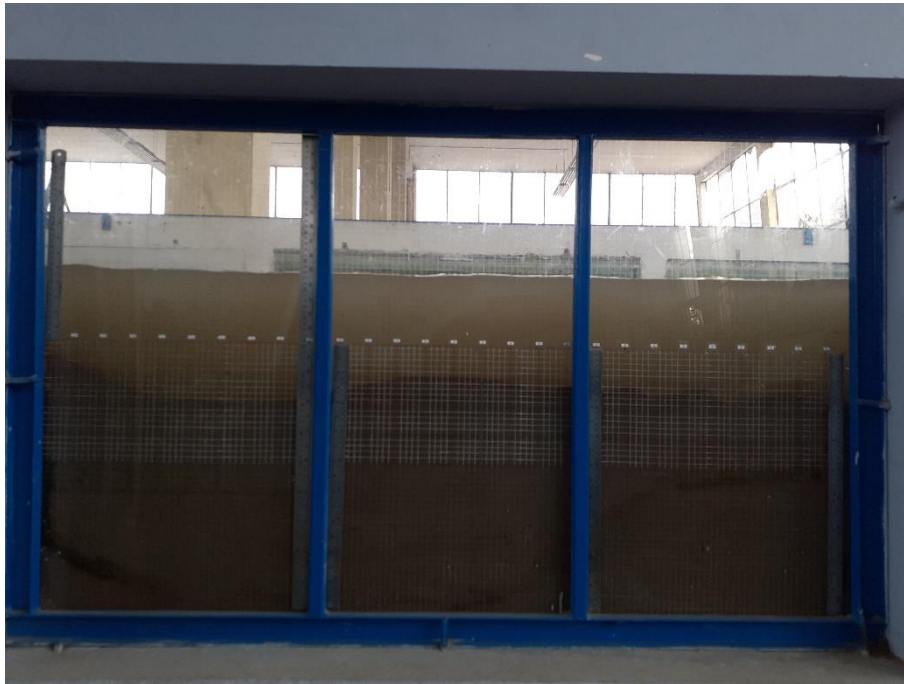
Fotografía 53: Erosión hora 06 – Caudal 105.34 l/s
