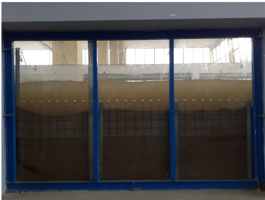
Fotografía 50: Erosión hora 03 – Caudal 105.34 l/s
