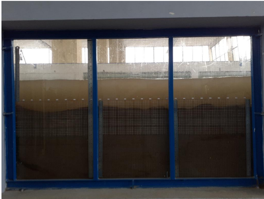
Fotografía 49: Erosión hora 02 – Caudal 105.34 l/s
