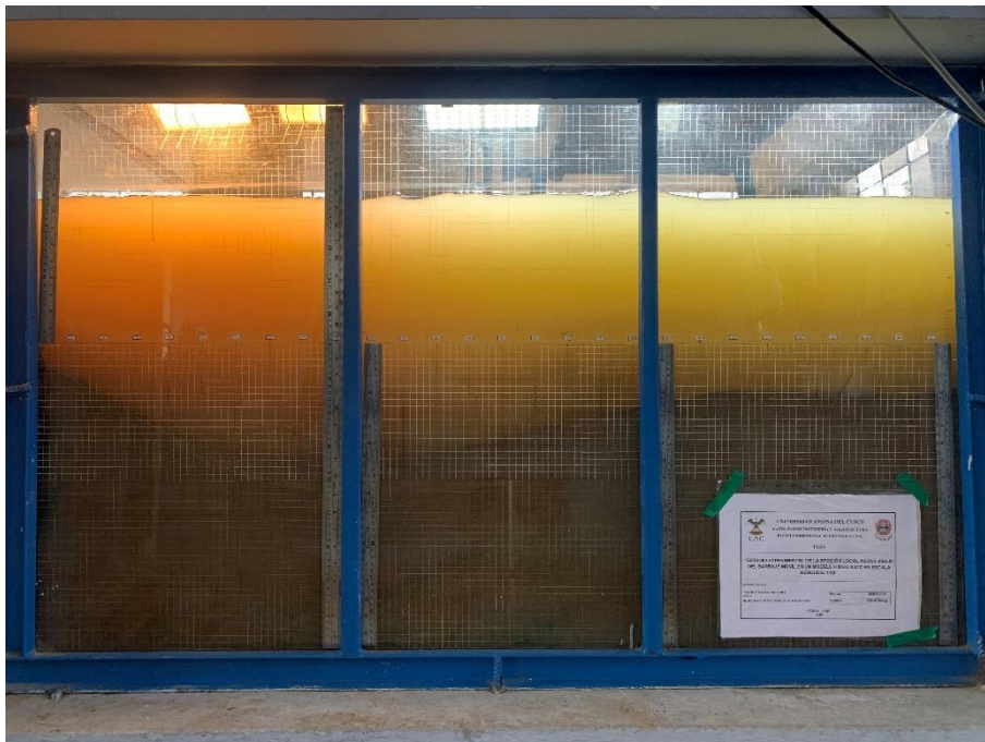
Fotografía 79: Erosión hora 02 – Caudal 232.65 l/s
