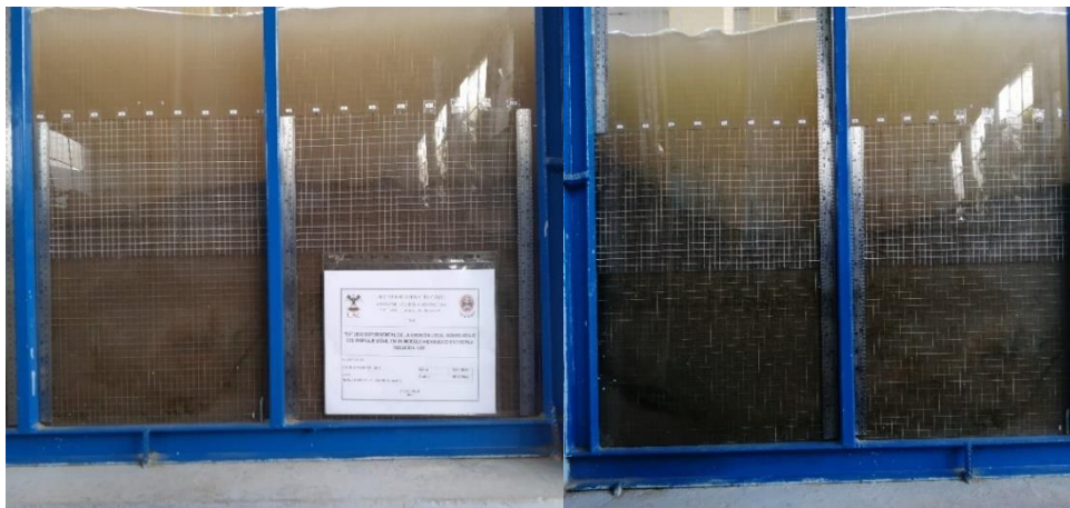
Fotografía 65: Erosión hora 08 – Caudal 148.23 l/s
