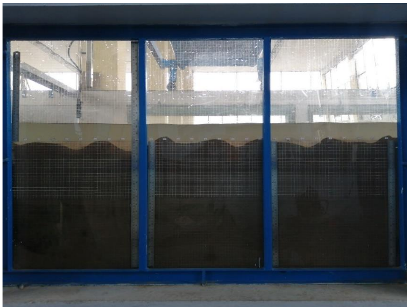
Fotografía 30: Erosión hora 01 – Caudal 29.55 l/s
