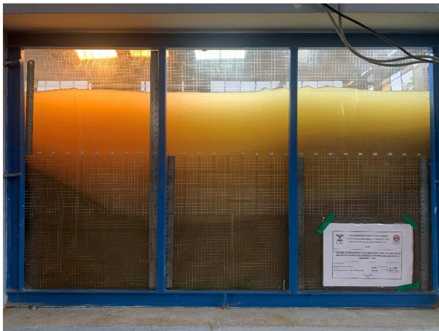
Fotografía 83: Erosión hora 6 – Caudal 232.65 l/s
