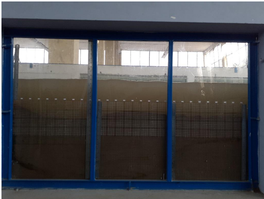
Fotografía 54: Erosión hora 07 – Caudal 105.34 l/s
