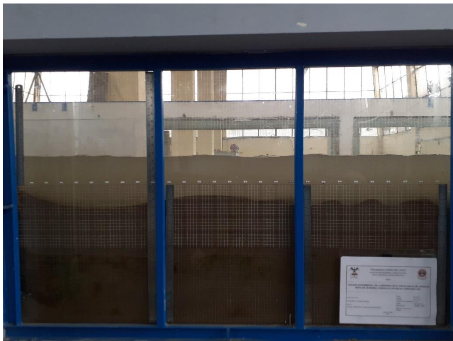
Fotografía 44: Erosión hora 08 – Caudal 63.39 l/s
