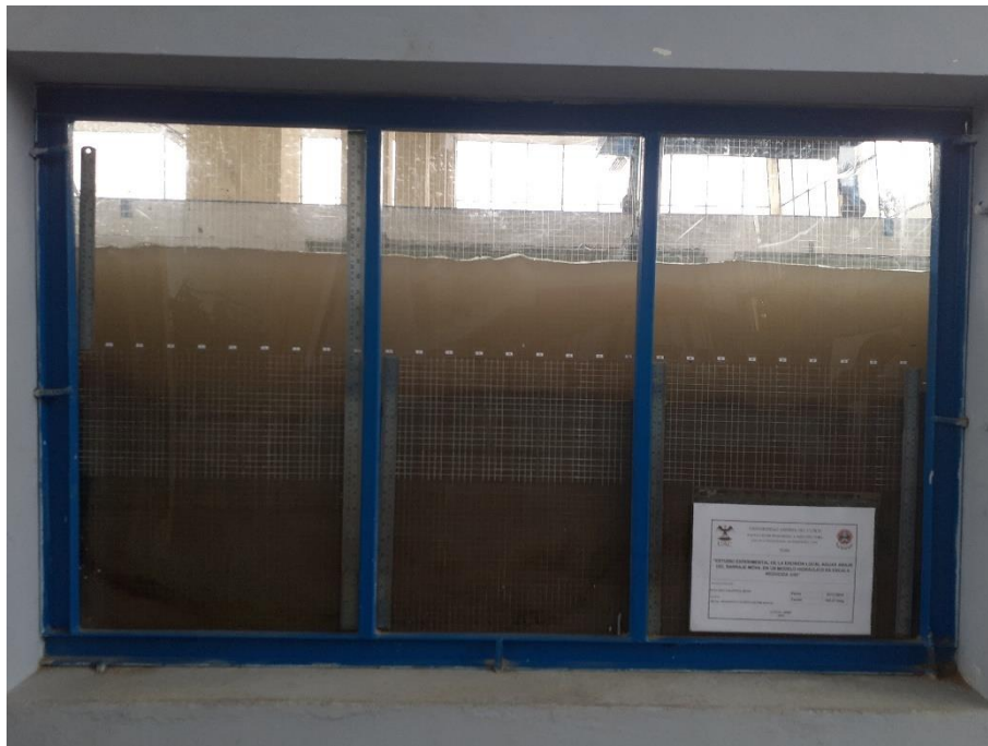
Fotografía 59: Erosión hora 02 – Caudal 148.23 l/s
