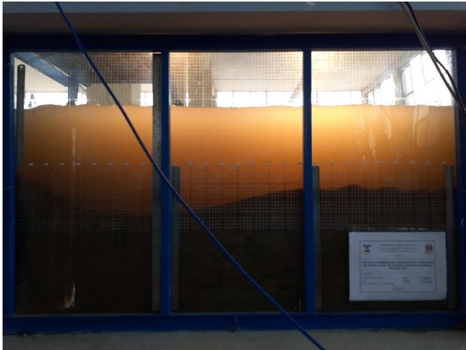
Fotografía 68: Erosión hora 02 – Caudal 189.56 l/s
