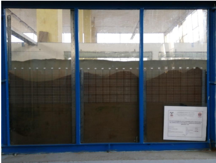
Fotografía 37: Erosión hora 08 – Caudal 29.55 l/s
