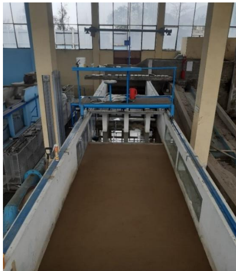
Fotografía 14: Lecho compactado y nivelado previo al ensayo
