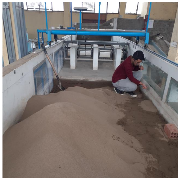
Fotografía 19: Proceso de cambio y compactado de lecho
