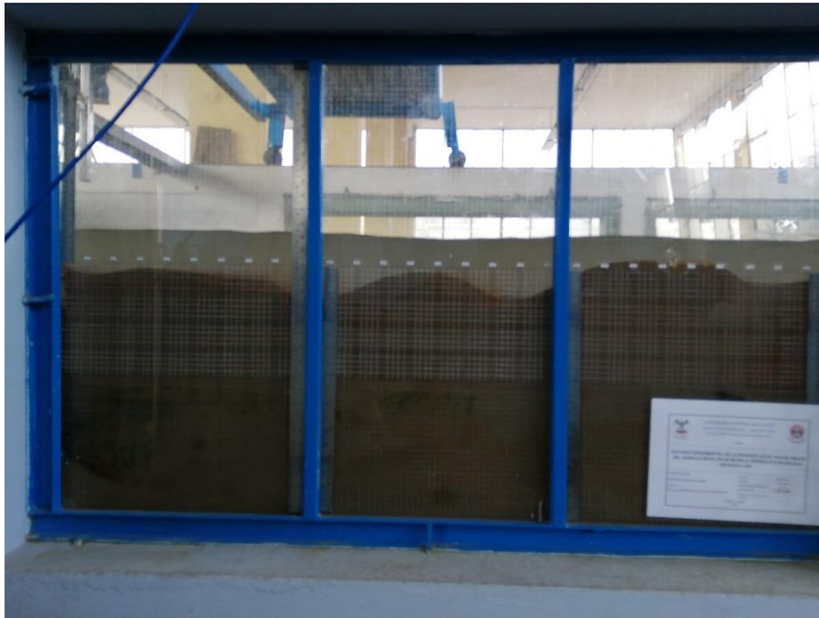
Fotografía 35: Erosión hora 06 – Caudal 29.55 l/s
