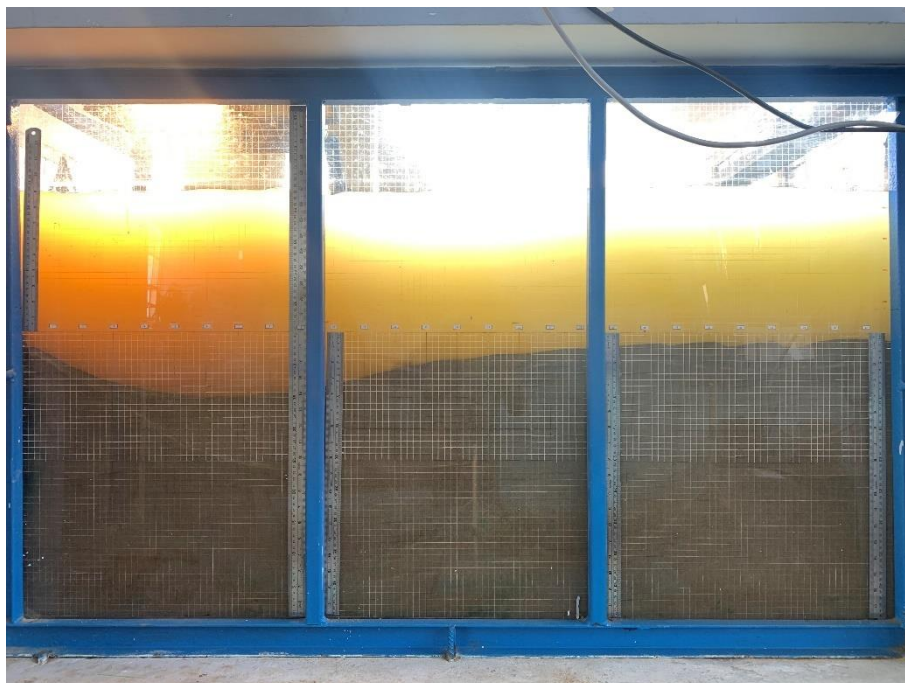
Fotografía 77: Erosión hora 00 – Caudal 232.65 l/s
