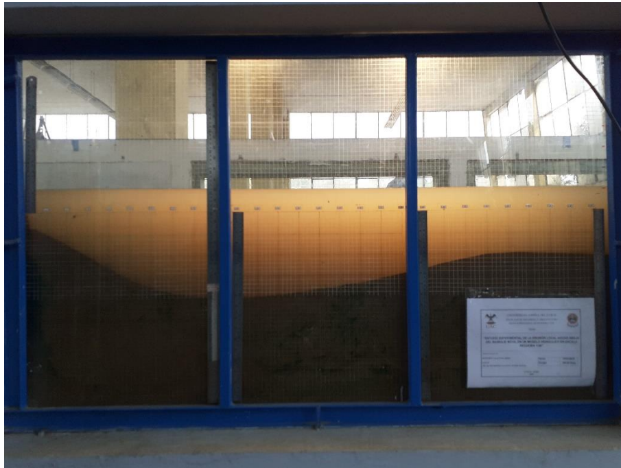
Fotografía 76: Erosión hora 10 – Caudal 189.56 l/s
