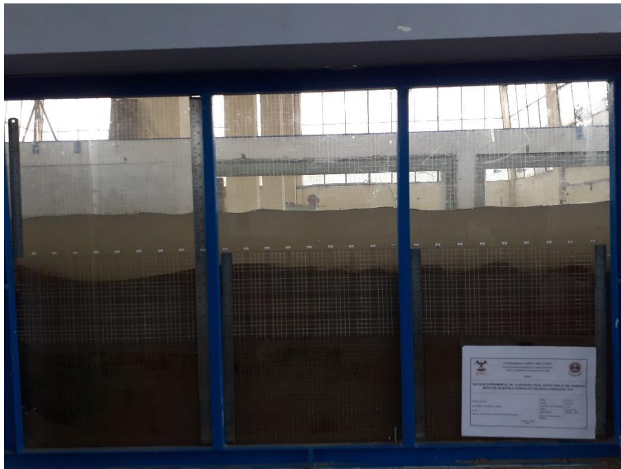
Fotografía 41: Erosión hora 05 – Caudal 63.39 l/s
