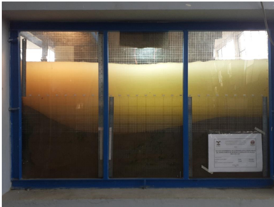
Fotografía 74: Erosión hora 08 – Caudal 189.56 l/s
