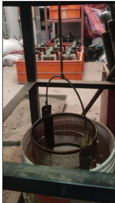
*Figura N°53. Pesado de las probetas sumergidas en agua – Gravedad Específica Bulk*
