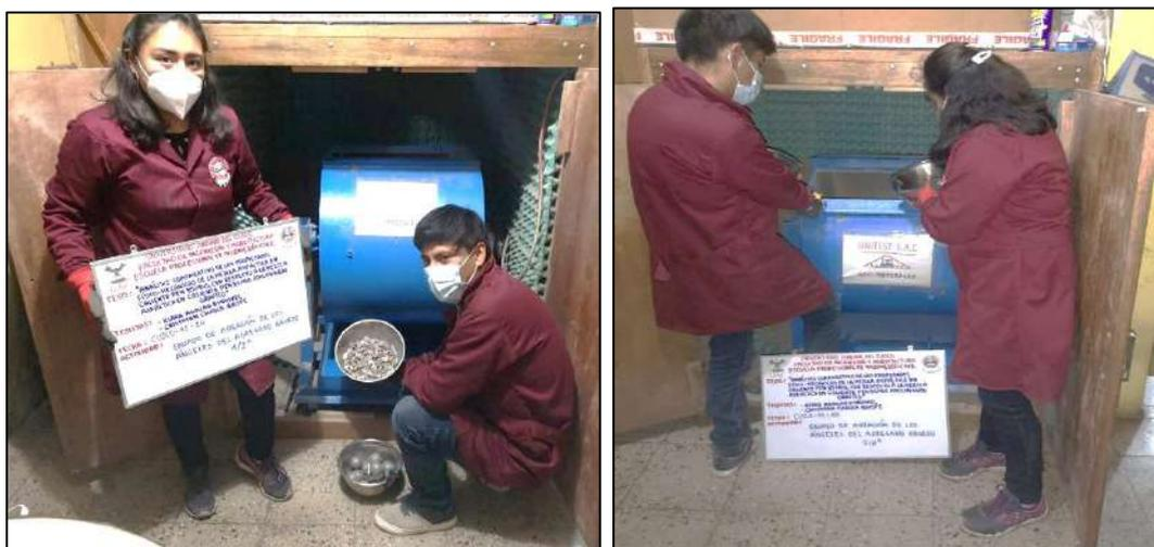
Figura N°29. Aseguramiento del cerrado de la máquina de los Ángeles - Ensayo de abrasión los ángeles
