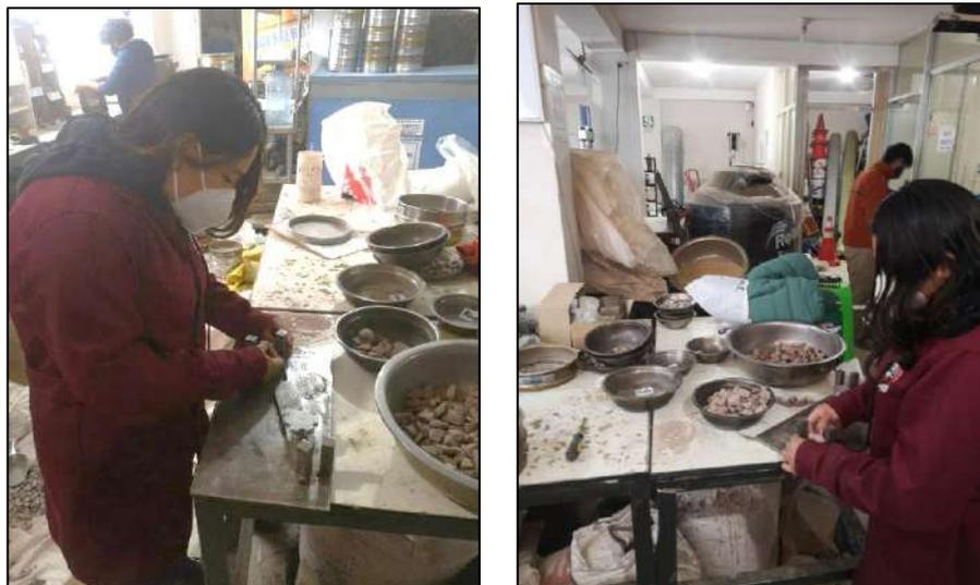
*Figura N°34. Pesado de las partículas calibradas - Ensayo de partículas chatas y alargadas en agregados*
