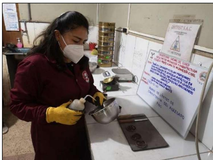
Figura N°43. Límites de consistencia – Aumentando el contenido de humedad
