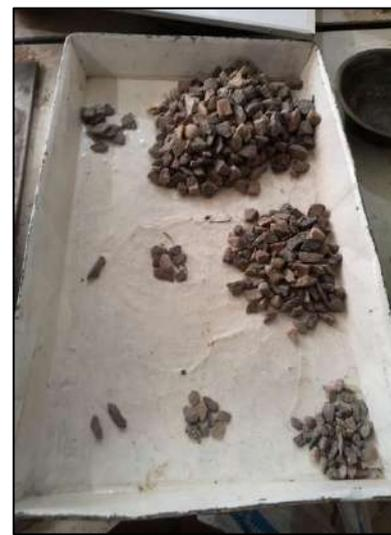
*Figura N°37. Distribución de las caras fracturadas - Ensayo de caras fracturadas*
