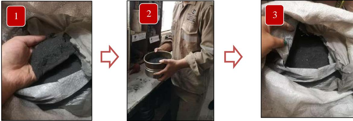
Figura N°19. Procedimiento de tamizado del grafito
