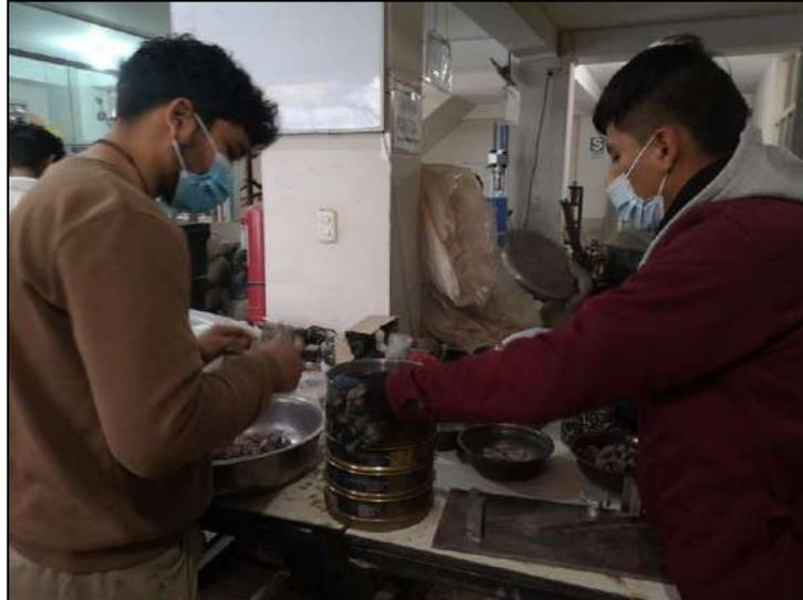
*Figura N°33. Separación de las piedras calibradas - Ensayo de partículas chatas y alargadas en agregados*
