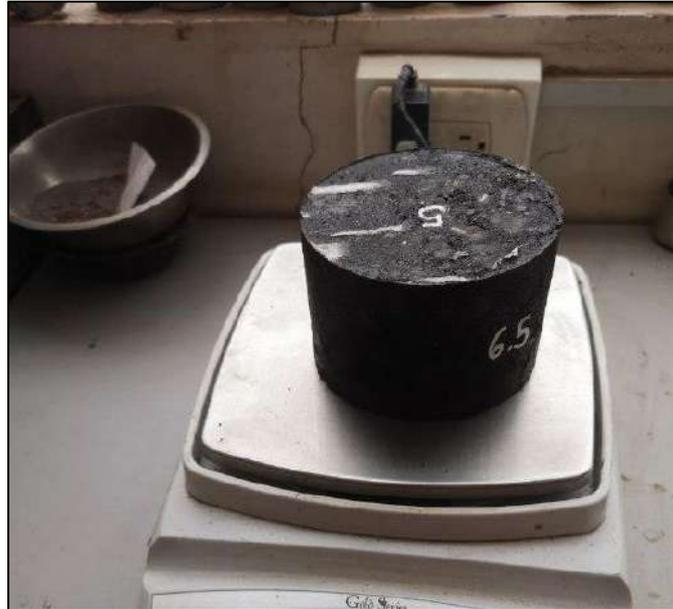
*Figura N°52. Pesado de las probetas realizadas sin grafito y con grafito – Gravedad específica bulk*
