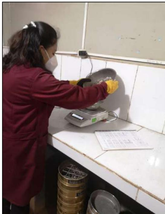
*Figura N°40. Peso específico y absorción – Pesado del agregado grueso  $\frac{3}{4}$ " y  $\frac{1}{2}$ "*
