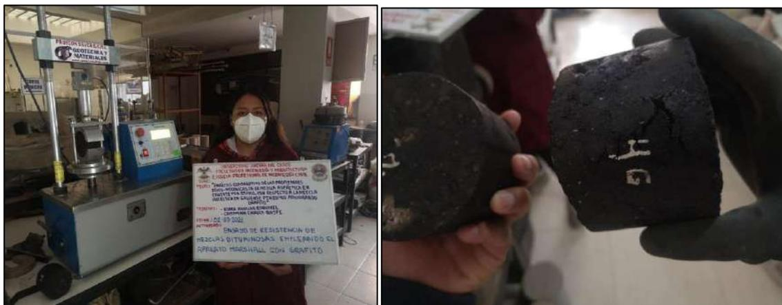
Figura N°58. Rotura de especímenes – Ensayo de estabilidad y flujo Marshall
