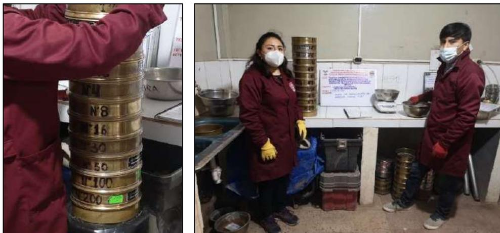
Figura N°23. Ordenado de los tamices según abertura - Ensayo de análisis granulométrico
