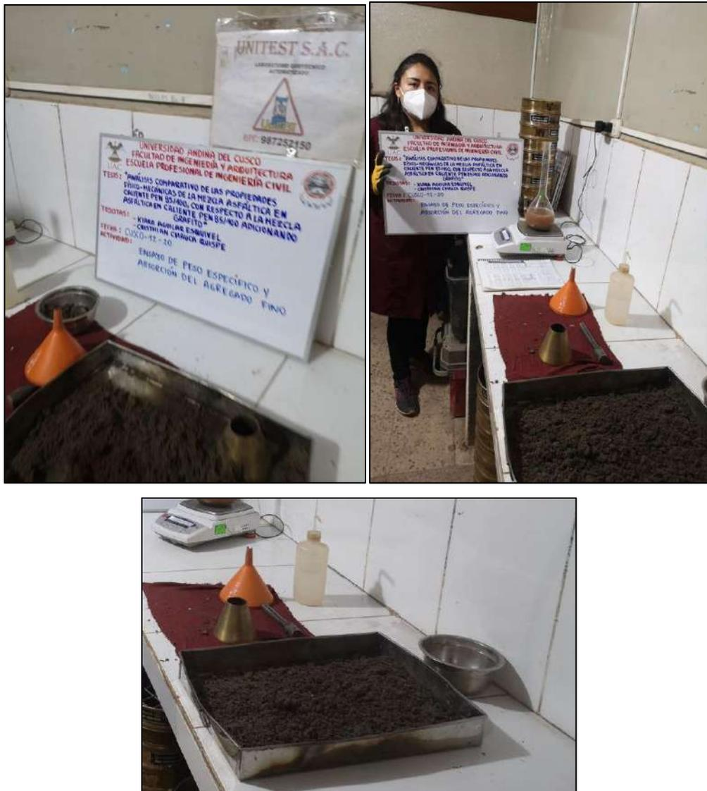
Figura N°38. Peso específico y absorción – Colocado en recipiente durante 24 hrs
