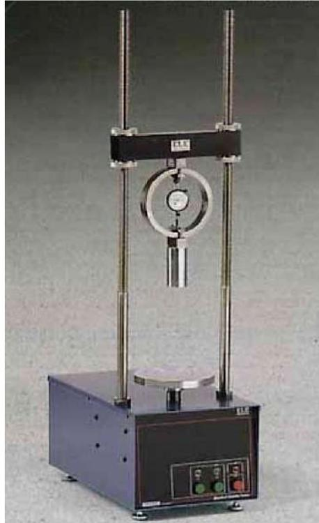
*Figura N°17. Máquina de Estabilidad Marshall con anillo de carga*
