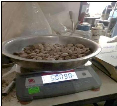
*Figura N°26. Pesado del agregado - Ensayo de abrasión los ángeles*
