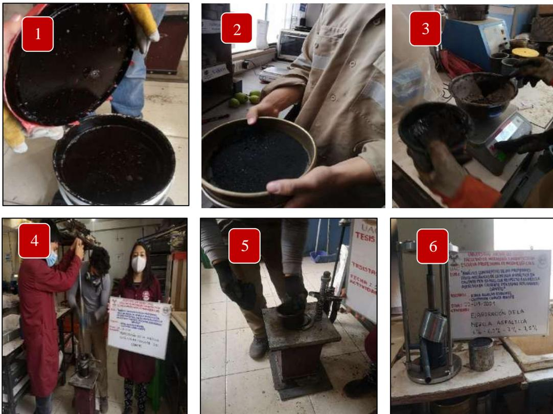
Figura N°55. Proceso de elaboración de especímenes asfálticos – Ensayo de estabilidad y flujo Marshall
