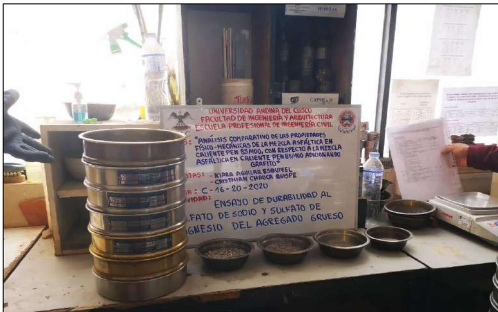
Figura N°48. Durabilidad del agregado al sulfato de magnesio – Tamizado
