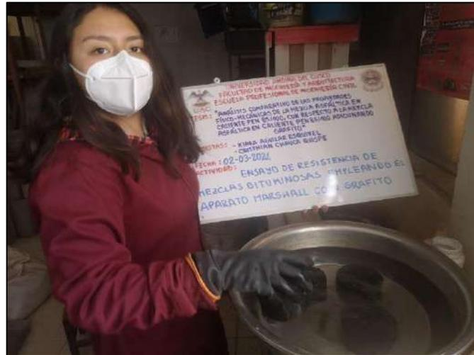
Figura N°57. Sumergido de Especímenes en baño maría – Ensayo de estabilidad y flujo Marshall
