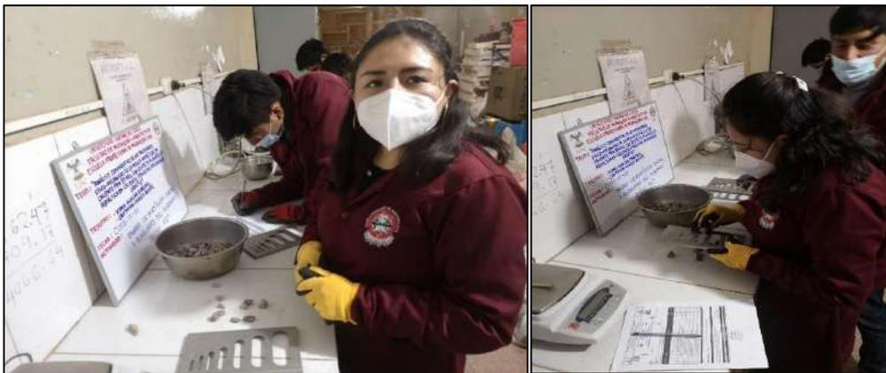
*Figura N°31. Enumerando cada piedra del agregado - Ensayo de partículas chatas y alargadas en agregados*
