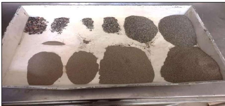
*Figura N°25. Pesado de cada tamiz de los agregados - Ensayo de análisis granulométrico*
