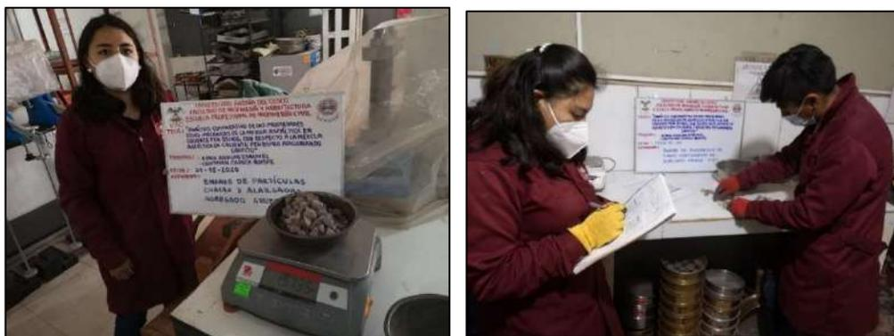
*Figura N°32. Medición de las piedras con vernier y toma de datos- Ensayo de partículas chatas y alargadas en agregados*
