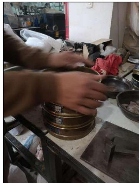
*Figura N°30. Tamizado del agregado - Ensayo de abrasión los ángeles*
