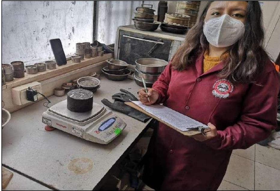
*Figura N°61. Registro de medidas de los especímenes – Ensayo al daño inducido por humedad*
