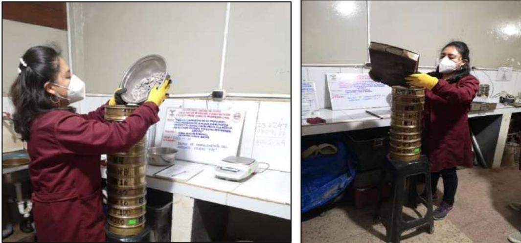
*Figura N°24. Tamizado de los agregados - Ensayo de análisis granulométrico*
