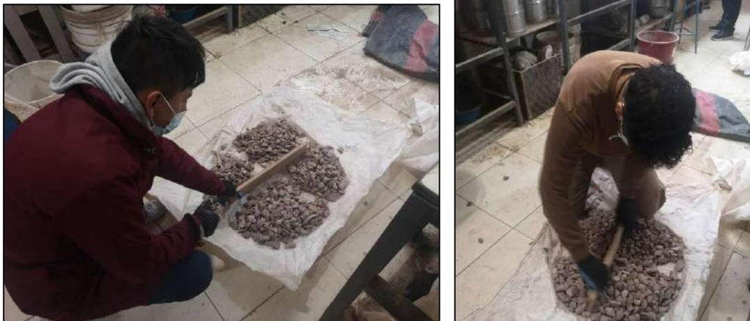
*Figura N°21. Cuarteo del agregado - Ensayo de análisis granulométrico*
