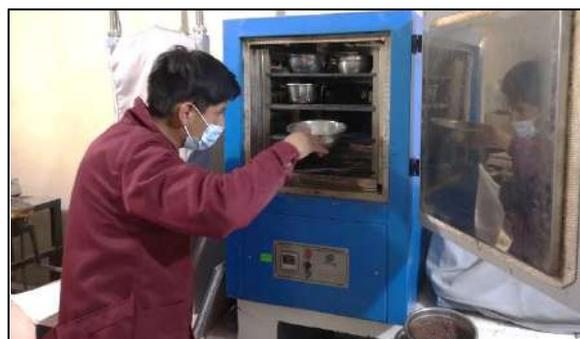
*Figura N°27. Agregado llevado al horno - Ensayo de abrasión los ángeles*
