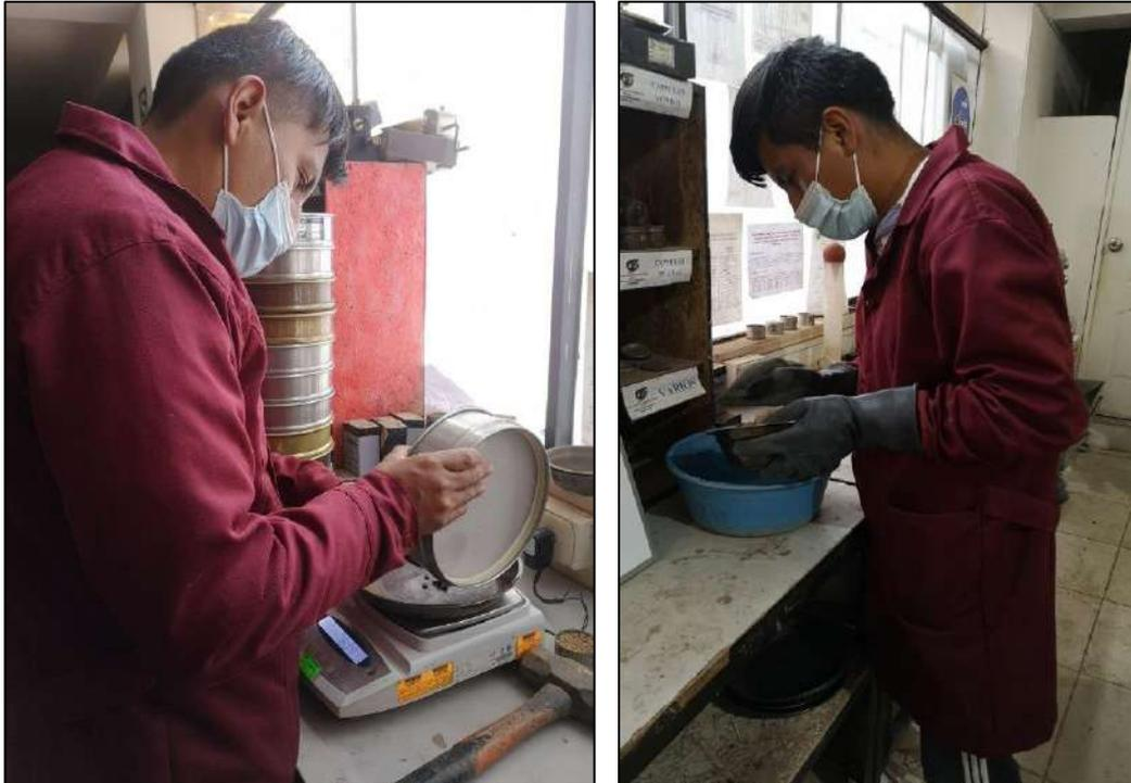
*Figura N°49. Durabilidad del agregado al sulfato de magnesio – Colocado del reactivo*
