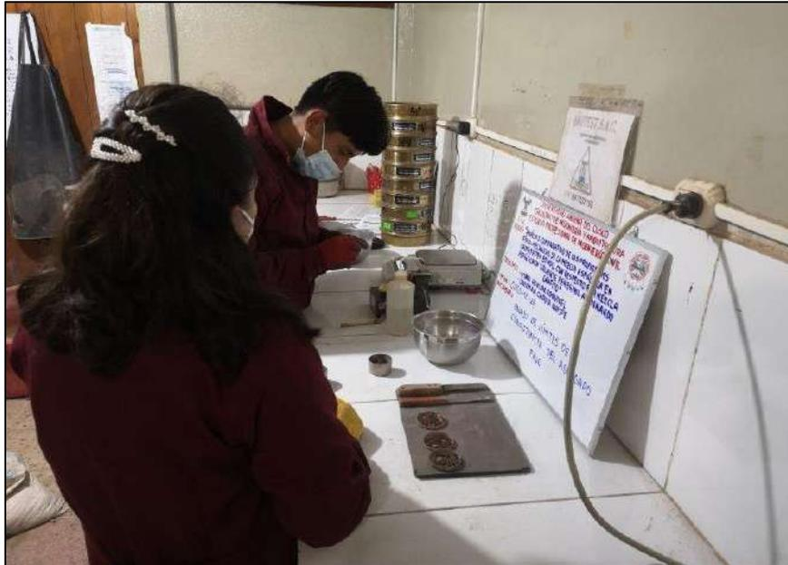
Figura N°42. Límites de consistencia – Trazado de la ranura
