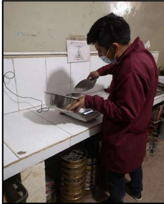
*Figura N°39. Peso Específico y Absorción – Pesado de la muestra*
