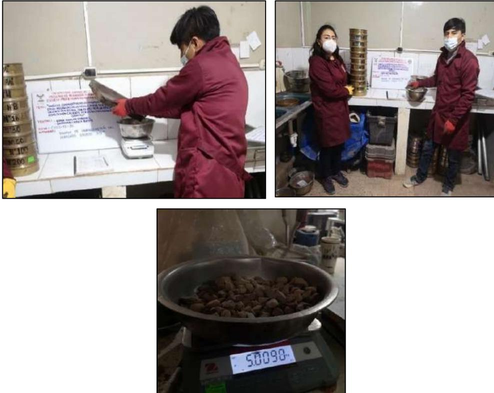
Figura N°22. Pesado de la cantidad requerida - Ensayo de análisis granulométrico
