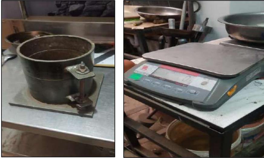
Figura N°44. Angularidad de finos – Calibración de la balanza y del molde
