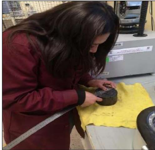
*Figura N°56. Medición de especímenes – Ensayo de estabilidad y flujo Marshall*
