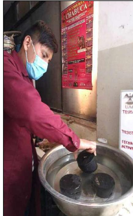
*Figura N°62. Especímenes sumergidos – Ensayo al daño inducido por humedad*
