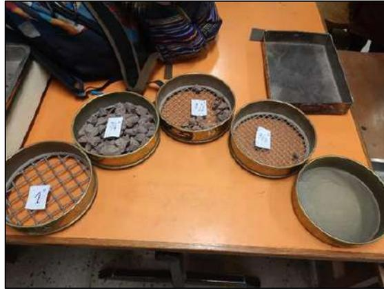
*Figura N°36. Tamices separados - Ensayo de caras fracturadas*
