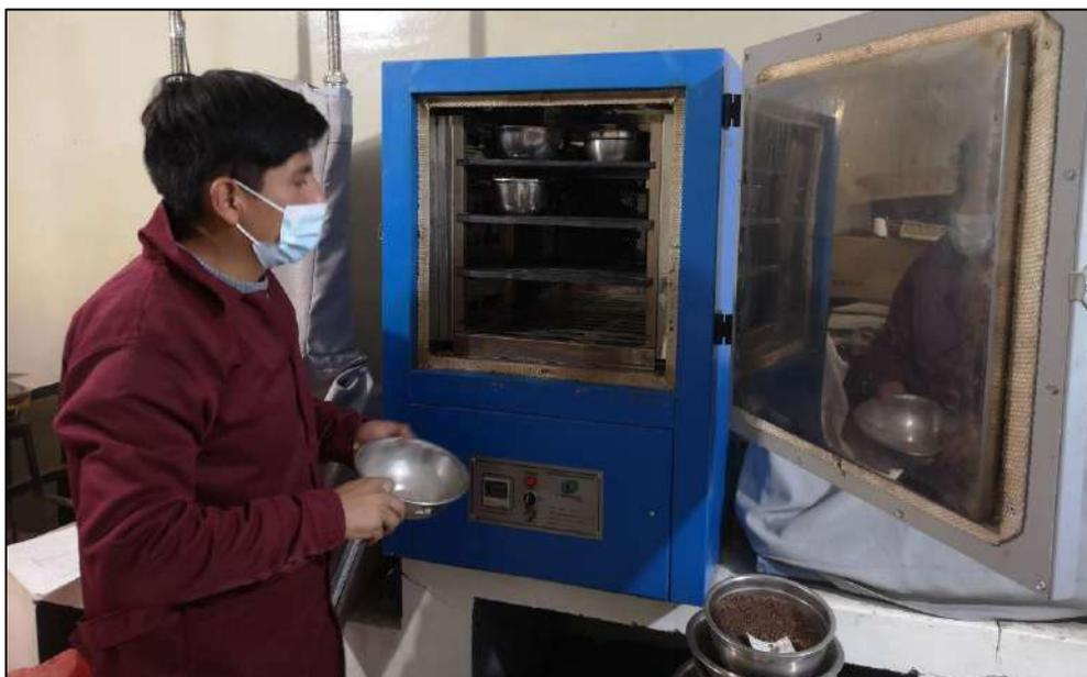
*Figura N°50. Durabilidad del agregado al sulfato de magnesio – Colocado al horno*
