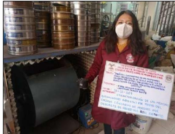
Figura N°59. Cántabro pérdida por desgaste – Introducción de los especímenes con grafito y sin grafito
