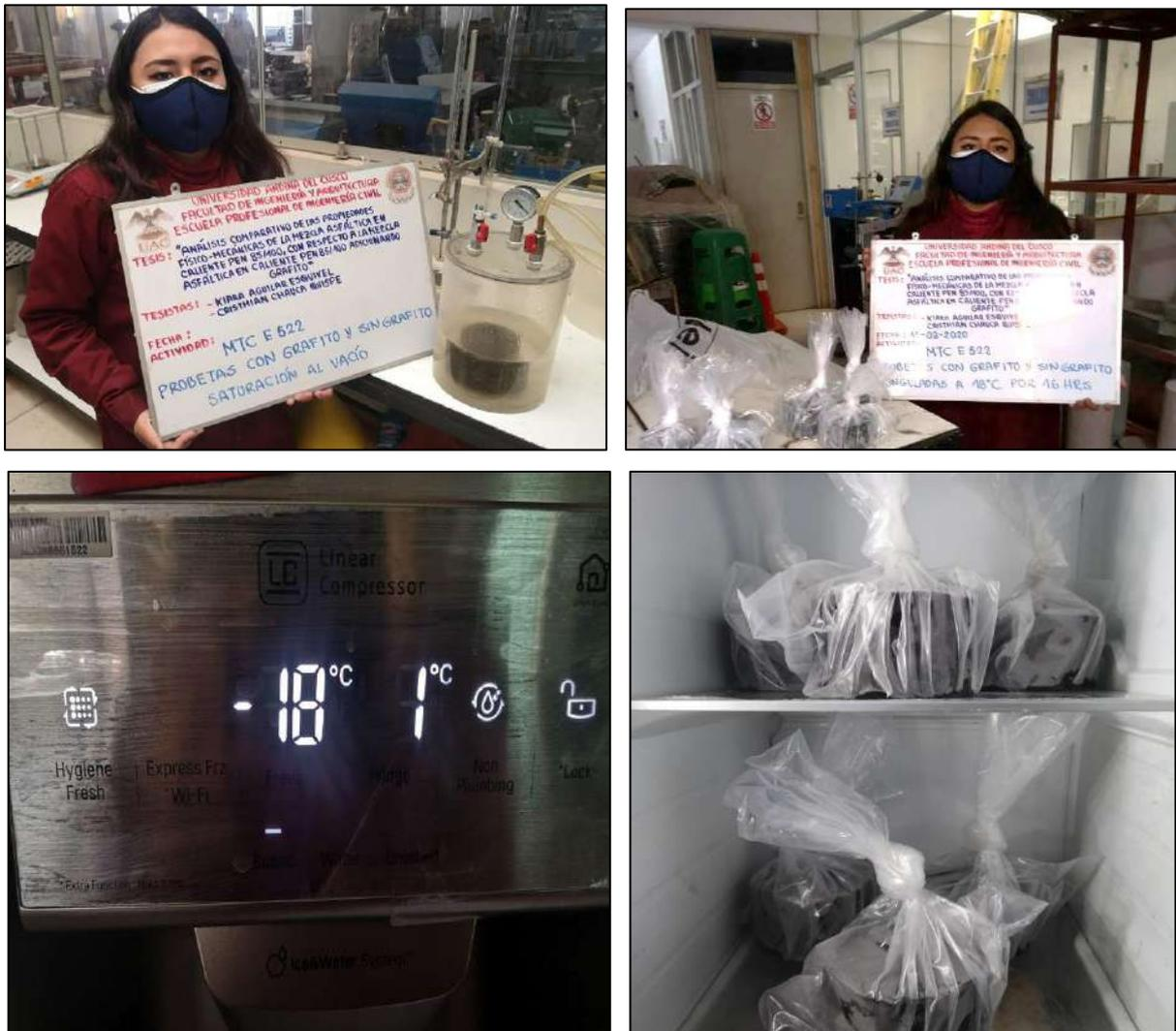
Figura N°63. Probetas al vacío colocados en congeladora -18.1°C – Ensayo al daño inducido por humedad
