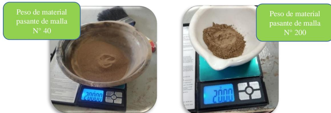
Figura 62: Pesaje del material pasante de la malla N°40 y N°200.
