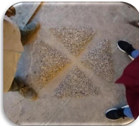
Figura 25: Cuarteo de la muestra para el ensayo de partículas aplanadas y achatadas.
