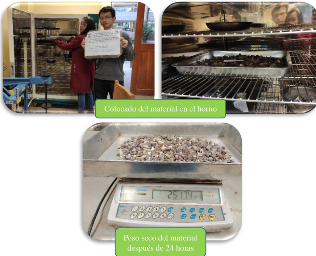
Figura 24: Colocado del material en el horno y peso seco del material luego de 24 horas.
