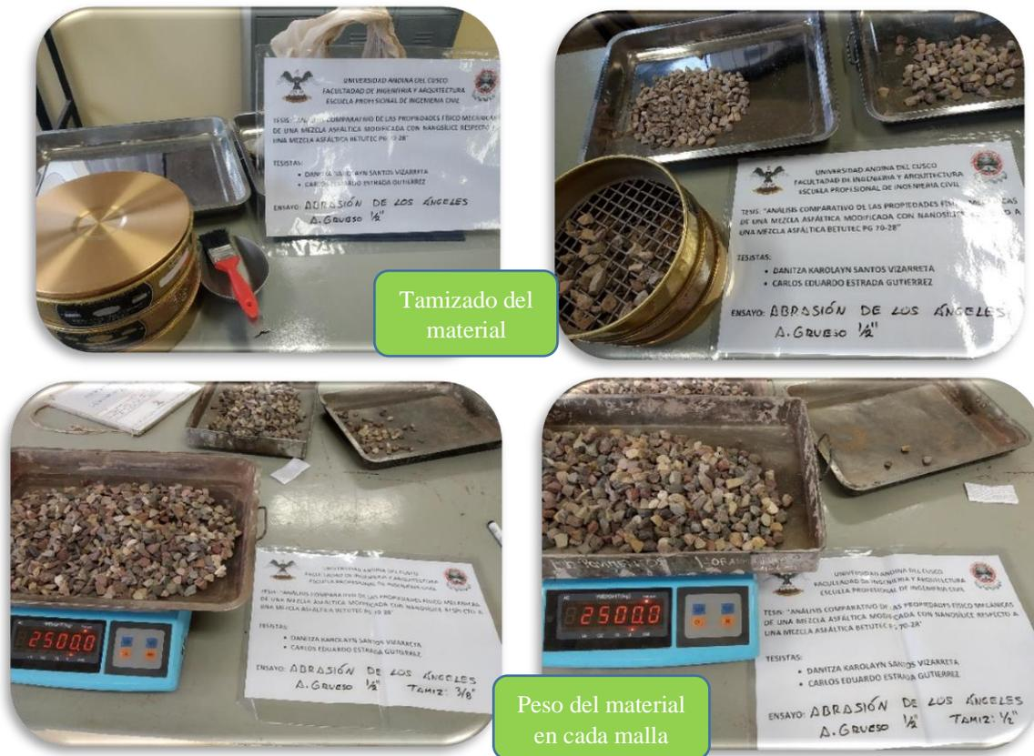
Figura 38: Tamizado y peso del material por tamiz.
