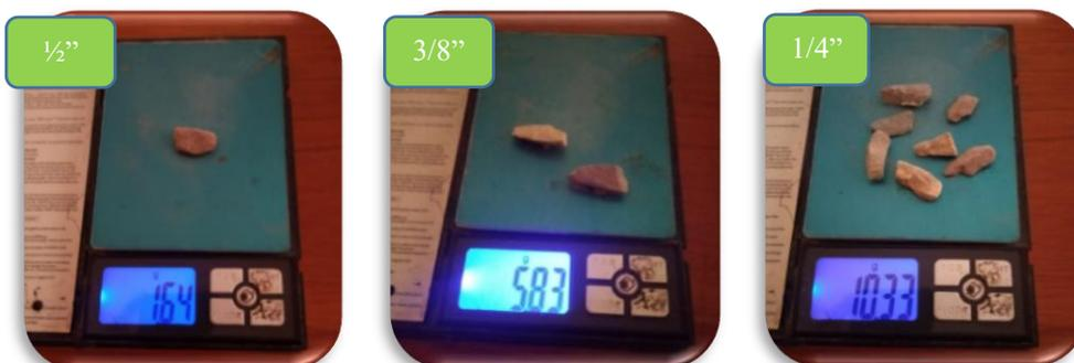
Figura 31: Determinación de partículas alargadas.
