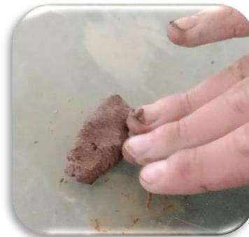
*Figura 70:* Cilindro desmoronado en el segundo intento.
