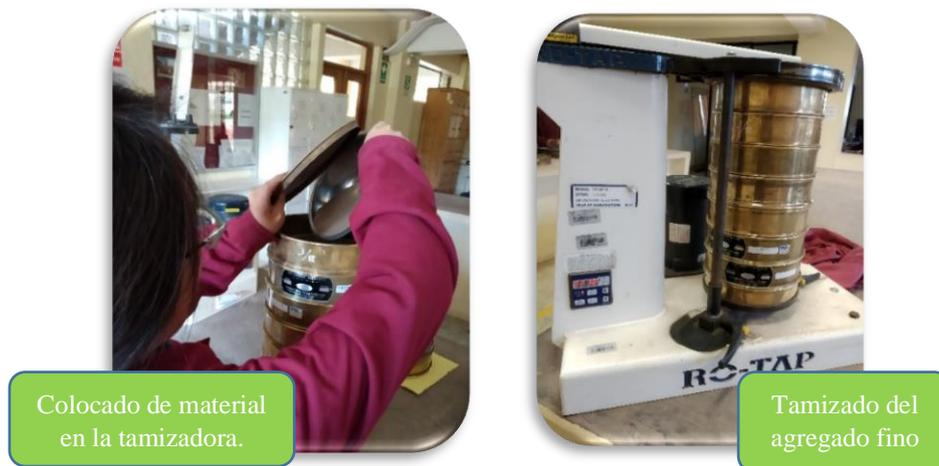
Figura 49: Colocado y tamizado de agregado fino.
