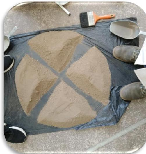
*Figura 51:* Cuarteo de material para el ensayo de gravedad específica y absorción.
