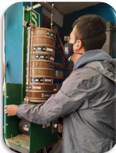
Figura 84: Separado de material por tamices requeridos.
