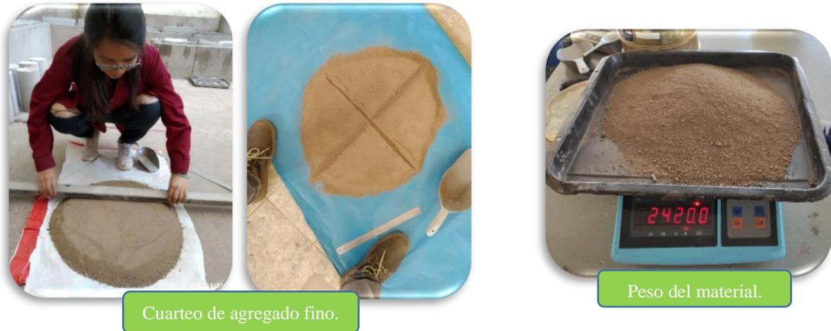
Figura 48: Cuarteo y pesaje de agregado fino.
