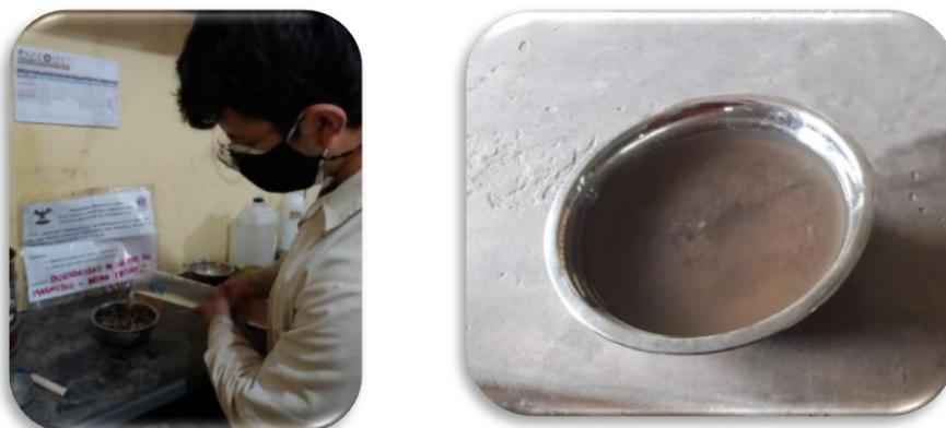
Figura 73: Inmersión del material en la solución.
