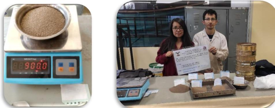
Figura 50: Pesaje por tamiz de agregado fino.
