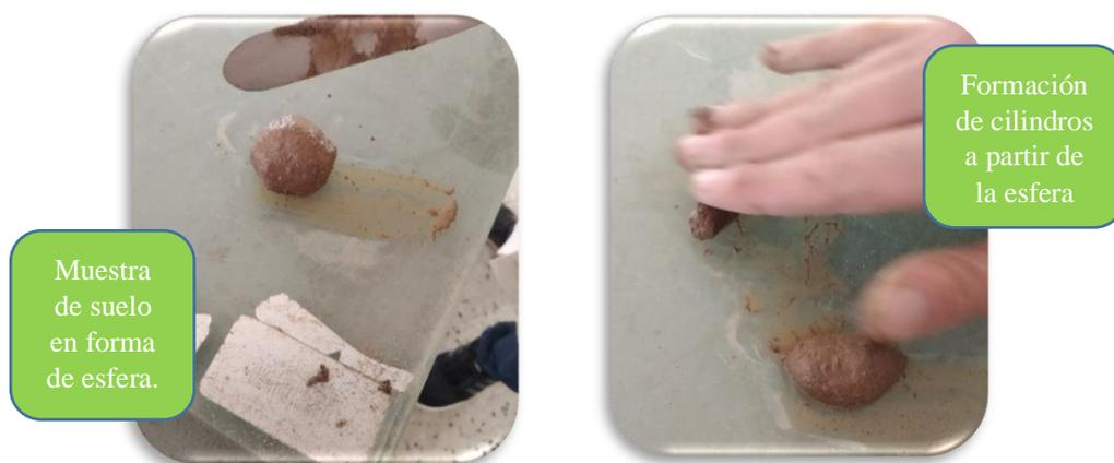
Figura 68: Elaboración de esfera y cilindros con material humedecido.
