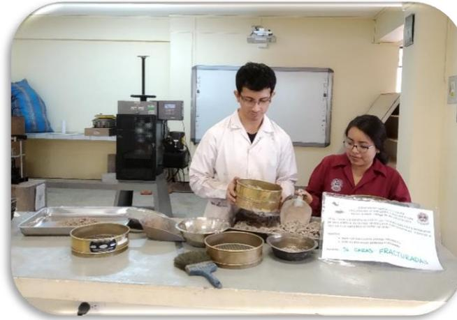
Figura 33: Tamizado de la muestra de material por las mallas correspondientes.
