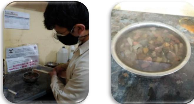
Figura 44: Inmersión del material en la solución.
