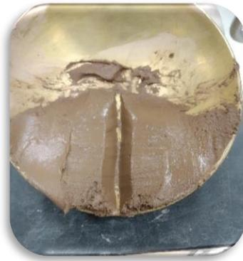
Figura 65: Muestra ranurada previa al ensayo.
