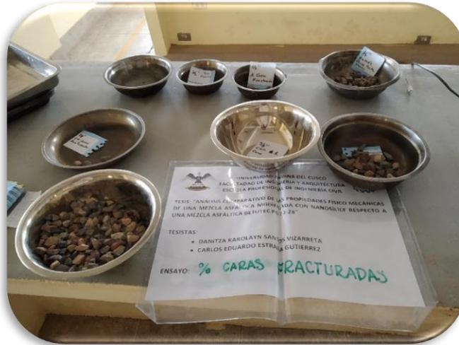
Figura 35: Partículas con caras fracturadas y sin caras fracturadas por tamiz.
