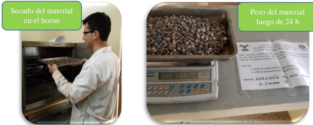
Figura 41: Se seca el material en el horno y se obtiene el nuevo peso.
