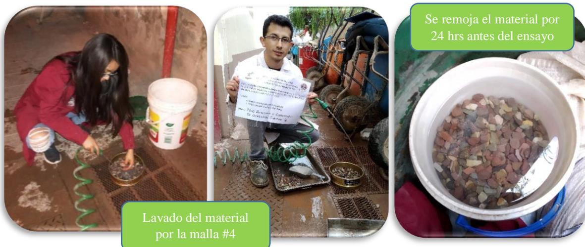
Figura 21: Lavado del material y remojo por 24 hrs.
