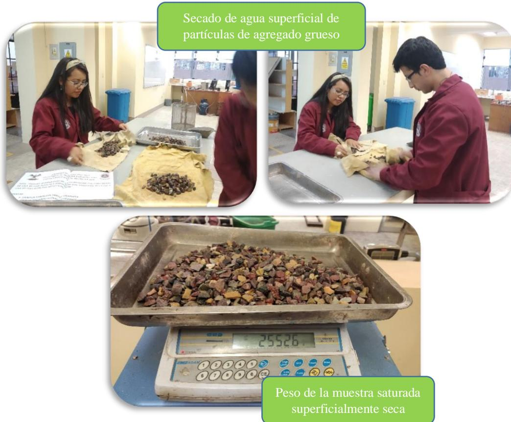
Figura 22: Secado y peso superficialmente seco de agregado grueso.
