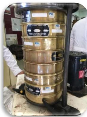
Figura 10: Tamiz para ensayo granulométrico.
