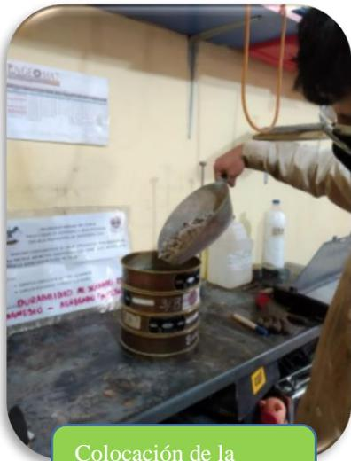
Colocación de la muestra en los tamices
