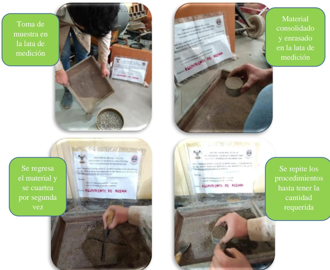
Figura 78: Obtención de muestra con la lata de medición.
