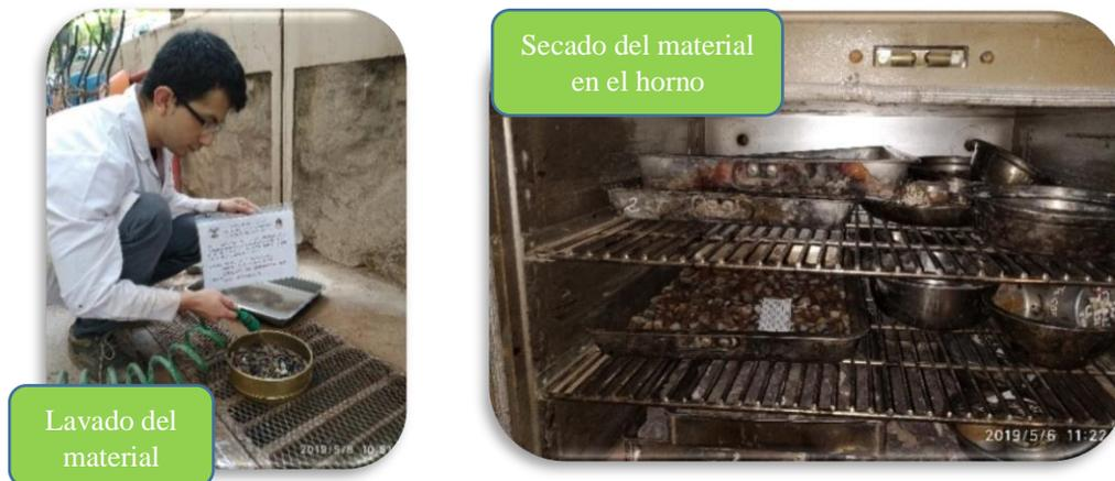
Figura 37: Lavado y secado en horno del material.
