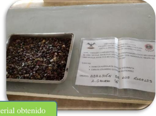
Figura 40: Lavado del material obtenido luego de la someterlo a la Máquina de los Ángeles.
