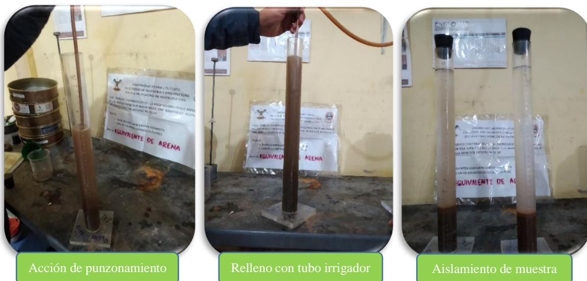
Figura 82: Acción de punzonamiento y relleno con tubo irrigador.
