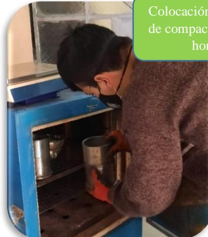
Figura 85: Colocación de agregados y moldes de compactación al horno.
