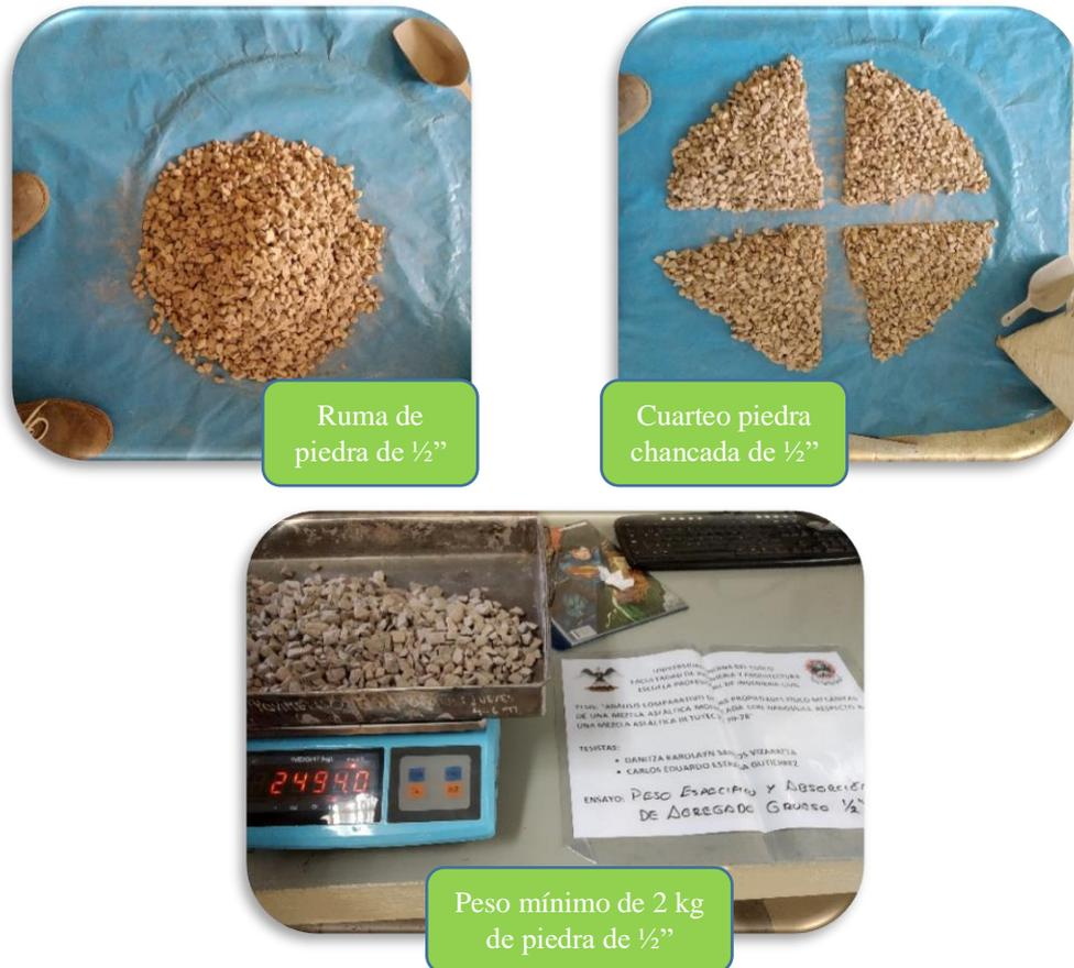
Figura 20: Cuarteo de material y obtención de peso mínimo para peso específico.
