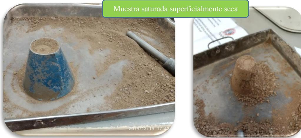
Figura 55: Secado de material hasta alcanzar el estado saturado superficialmente seco.
