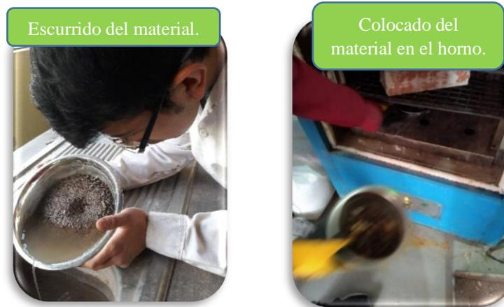
*Figura 74:* Escurreido y colocado del material en el horno.
