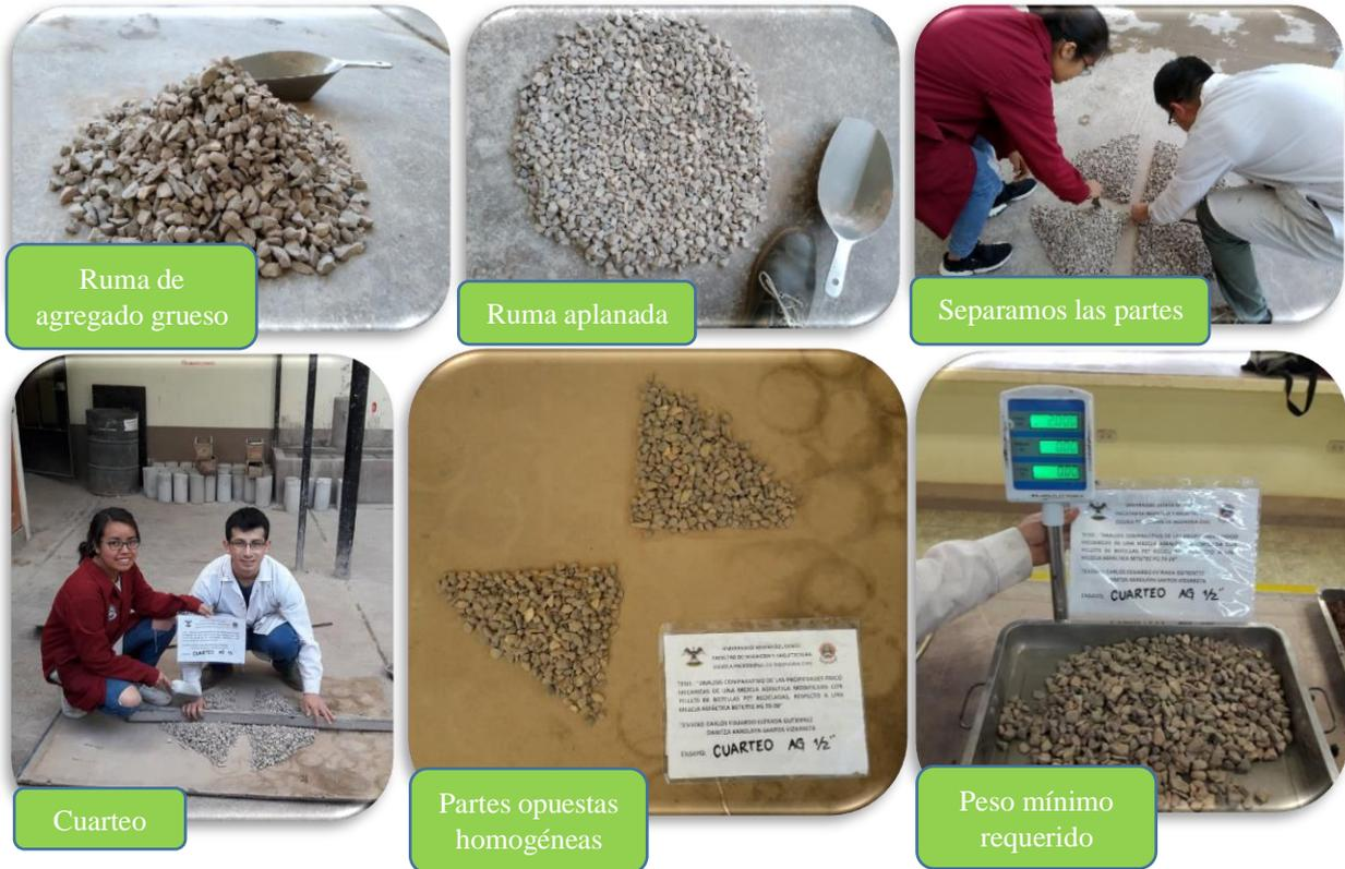
Figura 17: Cuarteo previo al ensayo de granulometría de agregado grueso
