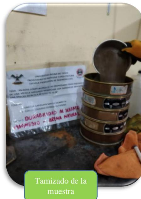
Figura 71: Preparación y tamizado de la muestra.
