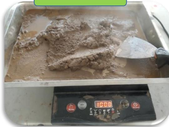
Figura 54: Secado de material hasta alcanzar el estado saturado superficialmente seco.
