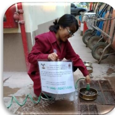
Figura 32: Lavado del material por malla #4.
