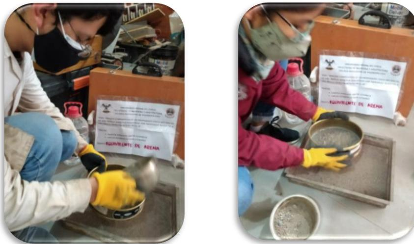
Figura 76: Muestreo manual del material mediante el tamiz N°4.
