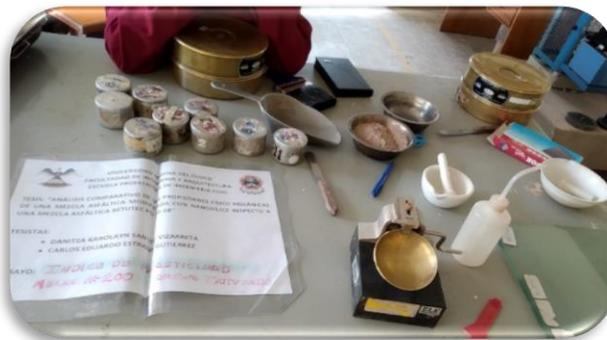
Figura 61: Equipos utilizados en el ensayo de Límite Líquido.
