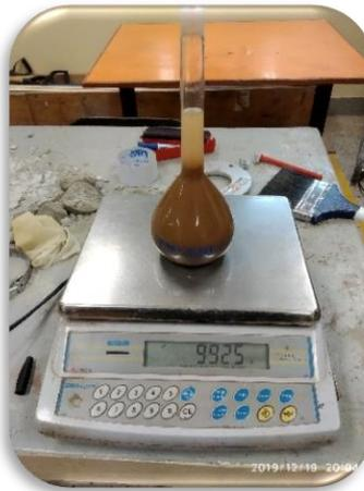
*Figura 58:* Peso total del frasco, muestra y agua.
