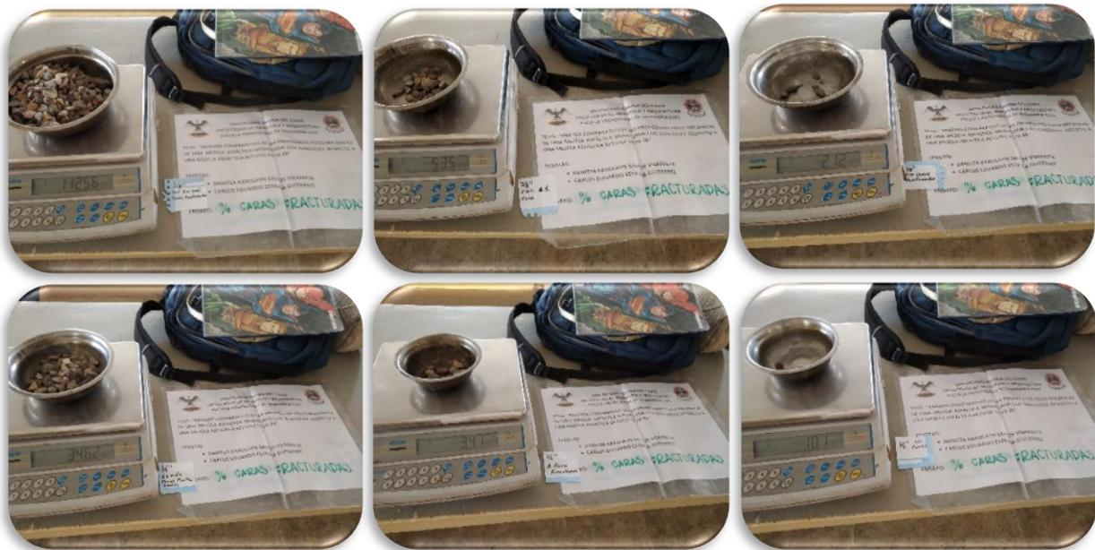
Figura 36: Pesos de partículas con caras fracturadas y sin caras fracturadas por tamiz.
