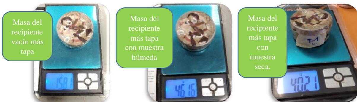
Figura 67: Toma de datos de la masa del material en sus diferentes estados.
