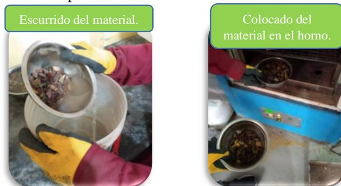
Figura 45: Ecurrido y colocado del material en el horno.
