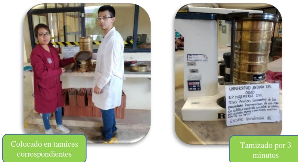
Figura 18: Granulometría de agregado grueso
