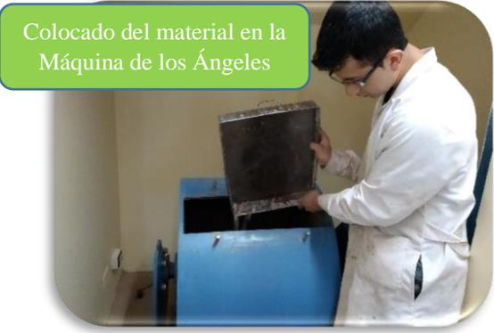
Colocado del material en la Máquina de los Ángeles
