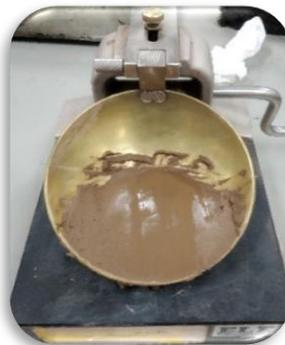
*Figura 64:* Muestra colocada en la copa de Casagrande.
