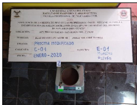
Figura 53 Pesaje de Espécimen Compactado
