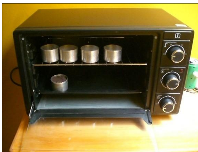
Figura 42 Determinación del Contenido de Humedad.
