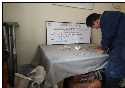
Figura 49 Determinación del Límite Plástico
