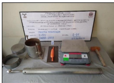
Figura 53 Pesaje de Espécimen Compactado
