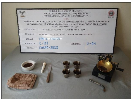
Figura 46 Equipos y Herramientas para Ensayo de Límite Líquido
