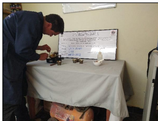
Figura 47 Determinación del Límite Líquido
