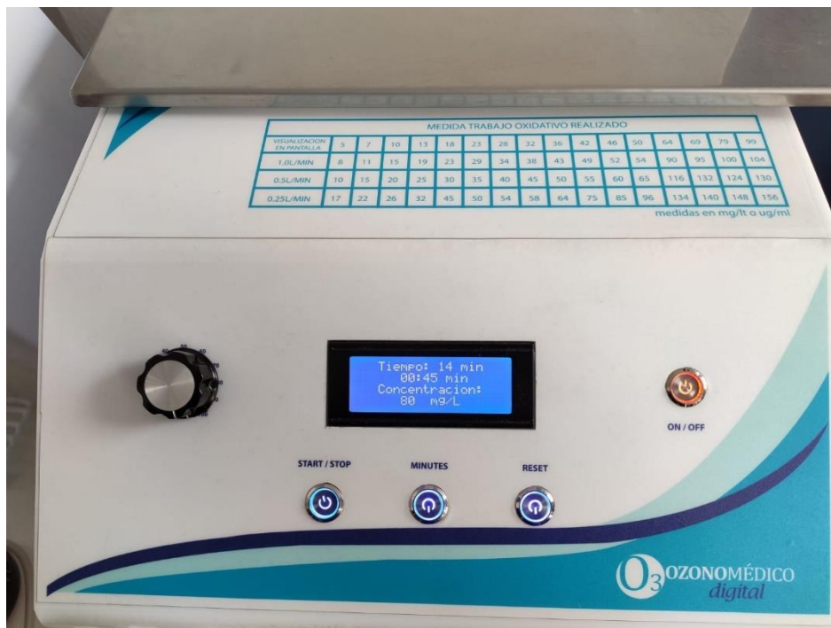
Medición de las concentraciones de Ozono
