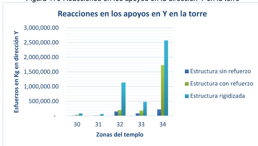
Figura 179 Reacciones en los apoyos en la dirección Y en la torre
