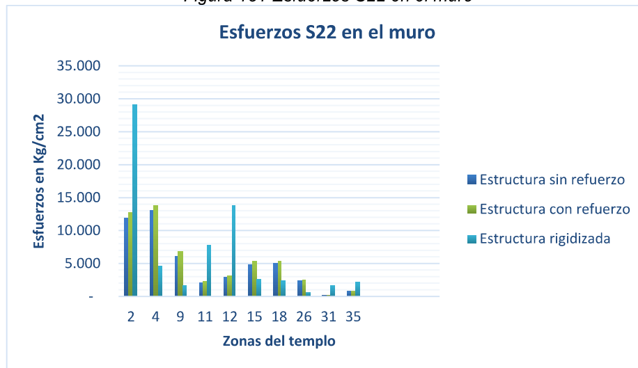
Figura 181 Esfuerzos S22 en el muro
