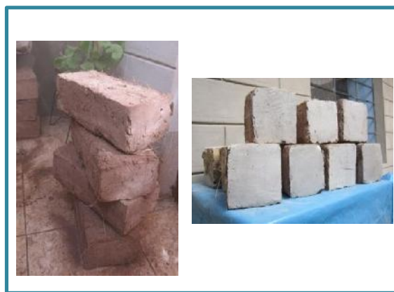
Figura 33 Unidades de adobe y cubos tallados para ensayos de compresión
