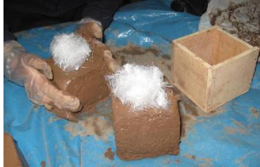
Figura 63 Preparación de empaste con 6.25 gr. De fibra de polipropileno
