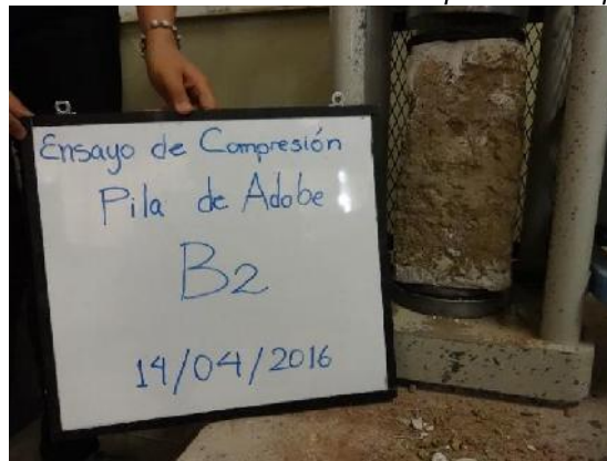
Figura 43 Pila de adobe actual en la máquina de compresión.
