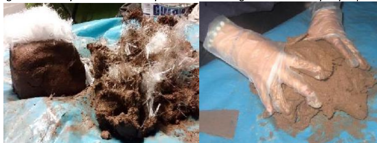
Figura 64 Preparación de empaste con 12.5 gr. De fibra de polipropileno
