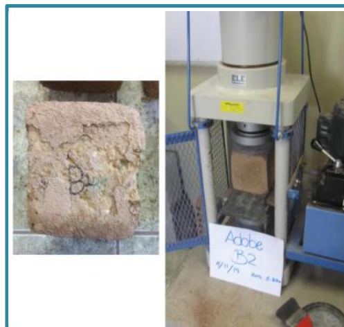
Figura 68 Ensayo de compresión: cubos con empaste B
