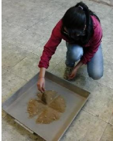
Figura 51 Cuarteo del material para el ensayo
