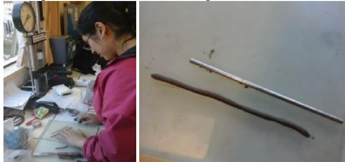
Figura 56 Se forma cilindros delgados con la muestra
