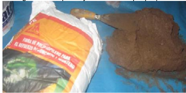
Figura 62 Empaste y las fibras de polipropileno
