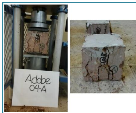
Figura 38 Especimen de adobe convencional en la máquina de compresión después de ser ensayado
