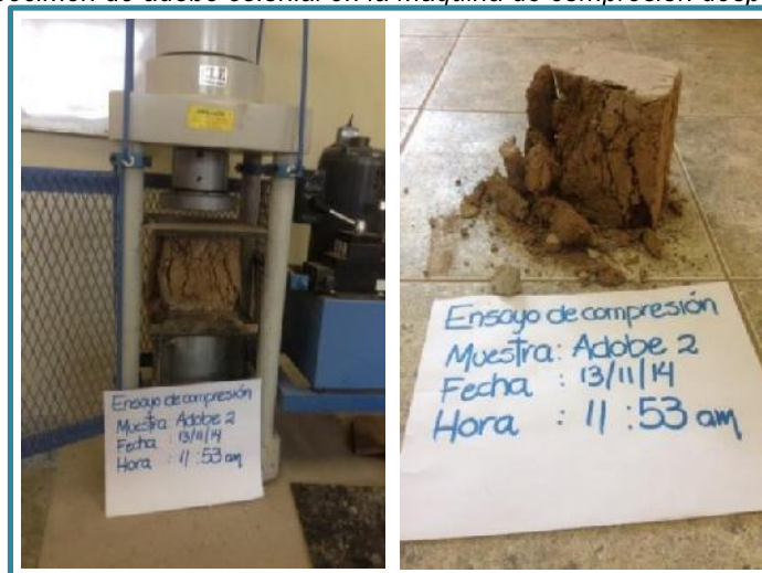
Figura 37 Especimen de adobe colonial en la máquina de compresión después del ensayo.
