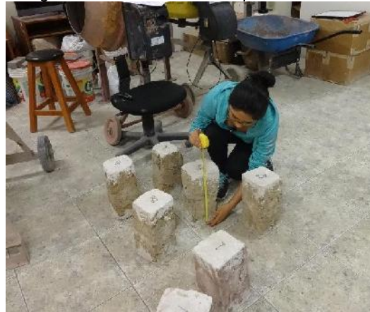
Figura 41 Medición de las pilas de adobe
