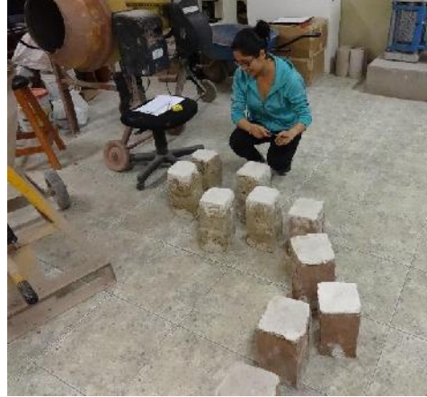
Figura 40 Pilas de adobe listos para el ensayo de compresión
