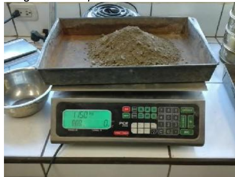
Figura 52 Se pesa el material a tamizar
