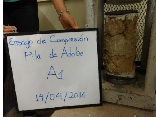
Figura 42 Pila de adobe colonial en la máquina de compresión.
