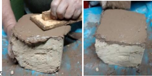
Figura 65 Empastado de los cubos de adobe con mortero
