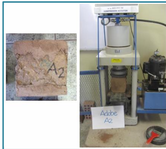
Figura 67 Ensayo de compresión: cubos con empaste A
