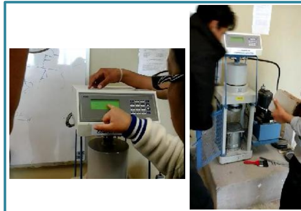
Figura 35 Programación de la máquina de compresión para iniciar el ensayo.
