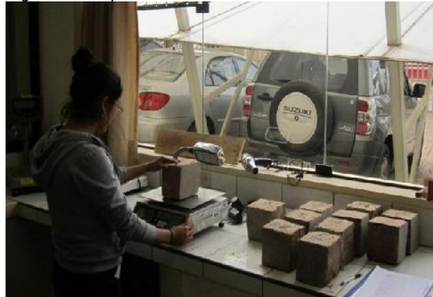
Figura 34 Se pesó los cubos de adobe en el laboratorio.
