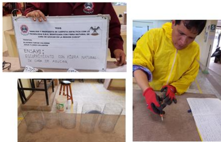
Figura 87: Fabricación de canastillas para el ensayo de escurrimiento
