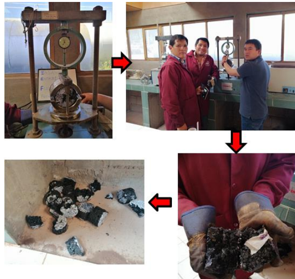
Figura 96: Rotura y termino de especímenes de asfalto de estabilidad y flujo Marshall
