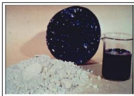
Figura 04: Cemento asfáltico a temperatura ambiente y de briqueeta preparada con una mezcla cemento asfáltico-agregado (Minaya Gonzales & Ordóñez Huamán, 2006)
