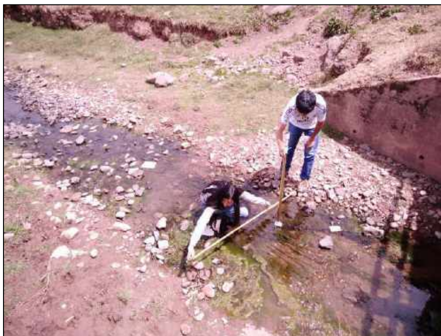
Fig. N° 34: Tesistas aforando con correntómetro
