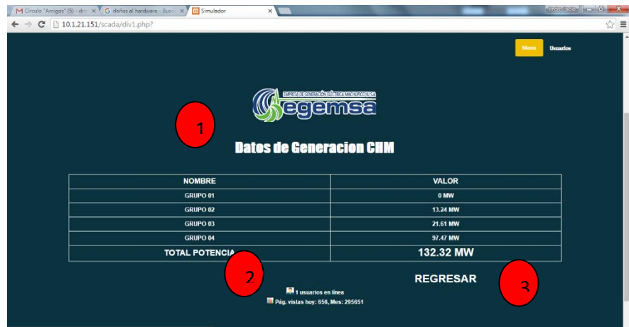
Ilustración 82: Ver Datos de Generación SCADA - CHM Sistema WEB SCADA.
