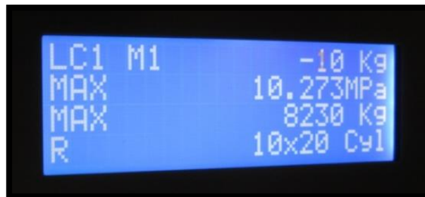
Figura 217: Datos de ensayo de resistencia a tracción indirecta de muestra T-2-B-14
