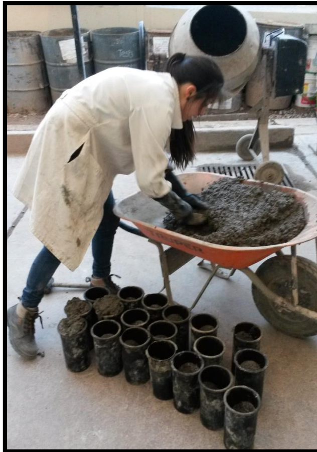
Figura 163: Colocación de la segunda capa de concreto en las briqueteras
