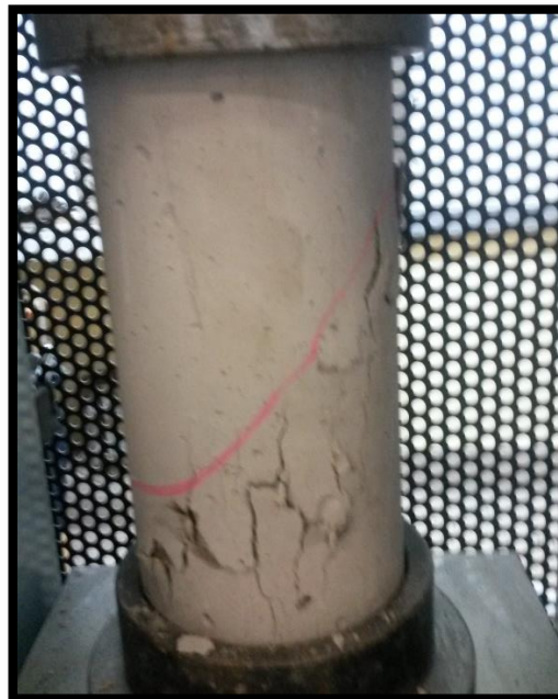
Figura 181: Muestra C-1.5-C-28 sometida a compresión con falla tipo 2
