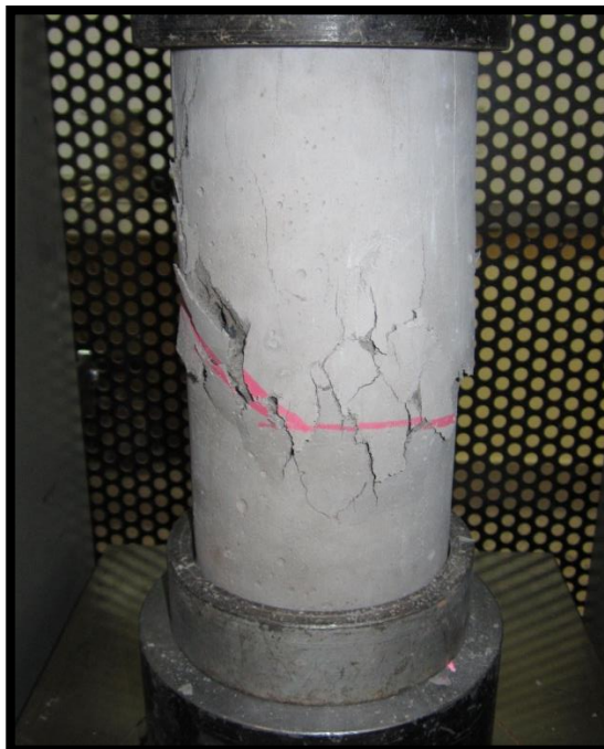
Figura 197: Muestra C-P-A-28 sometida a compresión con falla tipo 3
