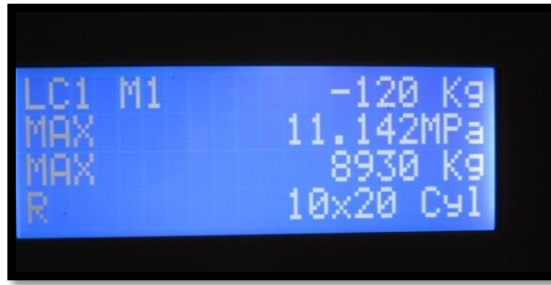
Figura 211: Datos de ensayo de resistencia a tracción indirecta de muestra T-2-C-28
