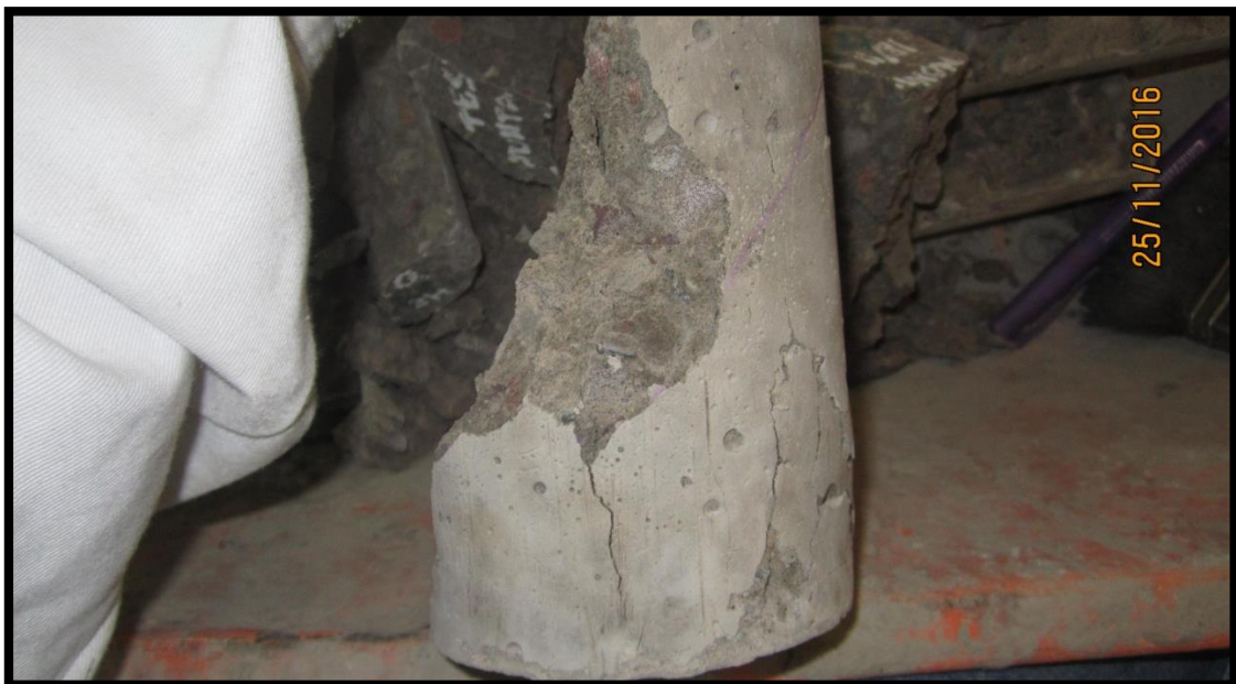
Figura 185: Muestra C-3-A-7 sometida a compresión con tipo de falla 2
