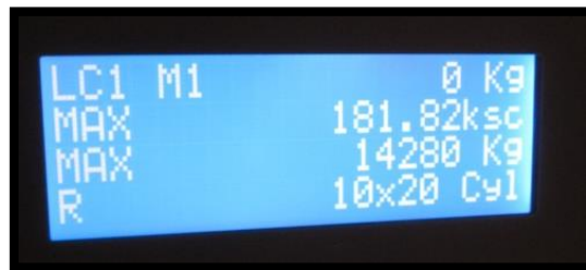
Figura 213: Datos de ensayo de resistencia a compresión de muestra C-4-B-7
