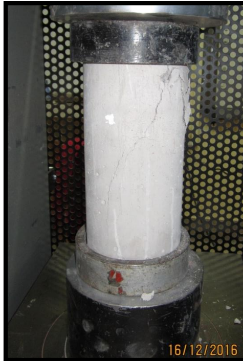
Figura 178: Muestra C-3-A-28 sometida a compresión con falla tipo 4
