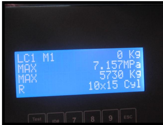
Figura 198: Datos de ensayo de resistencia a tracción indirecta de muestra T-3-A-7
