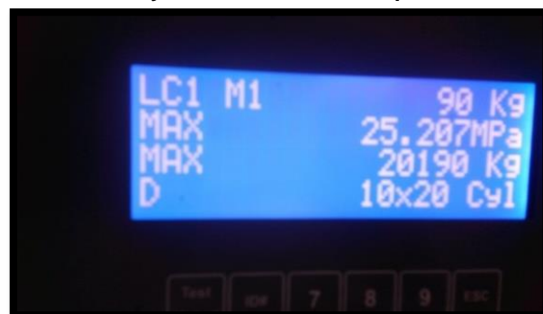
Figura 218: Datos de ensayo de resistencia a compresión de muestra C-1-B-28
