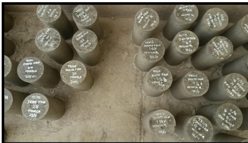
Figura 169: Desmoldado de briquetas con junta fría de 2 y 1 1/2 horas
