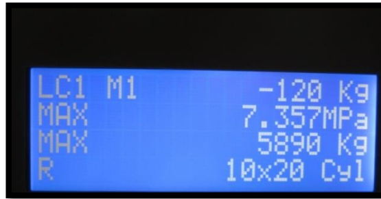
Figura 215: Datos de ensayo de resistencia a tracción indirecta de muestra T-4-A-7
