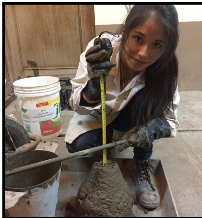
Figura 159: Determinación del revenimiento con el ensayo del cono de Abrams
