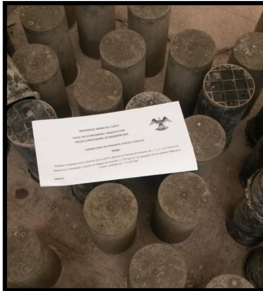
Figura 168: Testigos de concreto desencofrados
