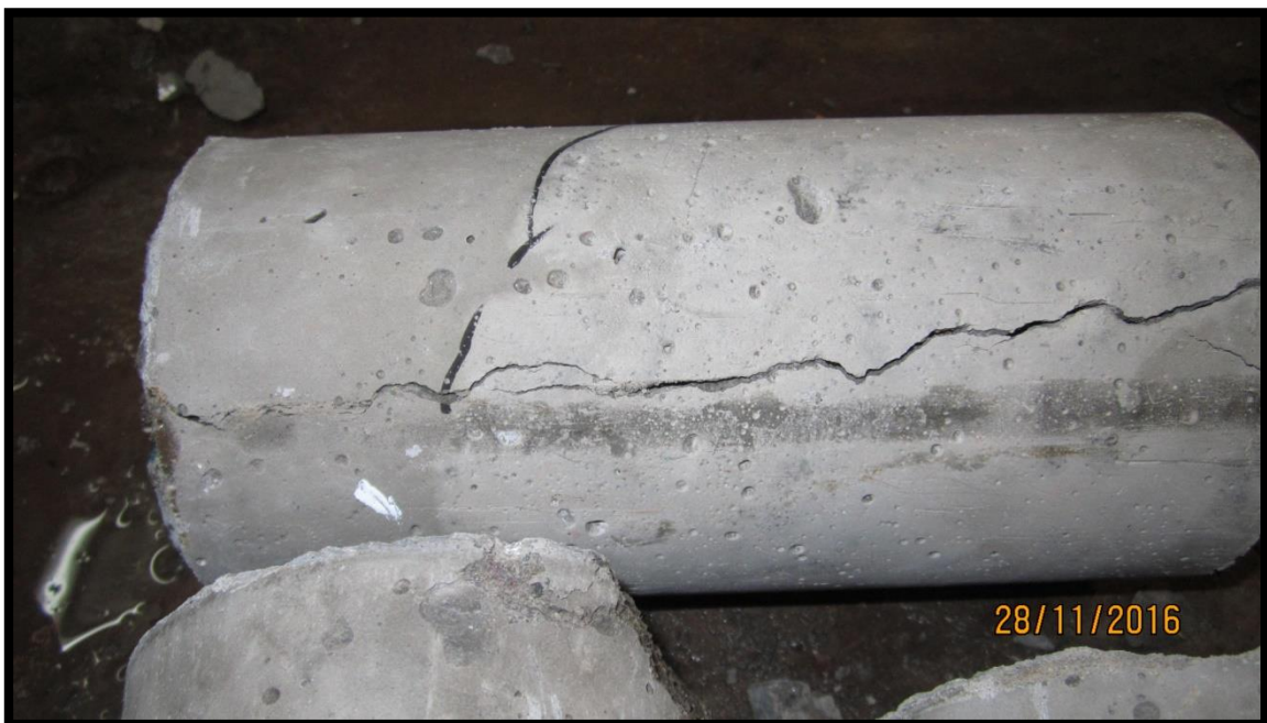
Figura 187: Muestra T-4-A-7 ensayada a tracción indirecta
