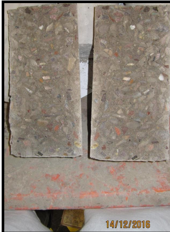
Figura 195: Muestra T-P-A-28 sometida a compresión
