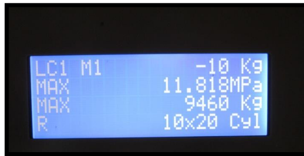
Figura 212: Datos de ensayo de resistencia a tracción indirecta de muestra T-3-A-28
