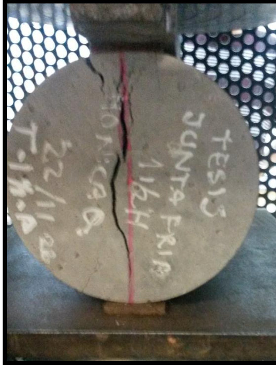
Figura 194: Muestra T-1.5-A-28 sometida a tracción indirecta
