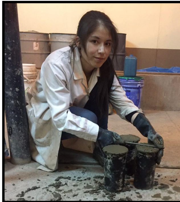
Figura 167: Enrasado de la superficie del testigo de concreto
