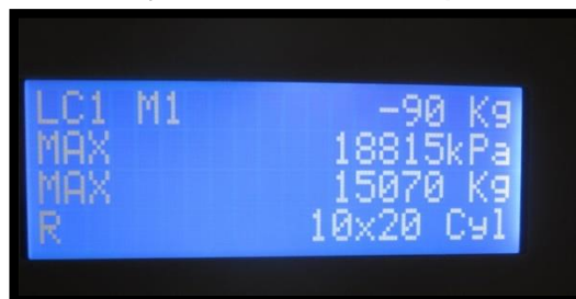
Figura 214: Datos de ensayo de resistencia a compresión de muestra C-1-B-7
