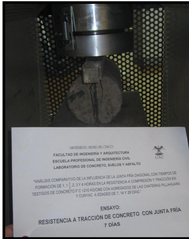
Figura 177: Muestra de concreto ensayada a tracción indirecta con 7 días de edad
