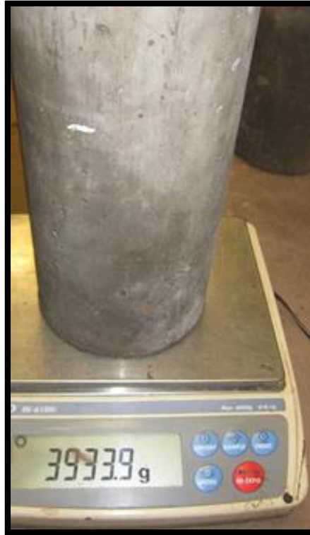
Figura 174: Toma de peso de muestra C-P-C-7
