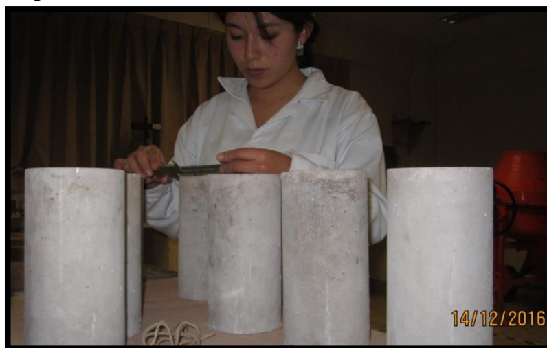
Figura 170: Toma de medida del diámetro de la muestra de concreto
