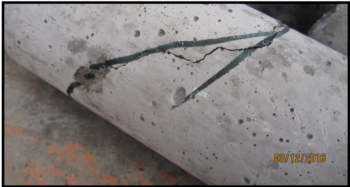
Figura 189: Muestra C-1-A-14 sometida a compresión con falla tipo 4
