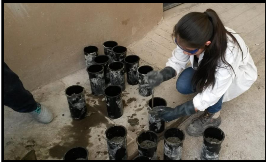
Figura 161: Compactación de la primera capa de concreto en los moldes
