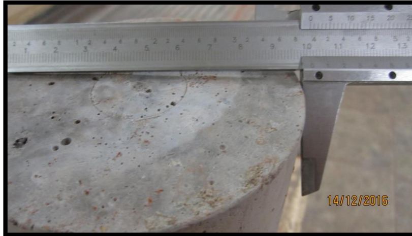
Figura 171: Medida del diámetro de la muestra de concreto
