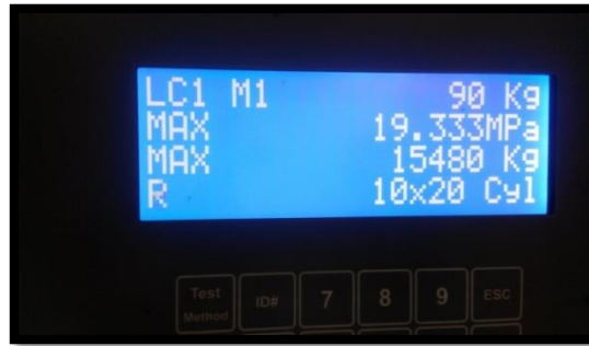
Figura 219: Datos de ensayo de resistencia a compresión de muestra C-P-B-7
