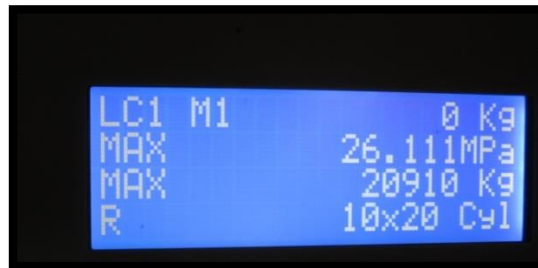
Figura 209: Datos de ensayo de resistencia a compresión de muestra C-P-B-28
