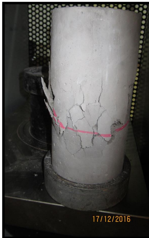
Figura 179: Muestra C-1-B-28 sometida a compresión con falla tipo 2
