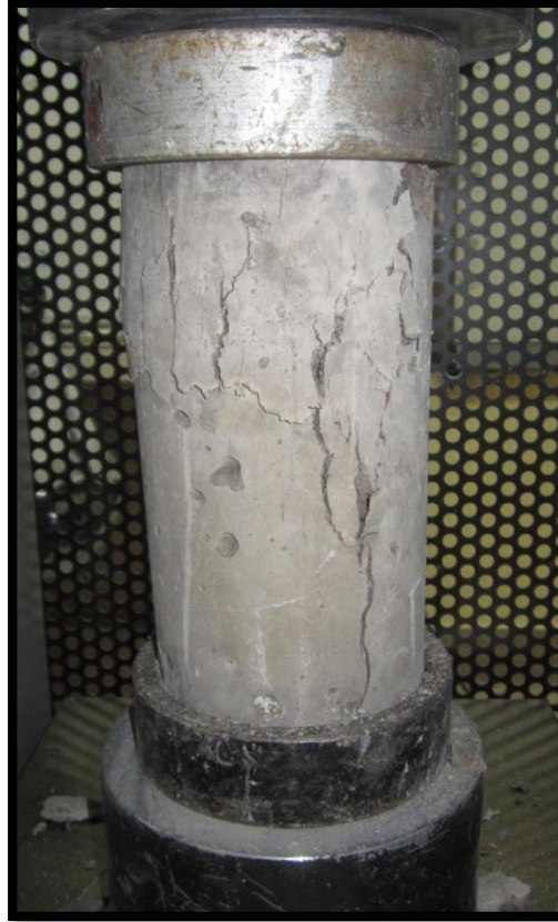
Figura 182: Muestra C-3-C-7 sometida a compresión con falla tipo 3
