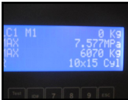
Figura 199: Datos de ensayo de resistencia a tracción indirecta de muestra T-2-B-7
