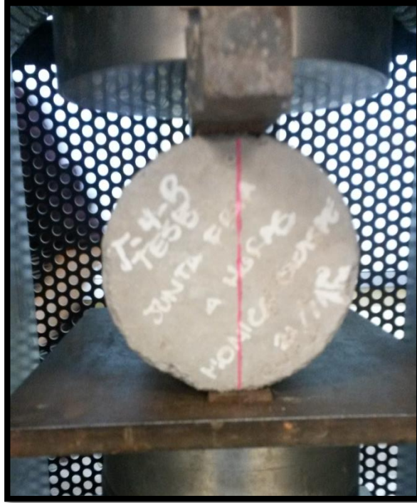
Figura 192: Muestra T-4-B-28 sometida a tracción indirecta
