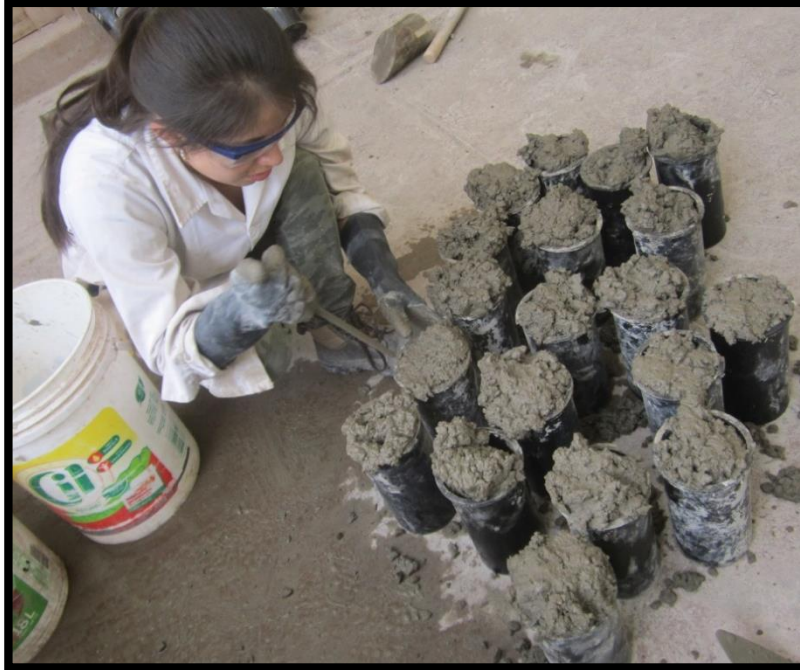
Figura 164: Compactación de la segunda capa de concreto con junta fría diagonal de 45°
