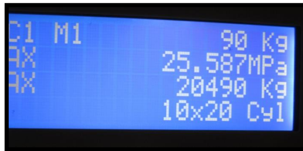
Figura 208: Datos de ensayo de resistencia a compresión de muestra C-P-C-28
