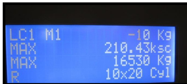
Figura 200: Datos de ensayo de resistencia a compresión de muestra C-P-A-14
