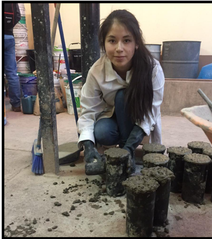
Figura 166: Eliminación de burbujas de aire en el concreto mediante golpes con el martillo de goma
