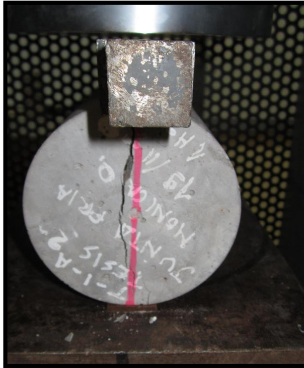
Figura 193: Muestra T-1-A-28 sometida a tracción indirecta
