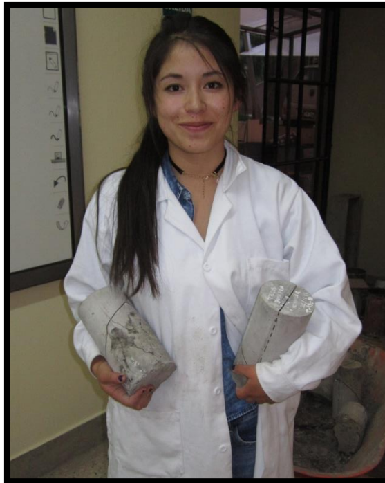
Figura 196: Muestras con junta fría con 2 horas de formación sometidas a compresión y tracción indirecta a los 14 días
