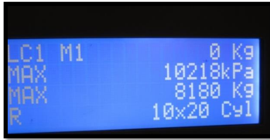
Figura 207: Datos de ensayo de resistencia a tracción indirecta de muestra T-1-A-14
