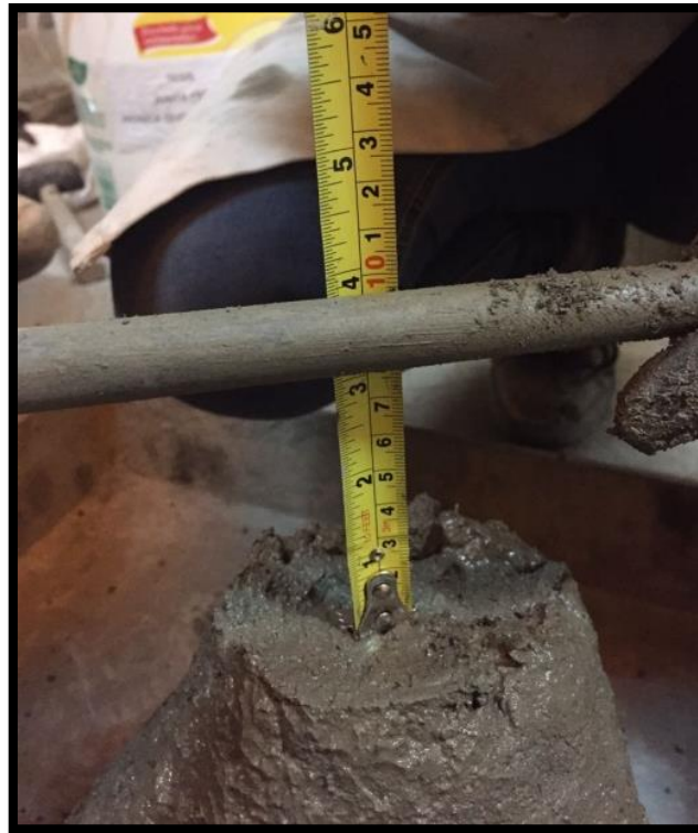
Figura 158: Determinación del revenimiento con el ensayo del cono de Abrams
