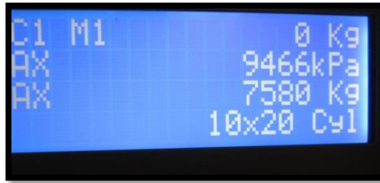
Figura 202: Datos de ensayo de resistencia a tracción indirecta de muestra T-1.5-A-14
