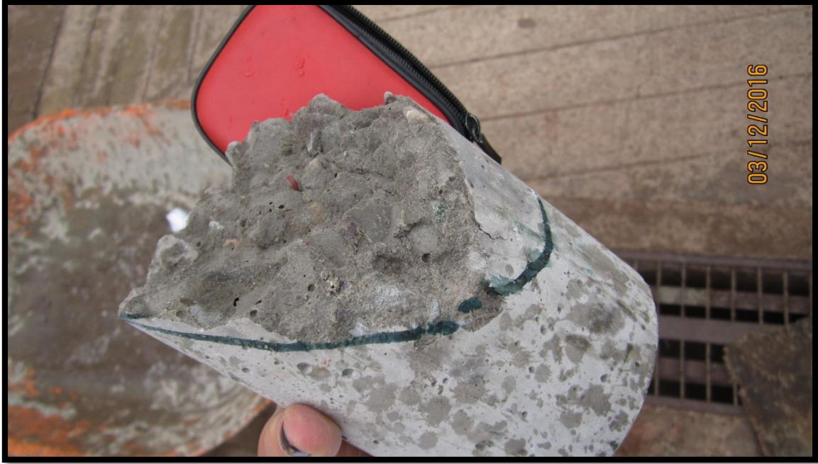
Figura 190: Muestra C-1-B-14 sometida a compresión con falla tipo 4
