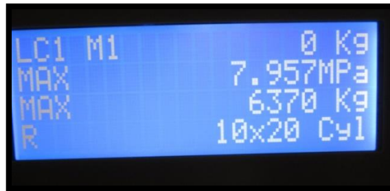
Figura 216: Datos de ensayo de resistencia a tracción indirecta de muestra T-P-C-7
