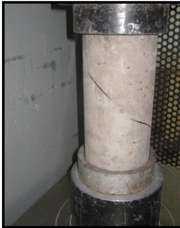
Figura 184: Muestra de concreto con junta fría con 4 horas de formación con 7 días de edad sometida a compresión
