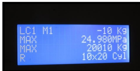
Figura 210: Datos de ensayo de resistencia a compresión de la muestra C-1.5-B-28
