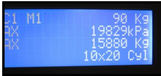
Figura 203: Datos de ensayo de resistencia a compresión de muestra C-1.5-B-14
