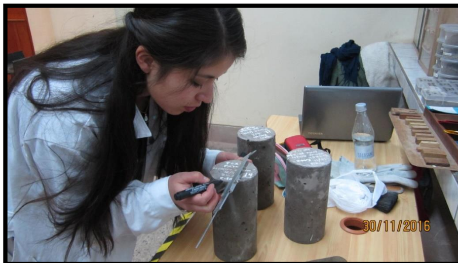
Figura 173: Dibujo de las líneas guía para en la probeta para ensayo de resistencia a tracción indirecta
