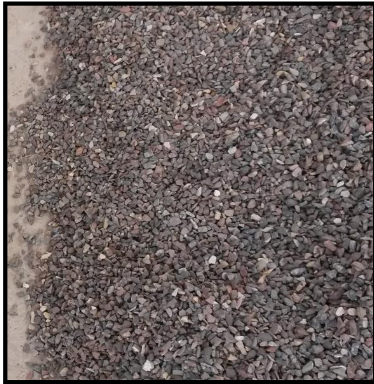
Figura 156: Agregado grueso de 1/2" lavado por la malla N°4 de la cantera de Pillahuara
