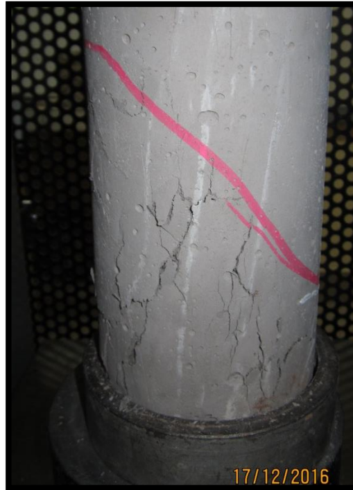
Figura 180: Muestra C-1-A-28 sometida a compresión con falla tipo 2
