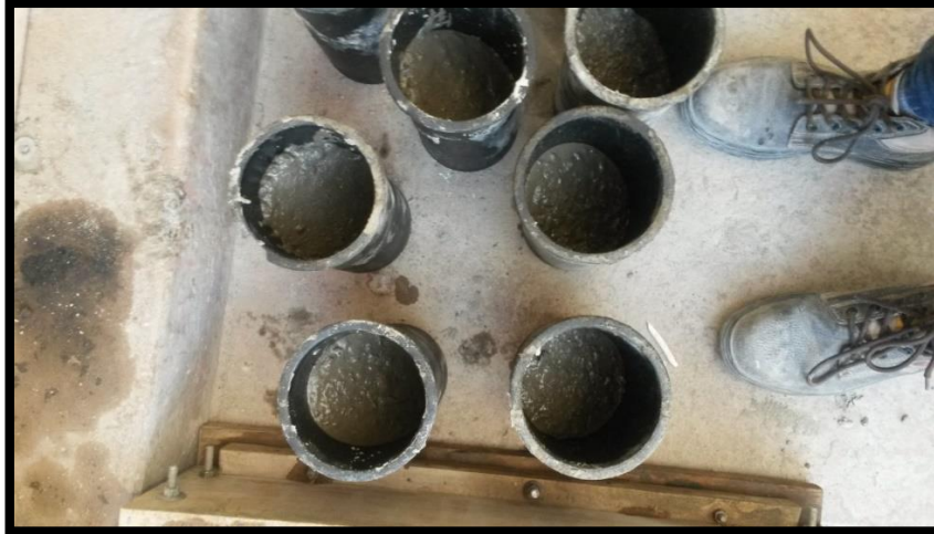
Figura 162: Primera capa de concreto en nuestras con junta fría diagonal de 45°
