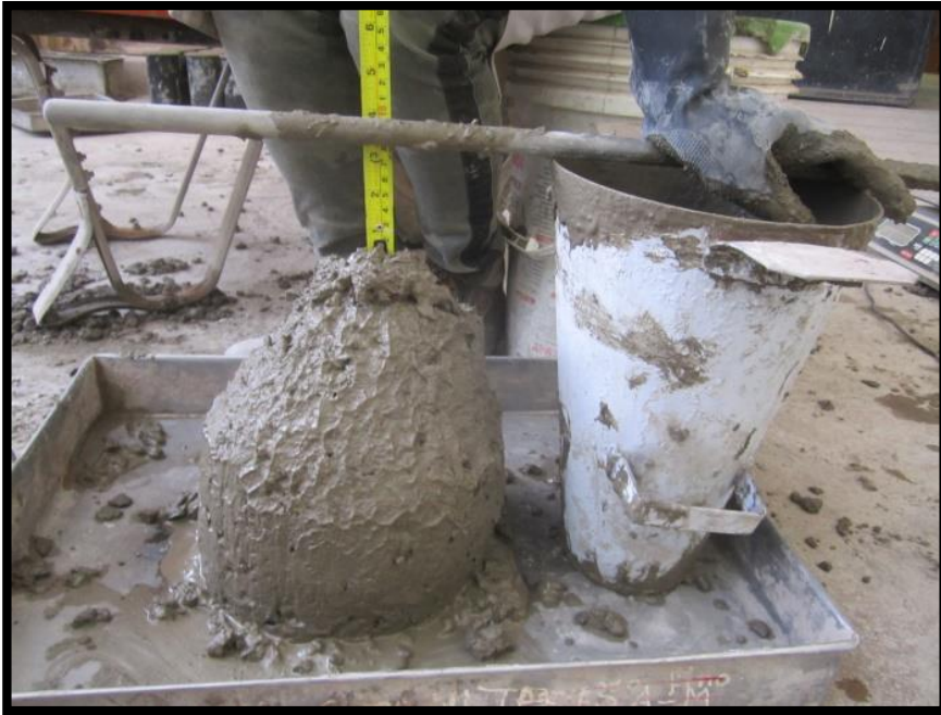
Figura 160: Determinación del revenimiento con el ensayo del cono de Abrams
