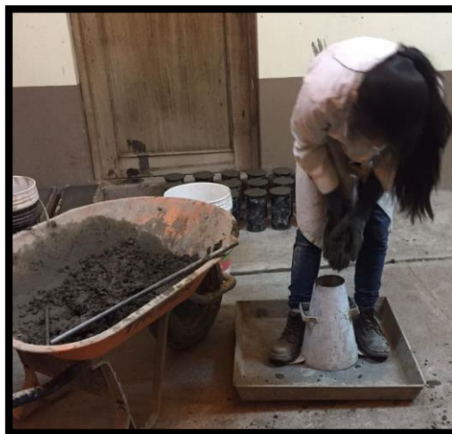
Figura 85: Compactación de las capas de concreto para el determinar el revenimiento
