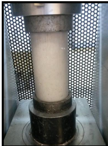
Figura 93: Ensayo de compresión de la muestra de concreto
