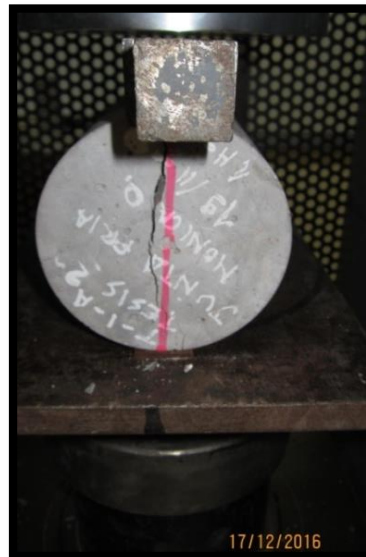
Figura 104: Muestra de concreto ensayada a tracción indirecta
