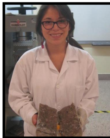
Figura 107: Muestra de concreto ensayada a tracción
