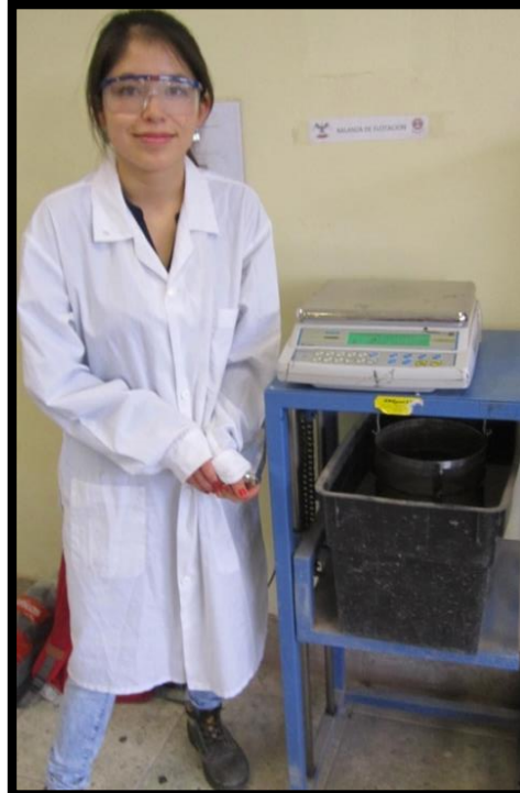
Figura 39: Determinación del peso sumergido del agregado grueso.
