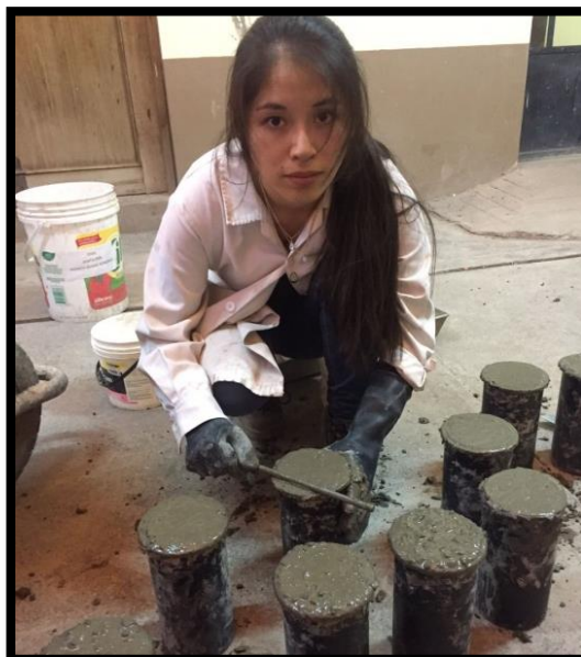
Figura 72: Enrasado de muestras de concreto
