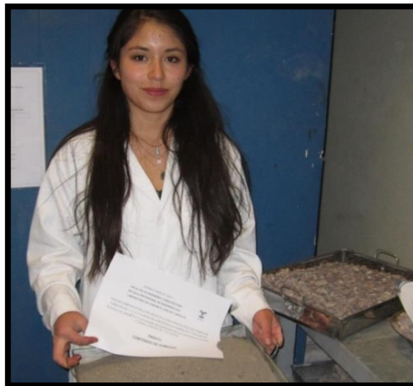
Figura 26: Agregado fino secado por 24 horas en el horno.
