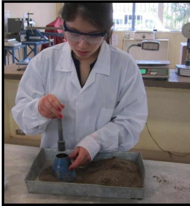
Figura 46: Ensayo del cono metálico con el agregado fino
