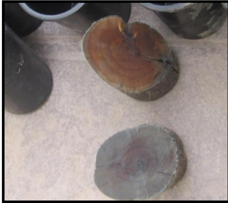
Figura 77: Moldes de madera para dar forma diagonal a la junta
