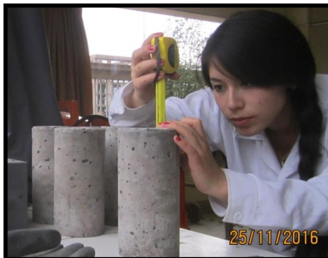
Figura 99: Toma de medidas de las muestras de concreto
