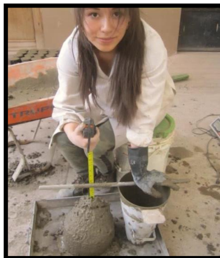
Figura 88: Medida del asentamiento con el cono de Abrams
