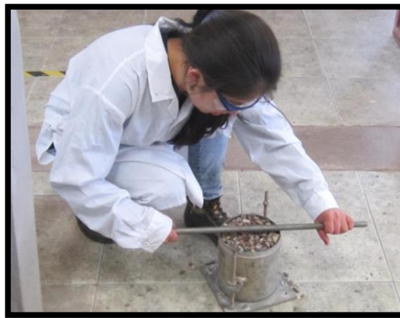
Figura 60: Enrasado del agregado grueso en el molde para determinar el peso unitario compactado
