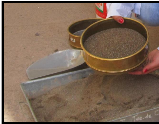
Figura 33: Material que pasa la malla N°16 y retenido en la malla N°30
