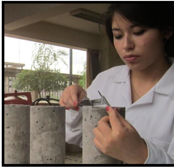
Figura 92: Toma de medidas de las muestras de concreto
