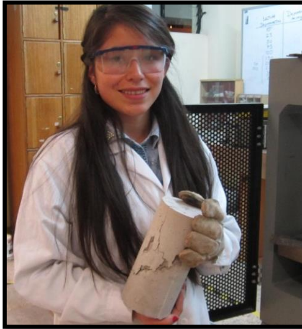
Figura 96: Muestra C-3-D-28 de concreto sometida a compresión axial, con falla tipo 2
