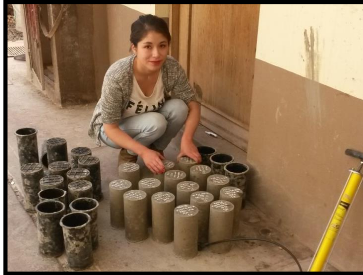
Figura 73: Desmoldado de muestras de concreto a las 24 horas después de su vaciado
