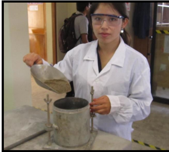
Figura 53: Distribución del agregado fino en el molde para determinar el peso unitario suelto
