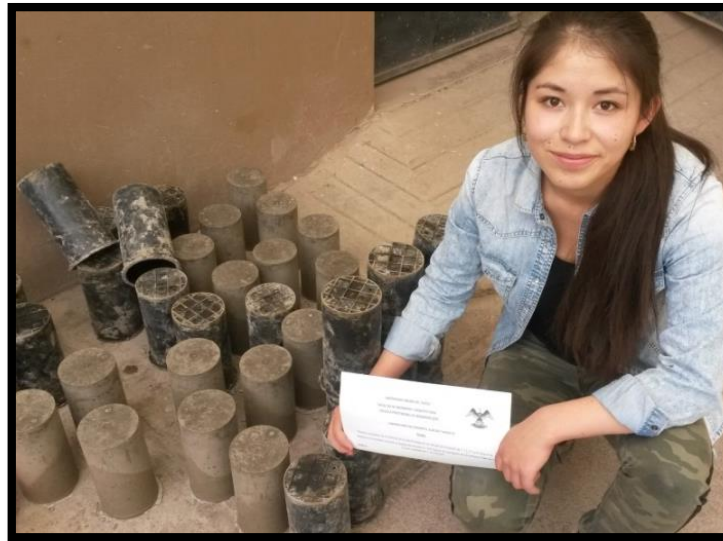
Figura 83: Muestras de concreto con junta fría desmoldadas
