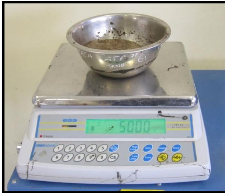
Figura 48: Toma de peso de agregado fino saturado superficialmente seco
