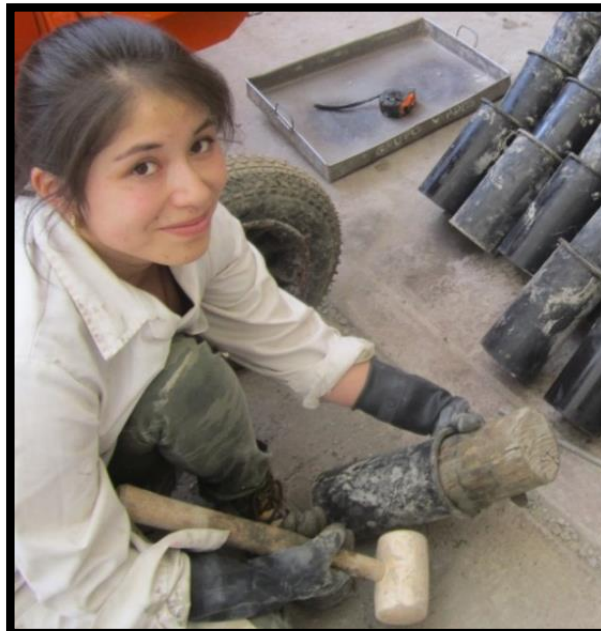
Figura 76: Colocación del molde de madera y compactación con el martillo de goma
