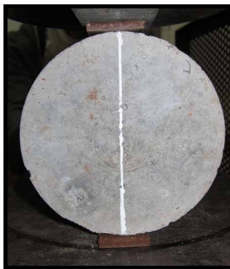
Figura 103: Muestra de concreto colocada en la máquina de compresión para el ensayo de tracción indirecta
