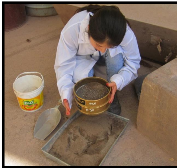
Figura 31: Tamizado del agregado fino por las mallas N°16 y N° 30
