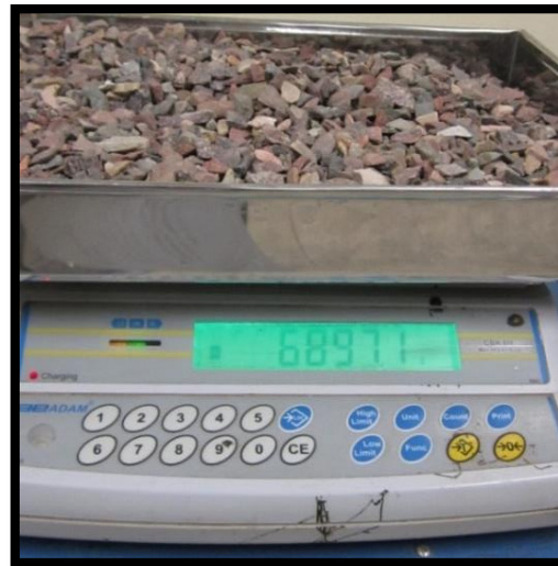
Figura 66: Toma de peso del agregado grueso seco
