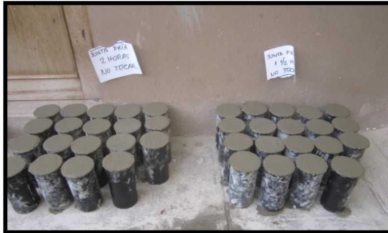
Figura 81: Muestras de concreto con junta fría con tiempo de formación de 2 y 1 1/2 horas enrasadas.
