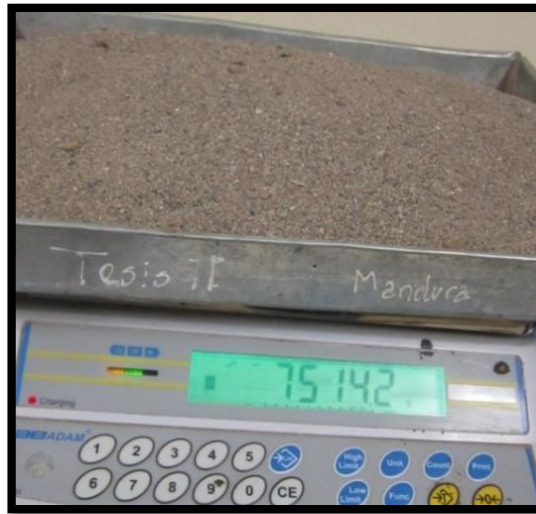
Figura 65: Toma de peso de agregado fino seco
