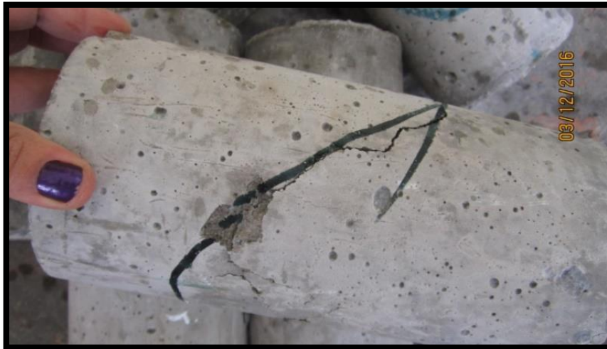
Figura 97: Muestra C-1-A-14 de concreto sometida a compresión axial, con falla tipo 4
