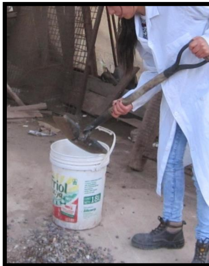
Figura 24: Colocación de la muestra cuarteada en recipiente para evitar su contaminación
