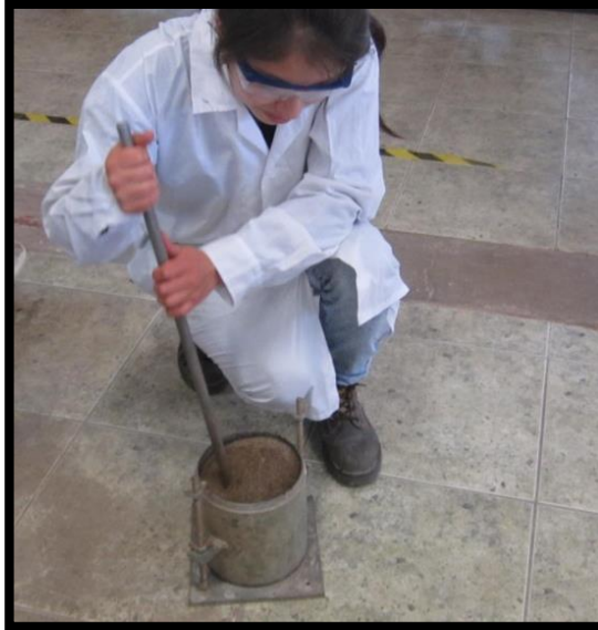
Figura 57: Compactado del agregado fino en el molde para determinar el peso unitario compactado
