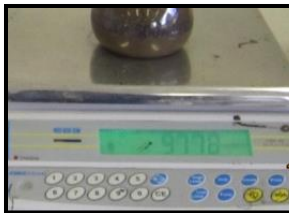
Figura 52: Peso de muestra de agregado fino en picnómetro
