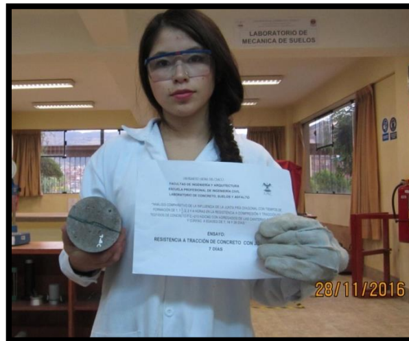
Figura 106: Muestra de concreto ensayada a tracción
