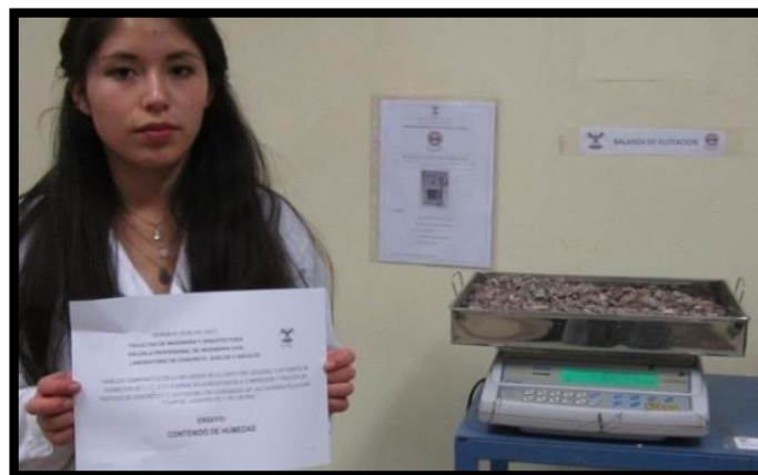
Figura 67: Toma de peso de agregado grueso seco para determinar el contenido de humedad
