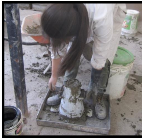
Figura 87: Retiro del molde cónico para ensayo del cono de Abrams
