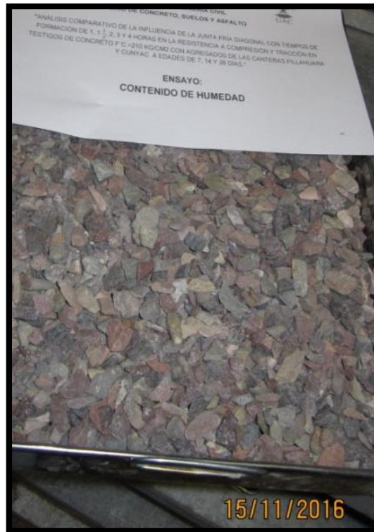
Figura 64: Muestra de agregado grueso seca, retirada del horno
