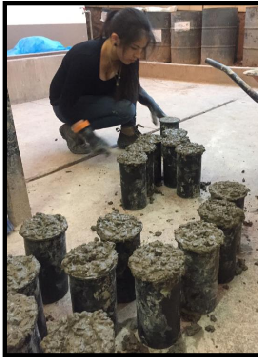
Figura 71: Enrasado de muestras de concreto
