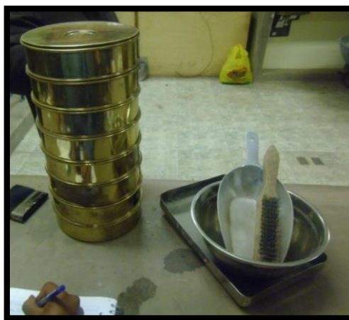
Figura 25: Materiales utilizados para realizar en ensayo de granulometría de agregados.
