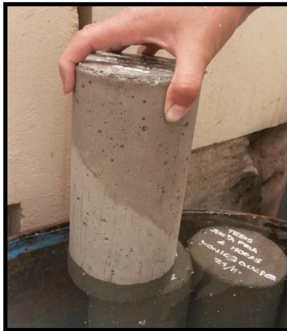
Figura 84: Muestra de concreto con junta fría en pozo de curado
