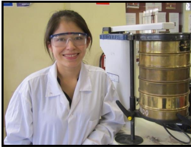
Figura 29: Tamizado de muestra de agregado grueso en la máquina agitadora
