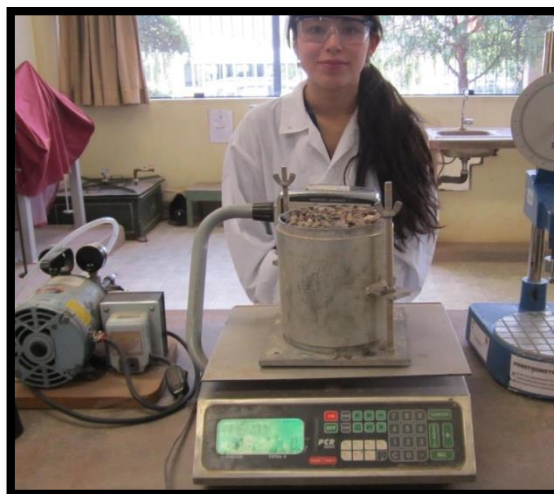
Figura 61: Determinación del peso unitario compactado del agregado grueso
