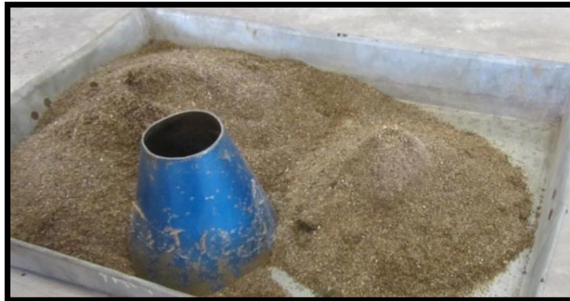
Figura 47: Arena en forma cónica terminada en punta después de ensayo con el cono metálico
