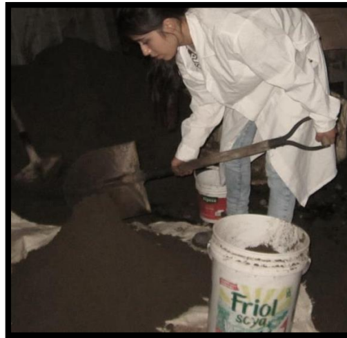
Figura 35: Mezcla del agregado tamizado y el agregado no modificado por peso.
