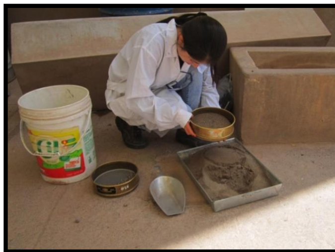
Figura 32: Tamizado del agregado fino por la malla N°30
