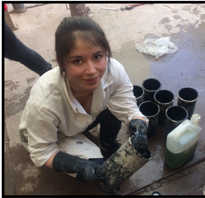
Figura 68: Colocación de desmoldante en las briqueteras
