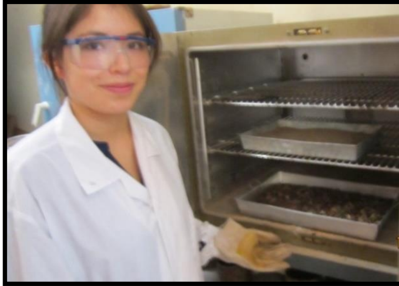
Figura 36: Secado de muestras de agregado en el horno
