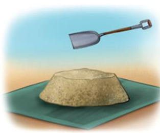
b) El aplanado de la mezcla.
