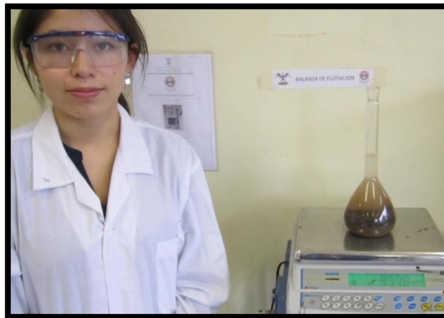
Figura 51: Toma de peso de muestra de agregado fino en picnómetro sin burbujas de aire
