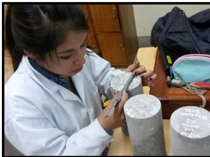
Figura 98: Toma de medidas de las muestras de concreto
