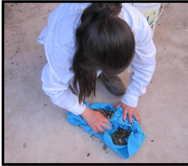
Figura 38: Secado de agregado grueso hasta el estado saturado superficialmente seco
