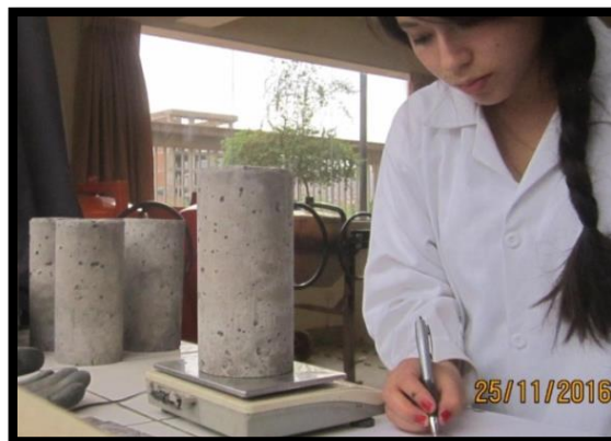
Figura 90: Toma de datos del peso de las muestras de concreto
