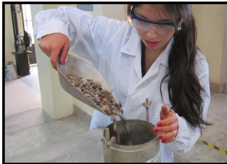
Figura 54: Distribución del agregado grueso en el molde para determinar el peso unitario suelto
