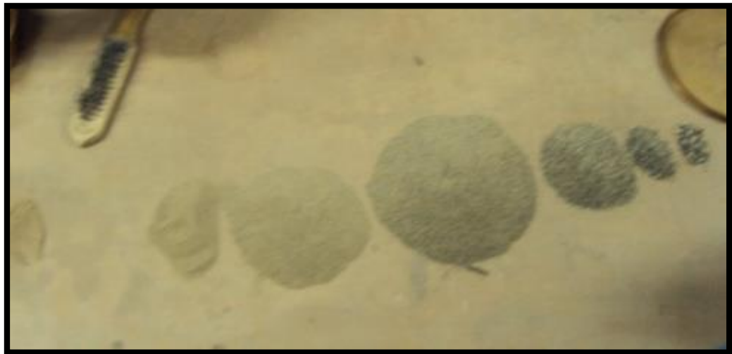
Figura 30: Agregado fino tamizado por las mallas N°4, N°8, N°16, N°30, N°50, N°100 y N°200
