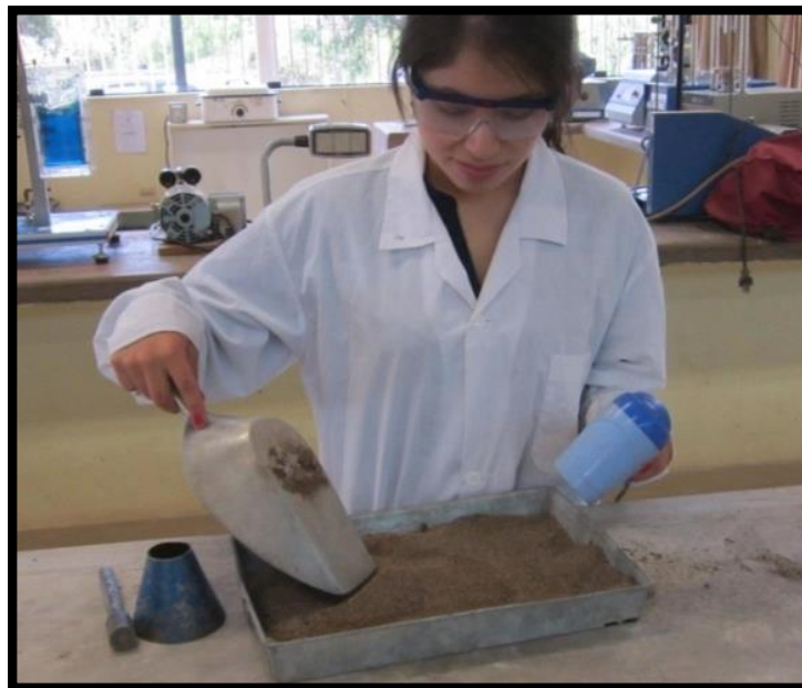
Figura 45: Secado de la muestra de agregado fino hasta estado saturado superficialmente seco
