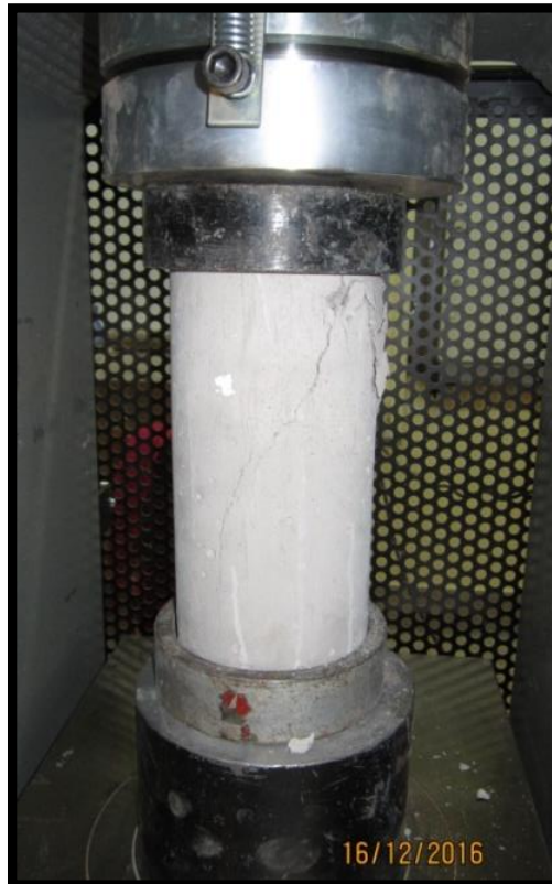
Figura 95: Muestra C-3-B-28 de concreto sometida a compresión axial, con falla tipo 2
