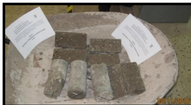
Figura 108: Muestras de concreto ensayadas a tracción indirecta
