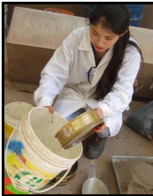
Figura 34: Acumulación del agregado B o agregado retenido entre las mallas N°16 y N°30
