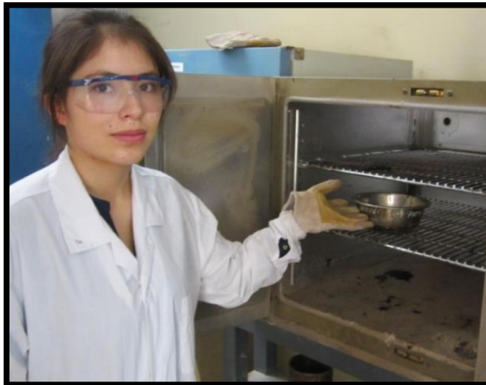
Figura 49: Colocación de agregado fino saturado superficialmente seco en el horno para su secado.
