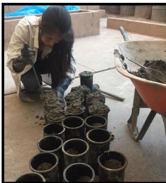
Figura 80: Colocación y compactación de la segunda capa de concreto en las muestras con junta fría
