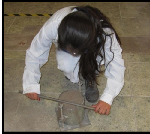
Figura 60: Enrasado del agregado grueso en el molde para determinar el peso unitario compactado
