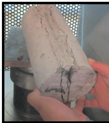
Figura 105: Muestra de concreto ensayada a tracción indirecta
