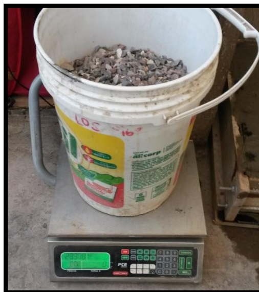
Figura 69: Determinación de peso del agregado de acuerdo al diseño de mezcla para la elaboración de concreto
