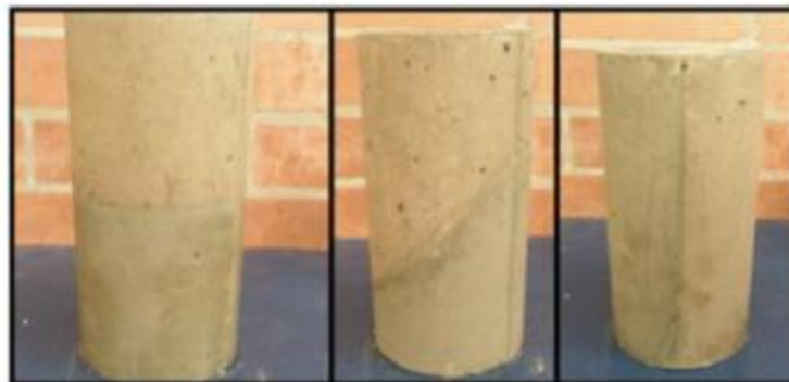
Figura 10: Probetas de concreto con junta fría horizontal, diagonal y vertical
