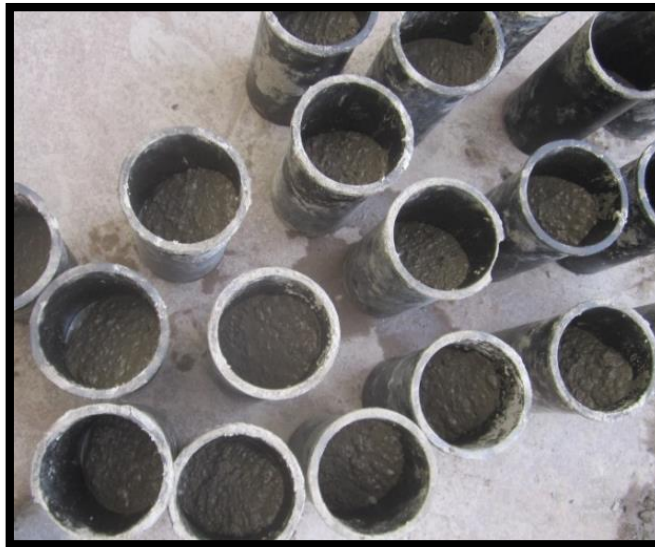
Figura 79: Primera capa de concreto en muestras con junta fría diagonal
