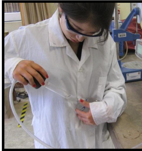
Figura 43: Eliminación de burbujas de aire del agua con la bomba de vacíos
