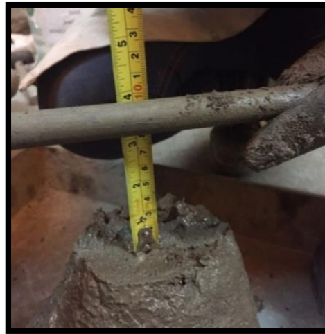
Figura 89: Medida del asentamiento con el cono de Abrams
