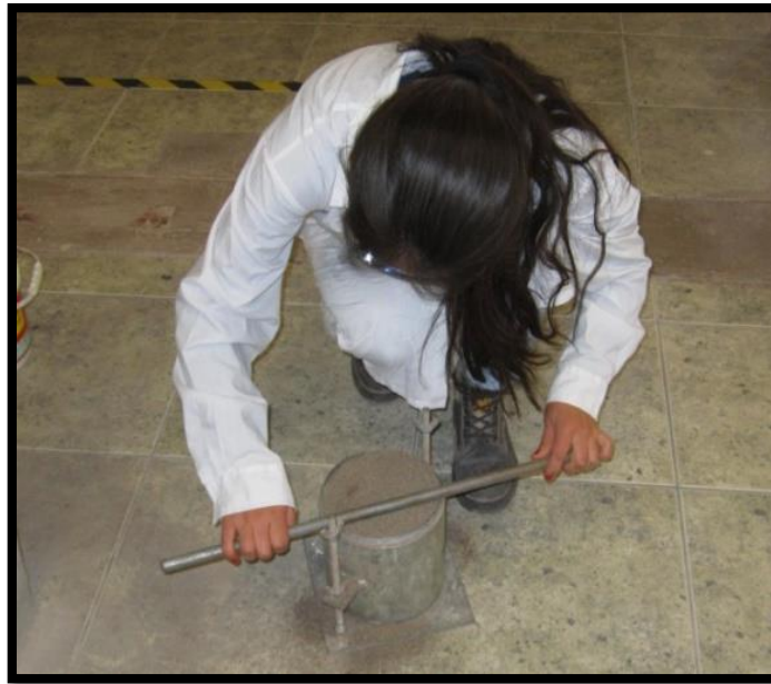
Figura 55: Enrasado de agregado fino
