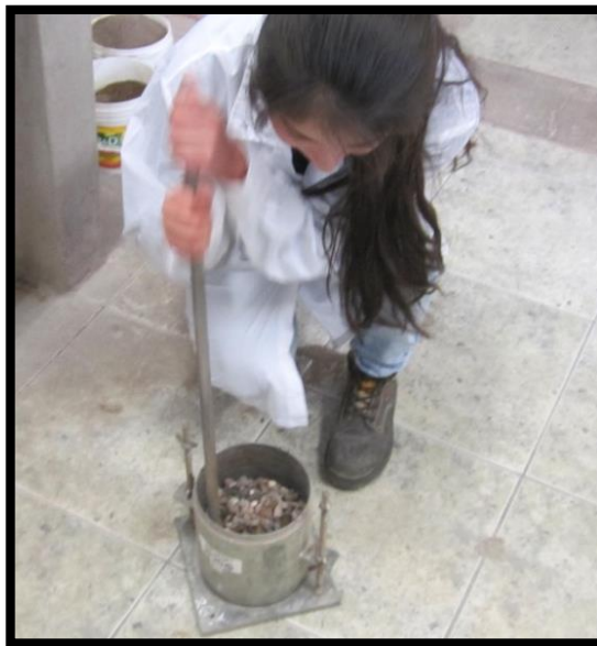
Figura 58: Compactado del agregado grueso en el molde para determinar el peso unitario compactado del agregado.
