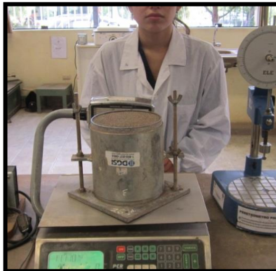
Figura 56: Toma de peso de molde con agregado fino
