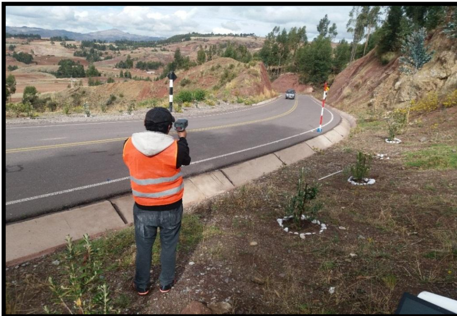
Figura: 47 Medición de velocidades de vehículos ligeros (minibús)
