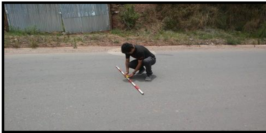
Figura: 26 Medición de peraltes máximos en campo
