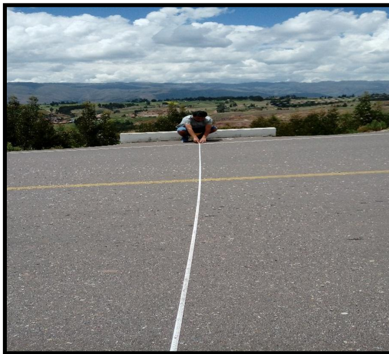
Figura: 28 Medición en campo de sobre anchos
