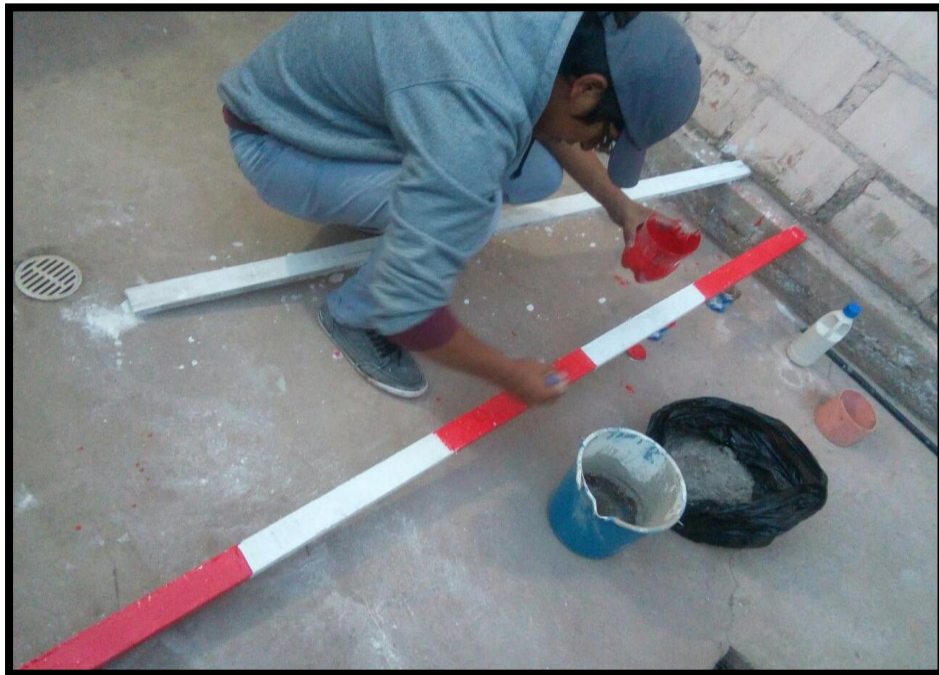
Figura: 45 Preparación de balizas para la medición de velocidades de operación en campo
