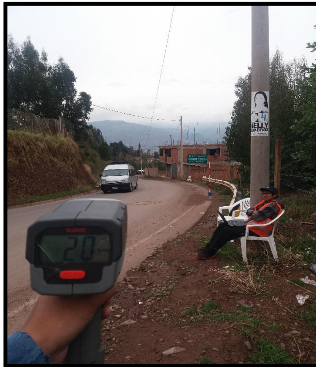
Figura: 25 Medición de velocidades de operación en campo
