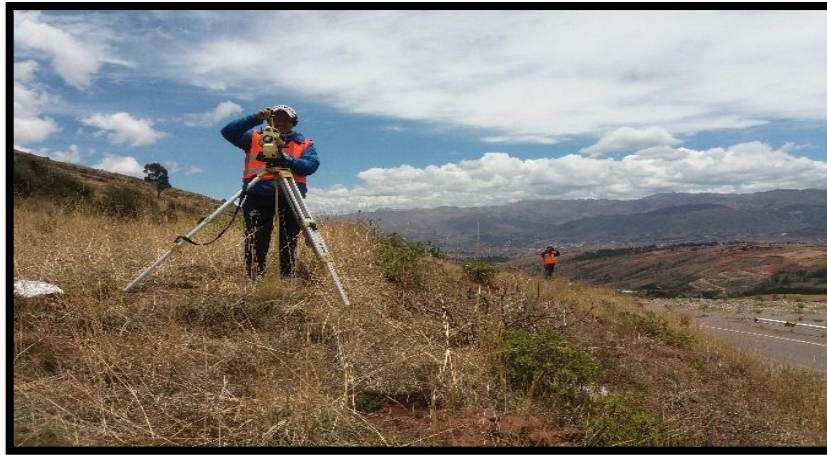
Figura: 23 Estacionamiento en el punto de cambio
