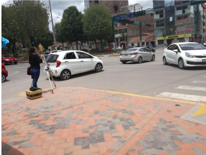
Fotografía 30: Levantamiento topográfico en la Intersección Semaforizada Av. 28 de Julio- 3er paradero de Ttio
