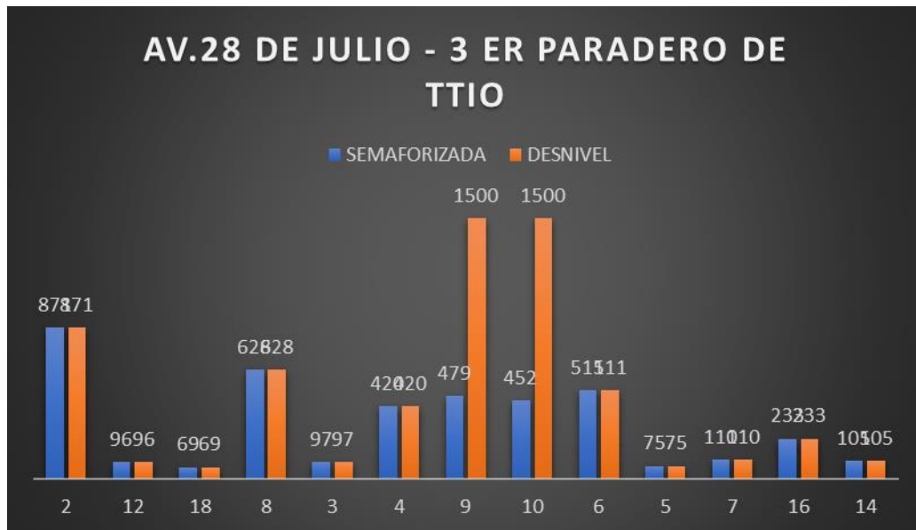
Figura 138 : Comparación de la capacidad de la intersección Semaforzada Av. 28 de Julio – 3er Paradero de Ttio con la intersección a desnivel
