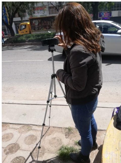
Fotografía 23: Registro Fílmico (punto de aforo 1) en la Intersección Semaforizada Av. La Cultura – Manuel Prado
