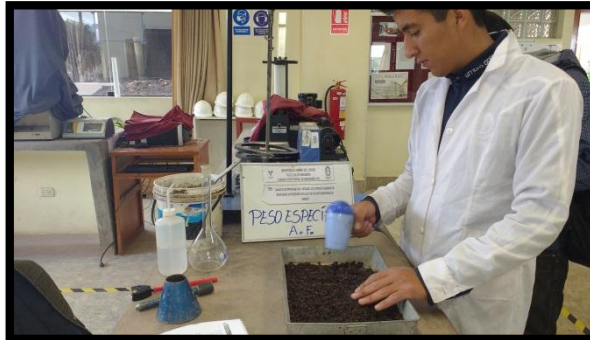
Figura 26 : SECADO DEL MATERIAL HAST TENER UN PESO
