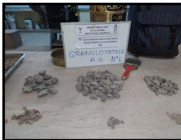
Figura 33: GRANULOMETRIA DEL AGREGADO GRUESO - VICHO
