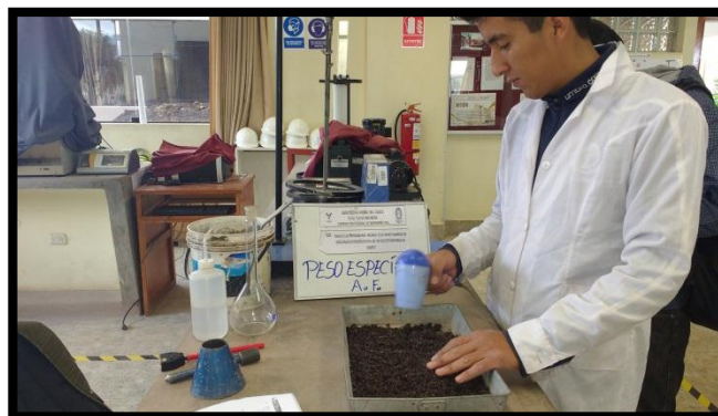
Figura 38: SECADO DE MUESTRA DE AGREGADO GRUESO- PARA HALLAR SU PESO ESPECIFICO
