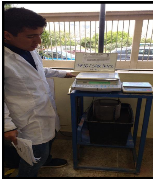
Figura 37: PESO ESPECIFICO DEL AGREGADO GRUESO
