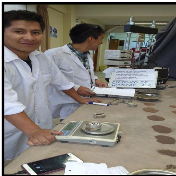
Figura 30: CONTENIDO DE HUMEDAD DEL AGREGADO FINO
