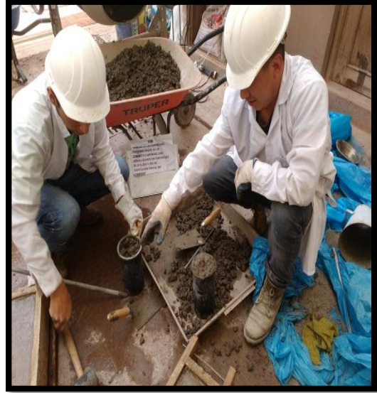
Figura 44: MOLDEADO DE PROBETAS-TESTIGOS
