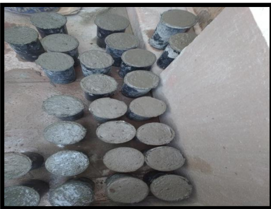
Figura 47: MOLDEADO DE PROBETAS-TESTIGOS
