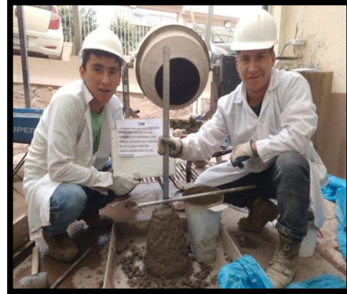
Figura 43: ENSAYO DE CONODE ABRAMS
