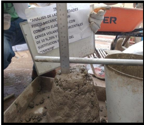
Figura 42: ENSAYO DE CONODE ABRAMS
