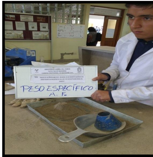
Figura 29: PESO ESPECIFICO DEL AGREGADO FINO
