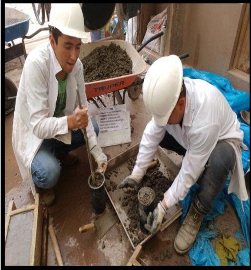
Figura 45: MOLDEADO DE PROBETAS-TESTIGOS
