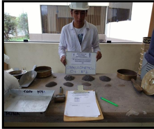
Figura 25: MATERIAL RETENIDO TRAS EL TAMIZADO
