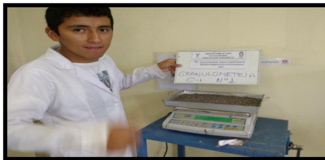
Figura 23: PESADO DEL PESO UNCIAL DEL AGREGADO FINO
