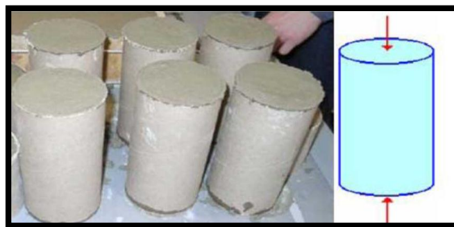
Figura 4: Muestras cilíndricas de concreto para ensayos de compresión estándar.
