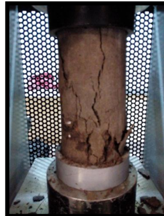
Figura 52: RESISTENCIA A LA COMPRESIÓN
