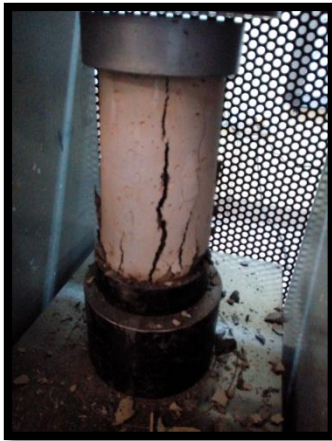
Figura 53: RESISTENCIA A LA COMPRESIÓN
