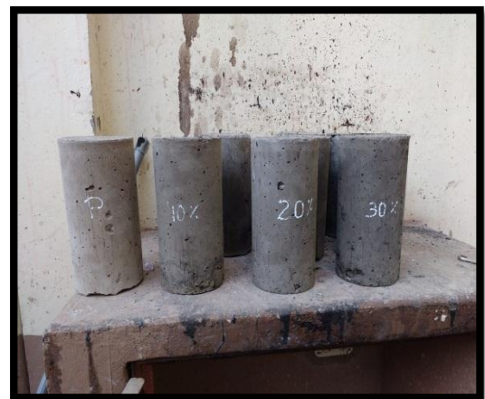
Figura 46: MOLDEADO DE PROBETAS-TESTIGOS
