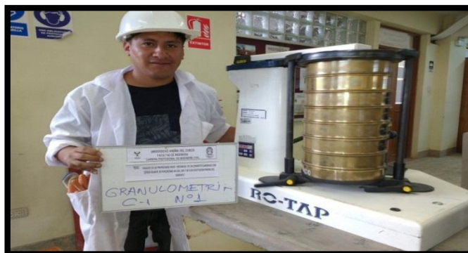
Figura 24: JUEGO DE TAMICES PARA EL AGREGADO FINO
