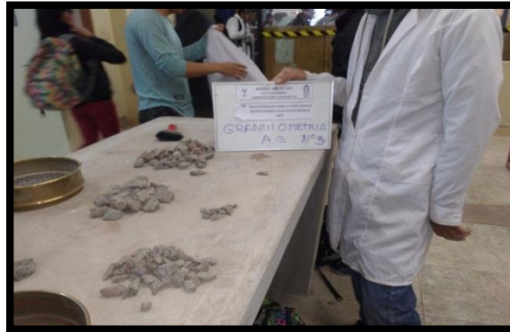
Figura 34: GRANULOMETRIA DEL AGREGADO GRUESO - VICHO
