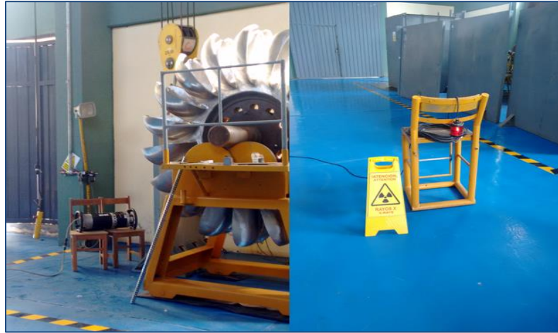
Figura N° 9: Prueba de rayos X. Fuente: Elaboración propia.
