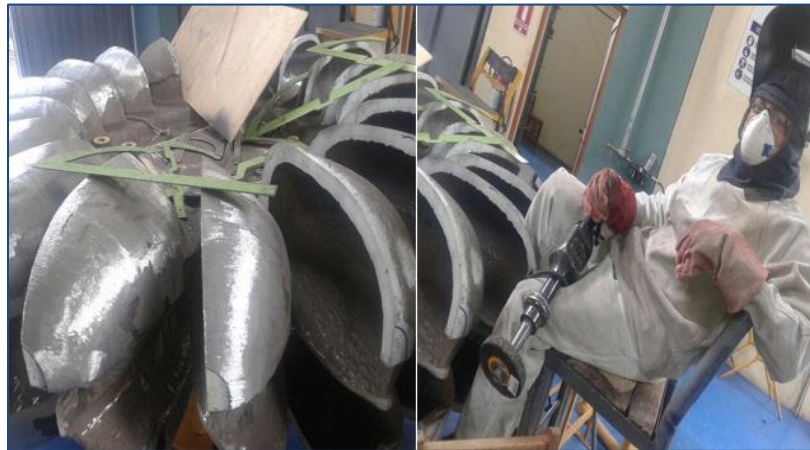
Figura N° 13: Proceso de esmerilado de cucharas. Fuente: Elaboración propia.
