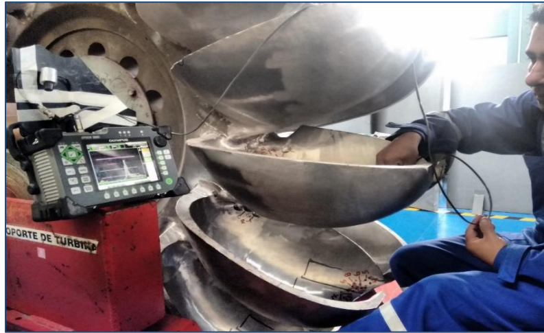
Figura N° 11: Prueba de ultra sonido.
