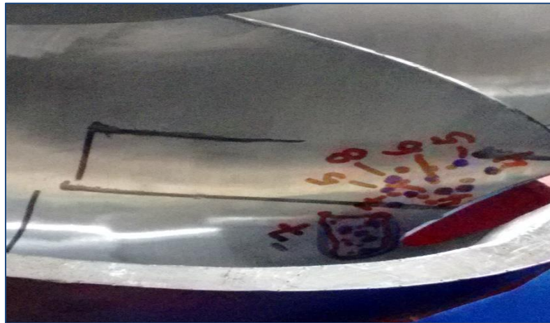
Figura N° 10: Ubicación de porosidad de las pruebas. Fuente: Elaboración propia.
