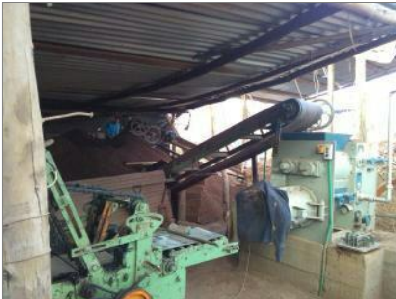
FIGURA N° 87: Equipos empleados para fabricación semi industrial de unidades de albañilería
