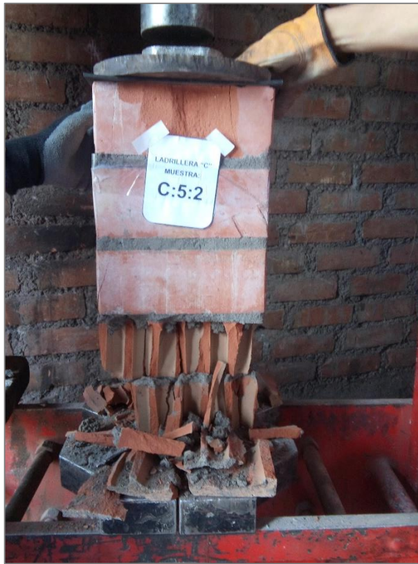
FIGURA N° 98: Falla por trituración de pila de albañilería
