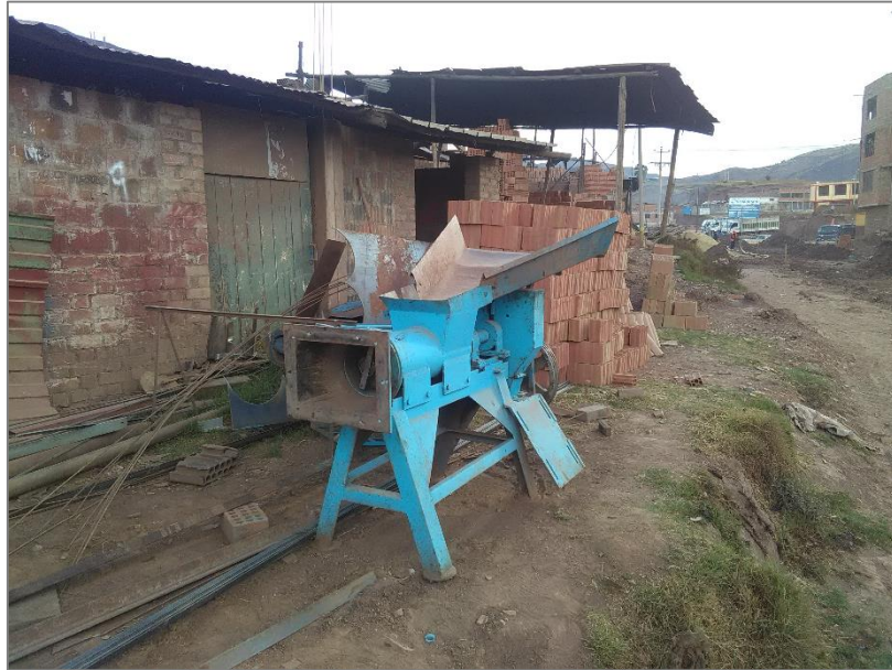
FIGURA Nº 88: Maquina extrusora fabricada empíricamente en el distrito de San Jerónimo
