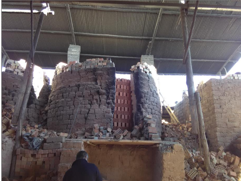
FIGURA N° 86: Horno artesanal para cocción de unidades de albañilería
