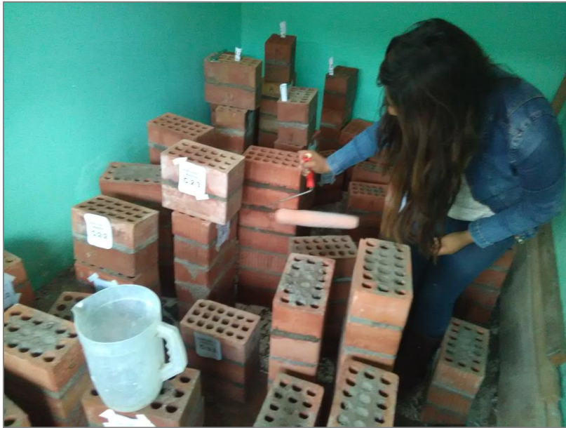
FIGURA N° 94: Curado de juntas de mortero en pilas de albañilería
