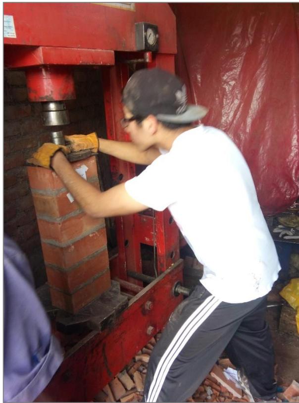
FIGURA N° 100: Colocación de pila de albañilería en prensa hidráulica
