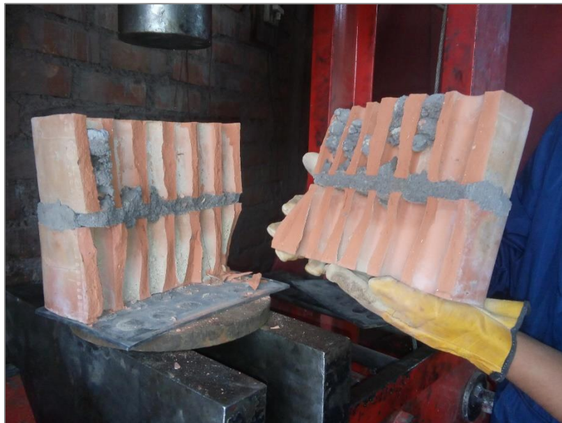
FIGURA N° 99: Falla ideal en pila de albañilería de 2 hiladas
