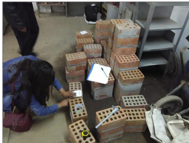
FIGURA N° 49: Medición de altura, ancho y espesor de pilas de albañilería
