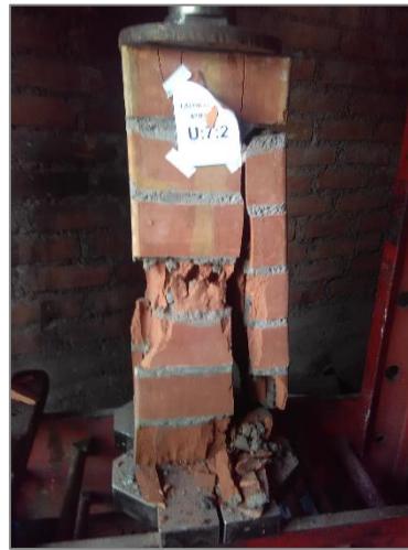
FIGURA N° 50: Falla de pila de albañilería por carga a compresión axial
