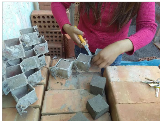
FIGURA N° 54: Desmolde de testigos cúbicos de mortero
