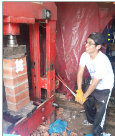
FIGURA N° 51: Aplicación de carga a compresión axial de pilas de albañilería
