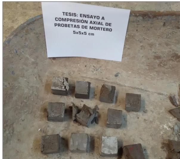
FIGURA Nº 56: Testigos de mortero después del ensayo de resistencia a compresión axial
